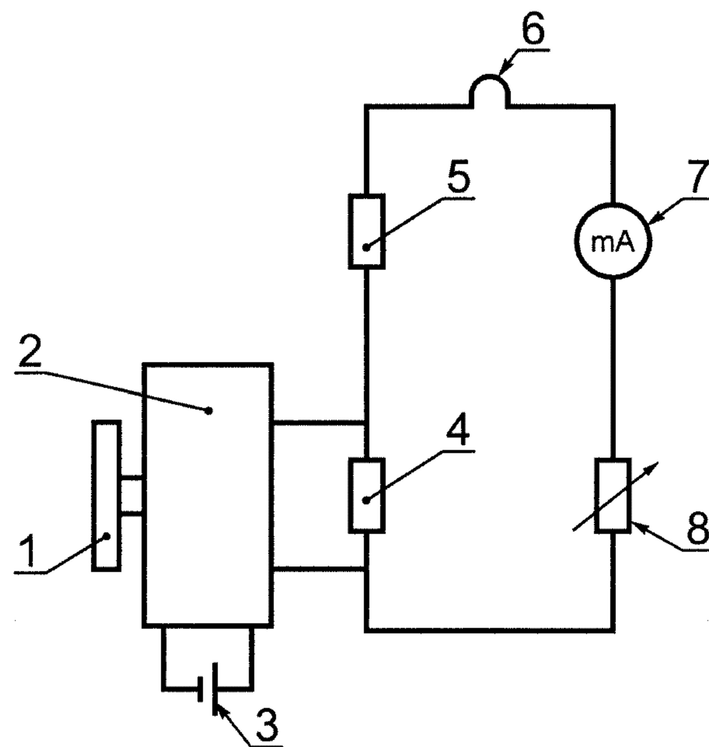
1, 5 — стабилизаторы напряжения, например типа П-36-1; 2 — потенциометр, например типа Р363-2; 3 — нормальный элемент НЭ-65; 4 — образцовая катушка сопротивления 10 Ом; 6 — нагреватель калориметра; 7 — миллиамперметр 0—50 мА; 8 — магазин сопротивлений, например типа Р33
