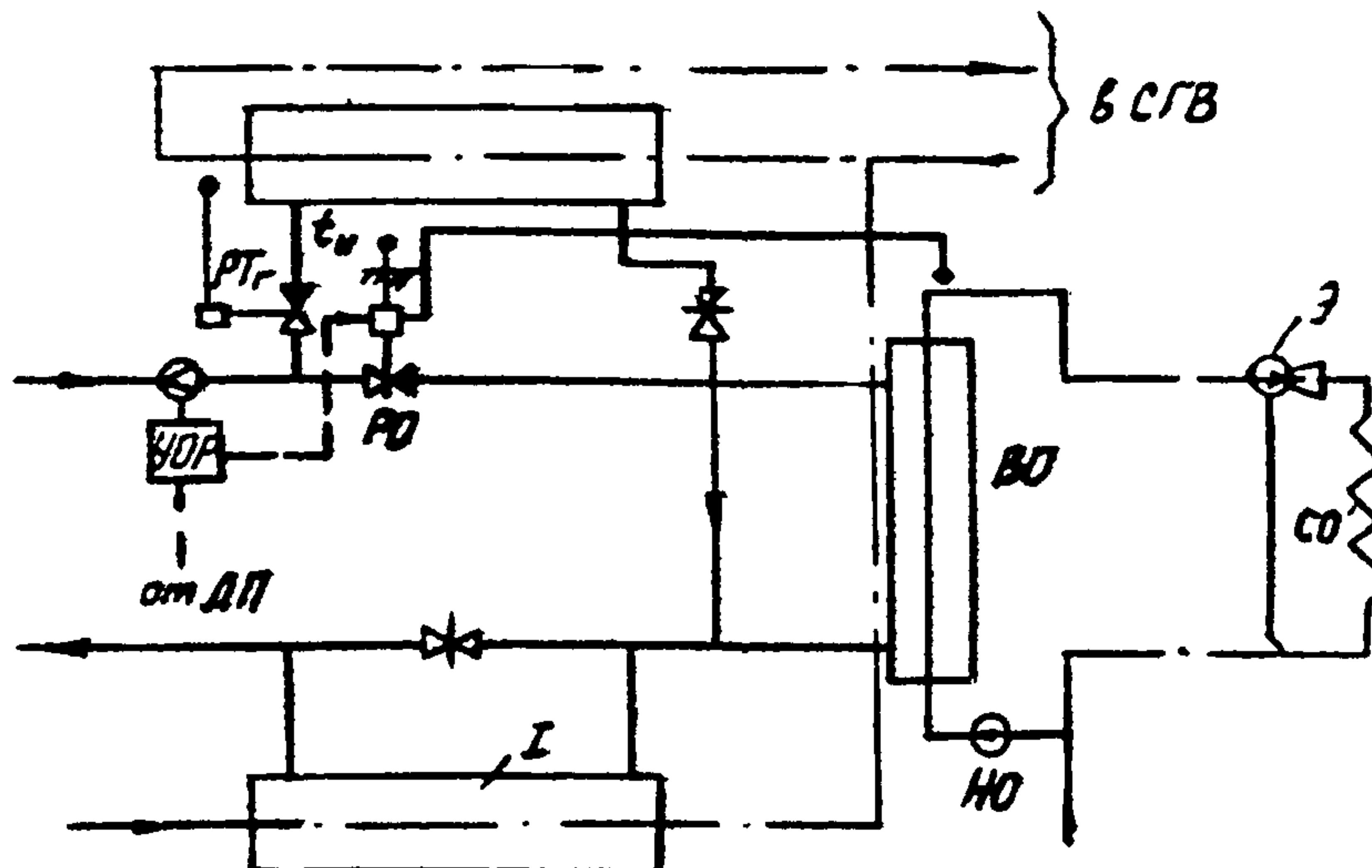
Рис.2. Технологическая схема ЦП со смешанной схемой присоединения водонагревателя горячего водоснабжения, автоматическим регулированием отпуска теплоты и независимым присоединением систем отопления:
