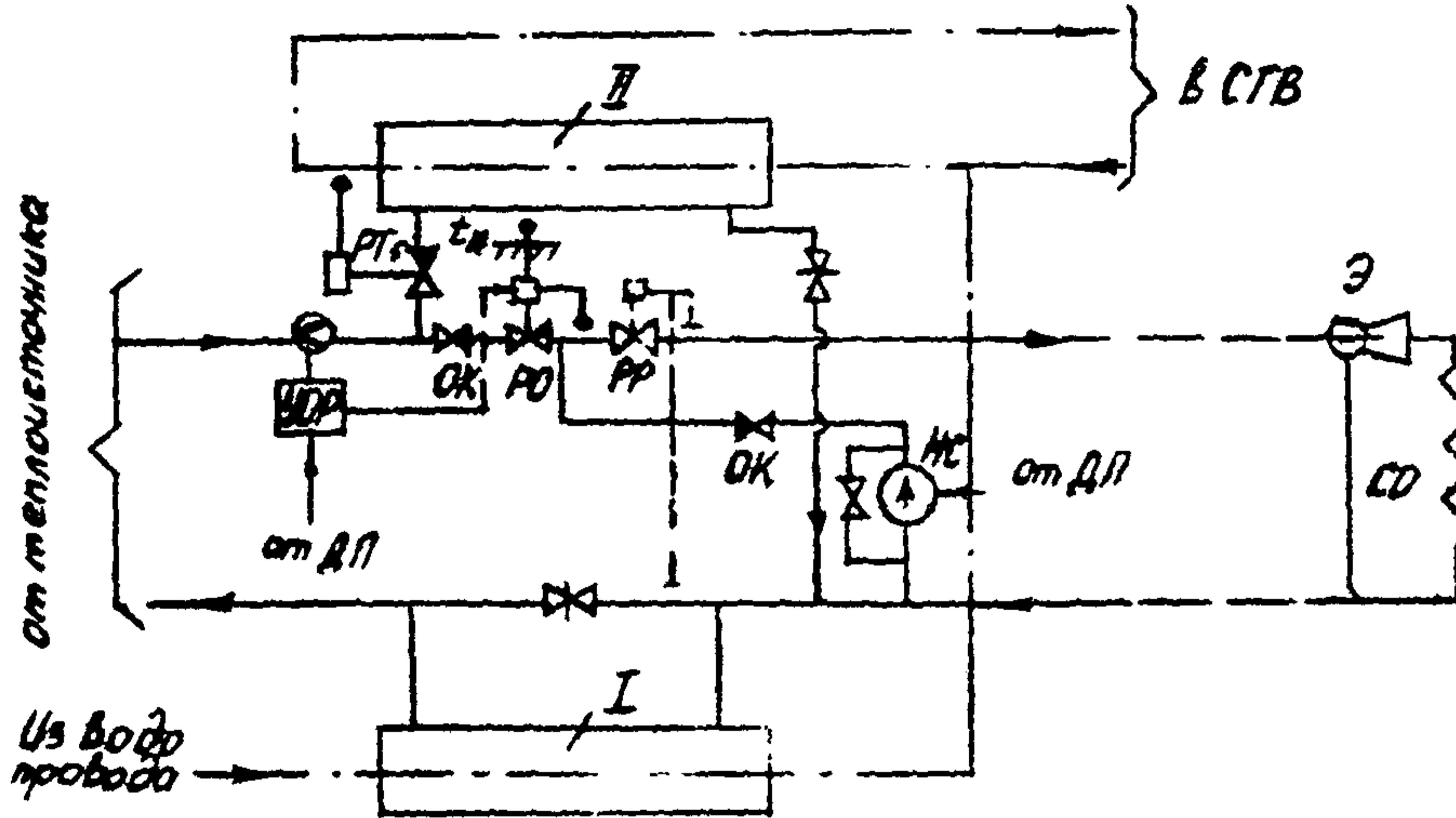
Рис. I. Технологическая схема ЦП со смешанной схемой присоединения водонагревателя горячего водоснабжения, автоматическим регулированием отпуска теплоты и зависимым присоединением систем отопления:
