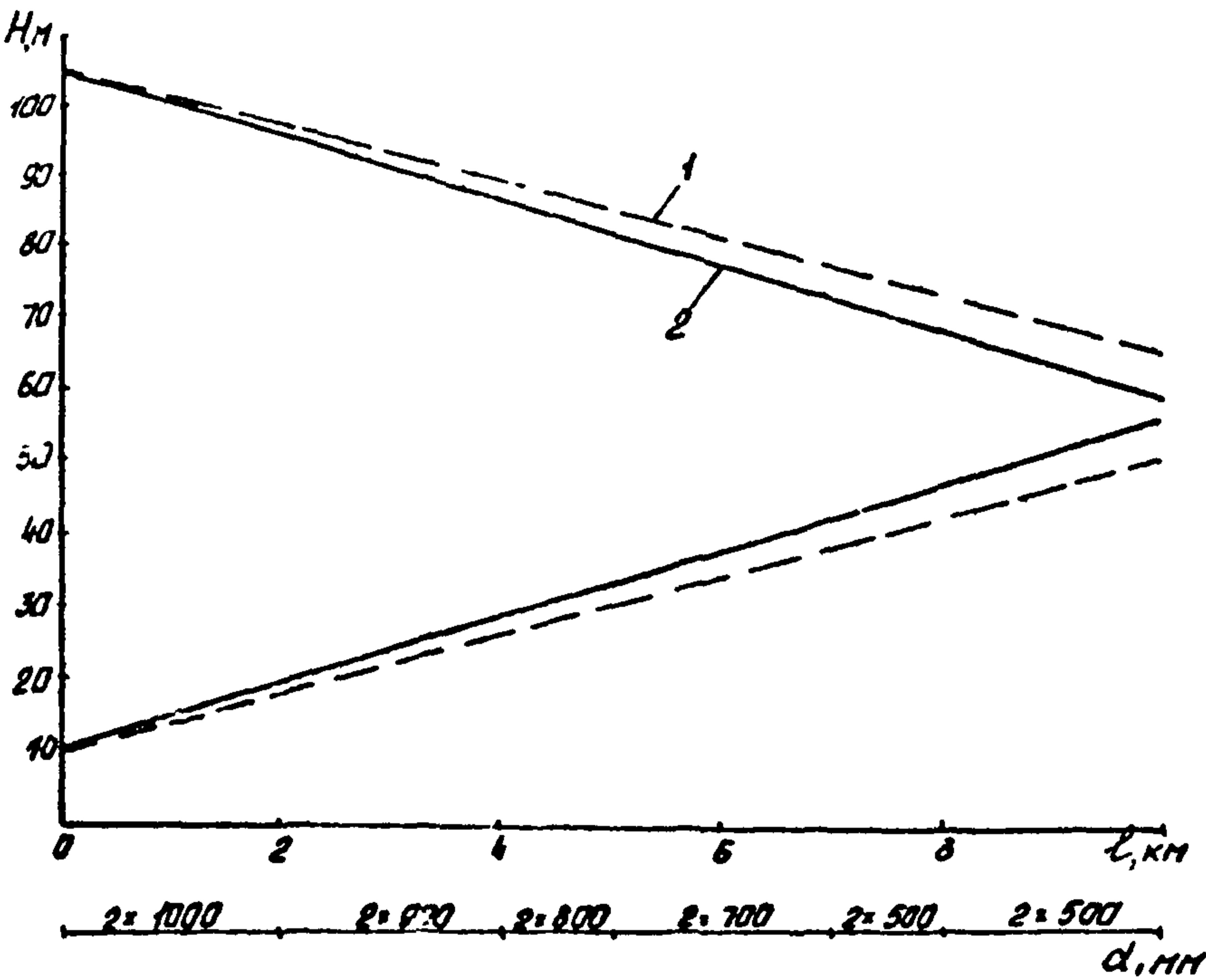
Рис. 2 График давлений в тепловой сети:
