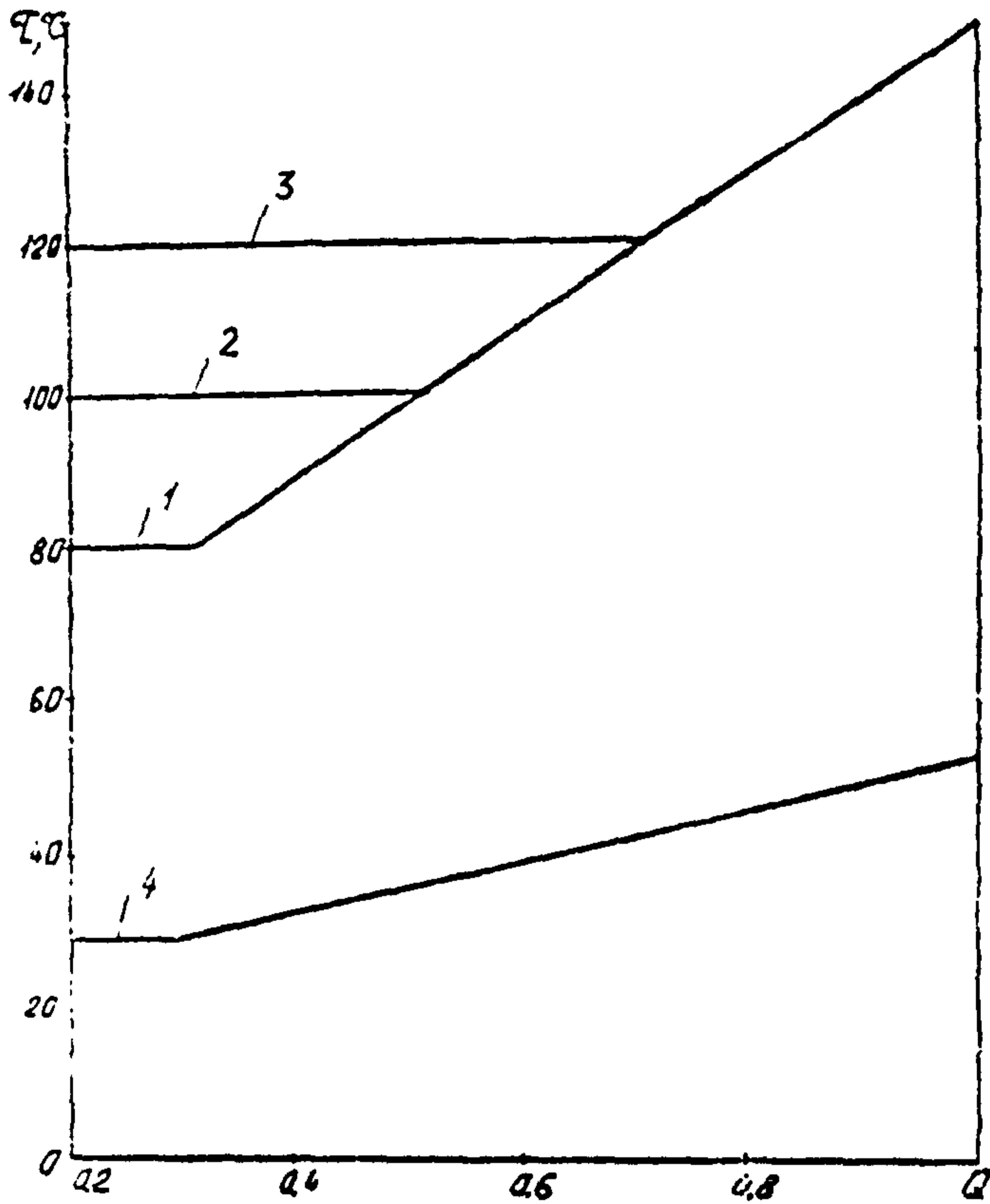
Рис. 5. Режим работы тепловой сети от котельной при автоматизации ГП:
