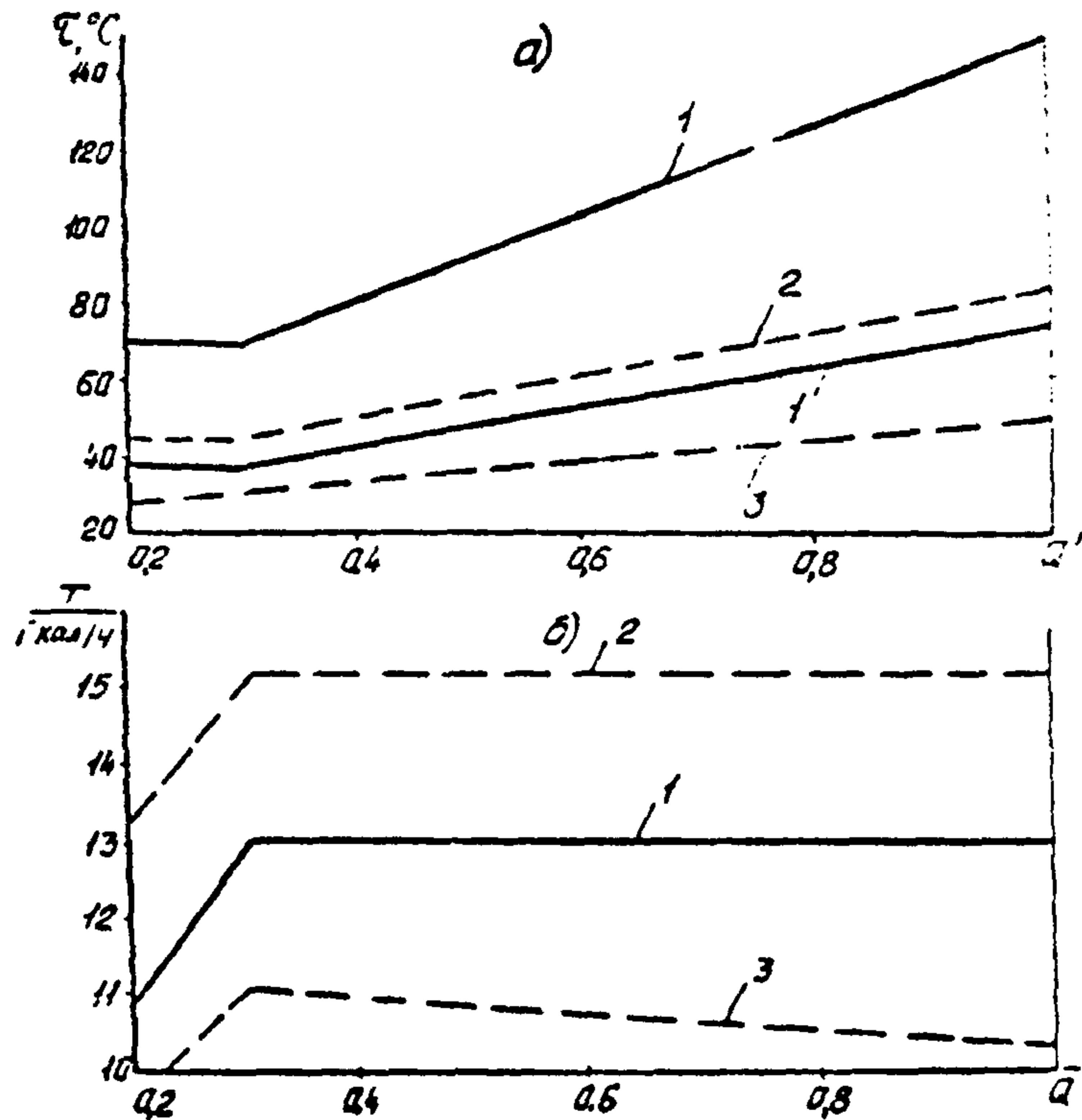
Рис. I Режим работы тепловой сети (пример):
