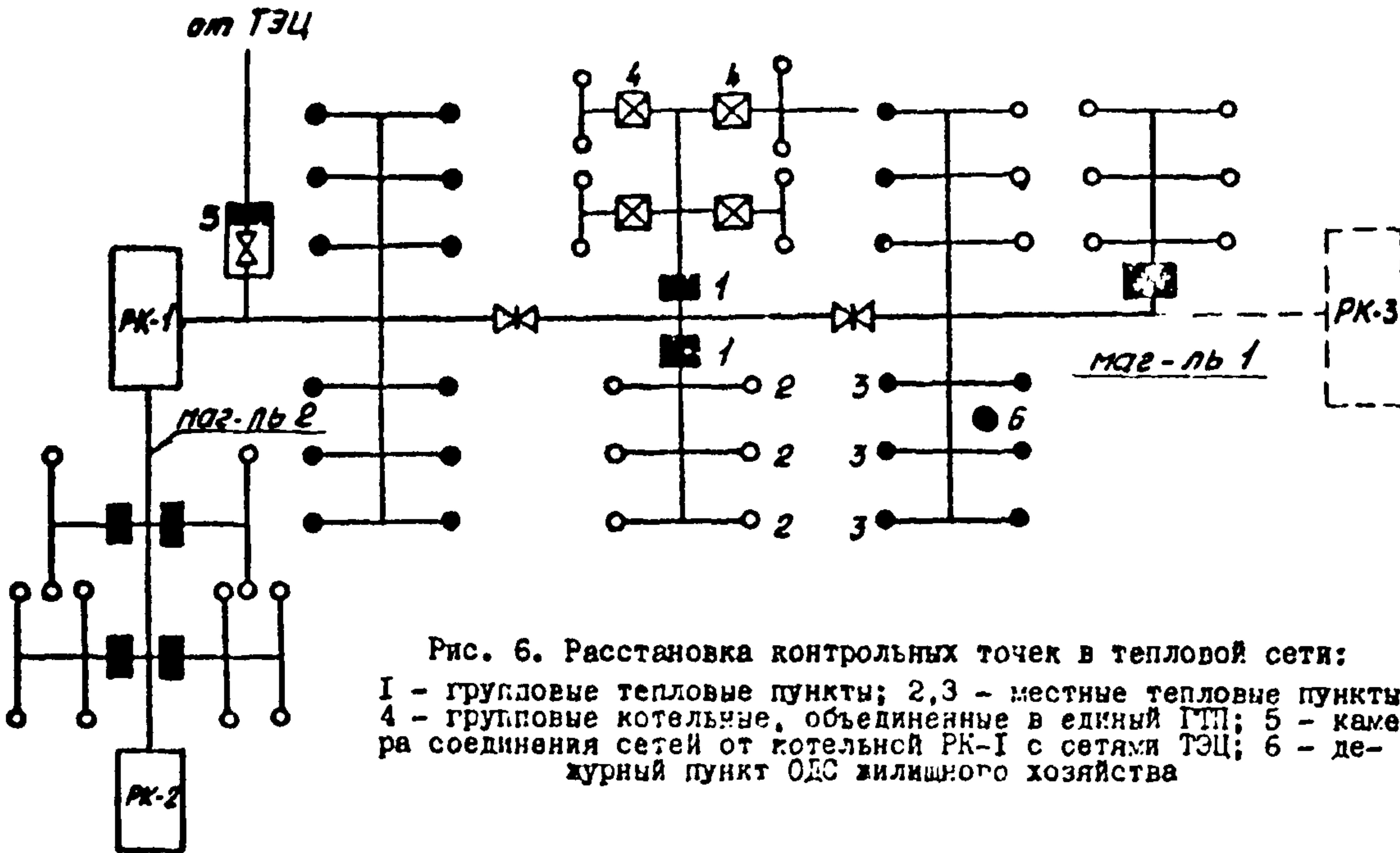
точек контроля, естественно, является функцией не только размера тепловой сети, но также и степени ее нагруженности как в целом, так и отдельных участков, что определяется расчетными графиками пьезометров. Задачи контроля усложняются, а следовательно, растет и необходимое количество точек контроля в тех случаях, когда по тем или иным причинам постоянно или достаточно часто нарушается график температур подаваемой воды.
