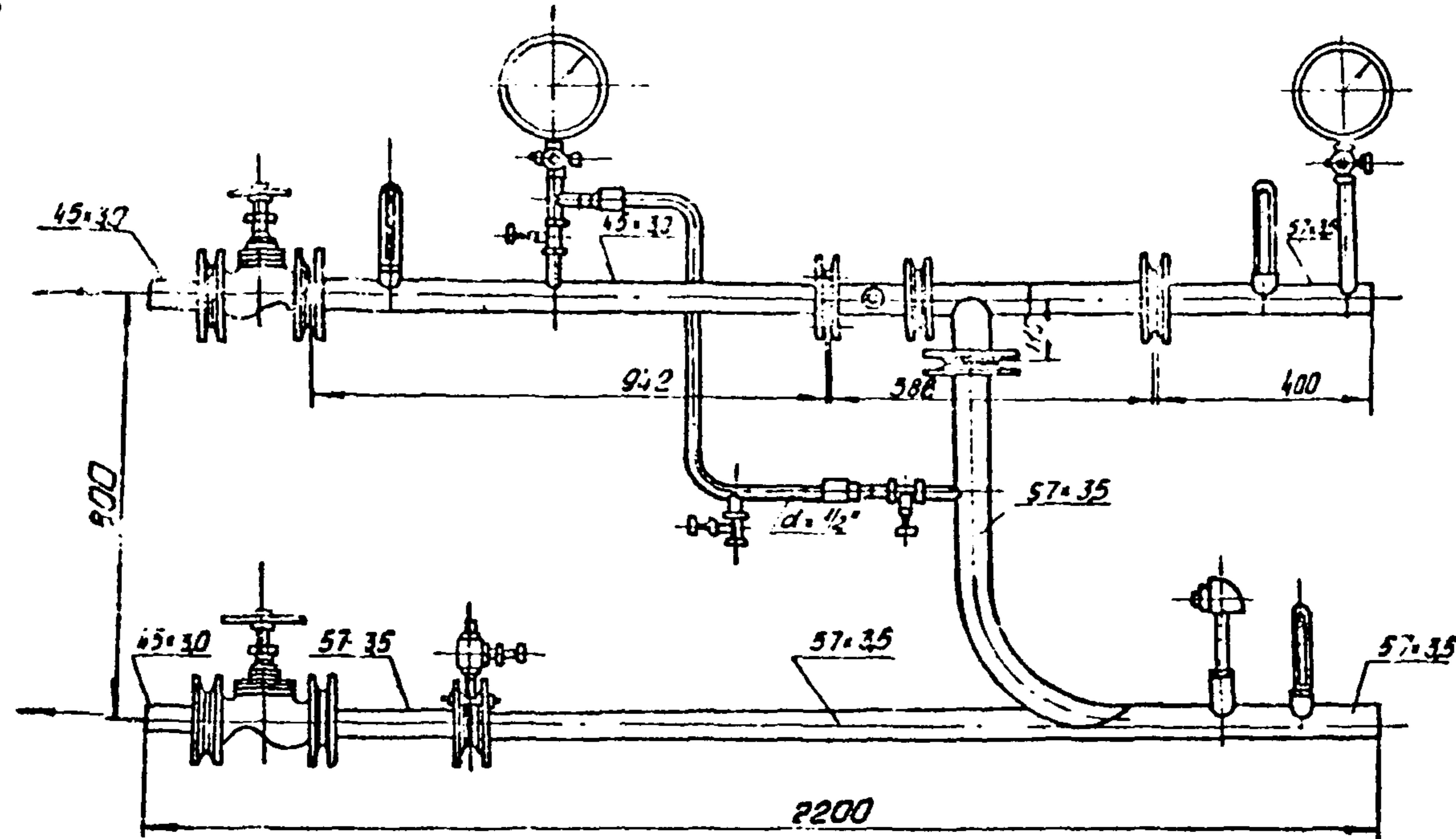
Рис. 3. Тепловой пункт - элеватор с регулируемым соплом
