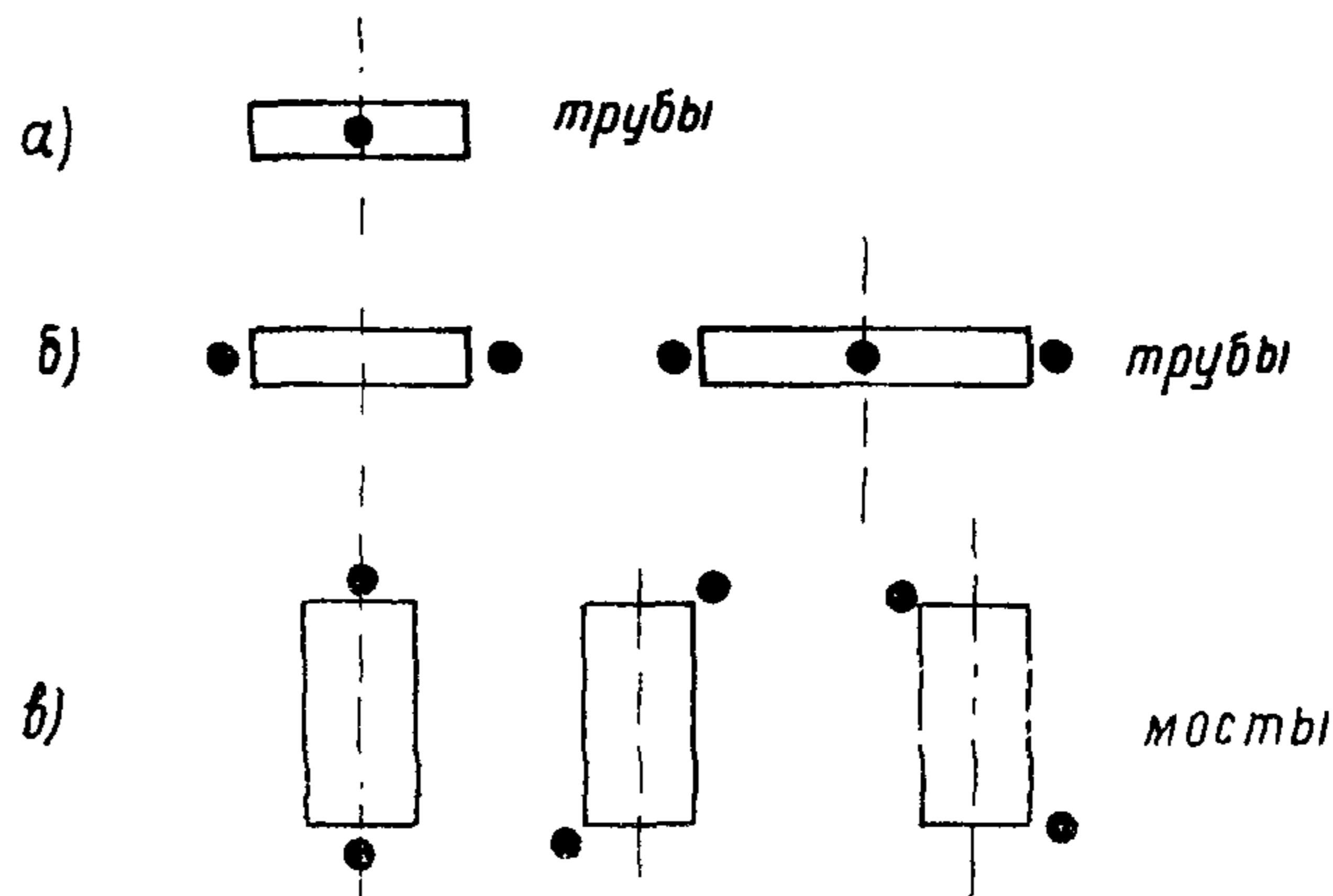
Рис 1 Схема расположения выработок при инженерно-геологическом обследовании мест устройствия малых искусственных сооружений.
