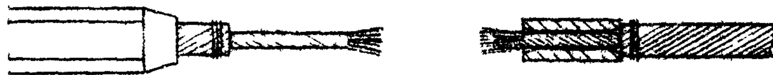
Положение сердечника соединителя до опрессовки
