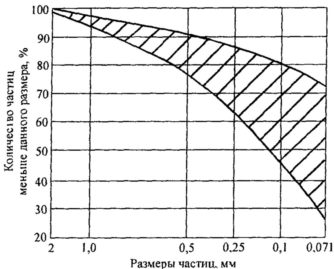
**Кривые гранулометрического состава грунта**
