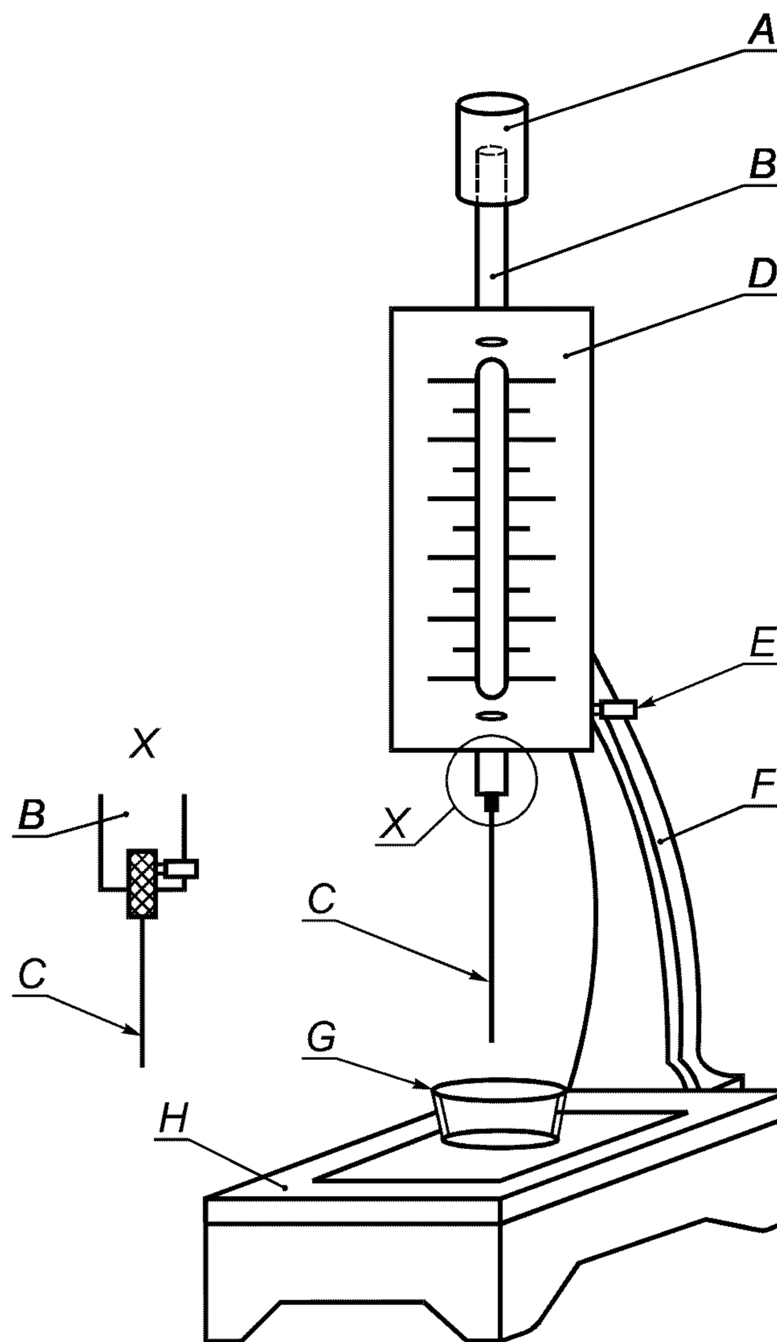
Рисунок 2 — Схема прибора Вика «ОГЦ»
