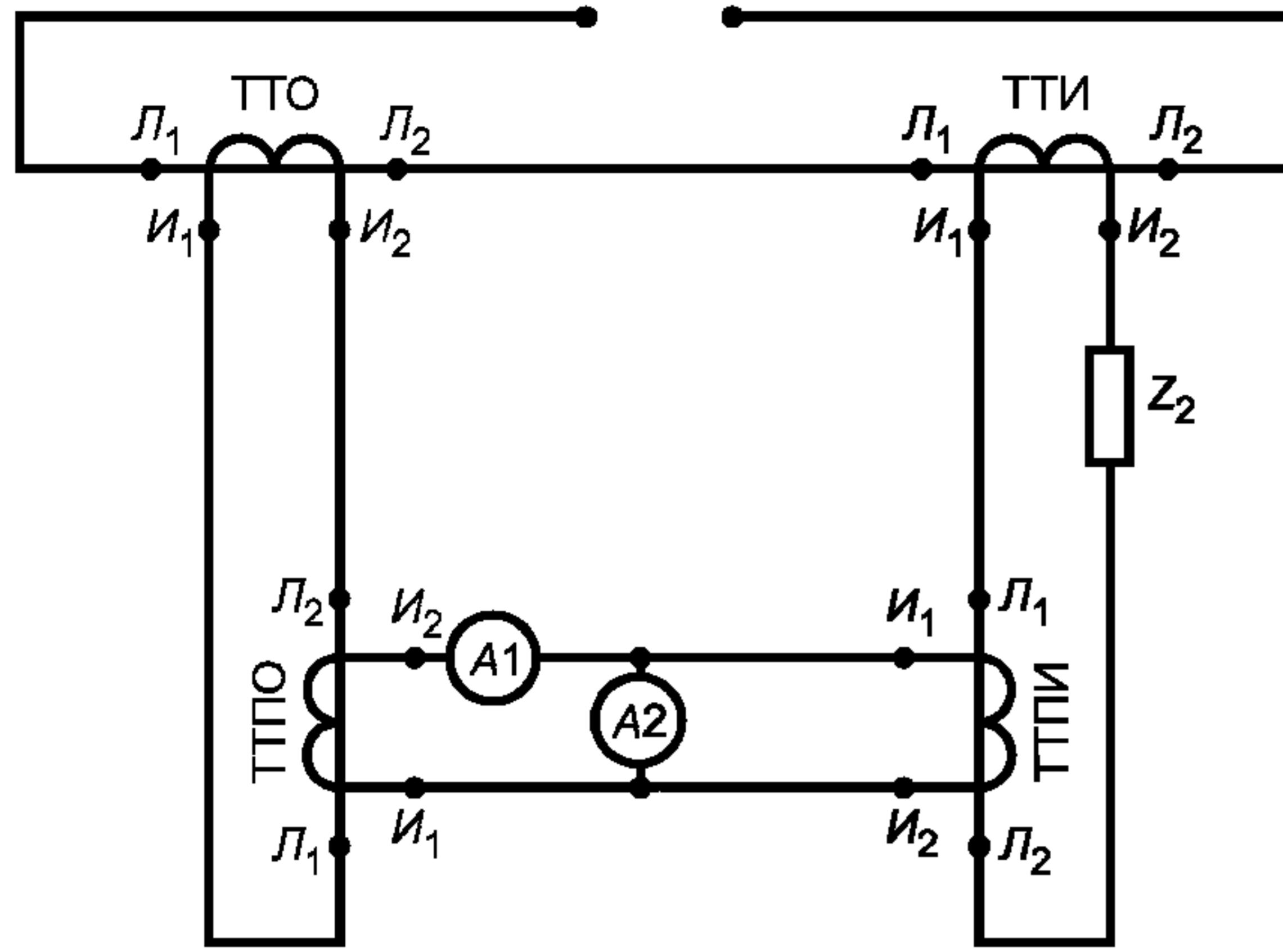
ТТО — образцовый трансформатор тока; ТТИ — испытуемый трансформатор тока; ТТПИ — промежуточный трансформатор тока, находящийся в цепи испытуемого трансформатора тока; ТТПО — промежуточный трансформатор тока, находящийся в цепи образцового трансформатора тока; А1, А2 — амперметры; Z<sub>2</sub> — вторичная нагрузка в цепи испытуемого трансформатора тока
