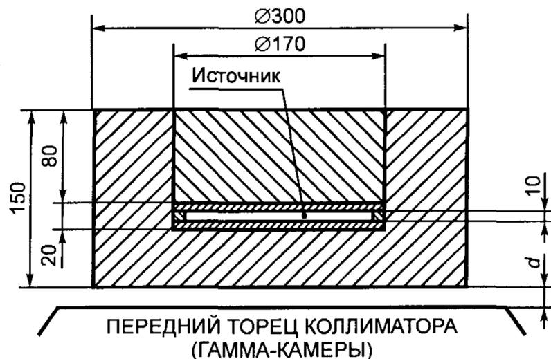
Рисунок 2 — Цилиндрический фантом
