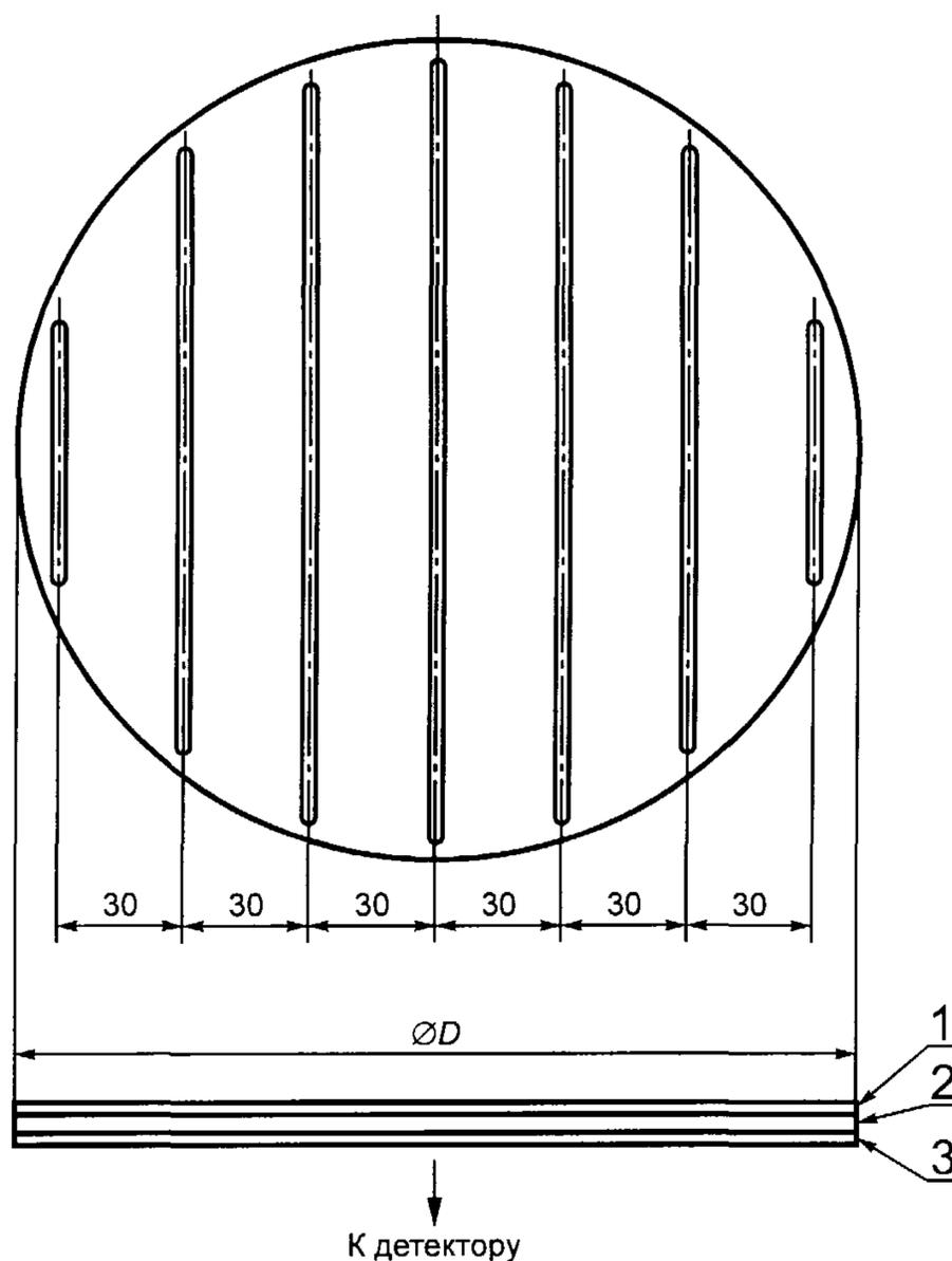
1 — алюминиевый сплав 3 мм; 2 — свинец (4 % алюминия) 3 мм;
