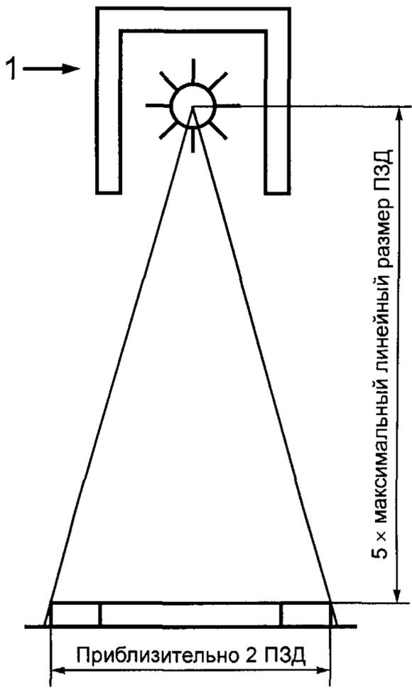
1 — свинцовая защита предотвращает неконтролируемое рассеяние
