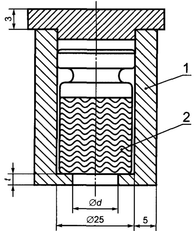
1 — опора источника (свинцовая); 2 — источник
