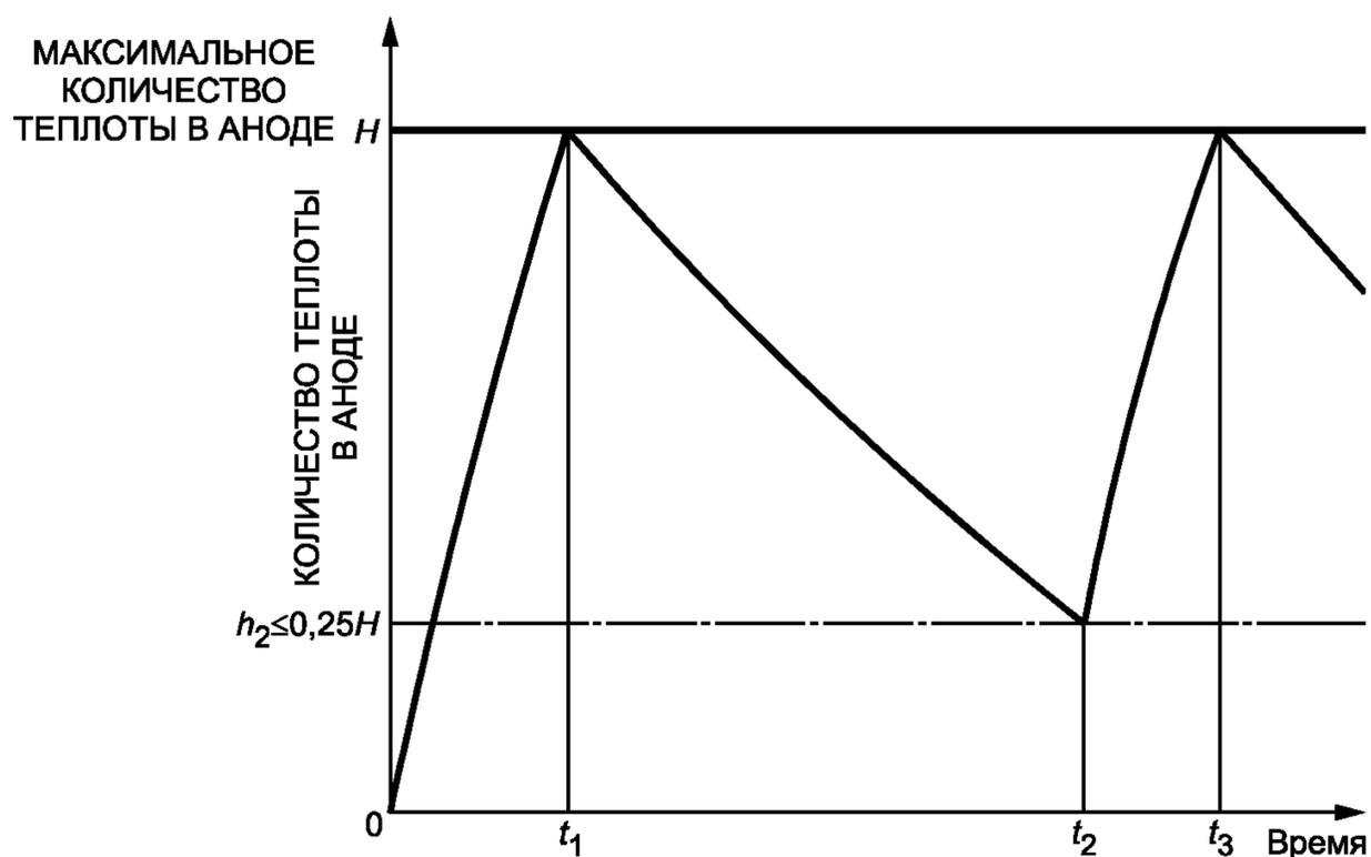
Рисунок 2 — Проверка КРИВОЙ ОХЛАЖДЕНИЯ АНОДА
