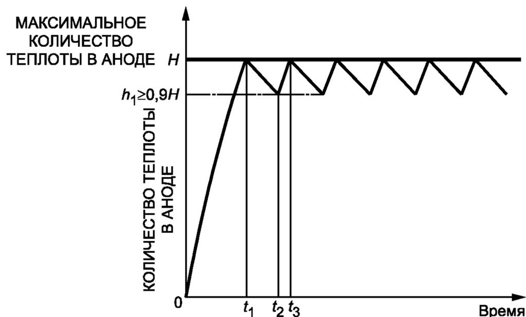
Рисунок 1 — Проверка МАКСИМАЛЬНОГО КОЛИЧЕСТВА ТЕПЛОТЫ В АНОДЕ
