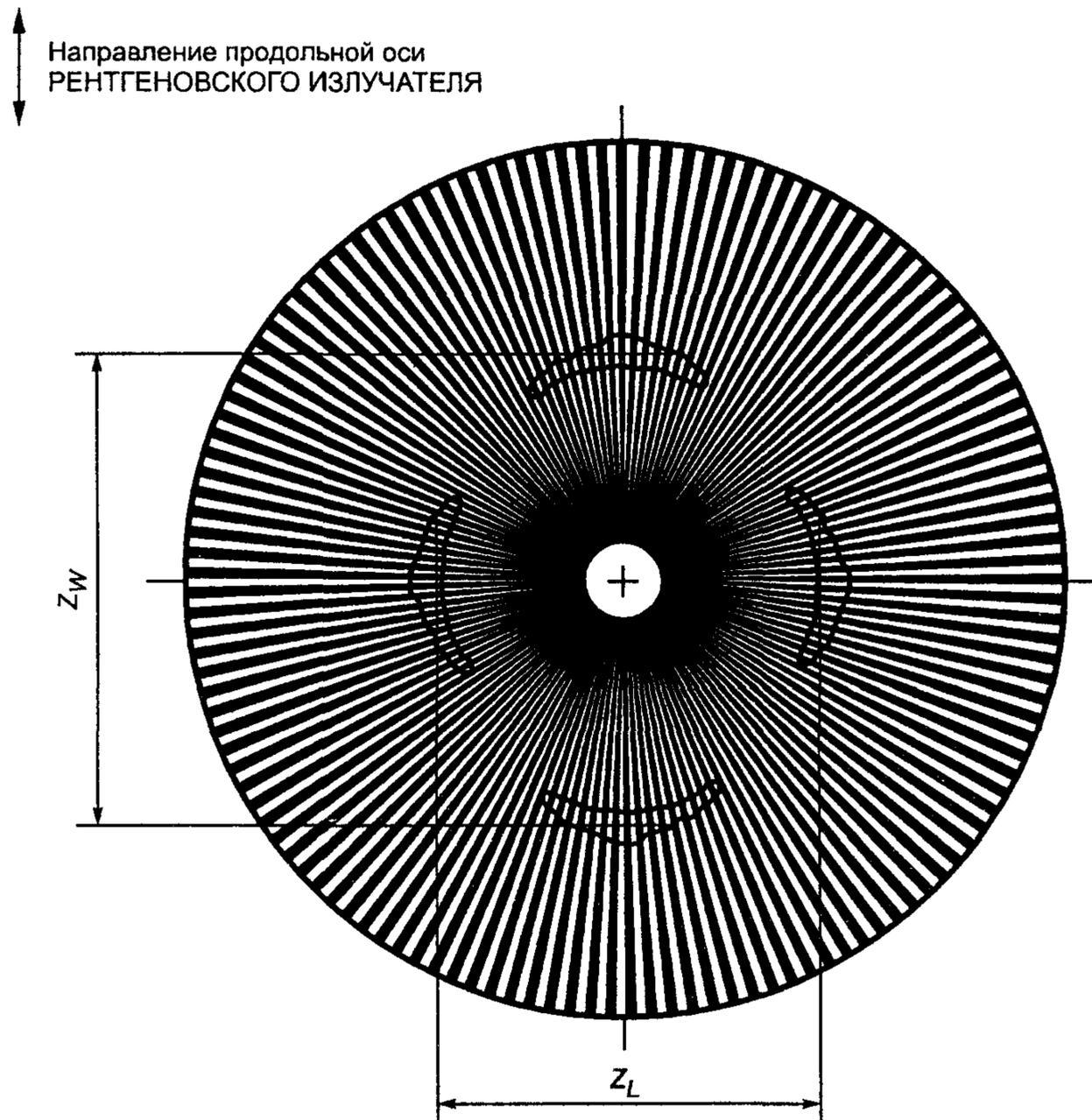
Рисунок 11 — Изображение испытательной миры
