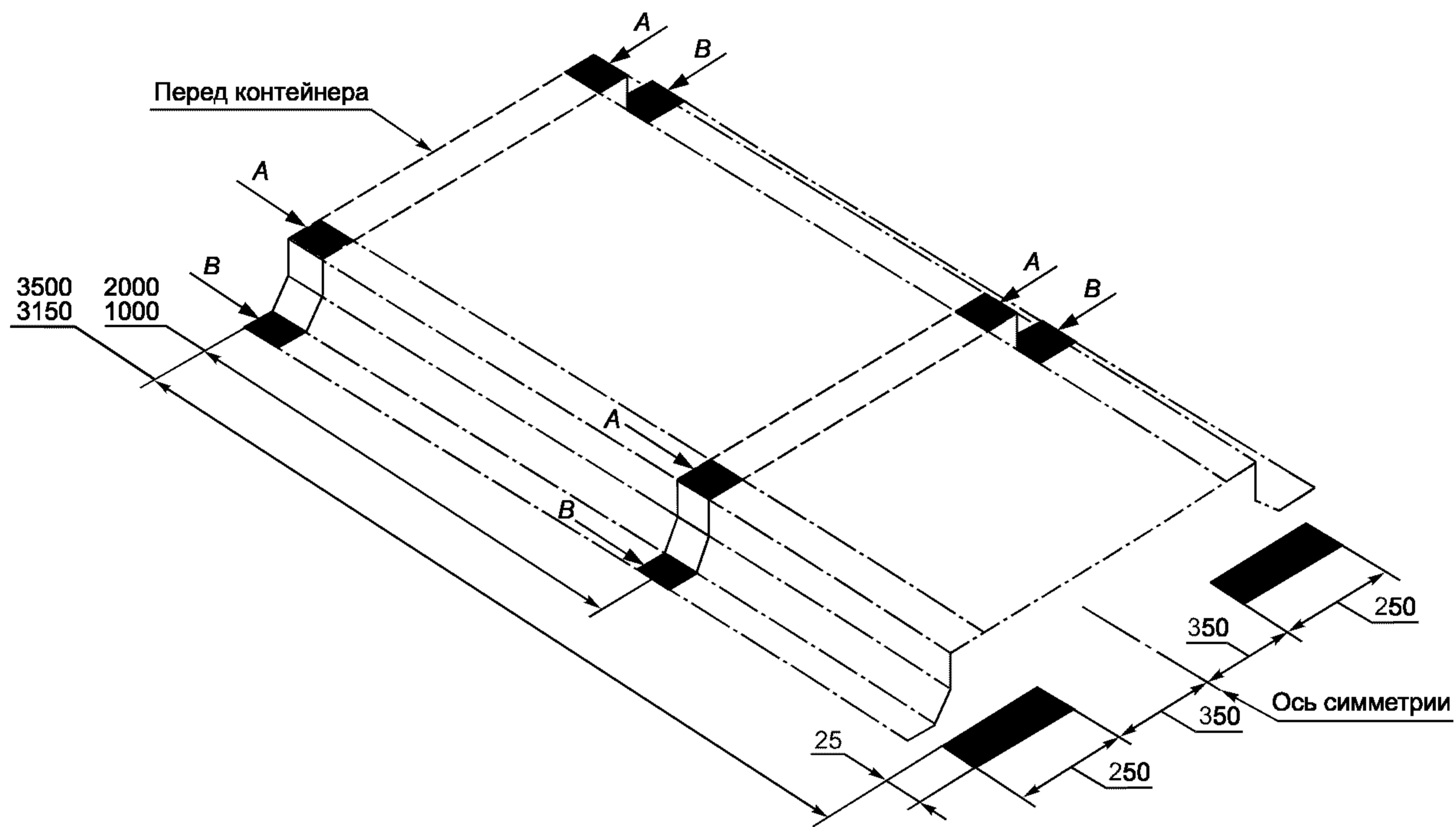
Каждая опорная (контактная) зона тоннеля имеет две составляющие: в верхней части — *A* и в нижней части — *B*. Суммарная площадь каждой пары площадок *A* и *B*, которые следует рассматривать как составные части одной поверхности, передающей нагрузки в зоне паза, должна быть не менее  $1250 \text{ мм}^2$  (см. приложение В для более подробного описания тоннеля).
