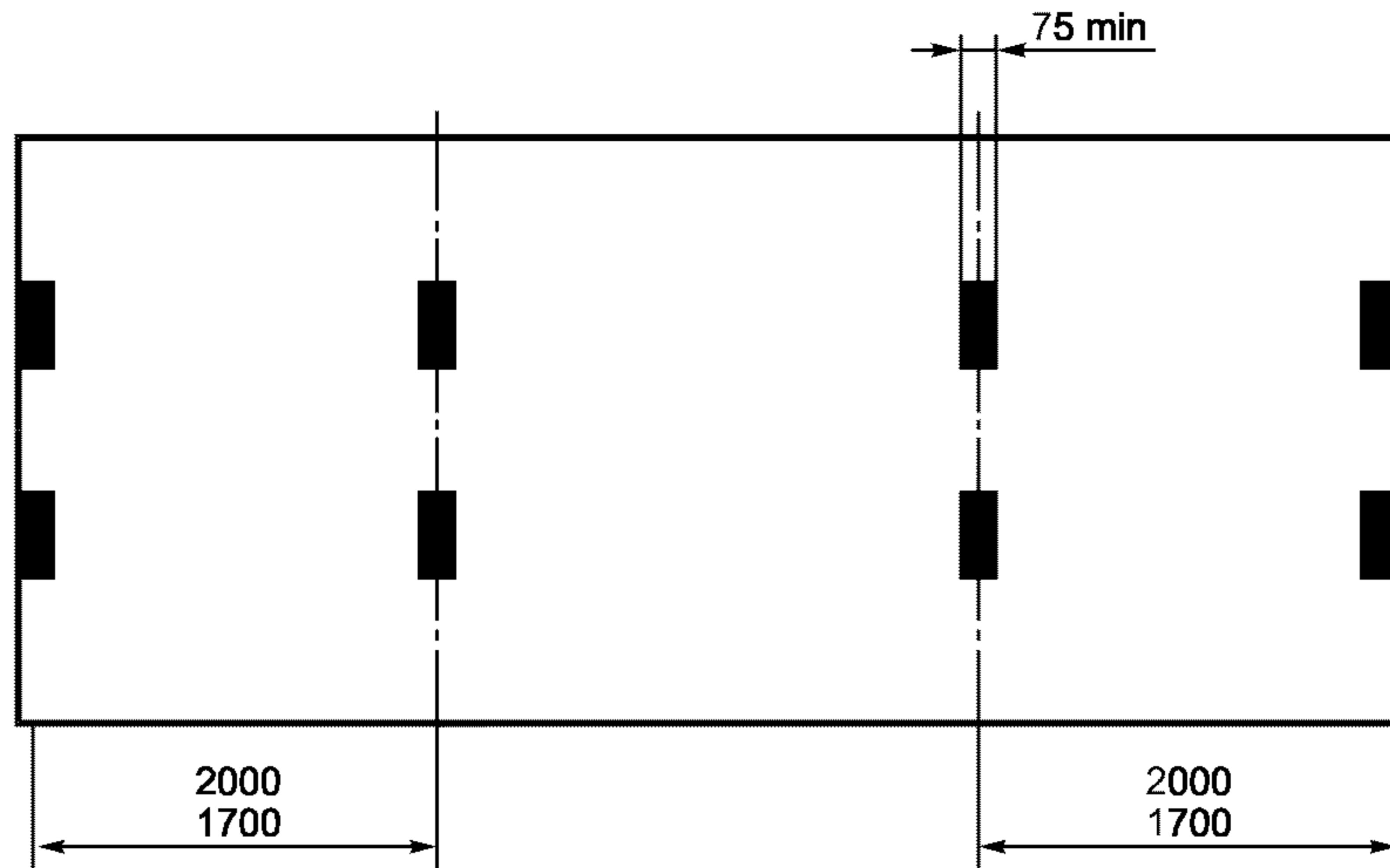
Рисунок Б.2 — Минимальное количество пар опорных (контактных) площадок контейнеров типов 1CCC, 1С и 1CX (при наличии) и контейнеров типов 1 BBB, 1BB, 1B и 1BX
