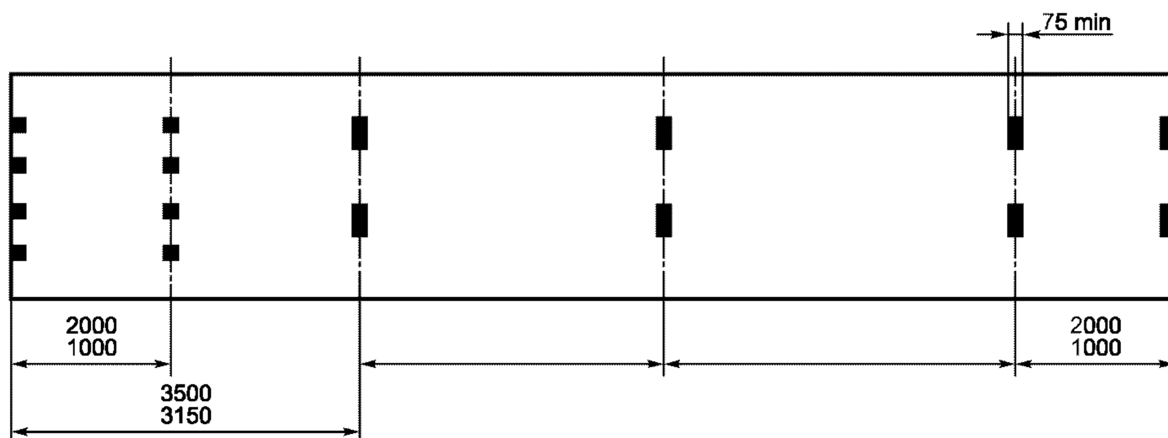
Рисунок Б.4 — Минимальное количество пар опорных (контактных) площадок контейнеров типов 1AAA, 1AA, 1A и 1AX с тоннелем для захвата типа «шея гуся»
