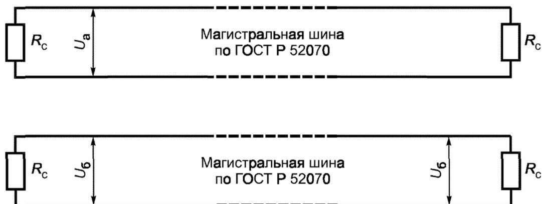
Рисунок 6 — Измерение взаимного влияния магистральных шин
