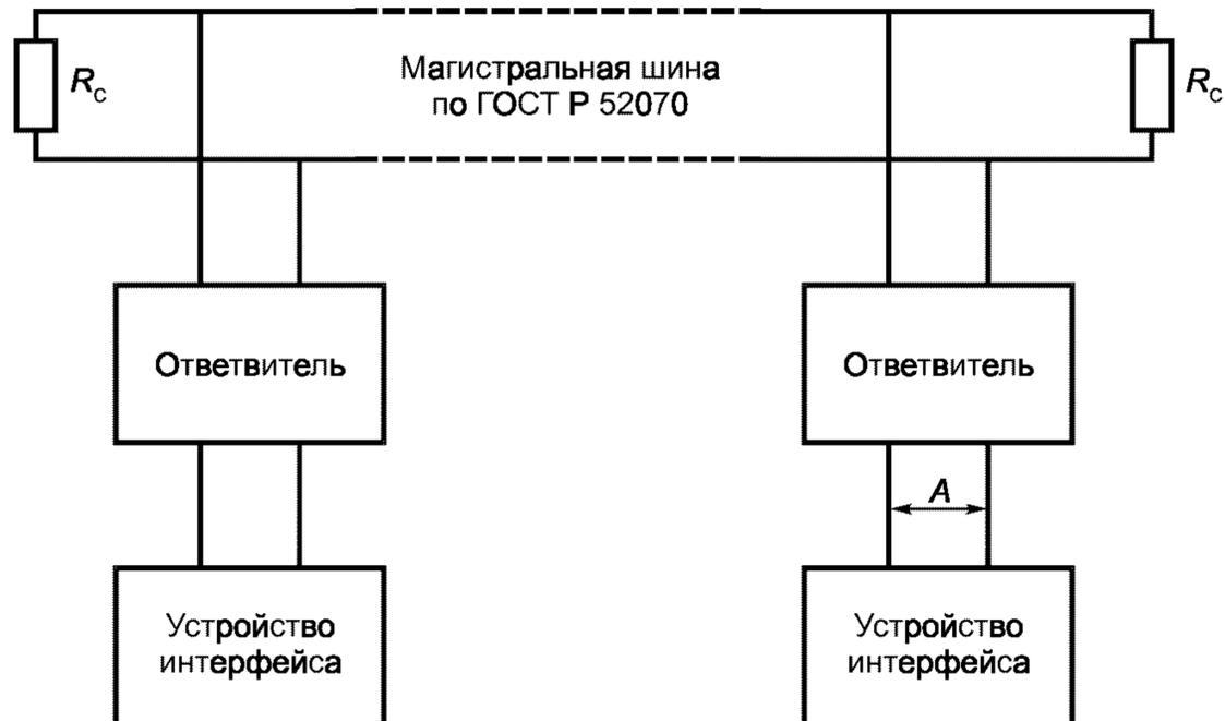
Рисунок 1 — Измерение активного сопротивления ответвителя с трансформаторной связью
