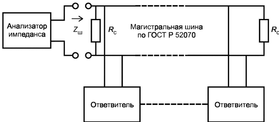
Рисунок 2 — Измерение импеданса магистральной шины
