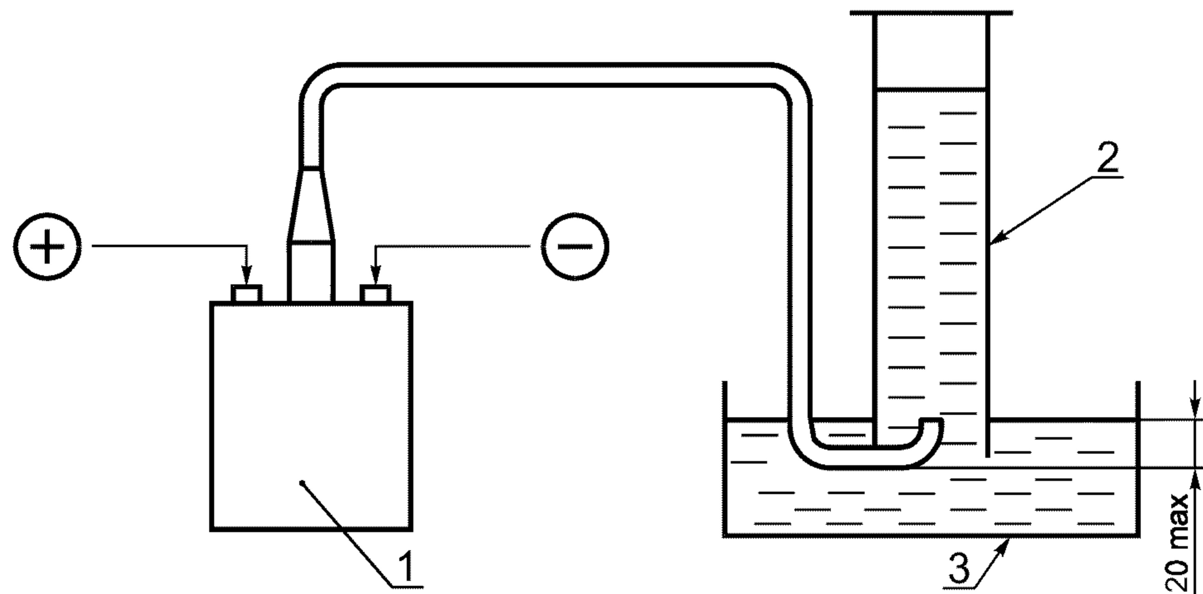
1 — аккумулятор; 2 — измерительный цилиндр; 3 — сосуд с водой
