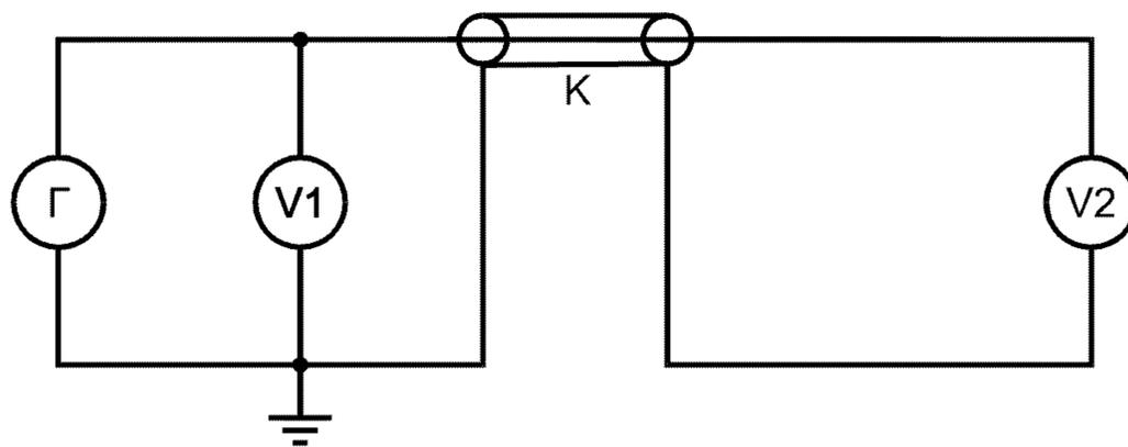
$\Gamma$  — генератор;  $V1, V2$  — вольтметры;  $K$  — кабель
