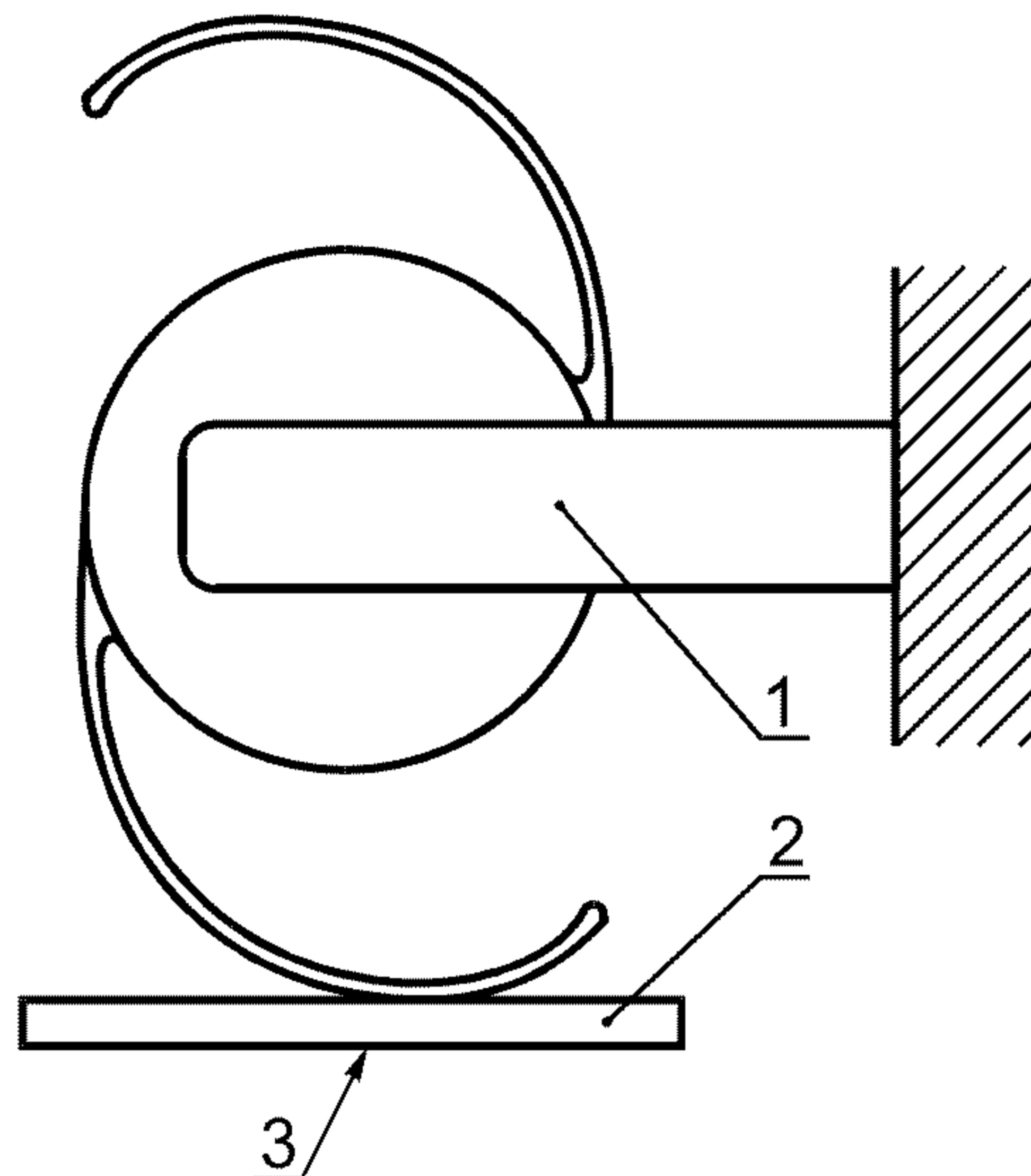
1 — зажим; 2 — испытательная пластина; 3 — линия приложения сжимающей силы
