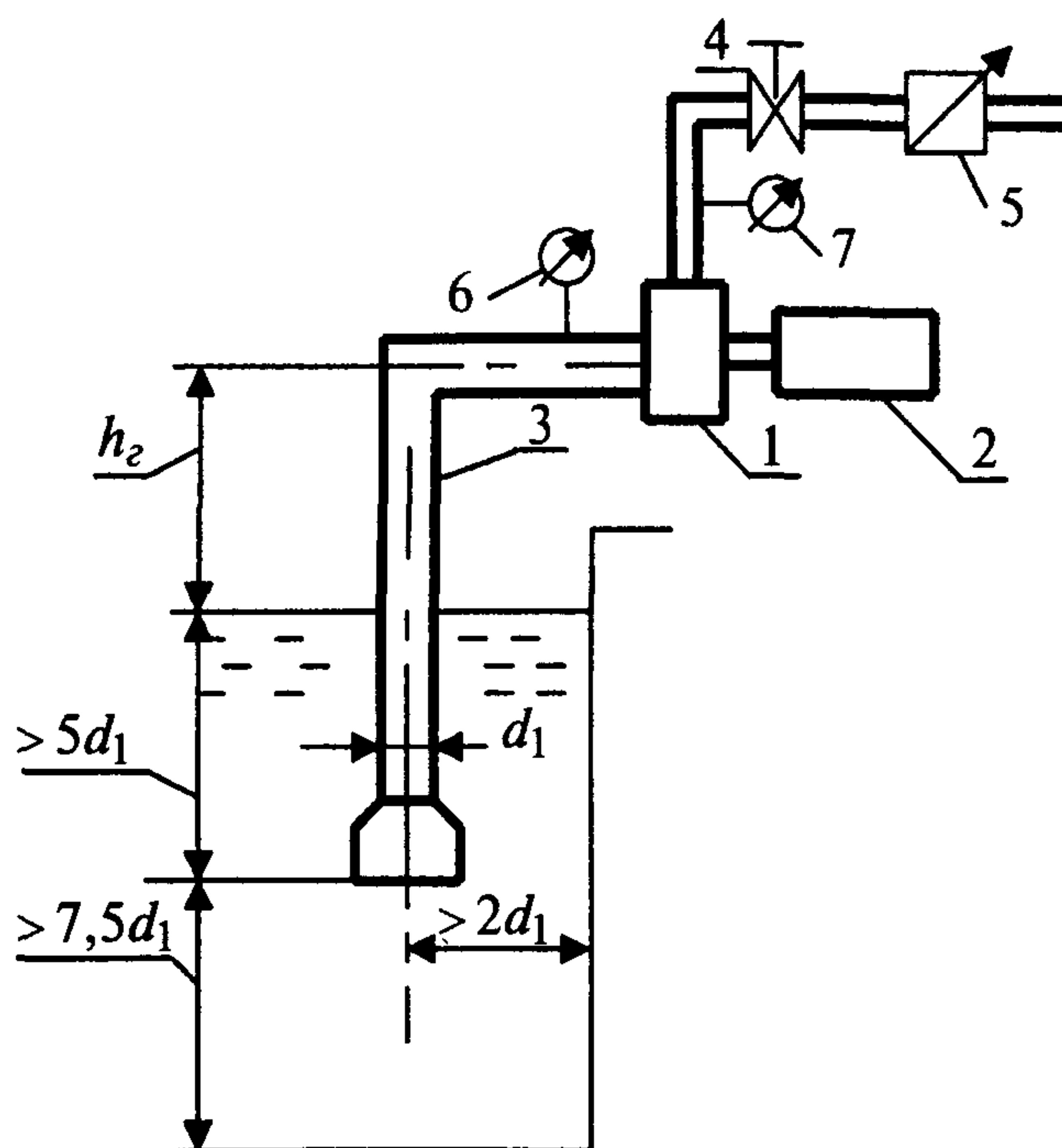
*Схема испытаний мотопомпы:*
