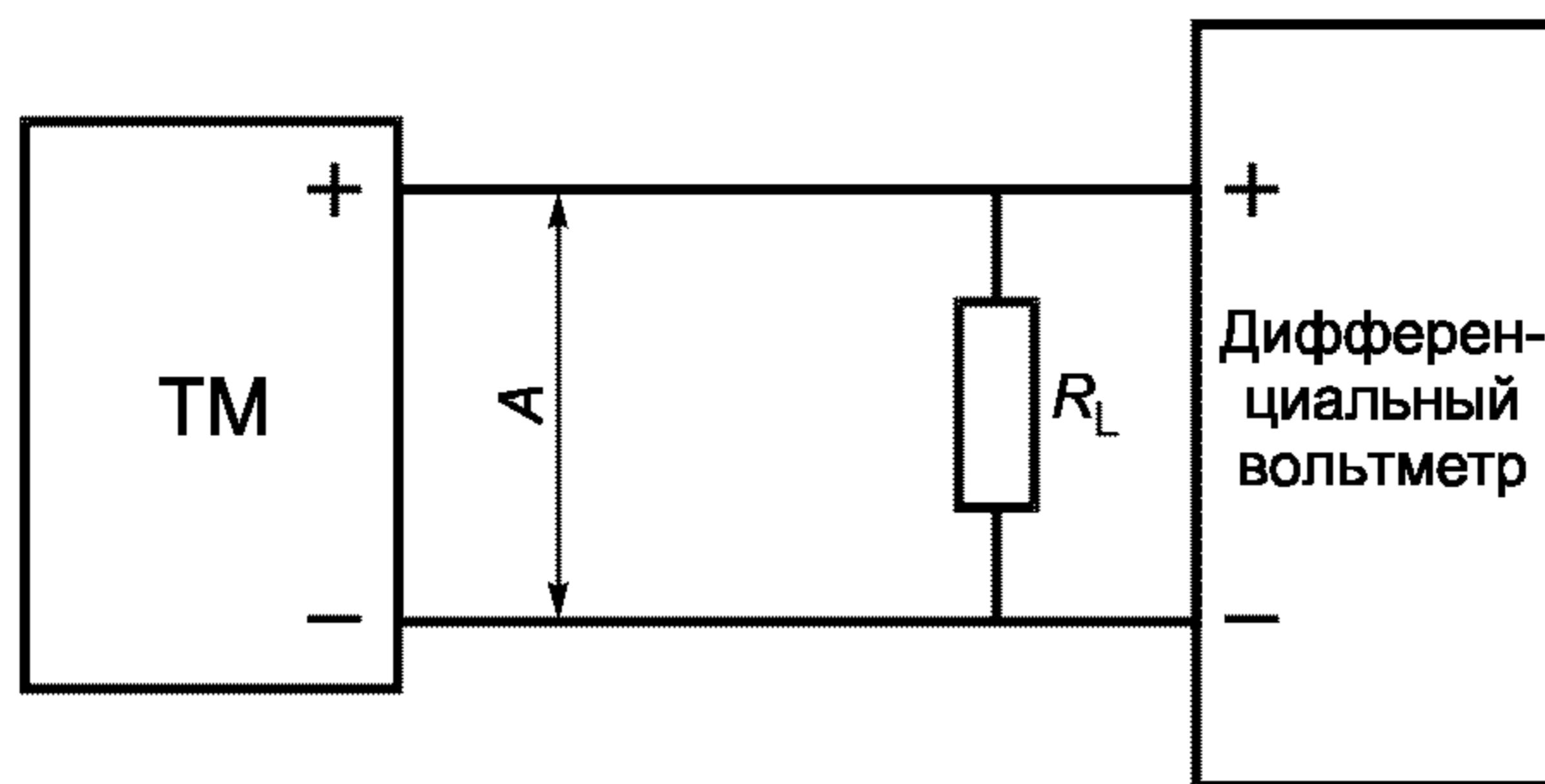
Рисунок 3 — Схема измерения выходного шума ТМ
