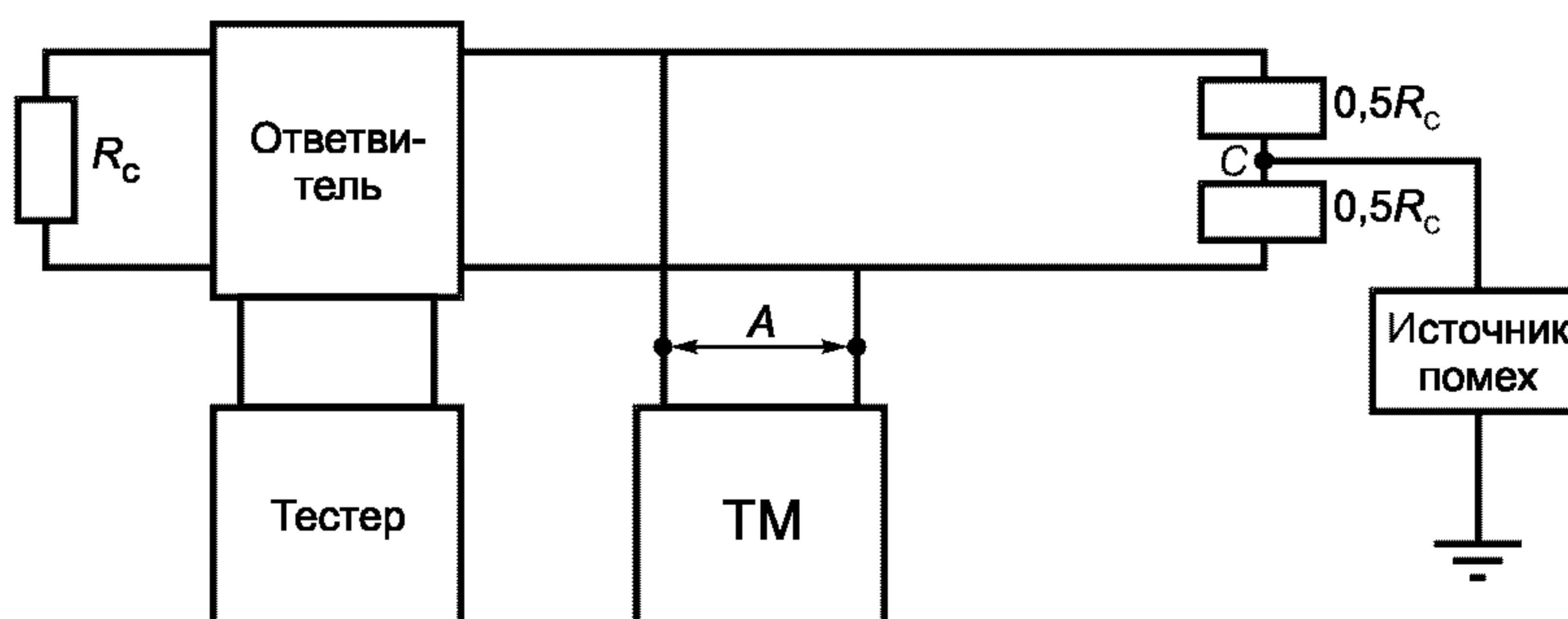
Рисунок 6 — Схема тестирования входного сигнала при синфазных помехах и непосредственном подключении ТМ
