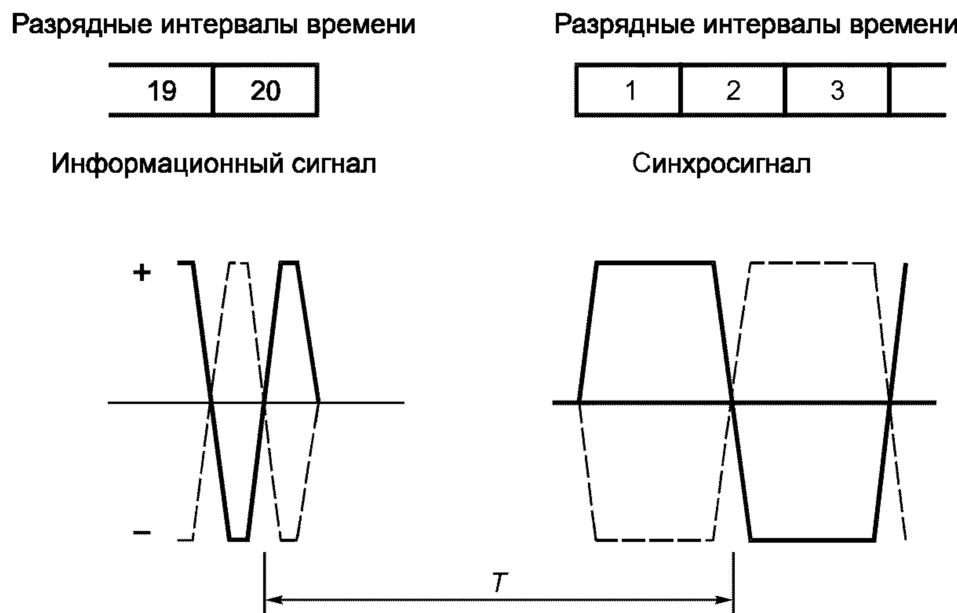
Рисунок 7 — Измерение временных пауз при передаче информации
