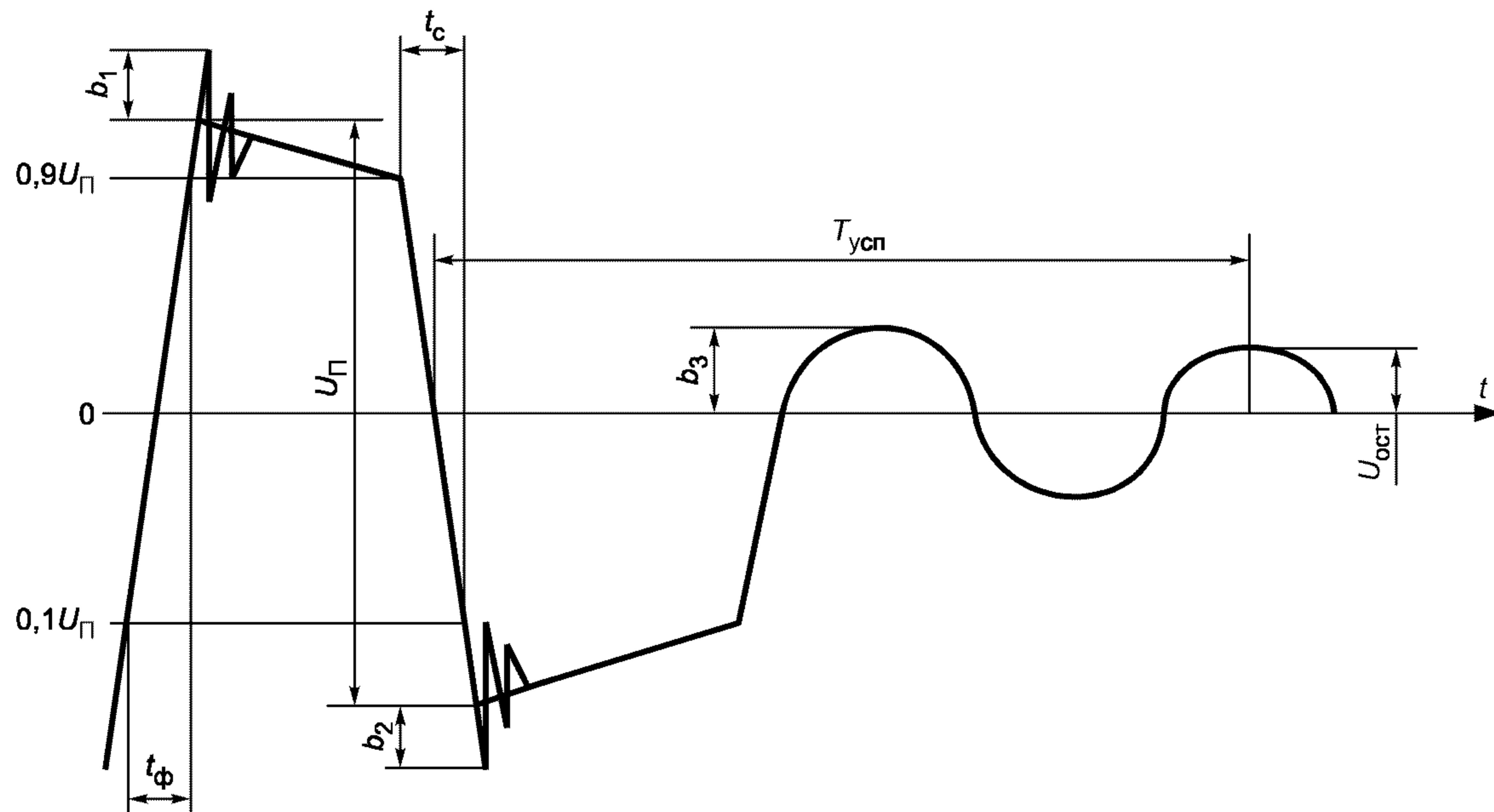
$t_{\phi}$  — длительность фронта сигнала;  $t_c$  — длительность спада сигнала;  $b_1, b_2, b_3$  — выбросы на вершине сигнала и колебания его амплитуды;  $U_{\Pi}$  — размах сигнала;  $T_{yсп}$  — время успокоения линии;  $U_{ост}$  — амплитуда остаточного напряжения
