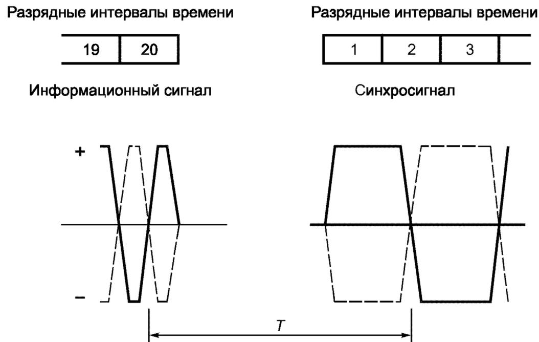
Рисунок 6 — Измерение временных пауз при передаче информации
