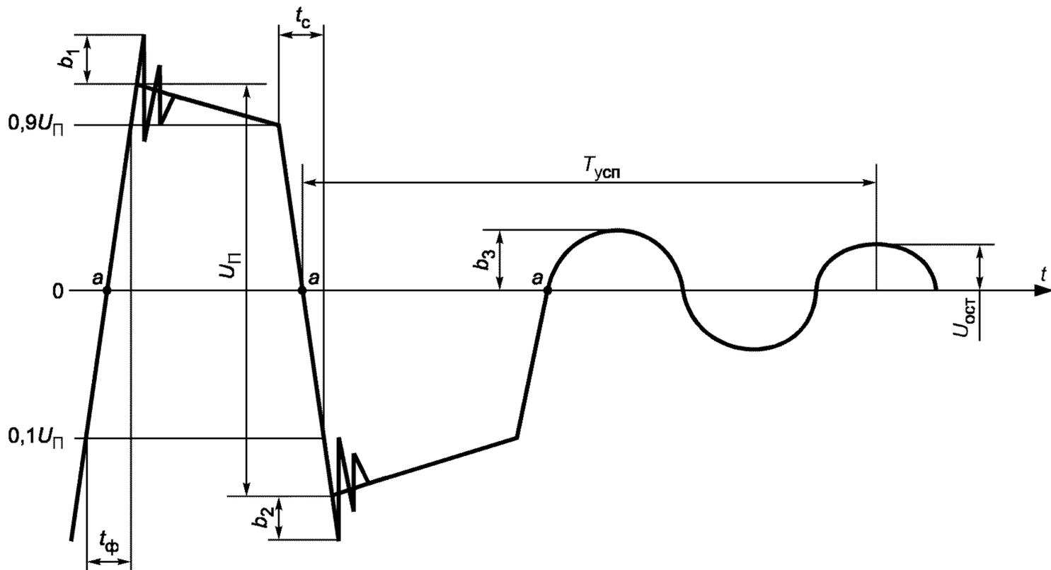
$t_\phi$  — длительность фронта сигнала;  $t_c$  — длительность спада сигнала;  $b_1, b_2, b_3$  — выбросы на вершине сигнала и колебания его амплитуды;  $U_\Pi$  — размах сигнала;  $T_{\text{усп}}$  — время успокоения линии;  $U_{\text{ост}}$  — амплитуда остаточного напряжения;  $a$  — точка перехода сигнала через нулевой уровень (нуль-переход)
