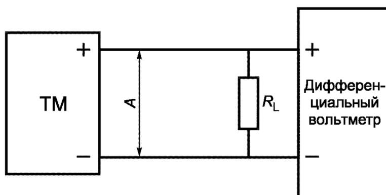
Рисунок 5 — Схема измерения выходного шума ТМ
