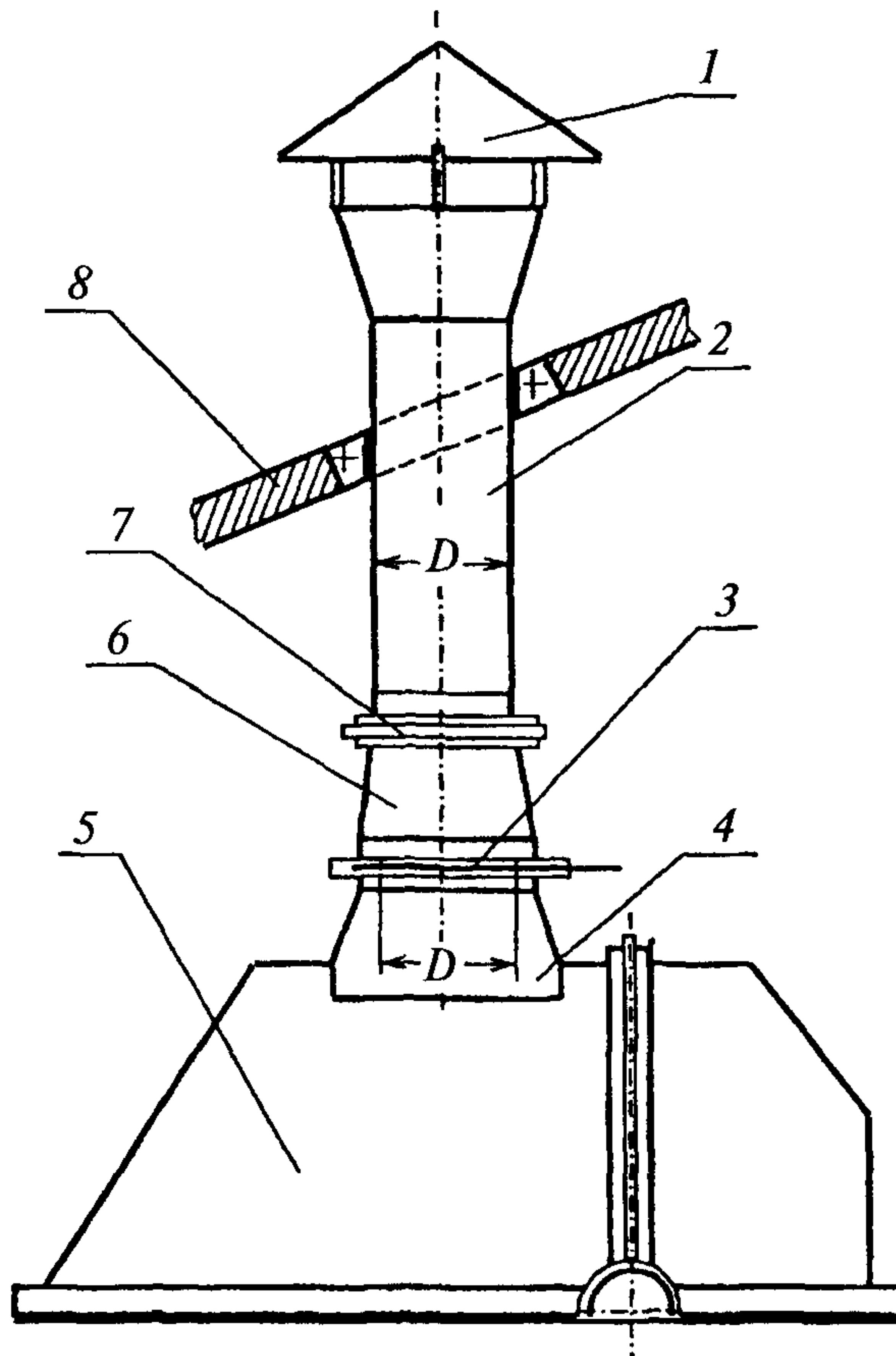
**Рис. 9. Схема расположения на головке нории взрыворазрядного устройства шиберного типа:**
