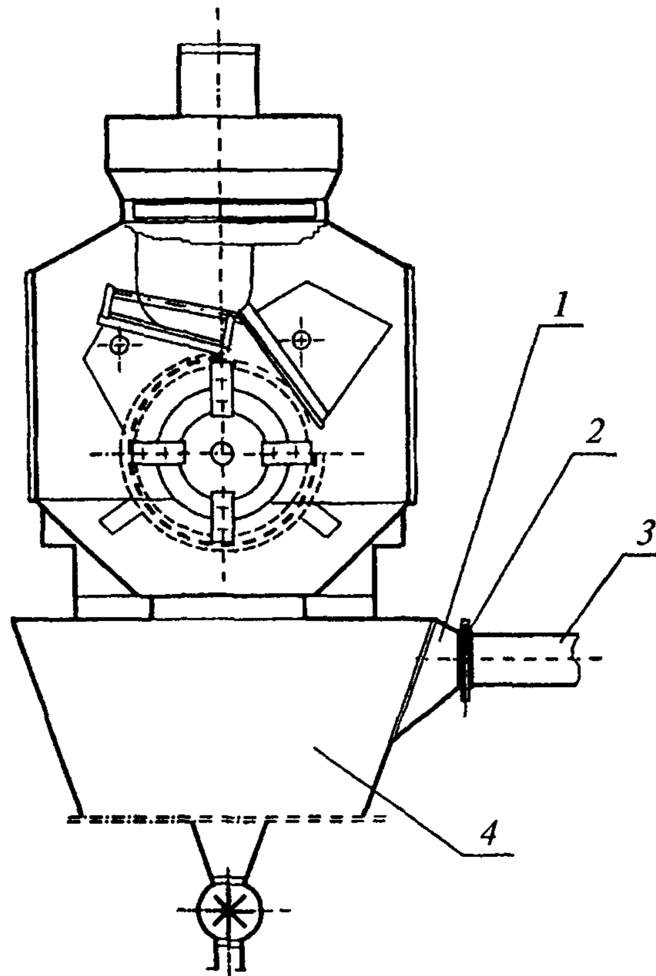
**Рис. 17. Схема расположения взрыворазрядного устройства на поддробильном бункере:**
