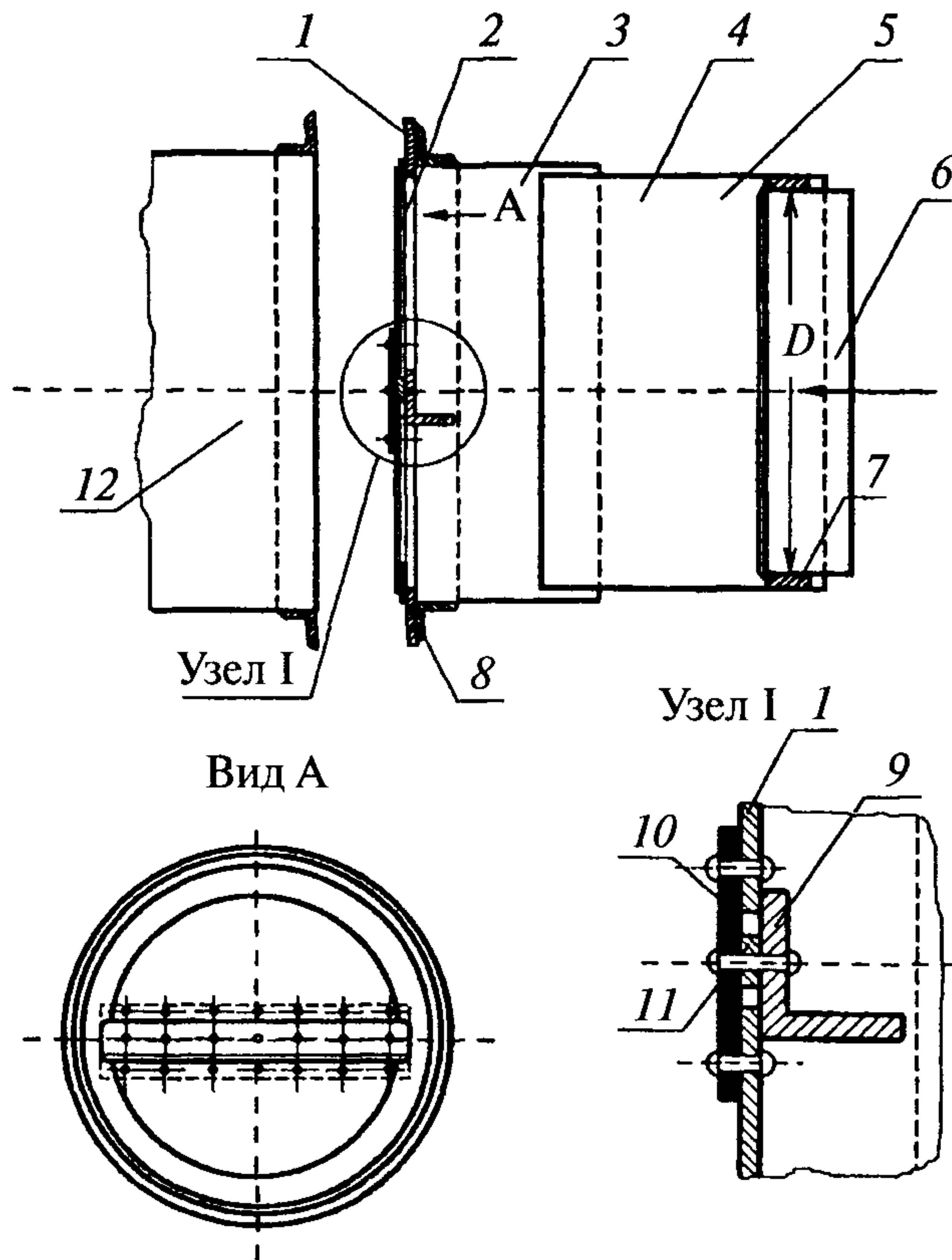
*Примечание.* На схеме ось створчатого клапана условно повернута на  $90^\circ$ , при установке клапана его ось должна располагаться вертикально
