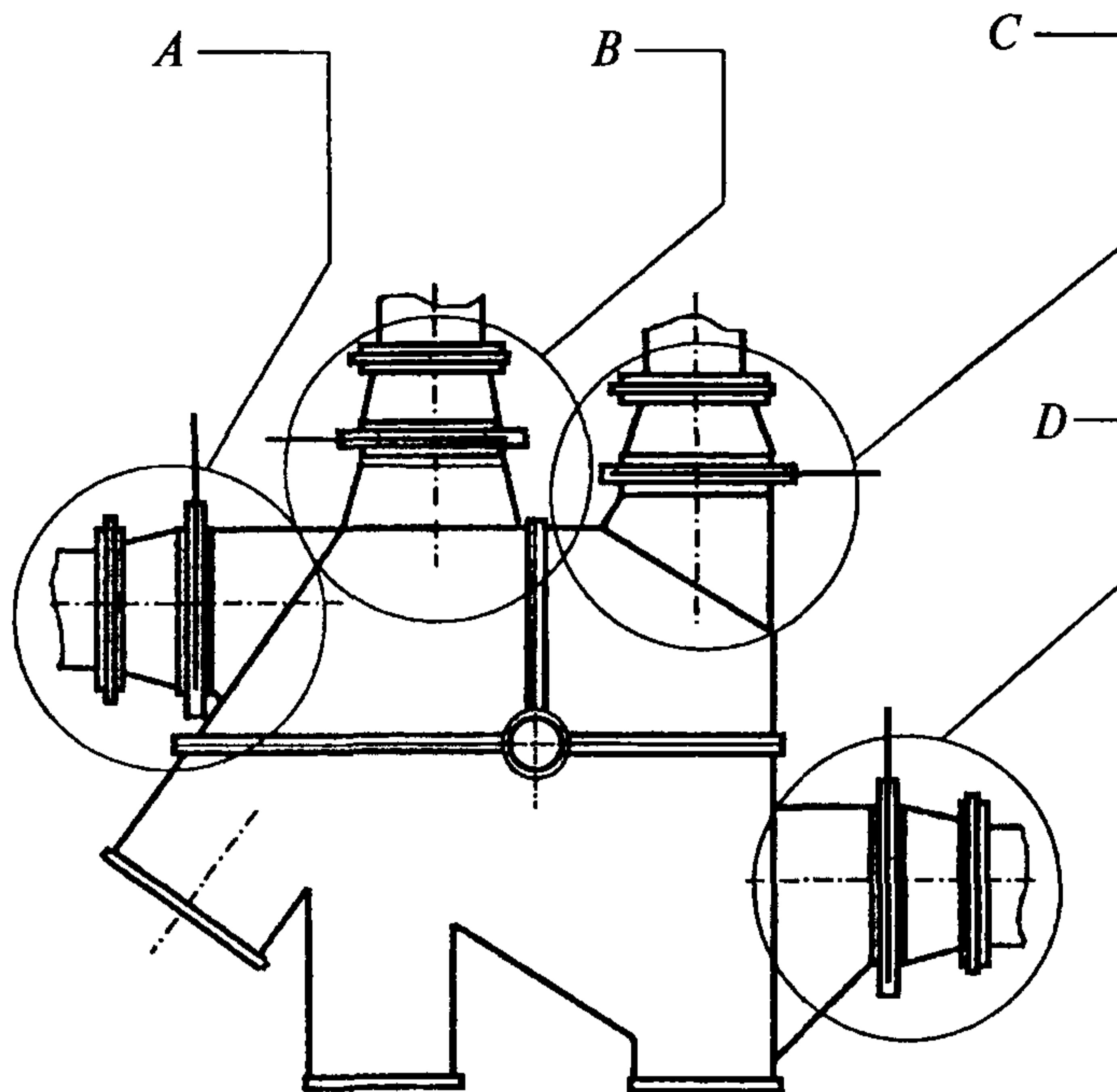
**Рис. 10.** Возможные варианты расположения взрыворазрядных устройств на головке нории с гравитационной разгрузкой:
