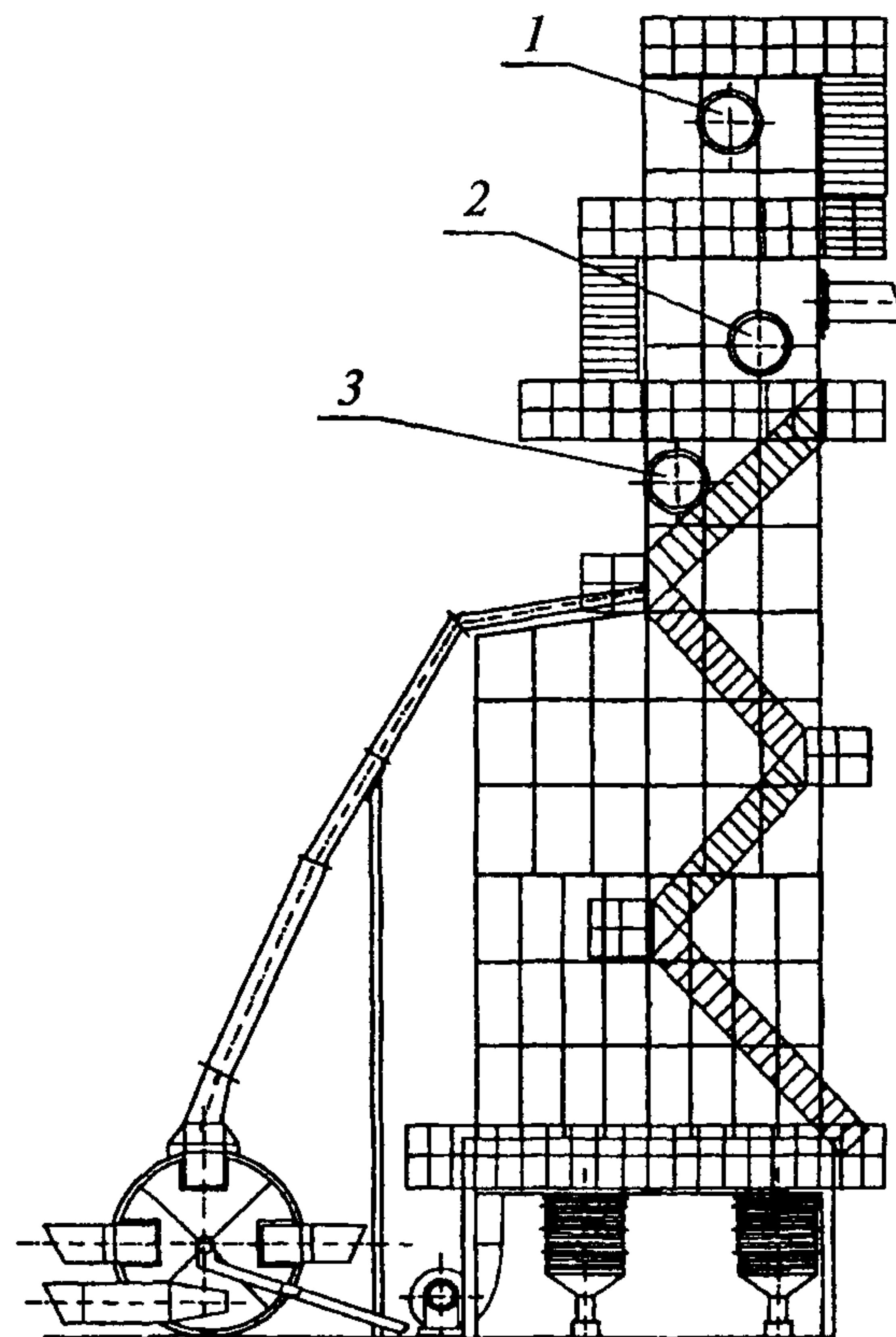
**Рис. 19. Схема расположения взрыворазрядных устройств на зерносушилке РД-2×25-70:**
