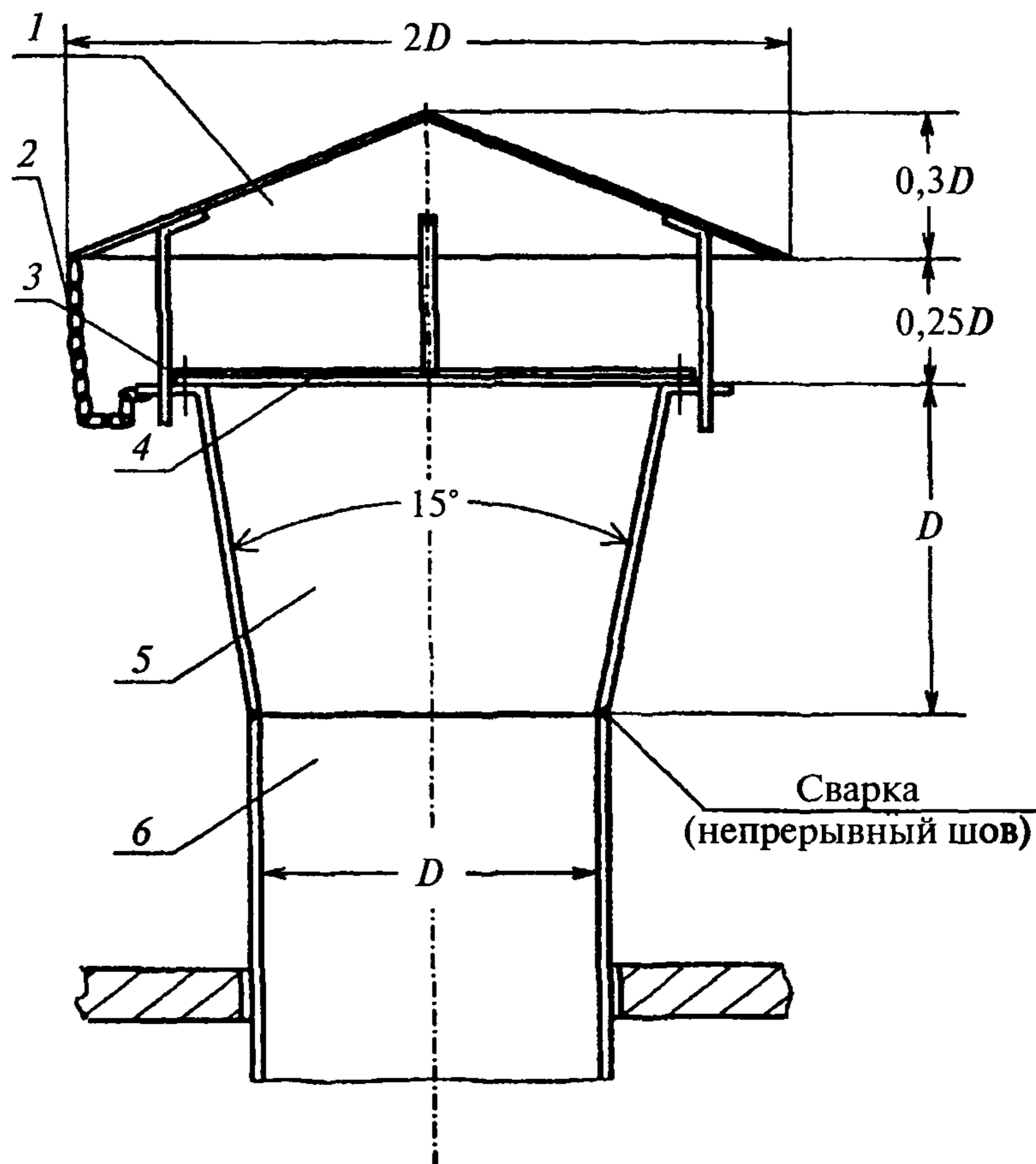
**Рис. 7. Конструктивная схема взрыворазрядного устройства с диффузором на срезе короткого вертикального патрубка:**
