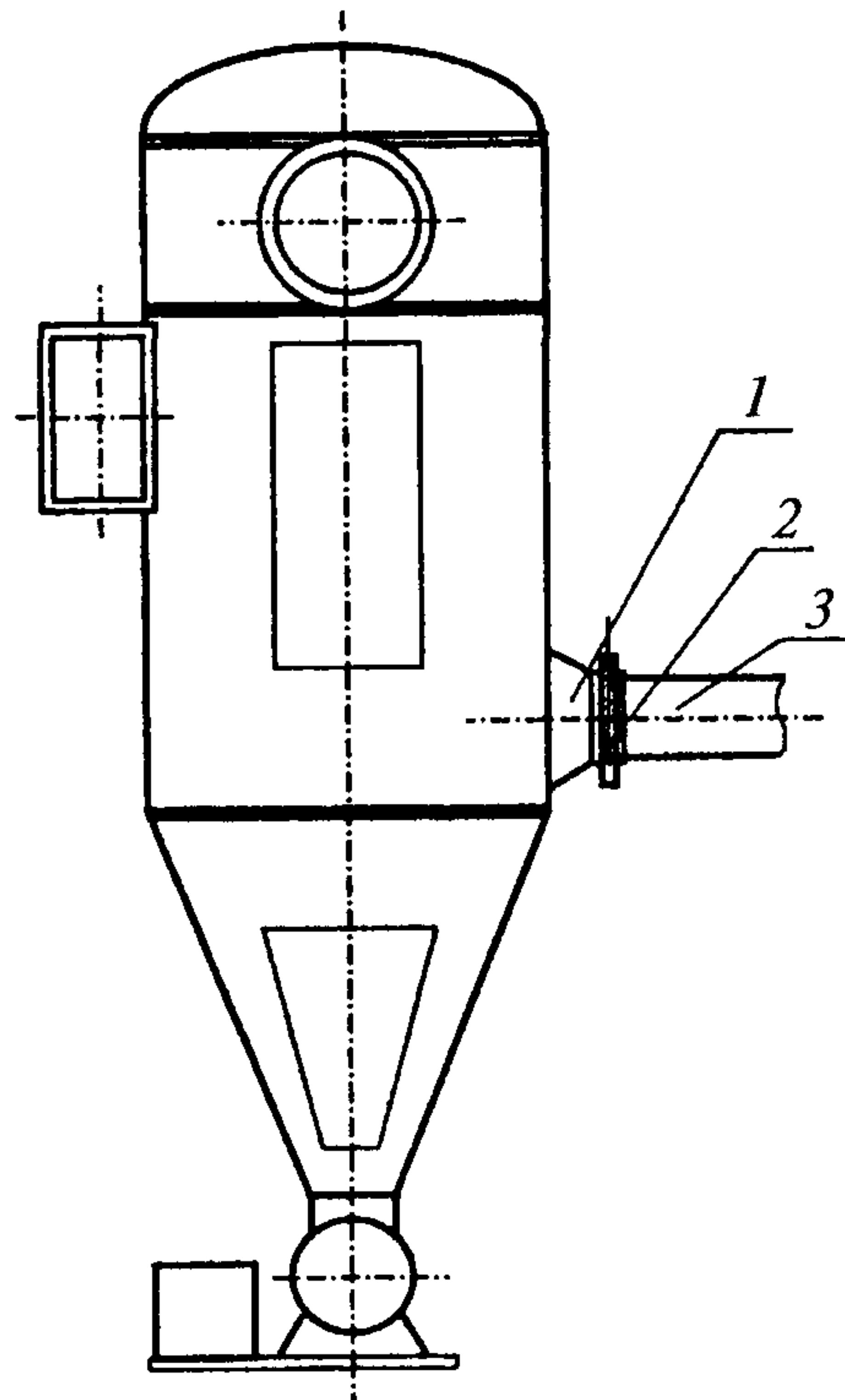
**Рис. 18. Схема расположения взрыворазрядного устройства на фильтр-циклоне:**
