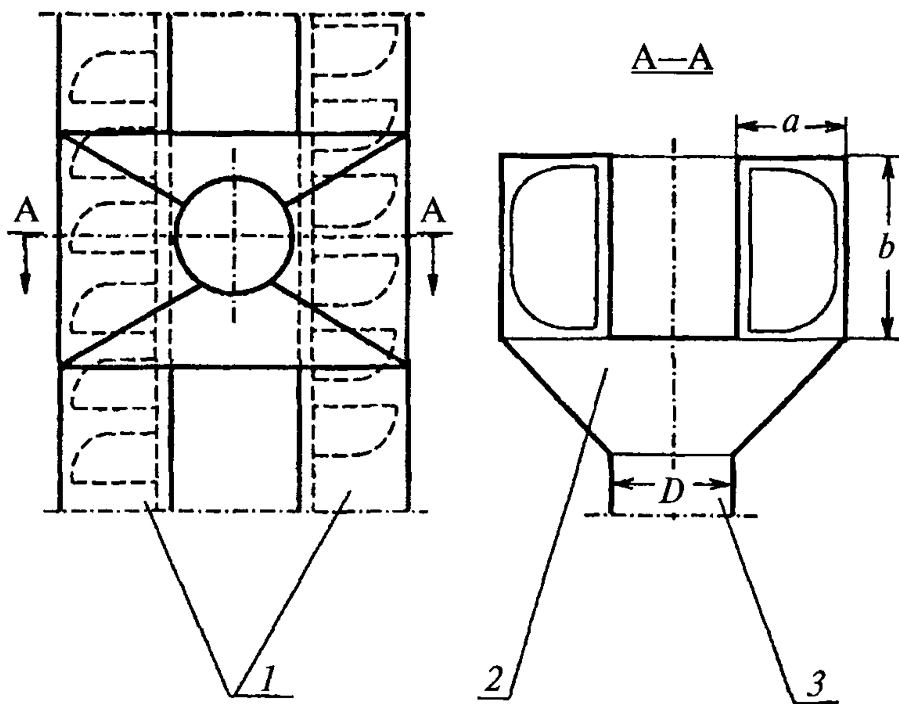
**Примечание.** Диаметр общего взрыворазрядного устройства  $D$  определяется расчетом или из табл. 2 (таблица для головок норий).
