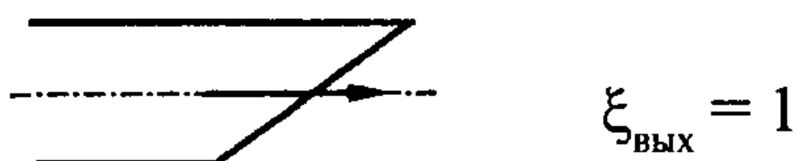
*11. Выход из диффузора с зонтом*
