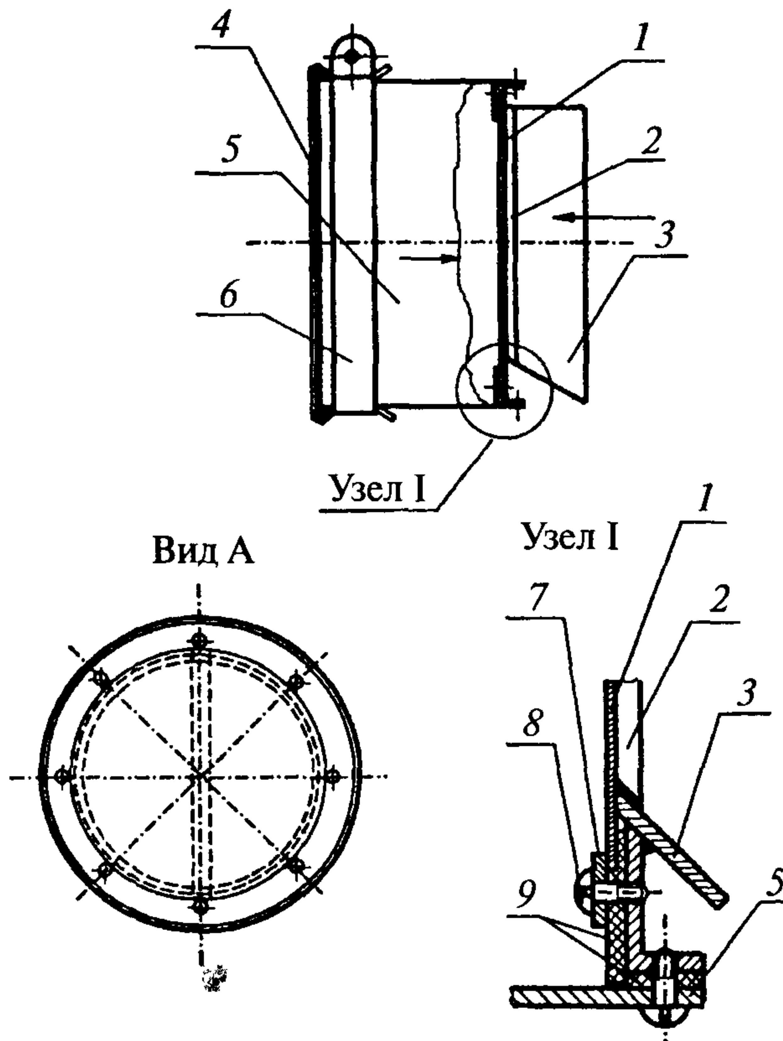
**Рис. 5. Конструктивная схема взрыворазрядного устройства с выщелкивающейся мембраной:**
