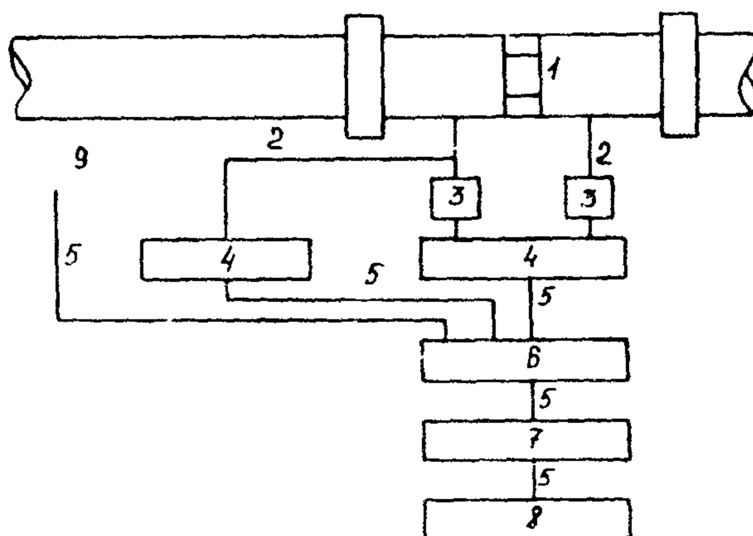
**Рис. 2. Структурная схема измерительной системы с использованием ИИС и ИВК АСУ ТП
