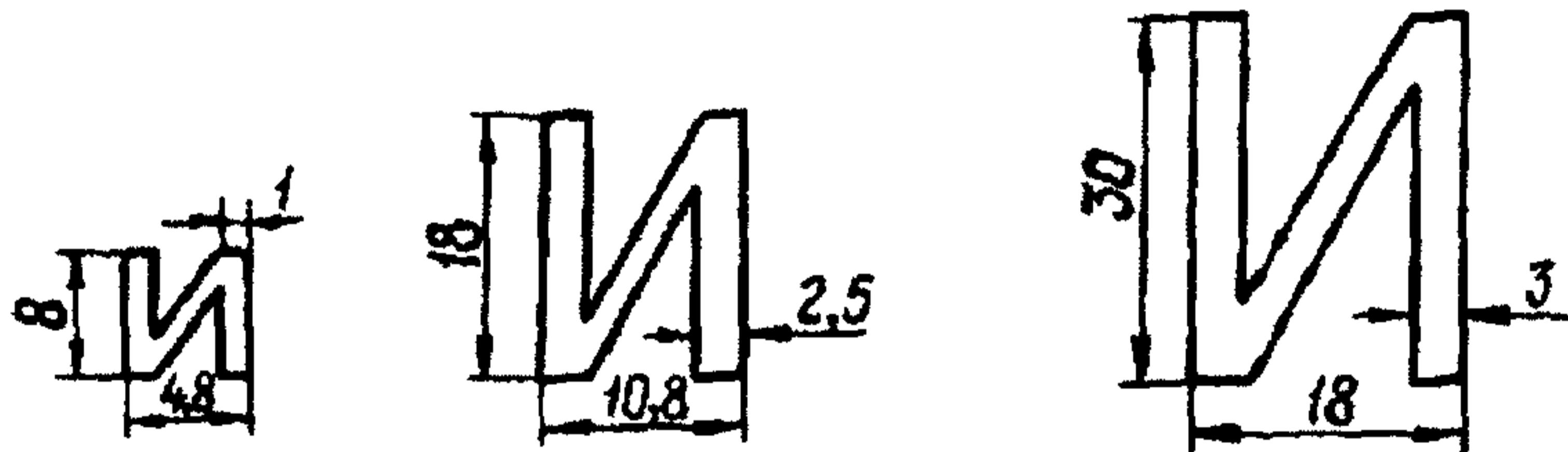
Другие размеры шрифта (толщина контура, ширина обозначения) выбирается по ГОСТ 2930-62 для соответствующей высоты шрифта (8, 18, 30 мм).
