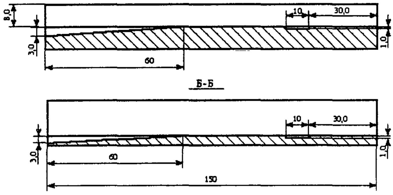
Рисунок 4 — Контрольный образец ОСП-U3x8-20x35x150-P-СтНН
