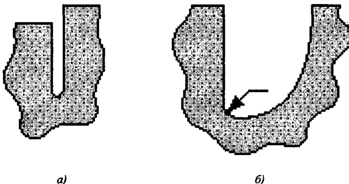
*а*) — тепловая канавка; *б*) — галтельный переход.
