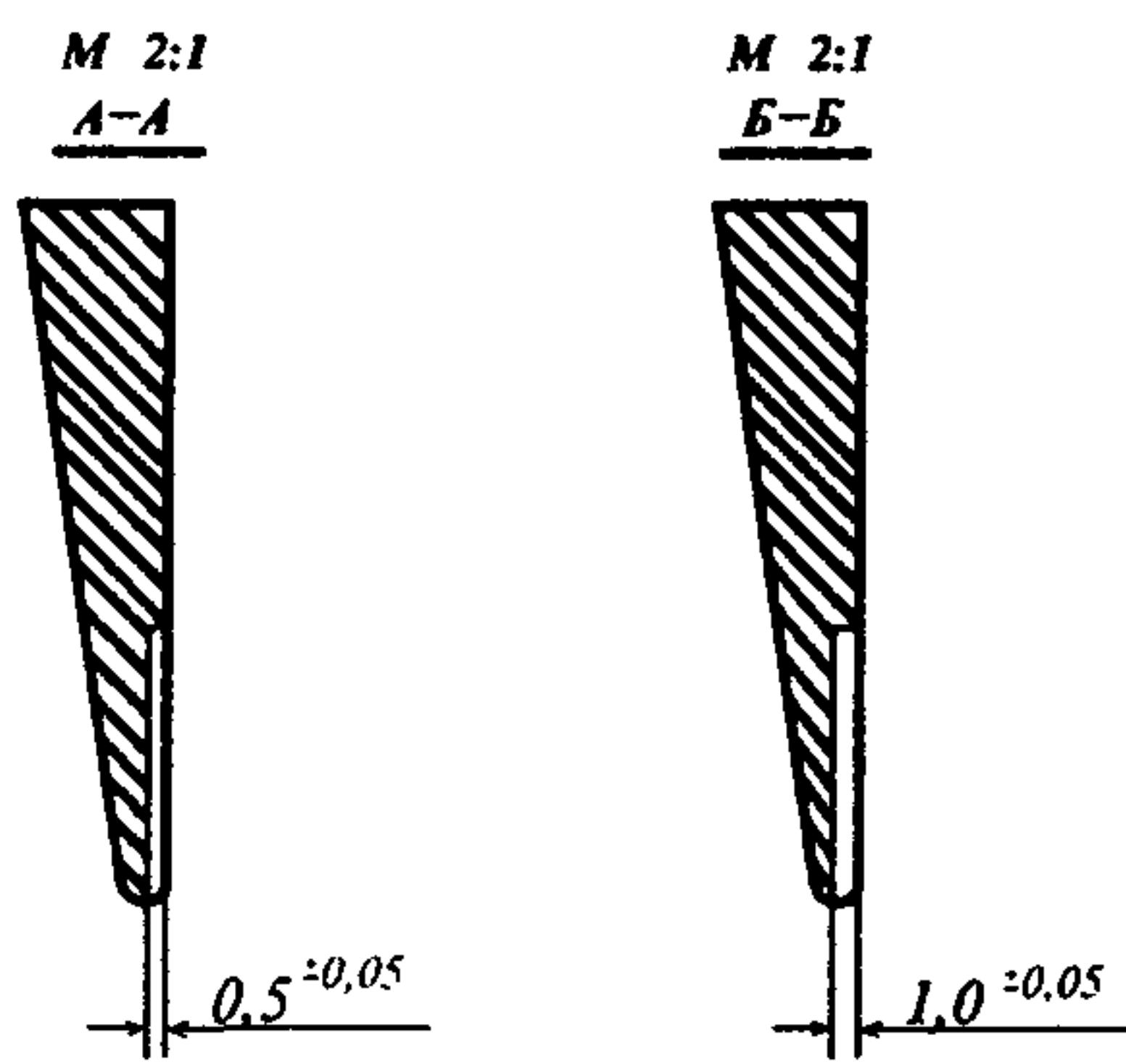
Рисунок 1 — Контрольный образец № 1 с рисками, выходящими на кромку лопатки
