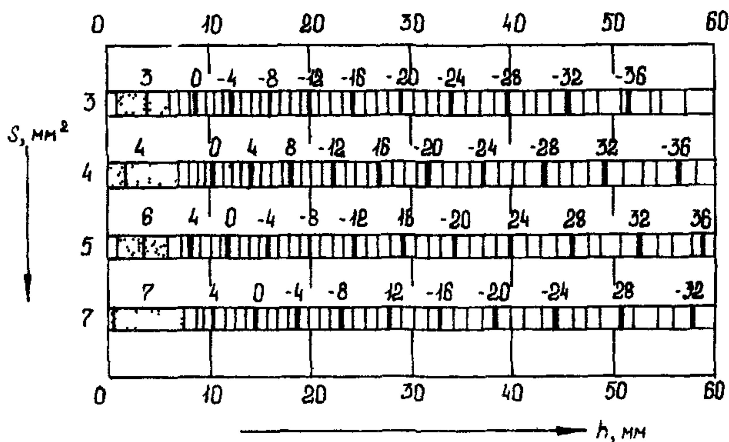
**Рис. 5, м. Разность между браковочным и опорным (по СО-2, глубина залегания отражателя 15 мм) уровнями чувствительности при контроле сварных соединений преобразователями ИЦ, ПНЦ; частота 5,0 МГц; угол ввода 65 град.; площадь пьезоэлемента 40  $\text{мм}^2$ ; коэффициент затухания 0,007 (1/мм)**
