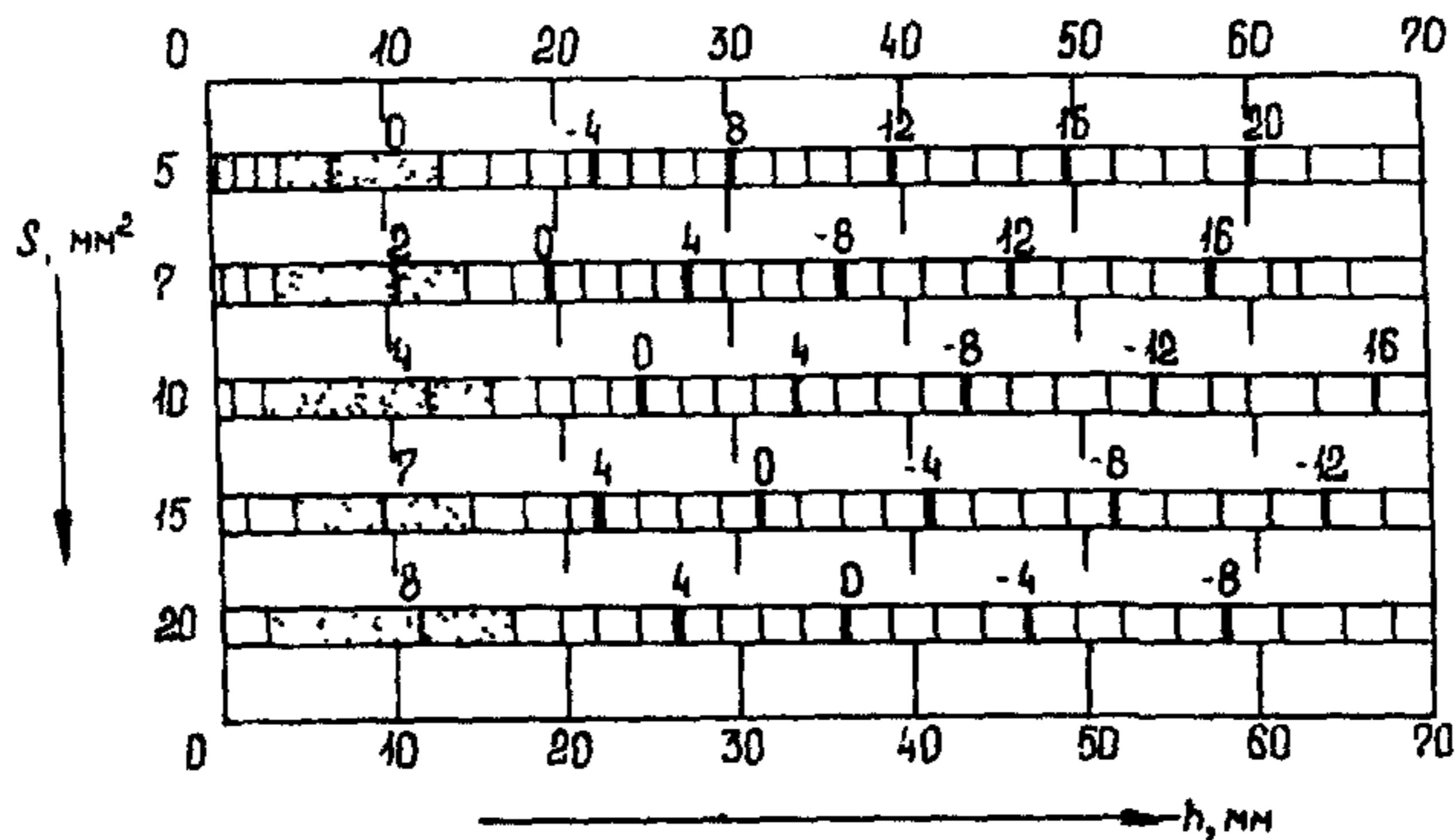
**Рис. 5, и.** Разность между браковочным и опорным (по СО-2, глубина залегания отражателя 44 мм) уровнями чувствительности при контроле сварных соединений преобразователями ПРИЗ-Д5; частота 2,5 МГц; угол ввода 65 град.; площадь пьезоэлемента 192  $\text{мм}^2$ ; коэффициент затухания 0,002 (1/мм)
