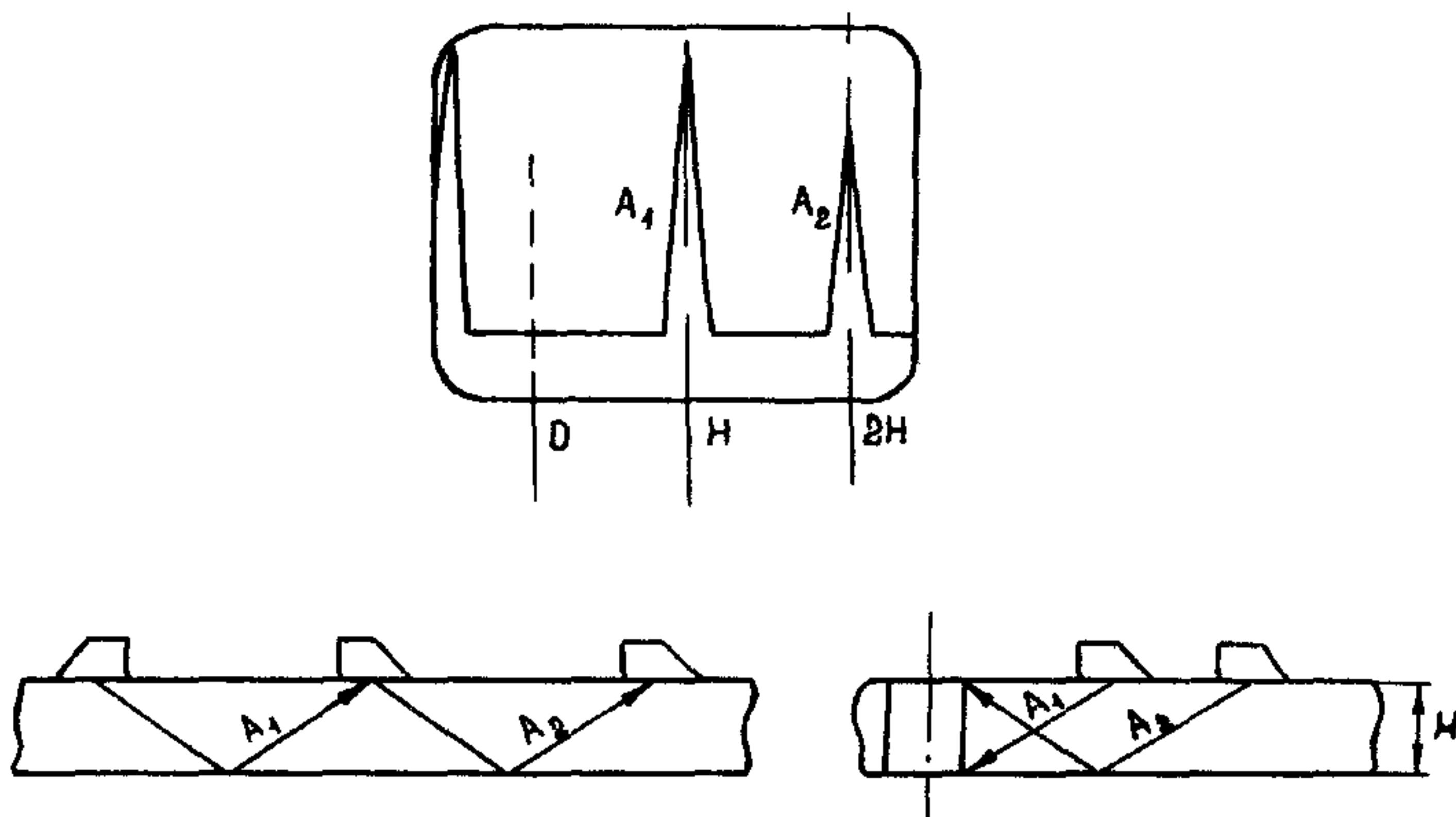
**Рис. 3. Способы безэталонной настройки скорости развертки на контролируемом элементе барабана**
