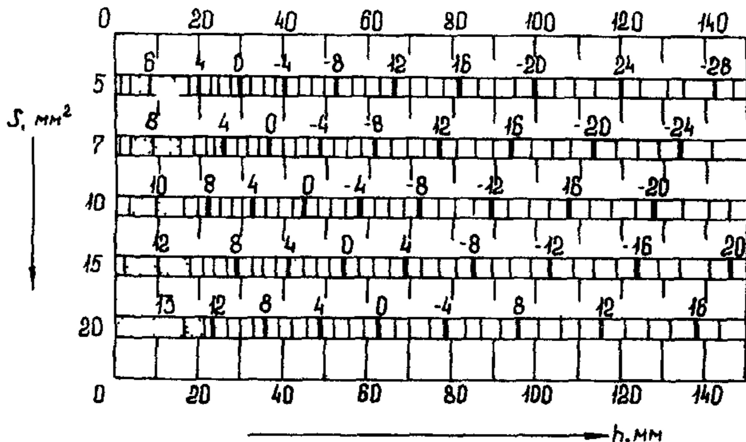
**Рис. 5, в. Разность между браковочным и опорным (по СО-2, глубина залегания отражателя 44 мм) уровнями чувствительности при контроле сварных соединений преобразователями ИЦ, ПНЦ; частота 2,5 МГц; угол ввода 50 град.; площадь пьезоэлемента 113 мм<sup>2</sup>; коэффициент затухания 0,002 (1 м/м)**
