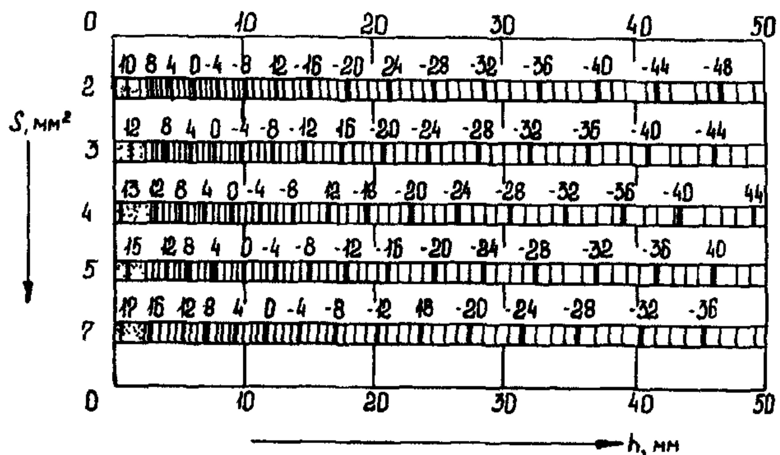
**Рис. 5, н.** Разность между браковочным и опорным (по СО-2, глубина залегания отражателя 15 мм) уровнями чувствительности при контроле сварных соединений преобразователями ИЦ, ПНЦ; частота 5,0 МГц; угол ввода 70 град.; площадь пьезоэлемента 28 мм<sup>2</sup>; коэффициент затухания 0,007 (1/мм)
