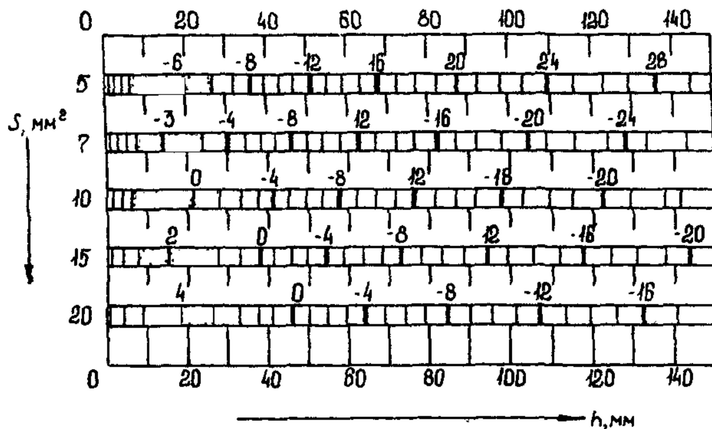
**Рис. 5, а. Разность между браковочным и опорным (по СО-2, глубина залегания отражателя 44 мм) уровнями чувствительности при контроле сварных соединений преобразователями ИЦ, ПНЦ; частота 1,8 МГц; угол ввода 50 град.; площадь пьезоэлемента 254 мм<sup>2</sup>; коэффициент затухания 0,001 (1/мм)**
