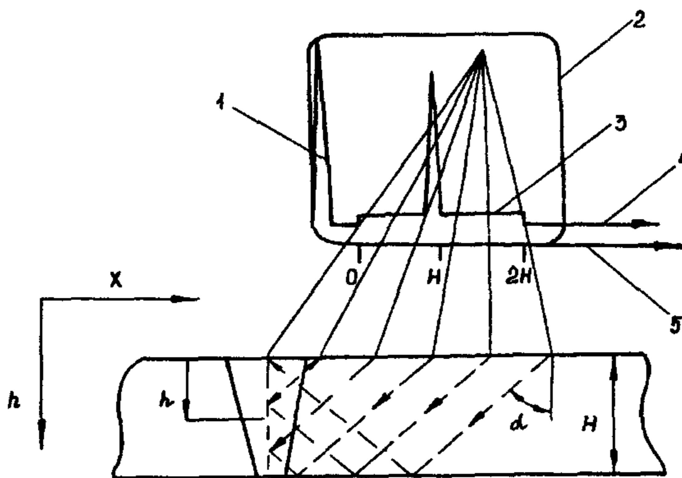
**Рис. 1. Принцип настройки скорости развертки дефектоскопа:**
