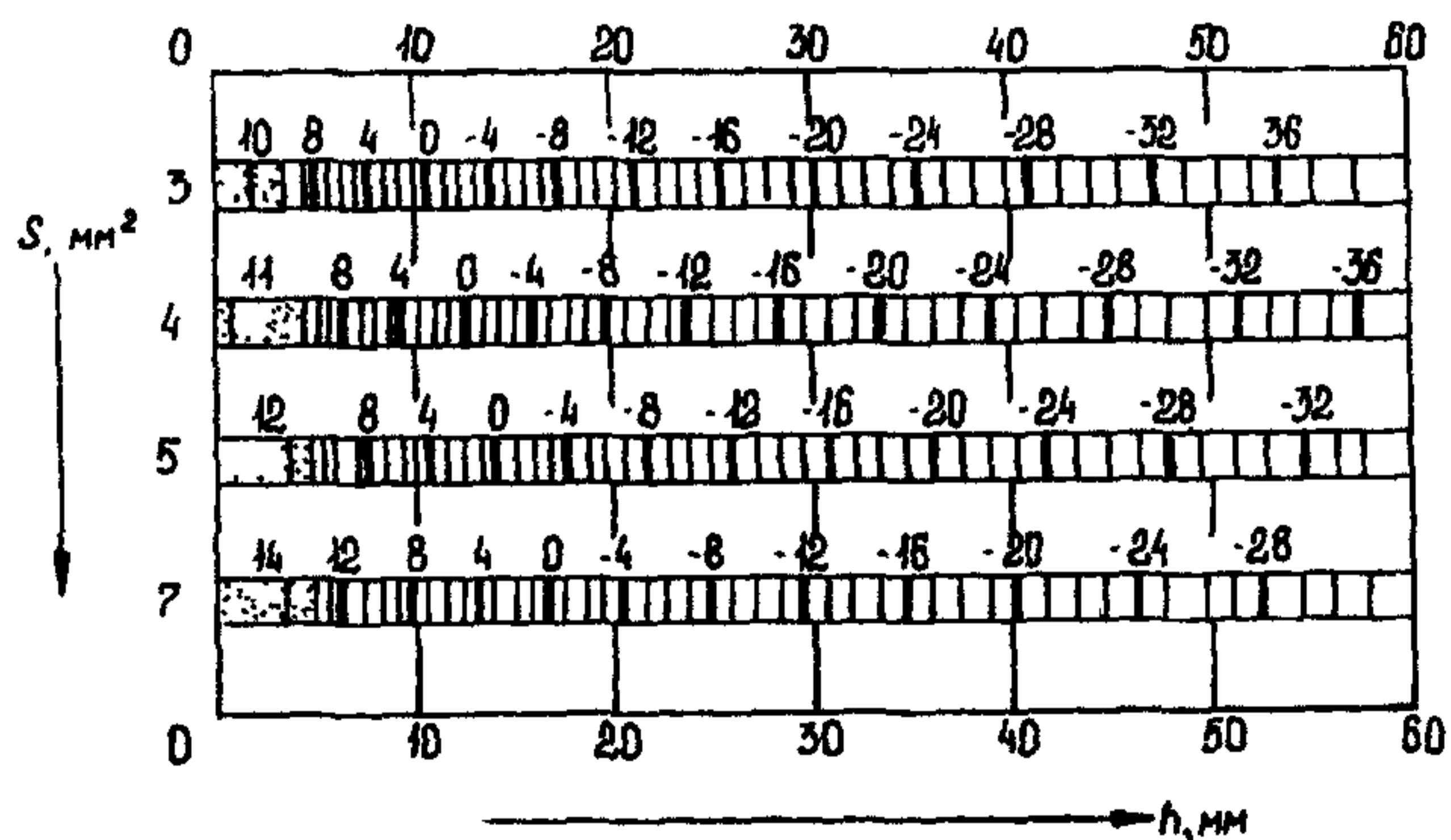
**Рис. 5, о.** Разность между браковочным и опорным (по СО-2, глубина залегания отражателя 15 мм) уровнями чувствительности при контроле сварных соединений преобразователями ИЦ, ПНЦ; частота 5,0 МГц; угол ввода 65 град.; площадь пьезоэлемента 28 мм<sup>2</sup>; коэффициент затухания 0,007 (1/мм)
