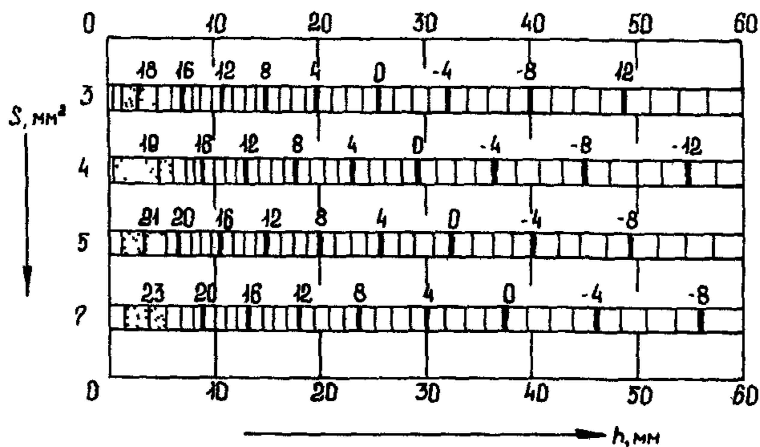
**Рис. 5, к.** Разность между браковочным и опорным (по СО-2, глубина залегания отражателя 44 мм) уровнями чувствительности при контроле сварных соединений преобразователями ПРИЗ-Д6; частота 2,5 МГц; угол ввода 65 град.; площадь пьезоэлемента 80  $\text{мм}^2$ ; коэффициент затухания 0,002 (1/мм)
