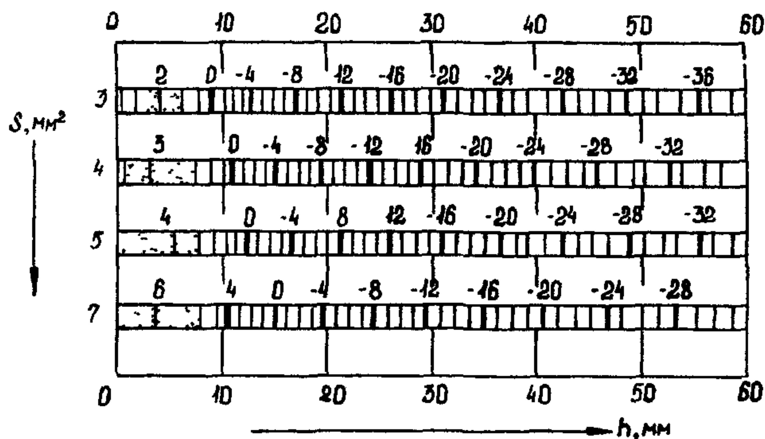
**Рис. 5, л. Разность между браковочным и опорным (по СО-2, глубина залегания отражателя 15 мм) уровнями чувствительности при контроле сварных соединений преобразователями ПРИЗ-Д6; частота 5,0 МГц; угол ввода 65 град.; площадь пьезоэлемента 50  $\text{мм}^2$ ; коэффициент затухания 0,007 (1/мм)**
