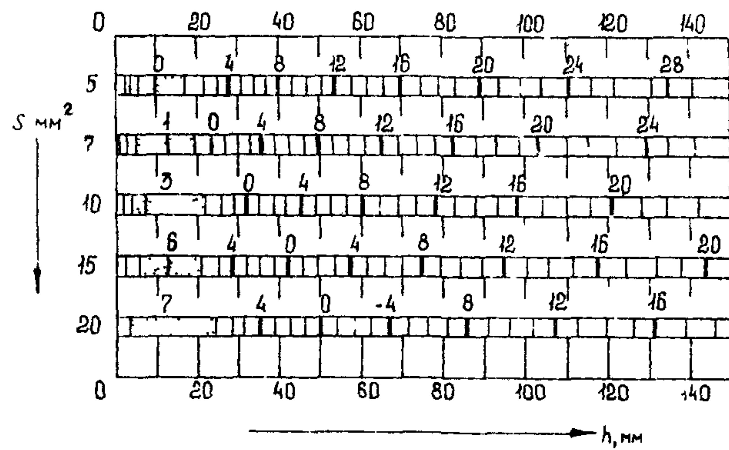
**Рис. 5, е. Разность между браковочным и опорным (по СО-2, глубина залегания отражателя 44 мм) уровнями чувствительности при контроле сварных соединений преобразователями ПРИЗ-Д5; частота 1,8 МГц; угол ввода 50 град.; площадь пьезоэлемента 192 мм<sup>2</sup>; коэффициент затухания 0,001 (1/мм)**
