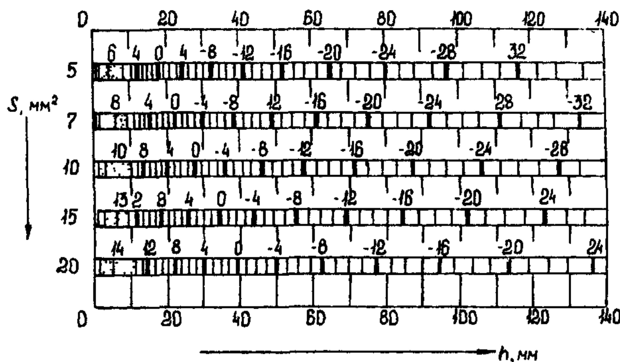
**Рис. 5, ж.** Разность между браковочным и опорным (по СО-2, глубина залегания отражателя 44 мм) уровнями чувствительности при контроле сварных соединений преобразователями ПРИЗ-Д5; частота 1,8 МГц; угол ввода 65 град.; площадь пьезоэлемента 192 мм<sup>2</sup>; коэффициент затухания 0,001 (1/мм)
