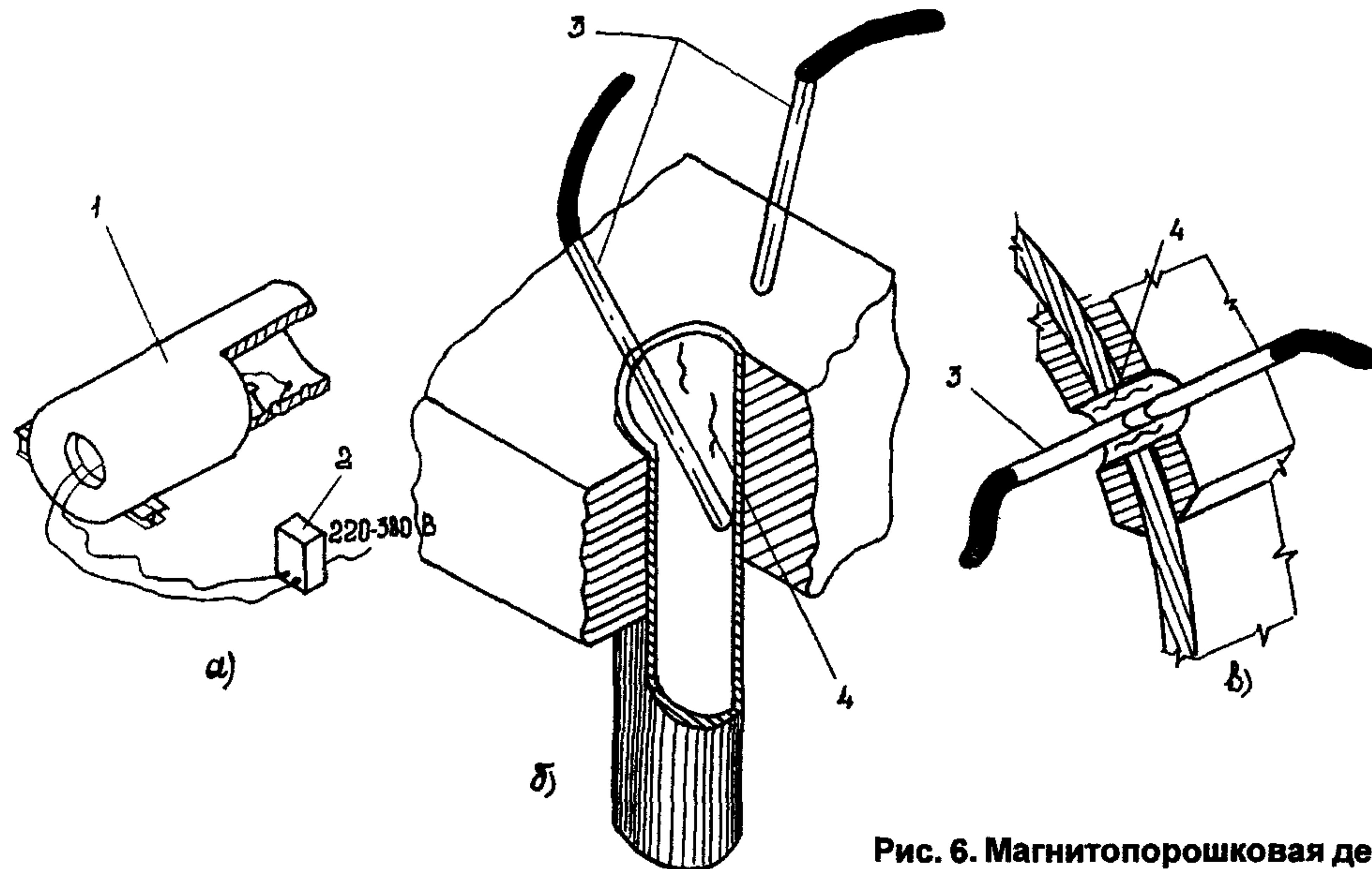
**Рис. 6. Магнитопорошковая дефектоскопия
