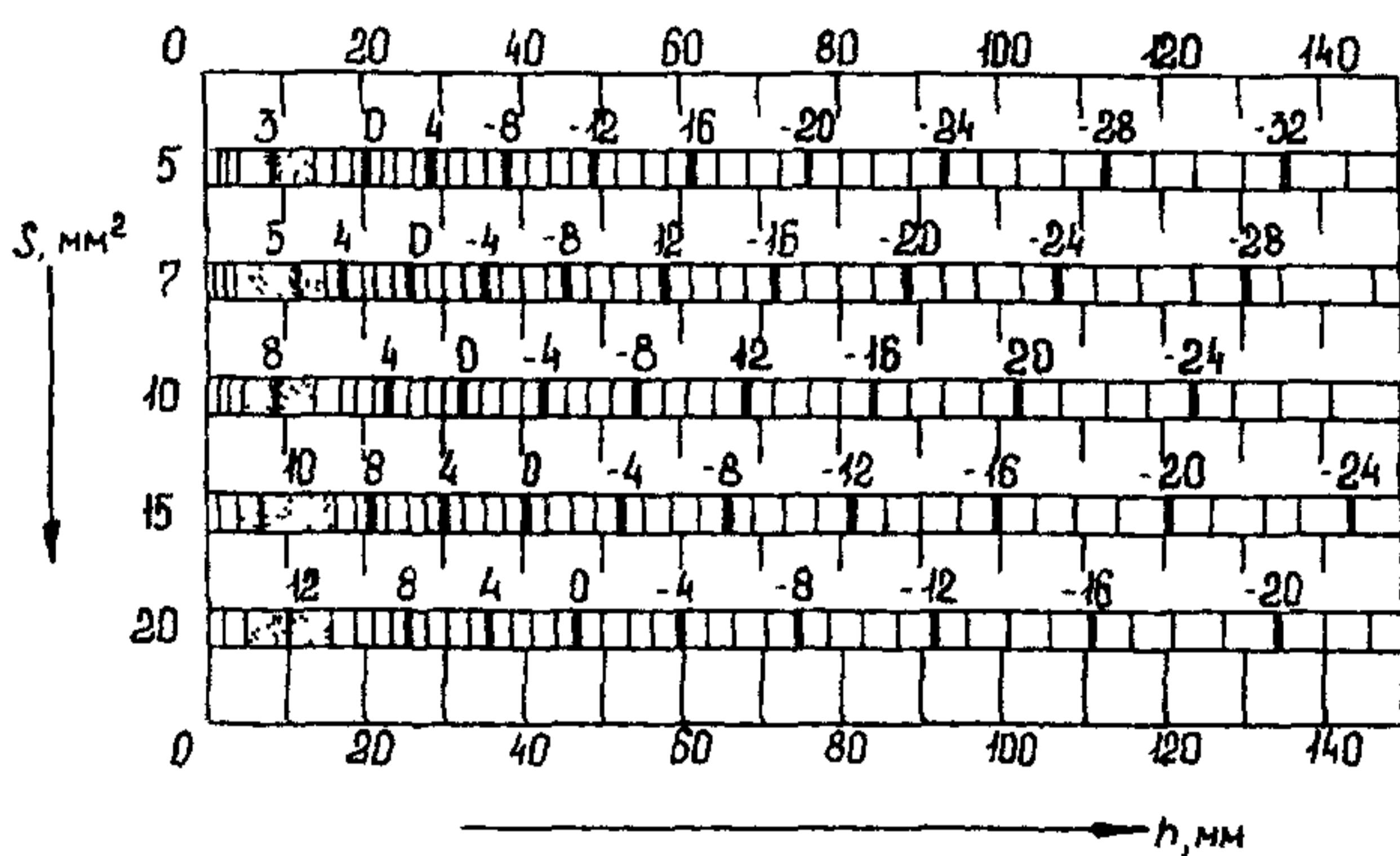
**Рис. 5, б. Разность между браковочным и опорным (по СО-2, глубина залегания отражателя 44 мм) уровнями чувствительности при контроле сварных соединений преобразователями ИЦ, ПНЦ; частота 1,8 МГц; угол ввода 65 град.; площадь пьезоэлемента 254 мм<sup>2</sup>; коэффициент затухания 0,001 (1/мм)**
