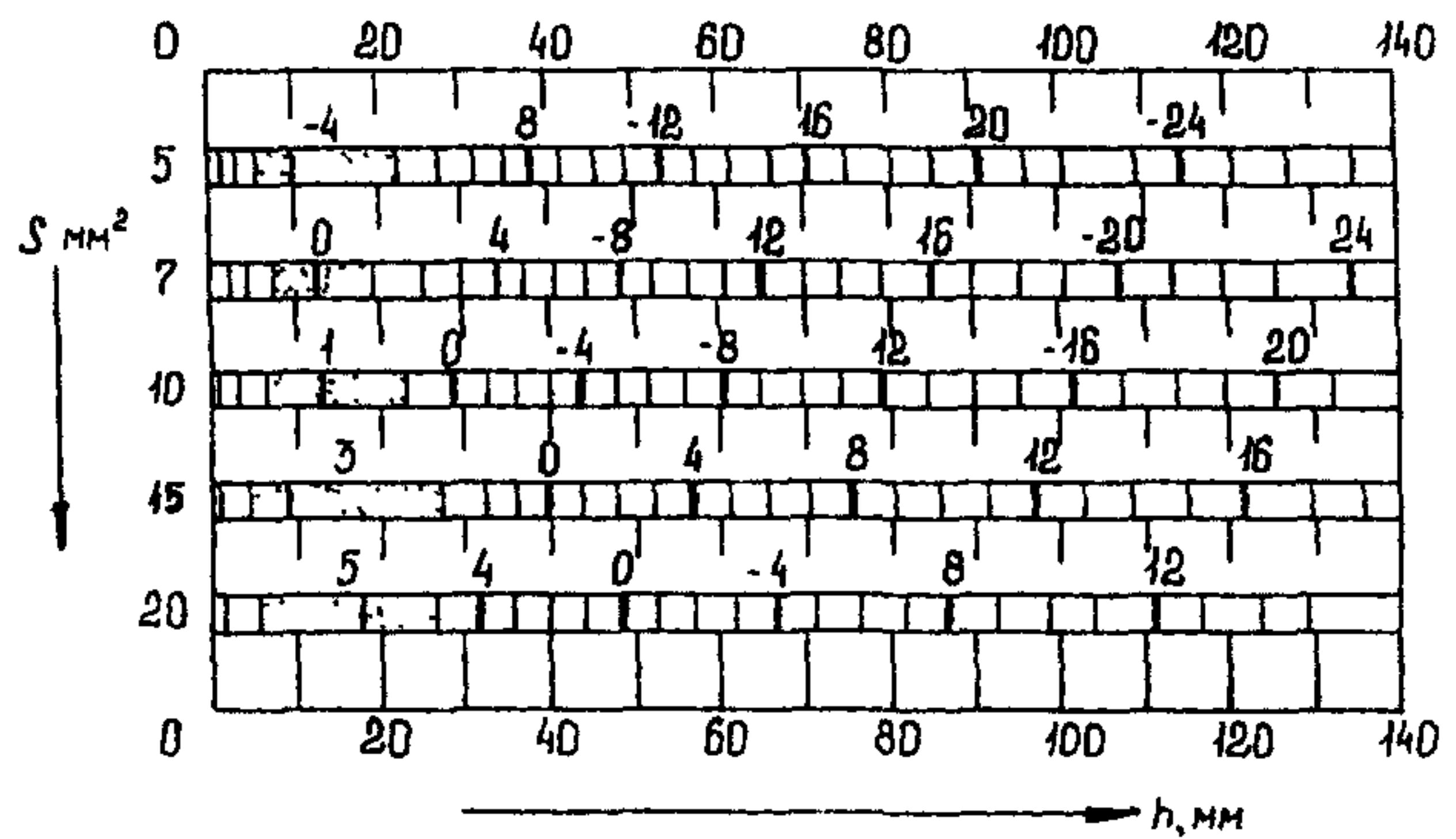
**Рис. 5, д. Разность между браковочным и опорным (по СО-2, глубина залегания отражателя 44 мм) уровнями чувствительности при контроле сварных соединений преобразователями ПРИЗ-Д5; частота 1,8 МГц; угол ввода 40 град.; площадь пьезоэлемента 192 мм<sup>2</sup>; коэффициент затухания 0,001 (1/мм)**
