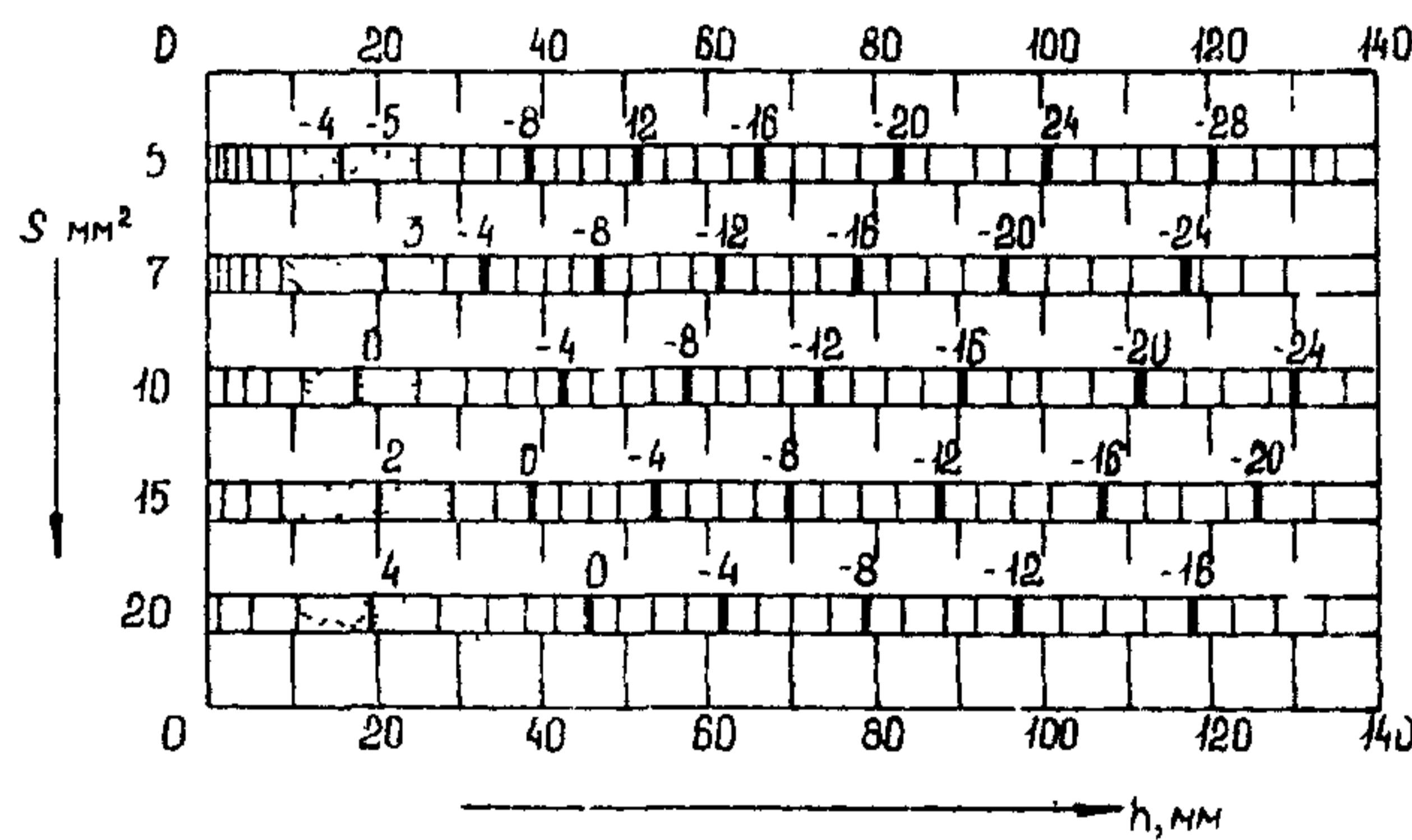
**Рис. 5, з.** Разность между браковочным и опорным (по СО-2, глубина залегания отражателя 44 мм) уровнями чувствительности при контроле сварных соединений преобразователями ПРИЗ-Д5; частота 2,5 МГц; угол ввода 50 град.; площадь пьезоэлемента 192 мм<sup>2</sup>; коэффициент затухания 0,002 (1/мм)
