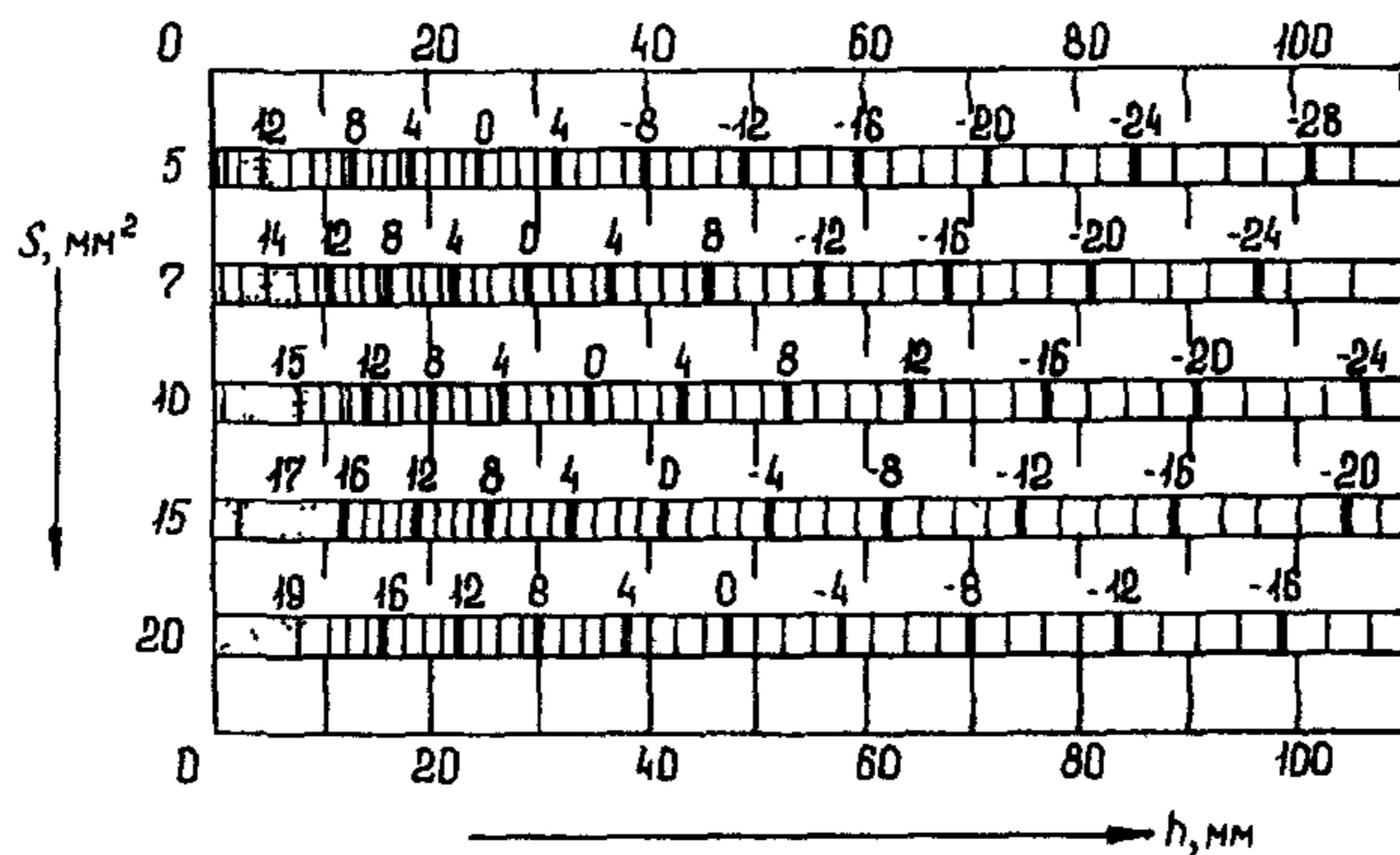
**Рис. 5, г. Разность между браковочным и опорным (по СО-2, глубина залегания отражателя 44 мм) уровнями чувствительности при контроле сварных соединений преобразователями ИЦ, ПНЦ; частота 2,5 МГц; угол ввода 65 град.; площадь пьезоэлемента 113 мм<sup>2</sup>; коэффициент затухания 0,002 (1/мм)**
