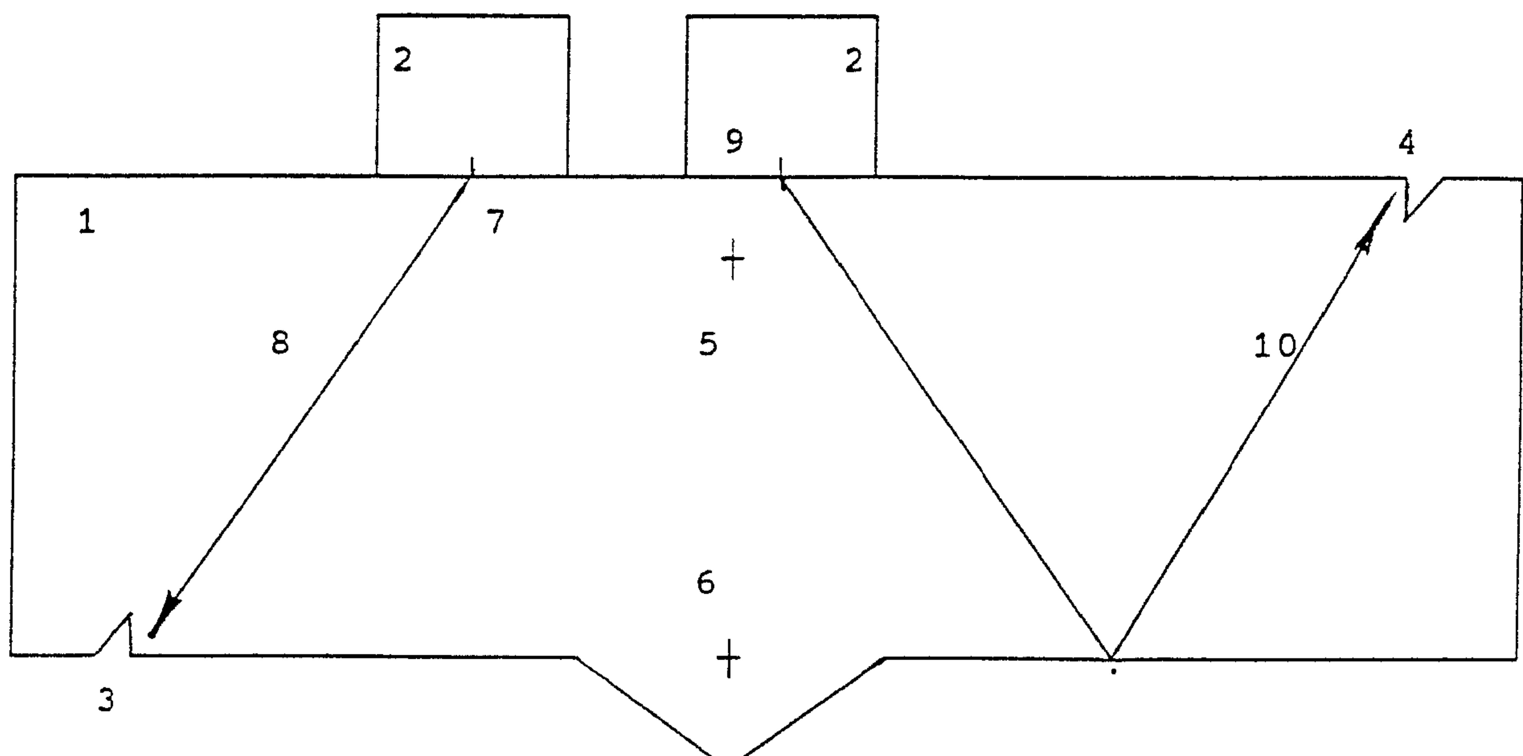
Стандартный образец предприятия СОП (1), преобразователи ПЭП (2), нижняя "зарубка" (3), верхняя "зарубка" (4), глухие отверстия (5) и (6) для уточнения настройки масштаба развертки, точка выхода (7) при контроле прямым лучом (8), точка выхода (9) при контроле отраженным лучом (10).
