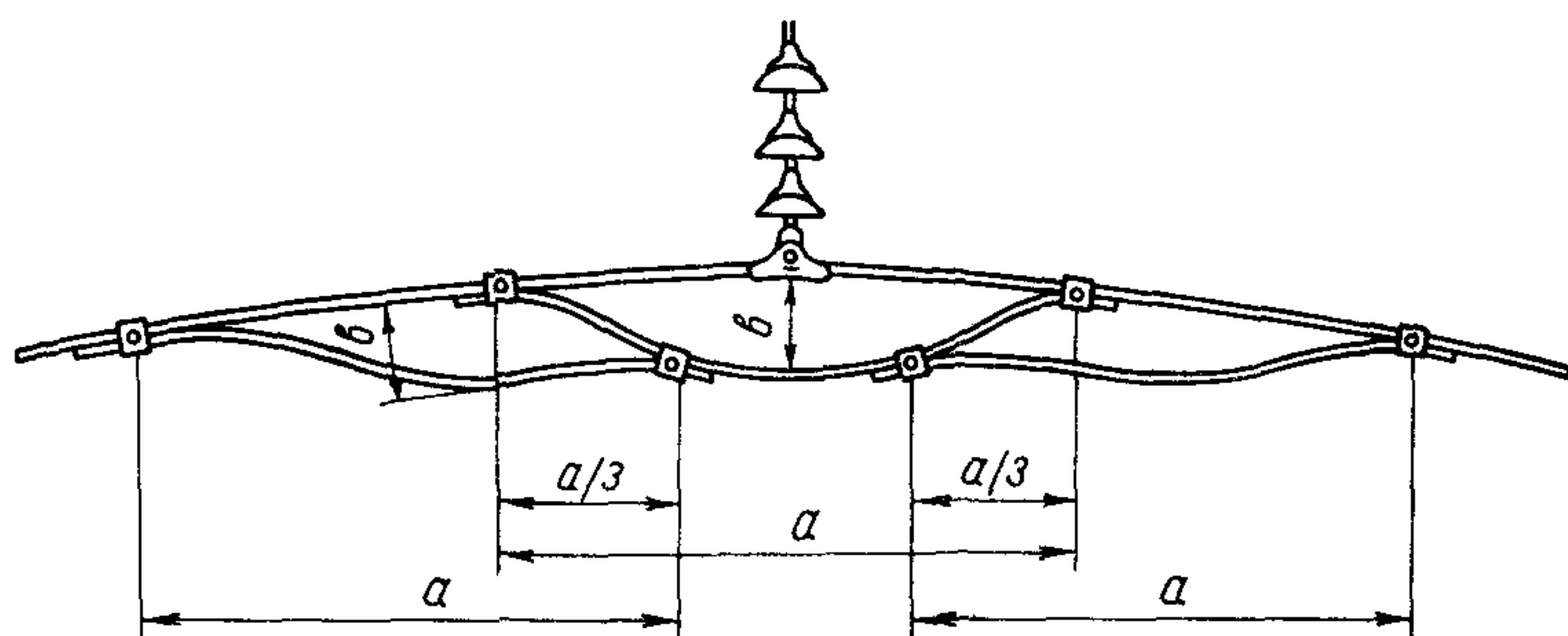
Рис.3.2. Трехпетлевой гаситель вибрации
