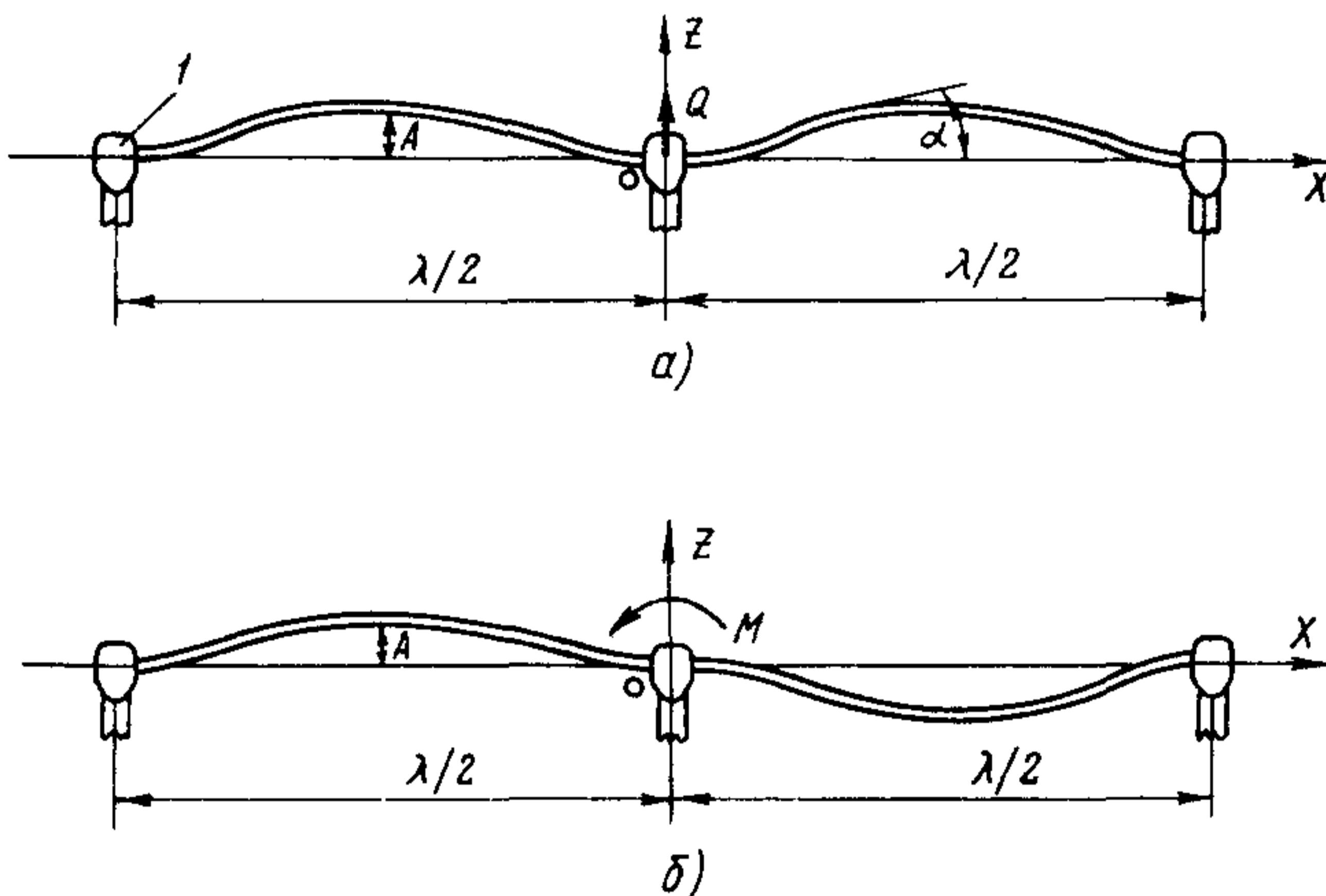
Рис.П2.5. Формы субколебаний провода:
