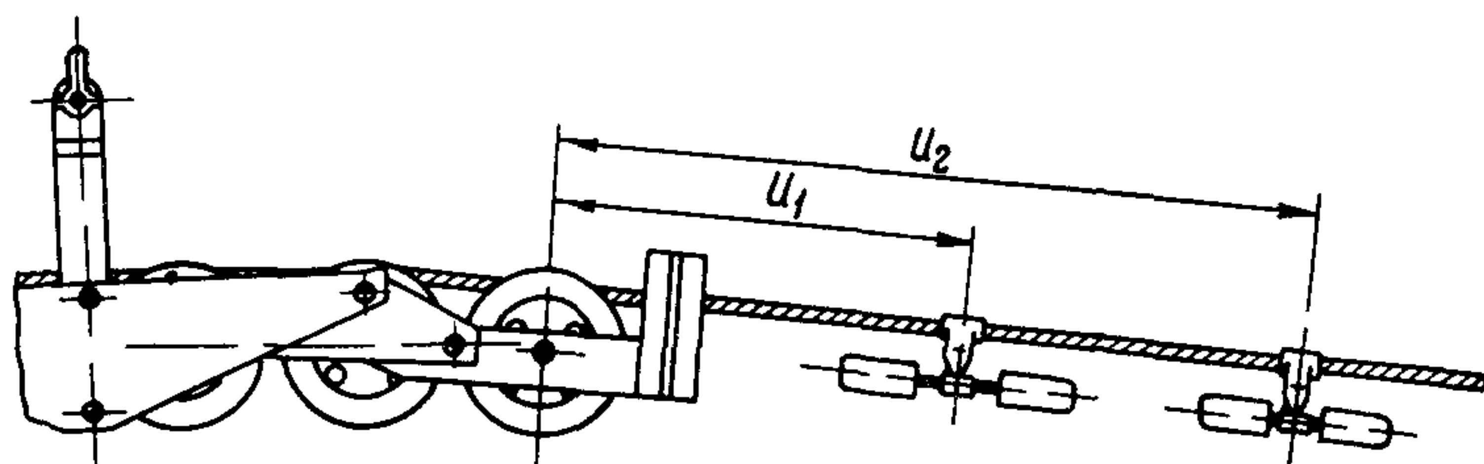
Рис.4.5. Расположение двух гасителей сбрасывающегося типа у многороликового подвесного устройства
