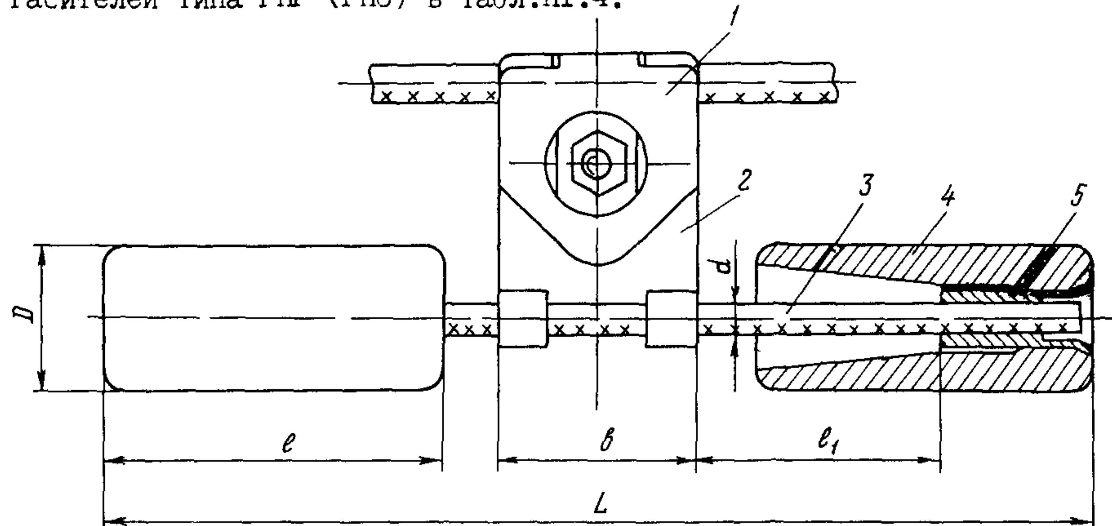
Рис.П.6. Конструкция гасителей вибрации типа ГВН (усовершенствованный), ГПГ:
