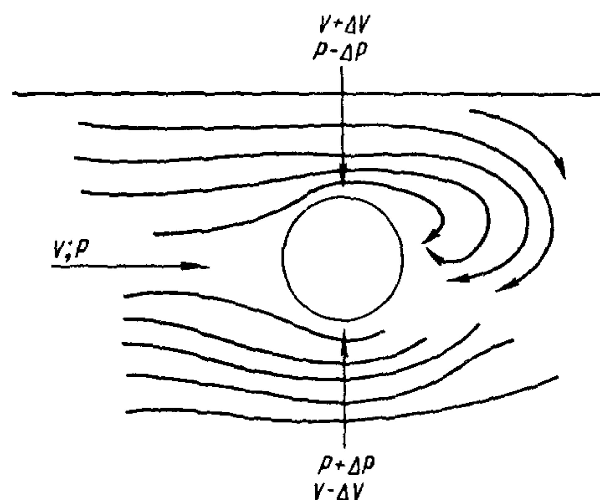
Рис.2.3. Схема вихреобразования за проводом
