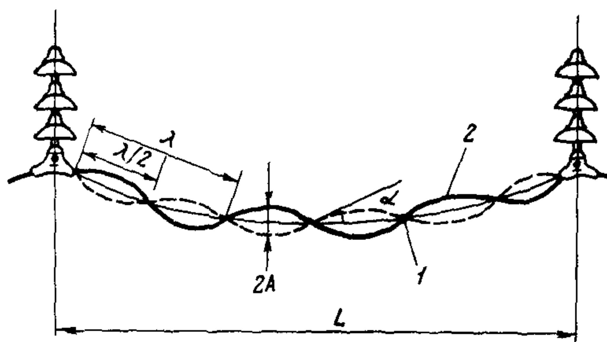
Рис.2.1. Стоячая волна вибрации провода в пролете ВЛ:
