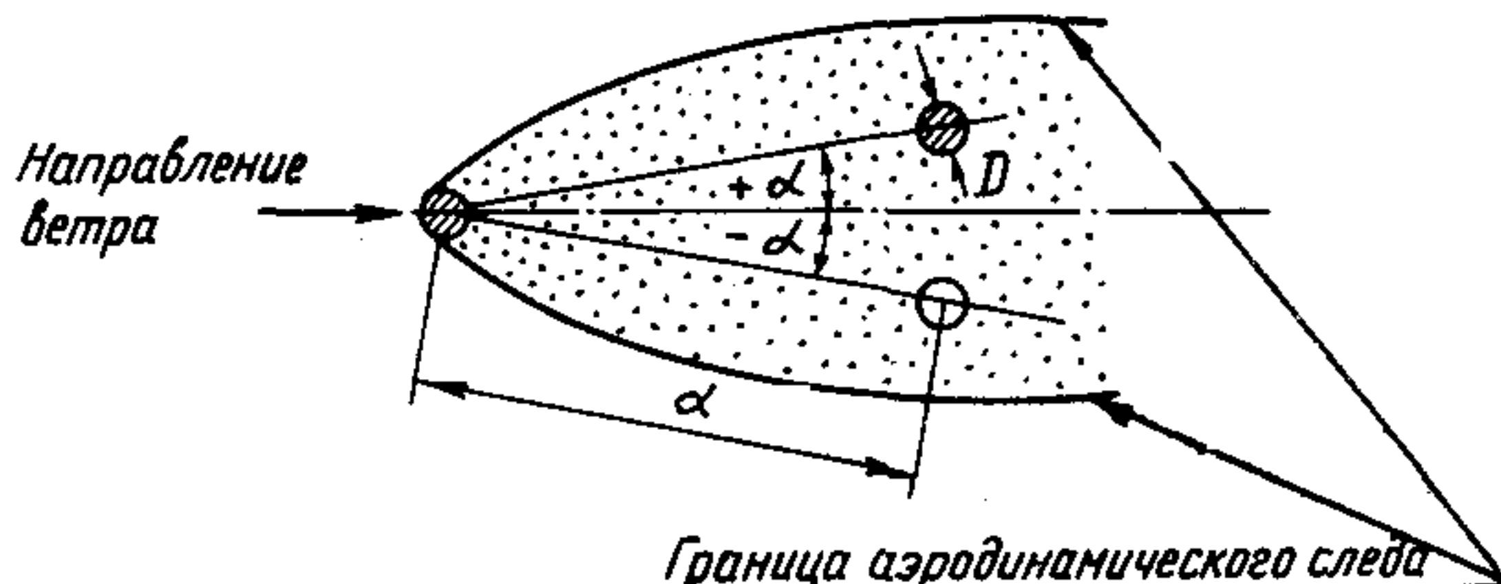
Рис.П2.4. Создание угла наклона пары проводов Пучка:
