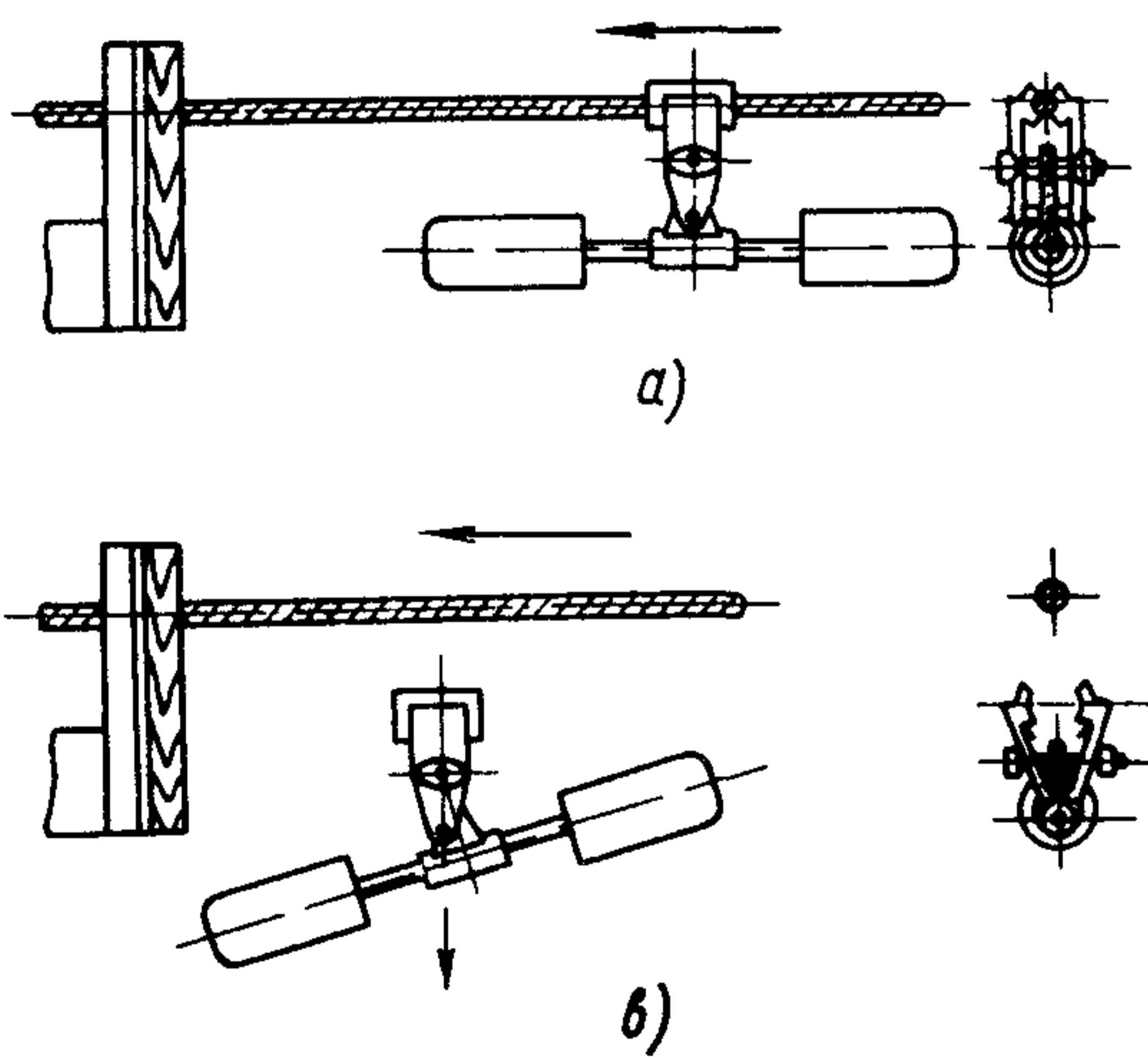
Рис.4.3. Схема срабатывания сбрасывающего устройства гасителя ГПС
