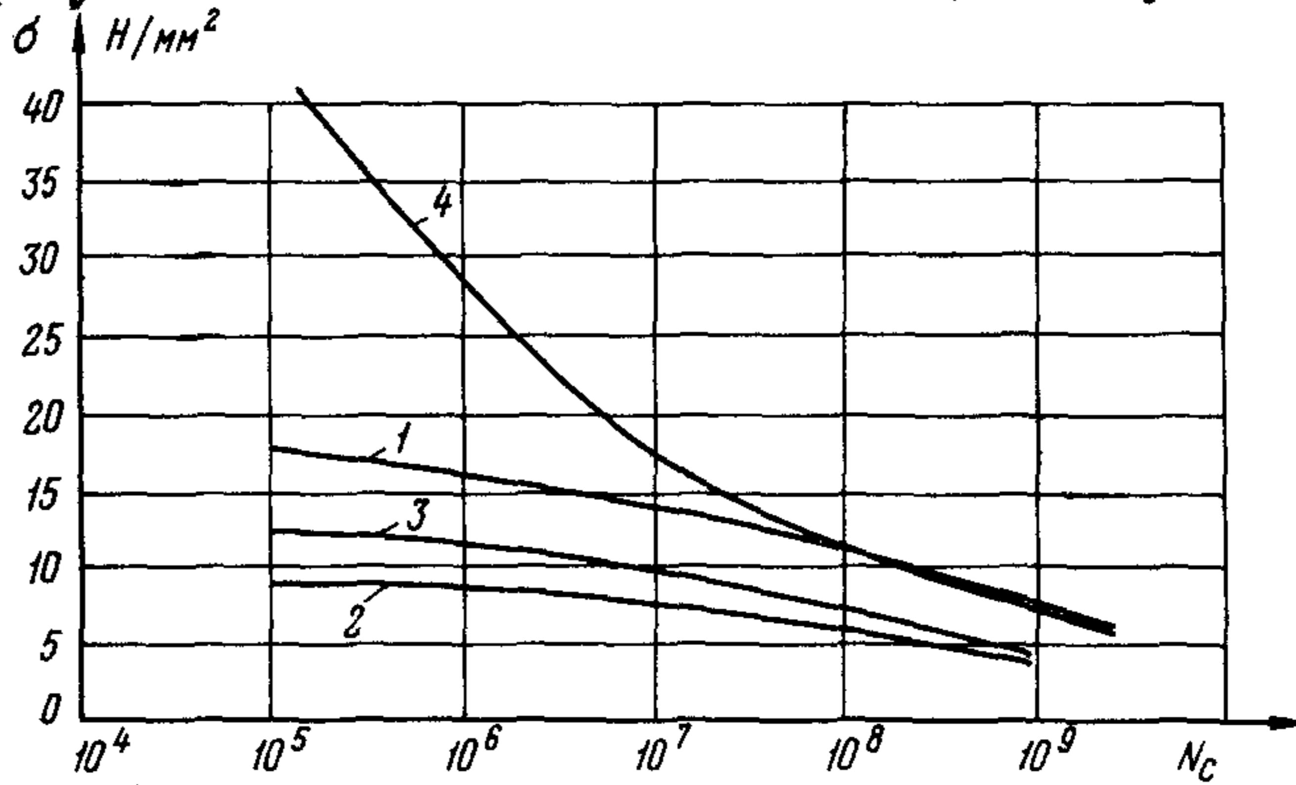
Рис.П.2. Кривые накопленных за год напряжений для провода АС 560/50: 1 - испытания проведены на ровной открытой местности,  $\sigma_{\text{стат}} = 0,2\sigma_f$  ( $\sigma_f$  - предел прочности провода на разрыв); 2 - испытания проведены на холмистой местности,  $\sigma_{\text{стат}} = 0,2\sigma_f$ ; 3 - испытания проведены на холмистой местности,  $\sigma_{\text{стат}} = 0,27\sigma_f$ ; 4 - пограничная кривая СИГРЭ
