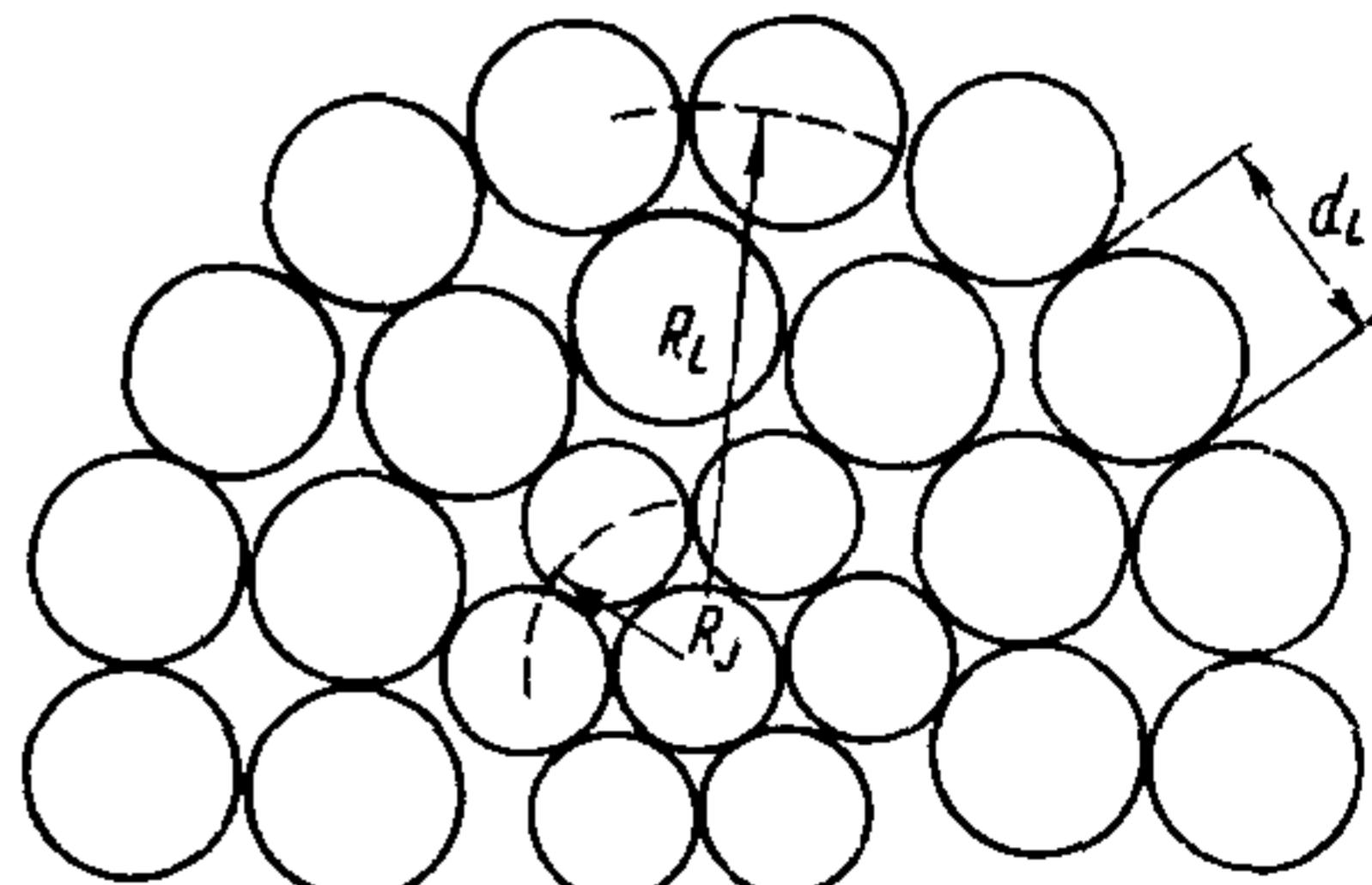
Рис. III. I. Поперечное сечение многослойного алюминиевого провода
