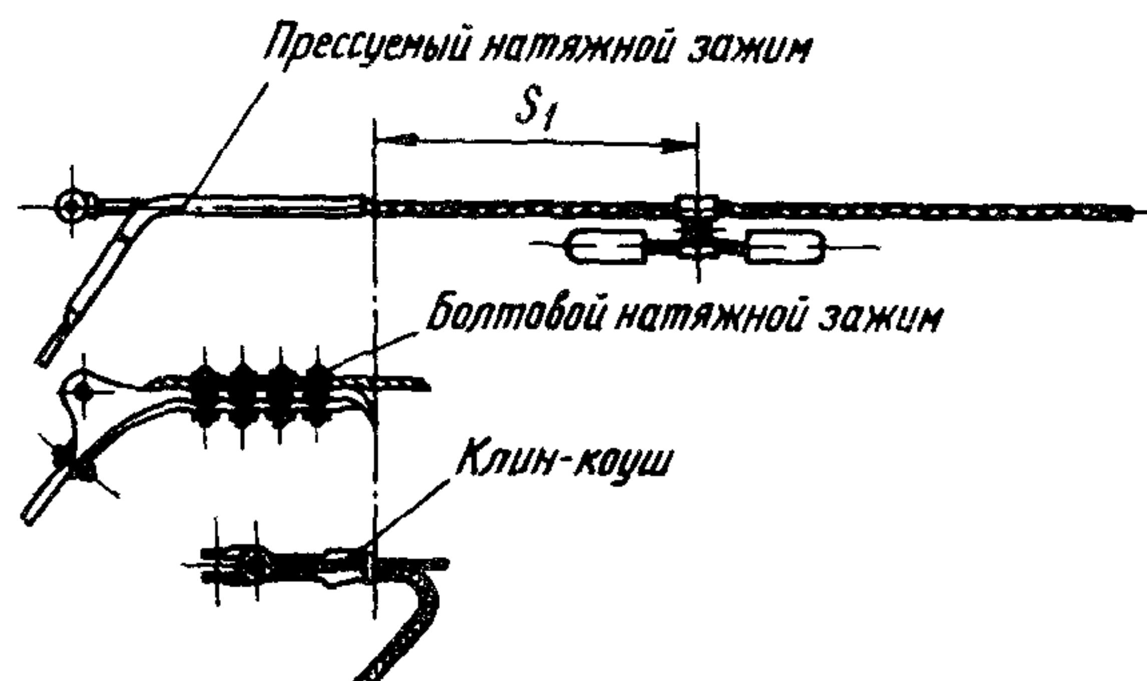
Рис.3.5. Расположение гасителя вибрации у натяжных зажимов
