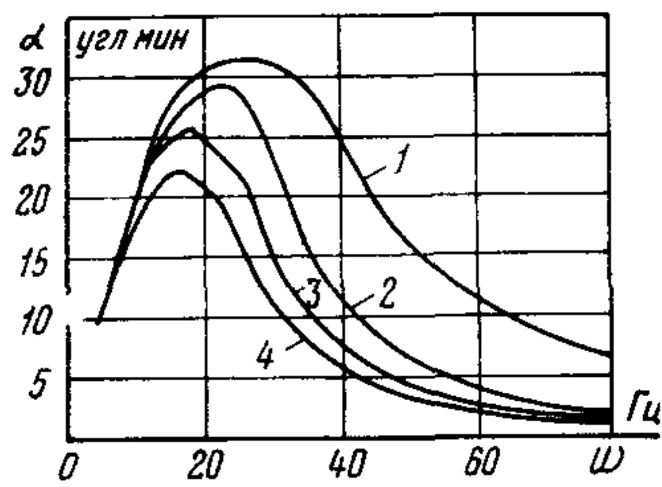
Рис.П.3. Зависимость угла вибрации провода от интенсивности турбулентности воздушного потока ( $I_t$ ):
