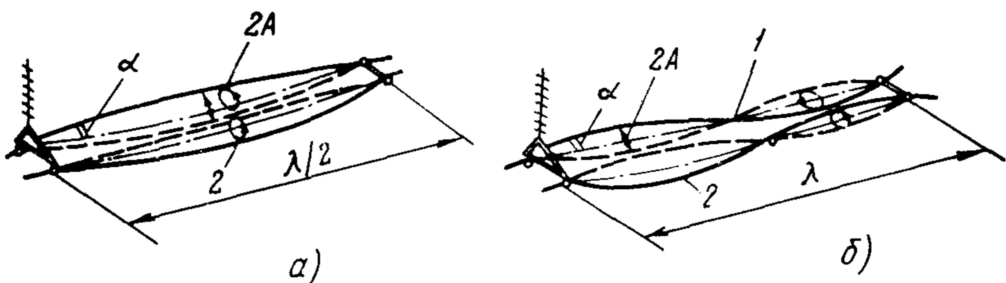
Рис.П2.1. Формы колебаний проводов в подпролетах:
