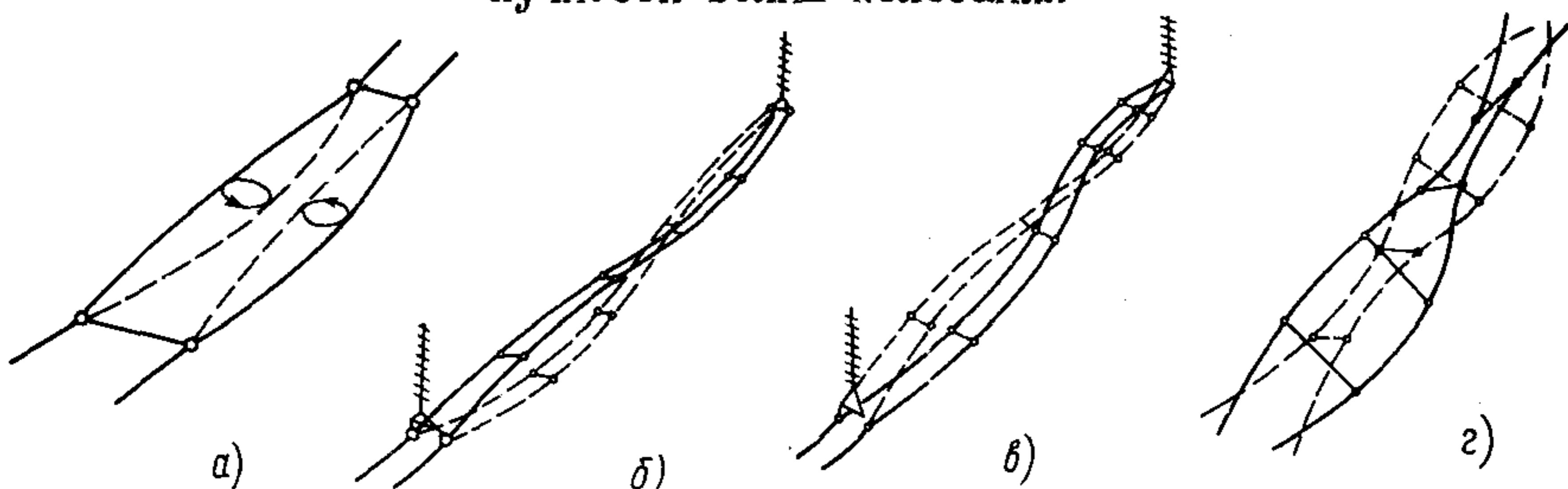
Рис.П2.2. Виды колебаний проводов, вызываемых воздействием аэродинамического следа:  $\alpha$  - колебания проводов в подпролетах;  $\beta$  - вертикальные колебания;  $\beta$  - горизонтальные колебания;  $\gamma$  - крутые колебания
