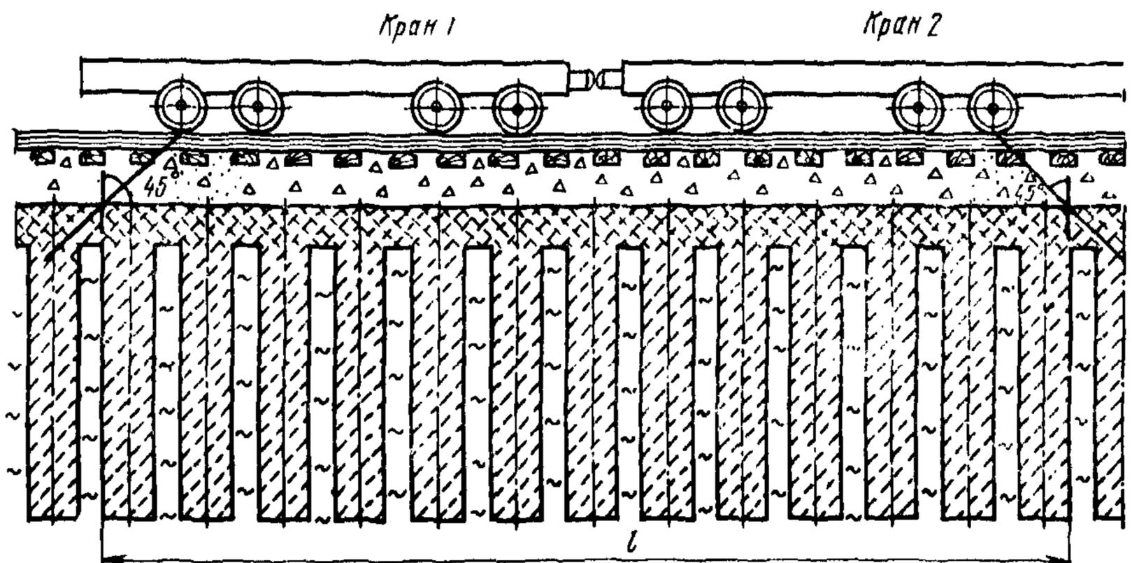
Рис. 5. Схема расчетного элемента основания подкрановых путей
