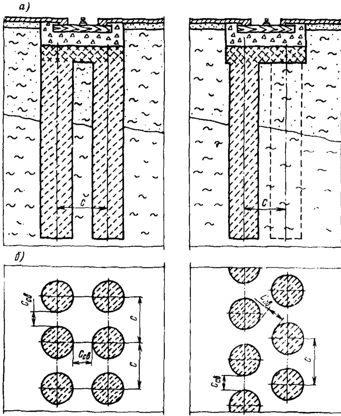
Рис. 4. Схемы подкрановых путей на илоцементных сваях (слева — без относительного смещения свай в рядах, справа — с относительным смещением свай в рядах):
