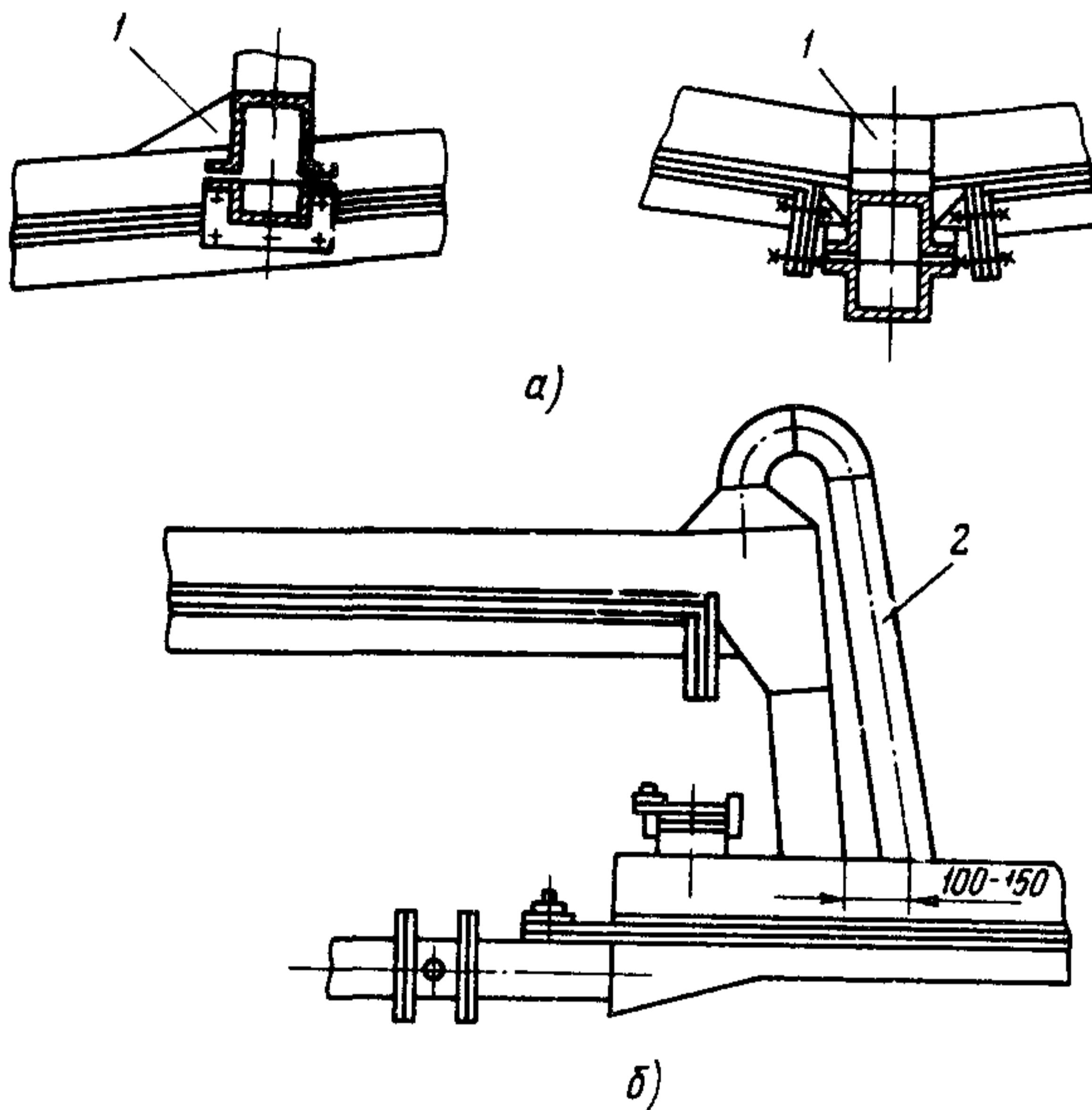
Рис.2.6. Реконструкция узлов пересыпки аэроежелобов:
