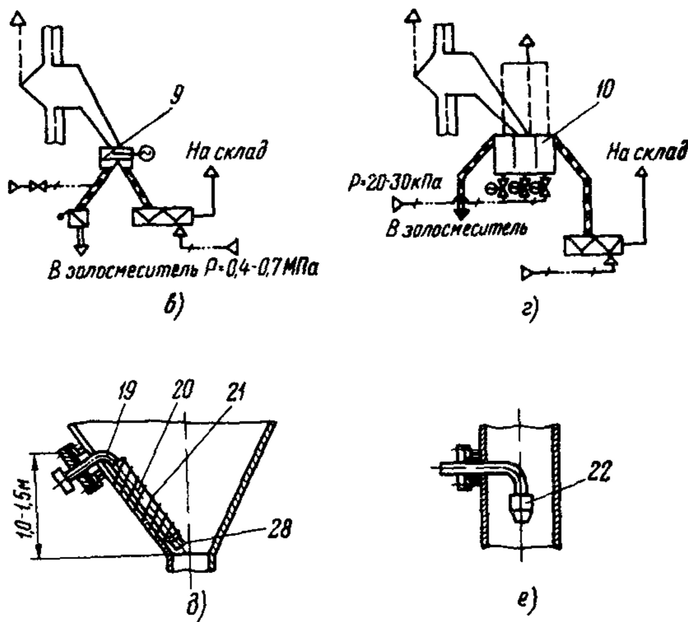
Рис.2.1. Внутреннее пневмозолоудаление аэрошелобами:
