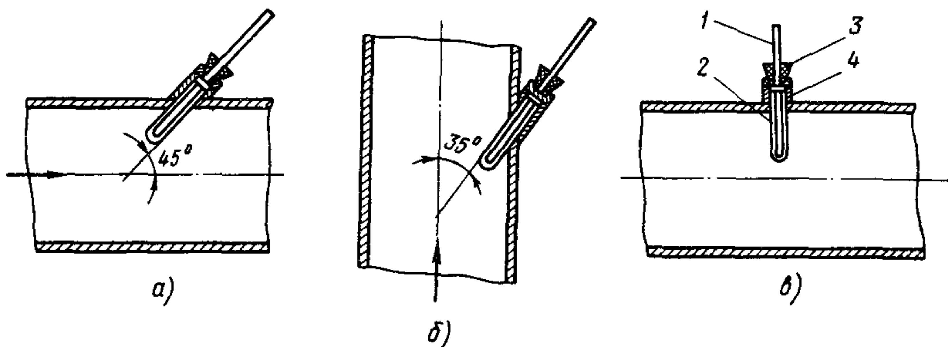
Рис.3.8. Способы установки термометров в трубопроводах:
