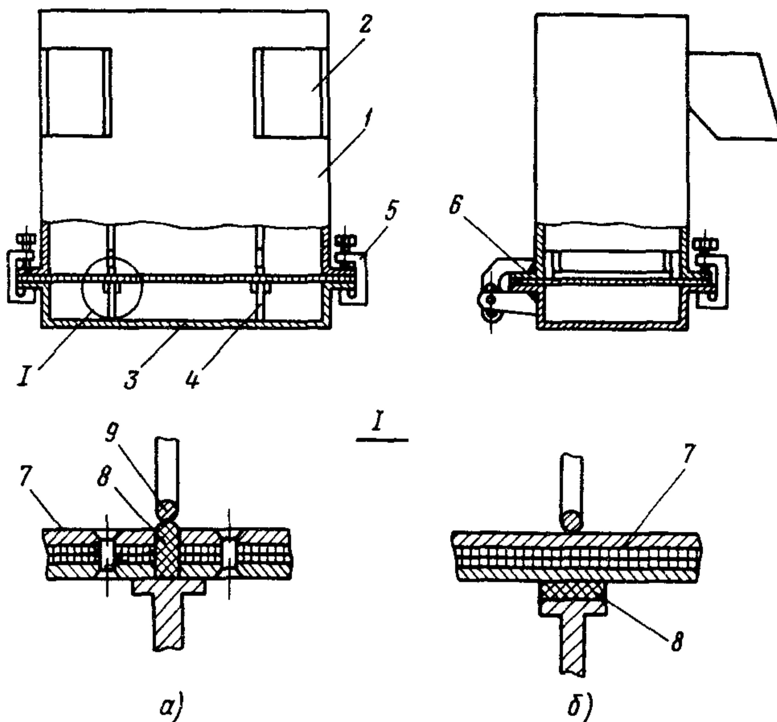
Рис.2.5. Реконструкция пневмослоевого переключателя:
