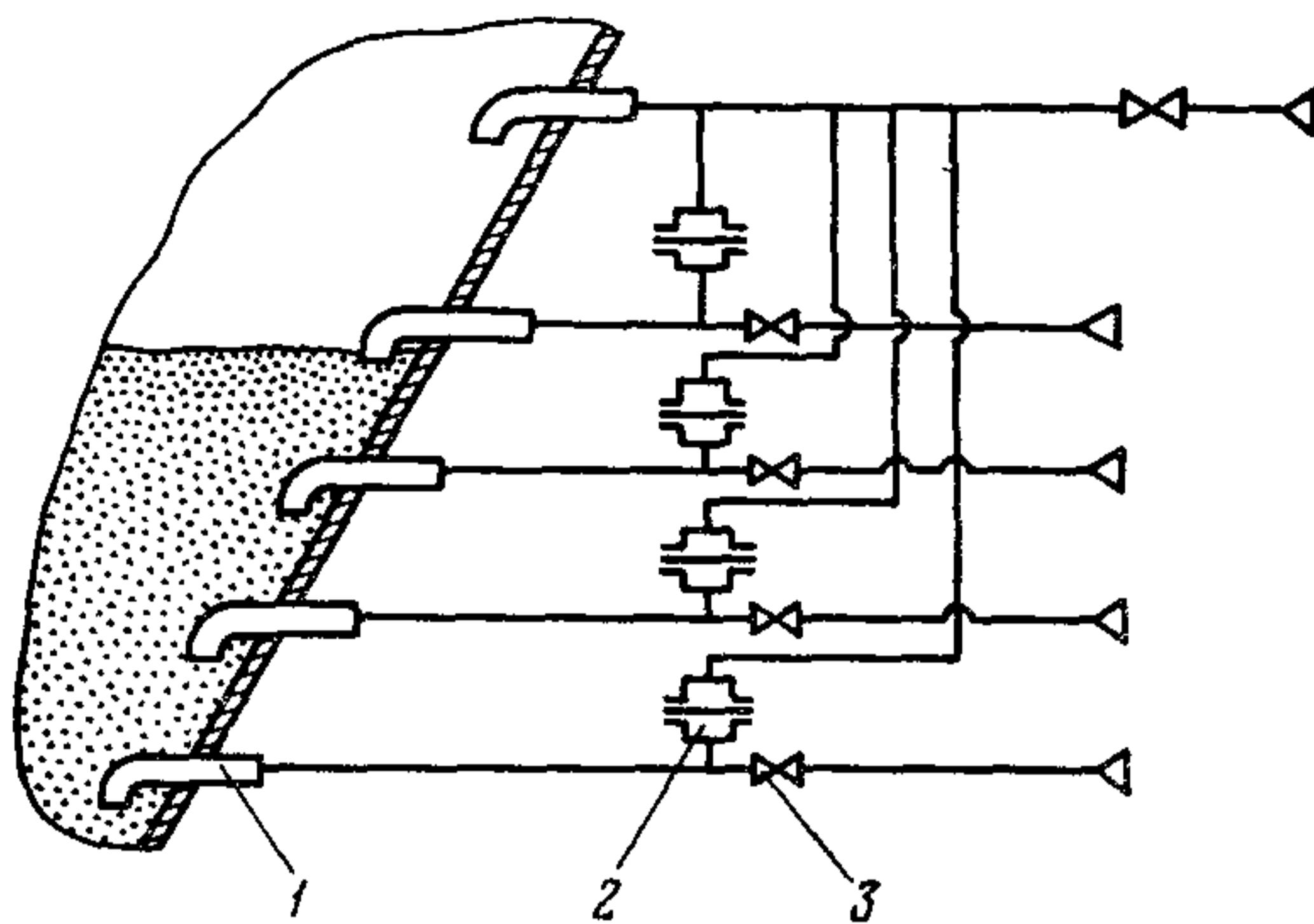
Рис.3.13. Установка датчика уровня золы в бункере:
