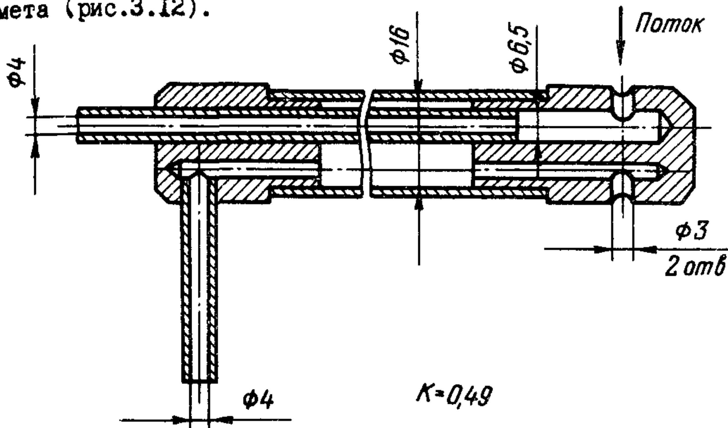
Рис.3.12. Цилиндрическая пневмометрическая трубка ЦНИИцветмета
