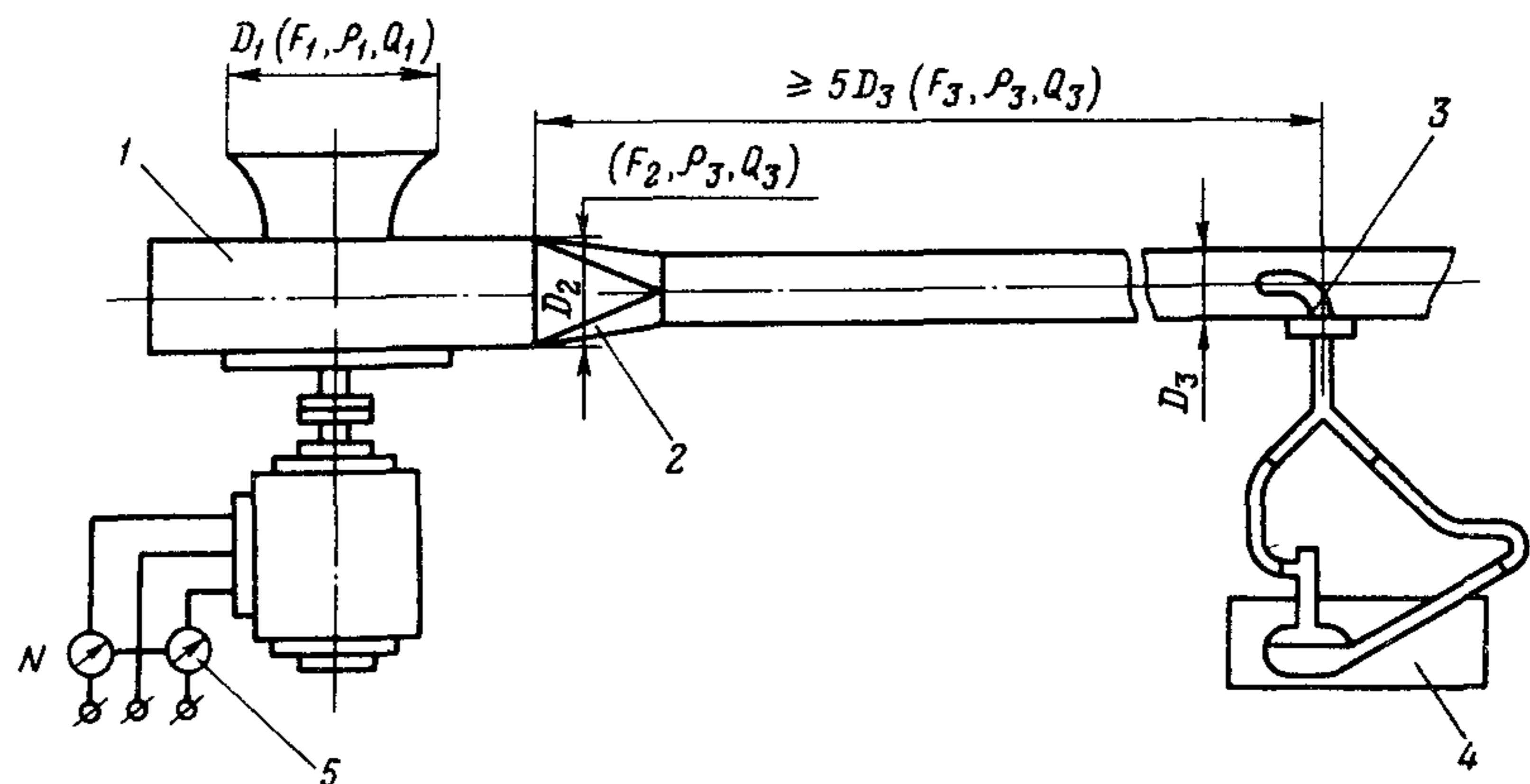
Рис.3.6. Схема установки для аэродинамических испытаний вентилятора:
