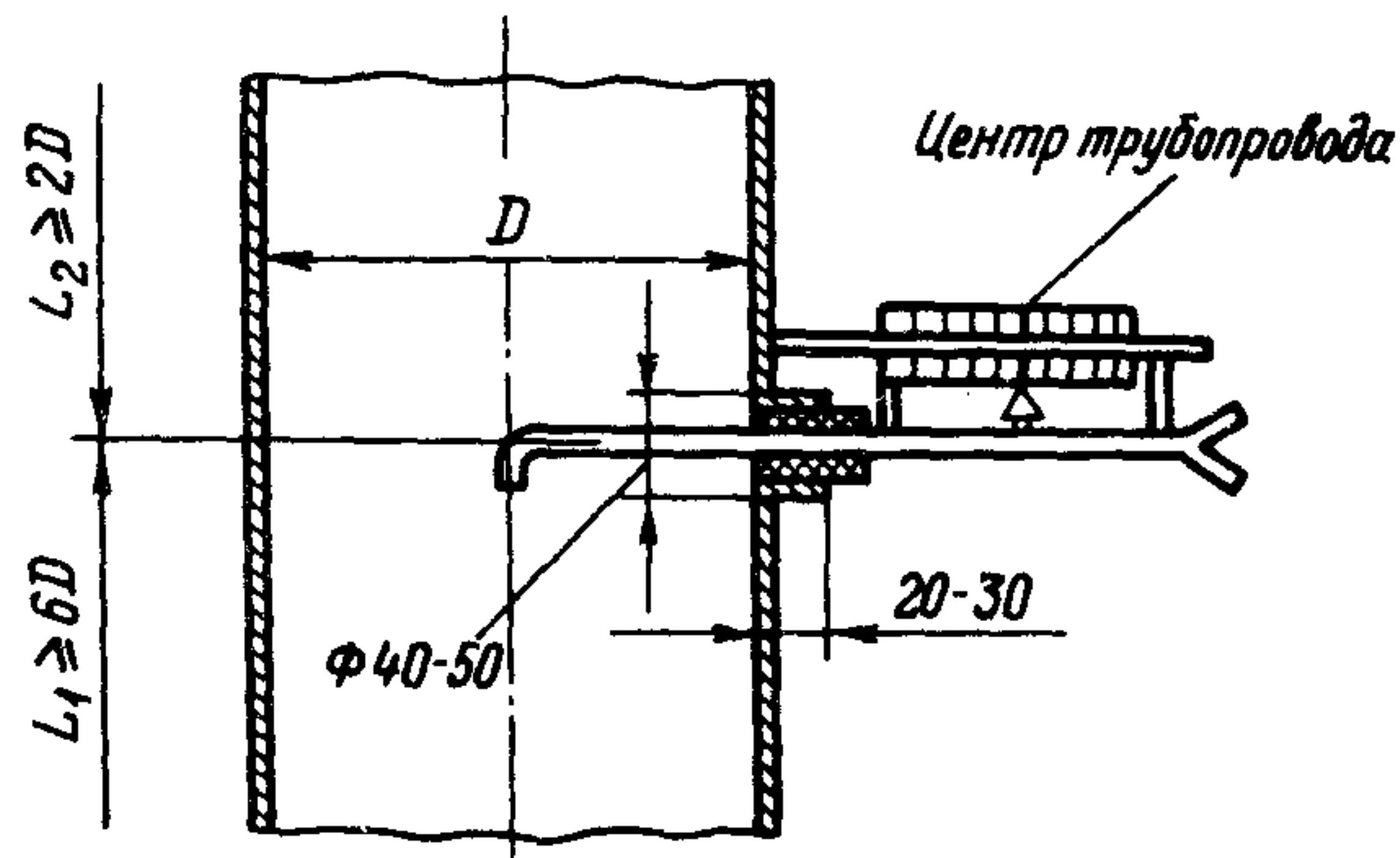
Рис.3.10. Установка пневматической трубы при проведении измерений в нескольких точках трубопровода:
