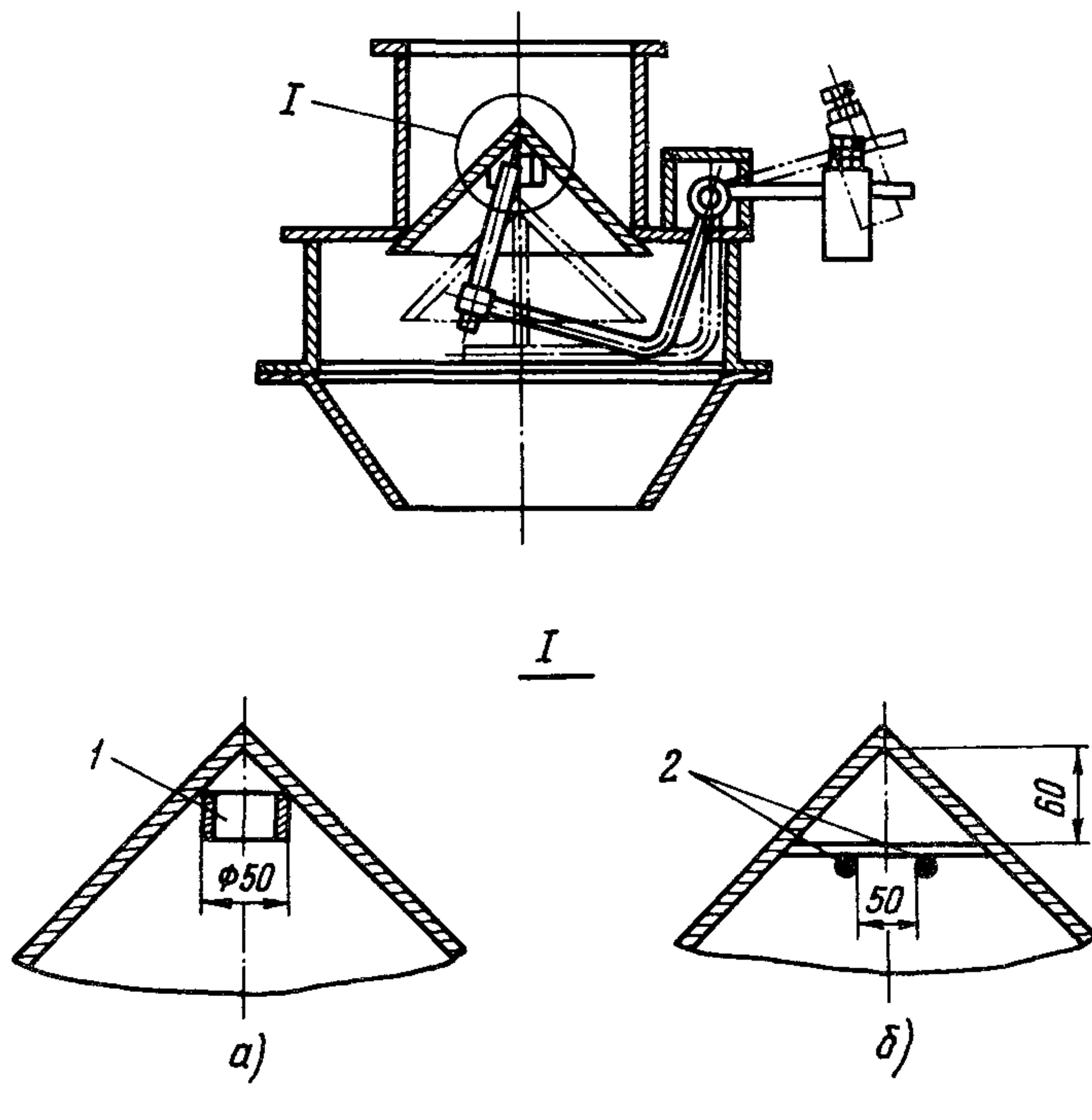
Рис.2.4. Реконструкция клапана-мигалки в целях предотвращения переворачивания конуса:
