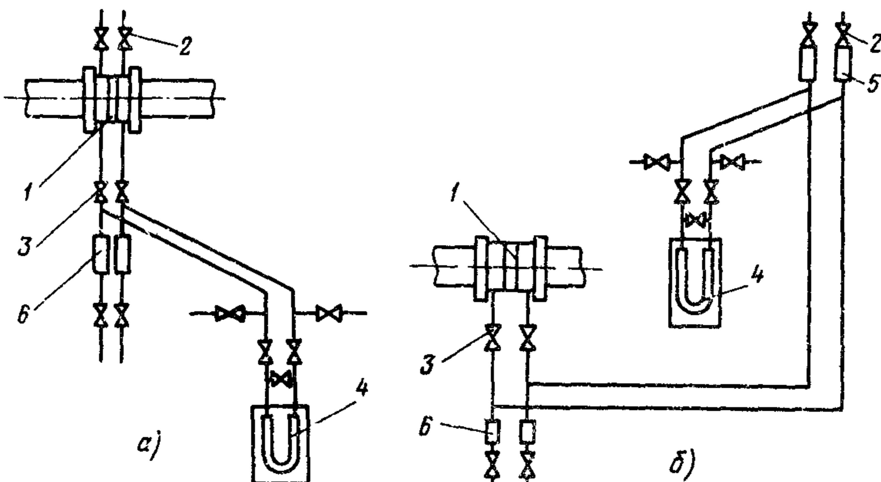
Рис.3.18 Схема соединительных линий для измерения расхода воды:
