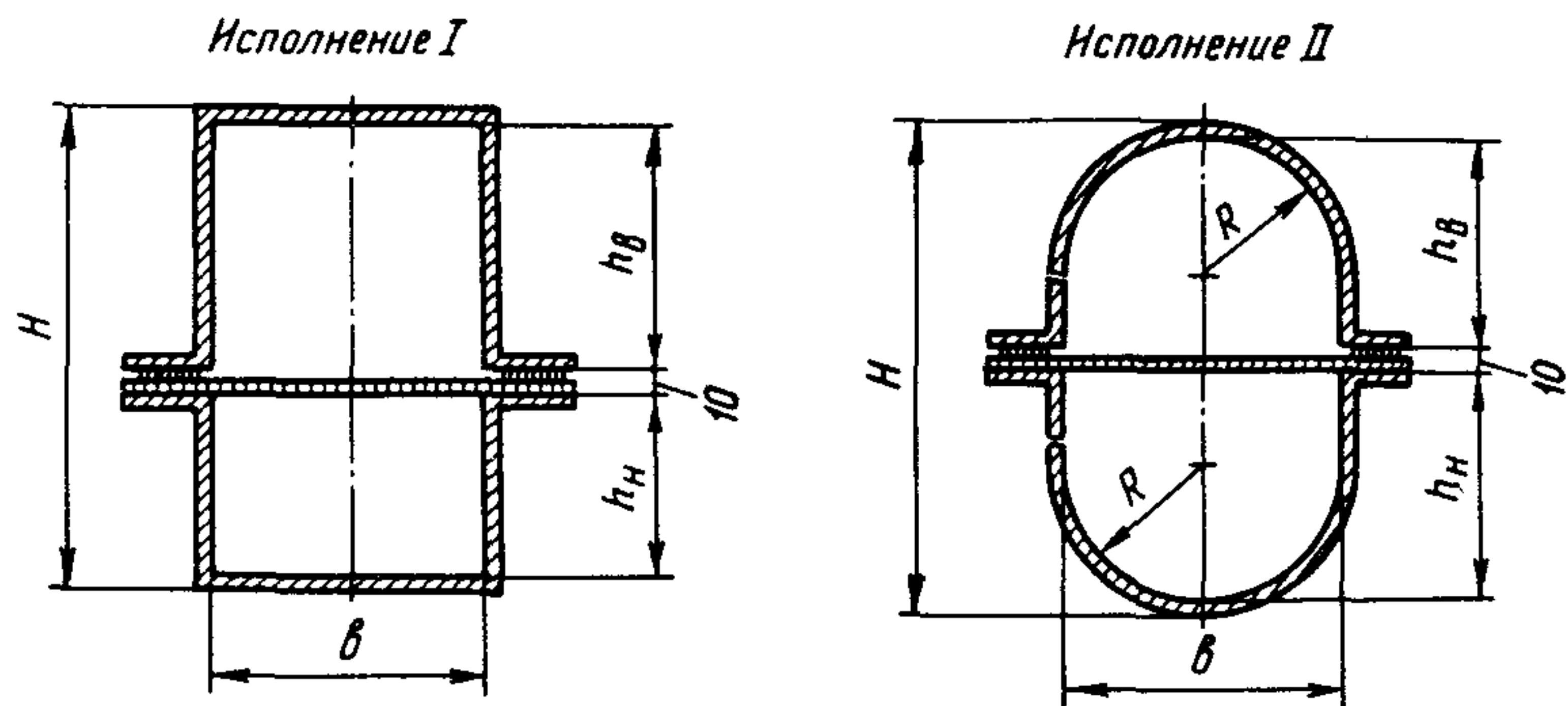
Рис.П2.1. Оптимальные типоразмеры аэрожелобов
