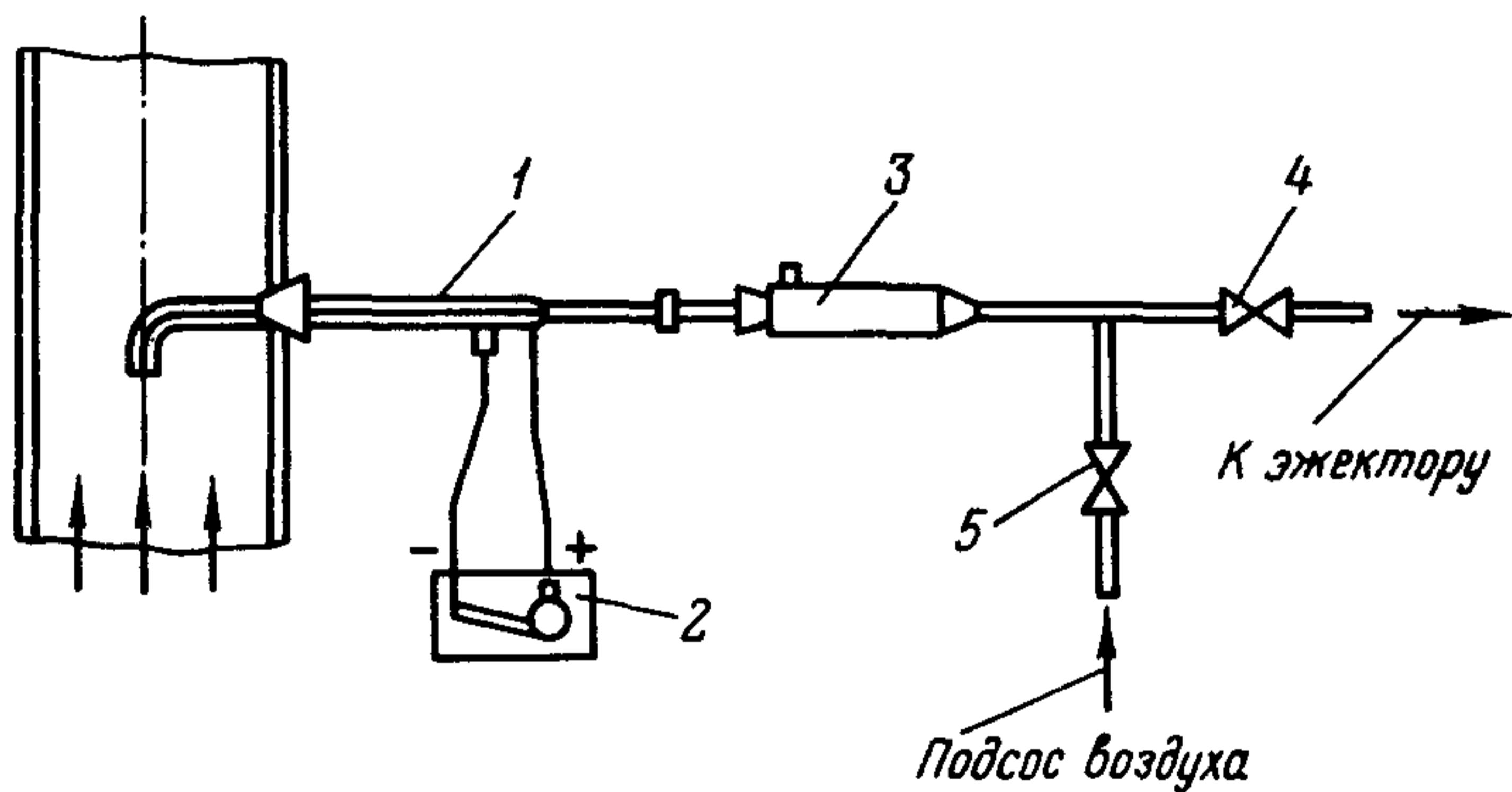
Рис.3.14. Схема установки ВТИ для определения запыленности газов с применением заборной трубы "нулевого" типа и внешней фильтрации:
