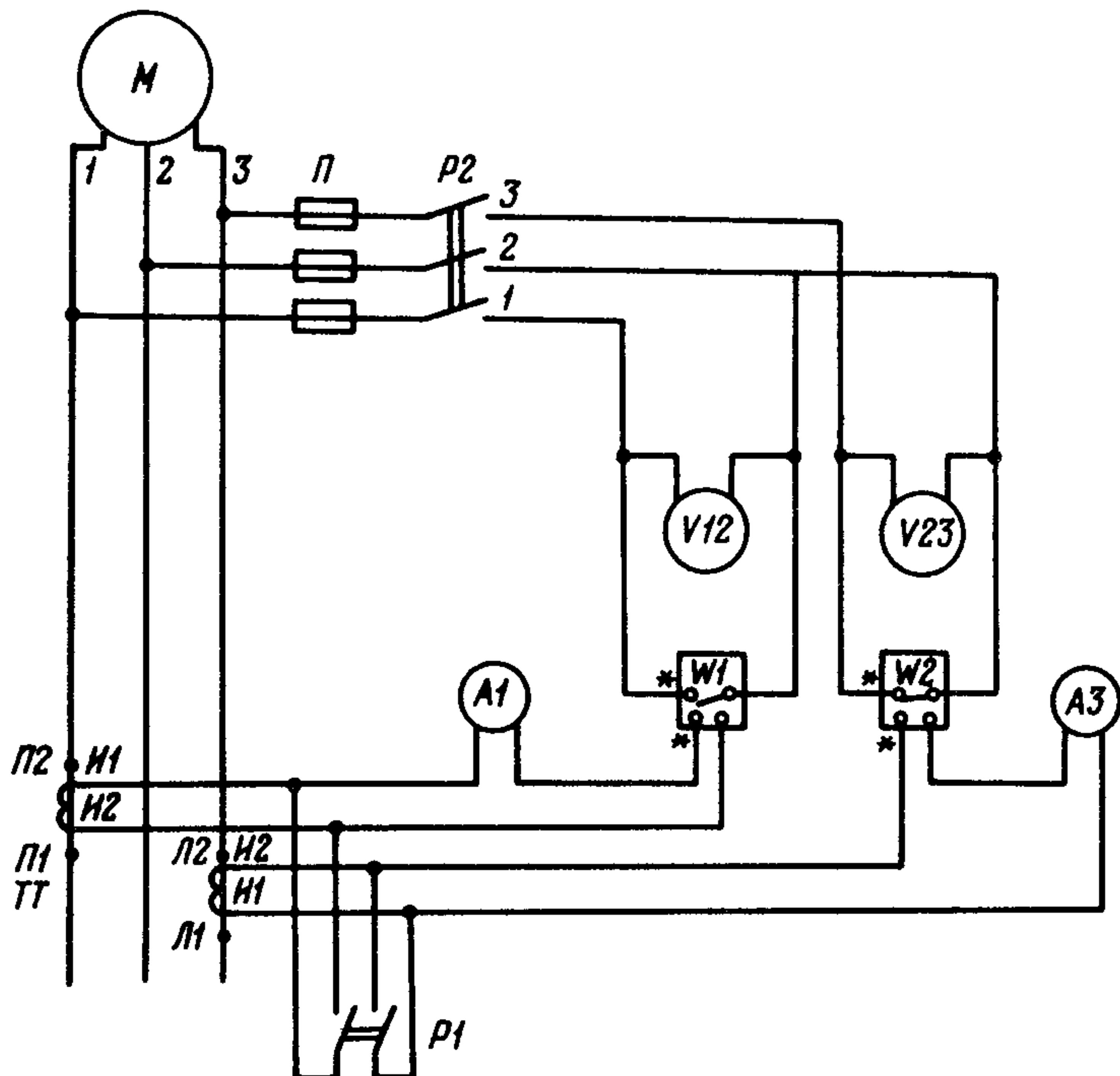
Рис.3.7. Определение мощности двигателя вентилятора
