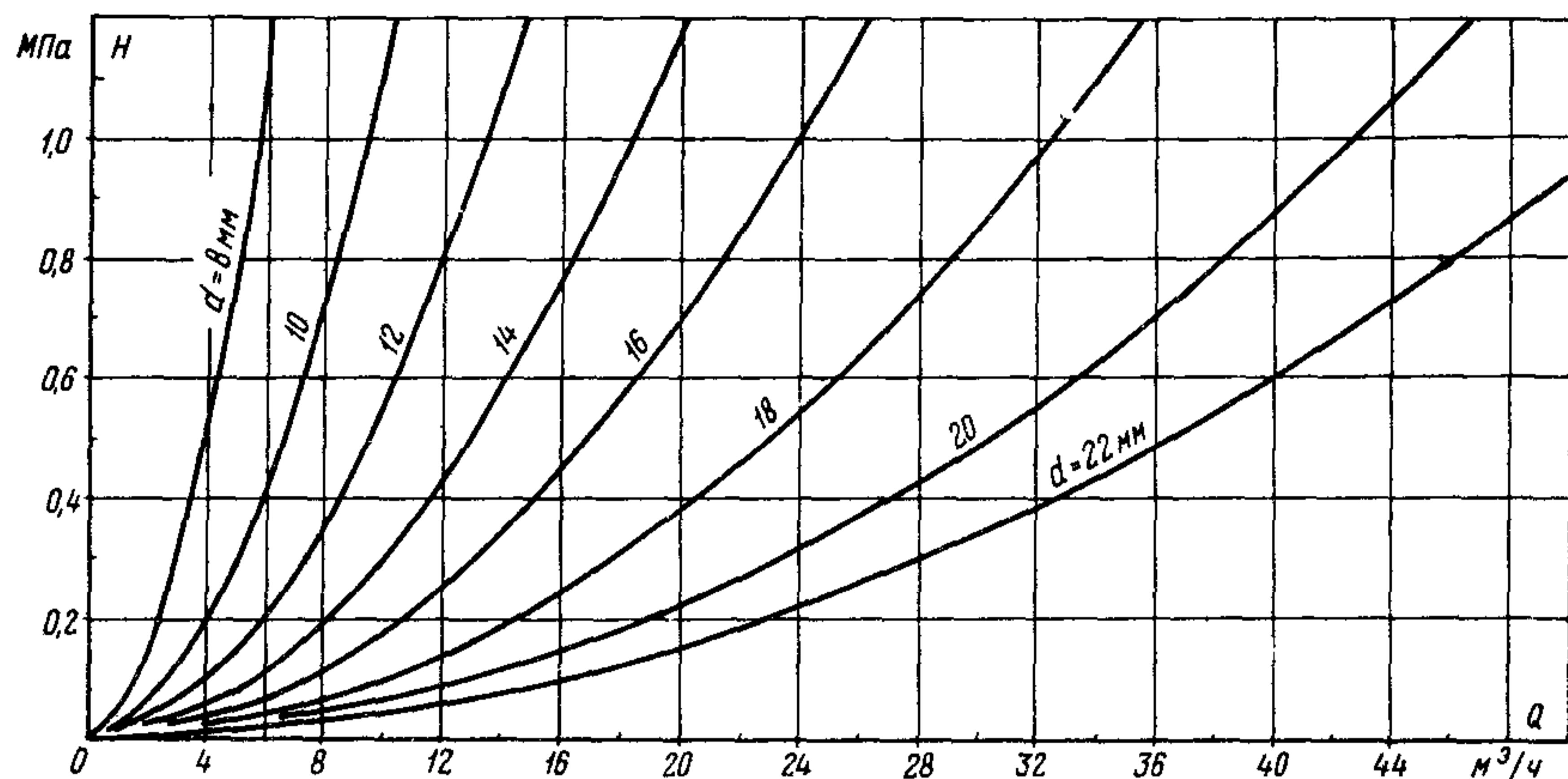
Рис.П3.2. Зависимость расхода воды через сопла от давления воды и диаметра сопла
