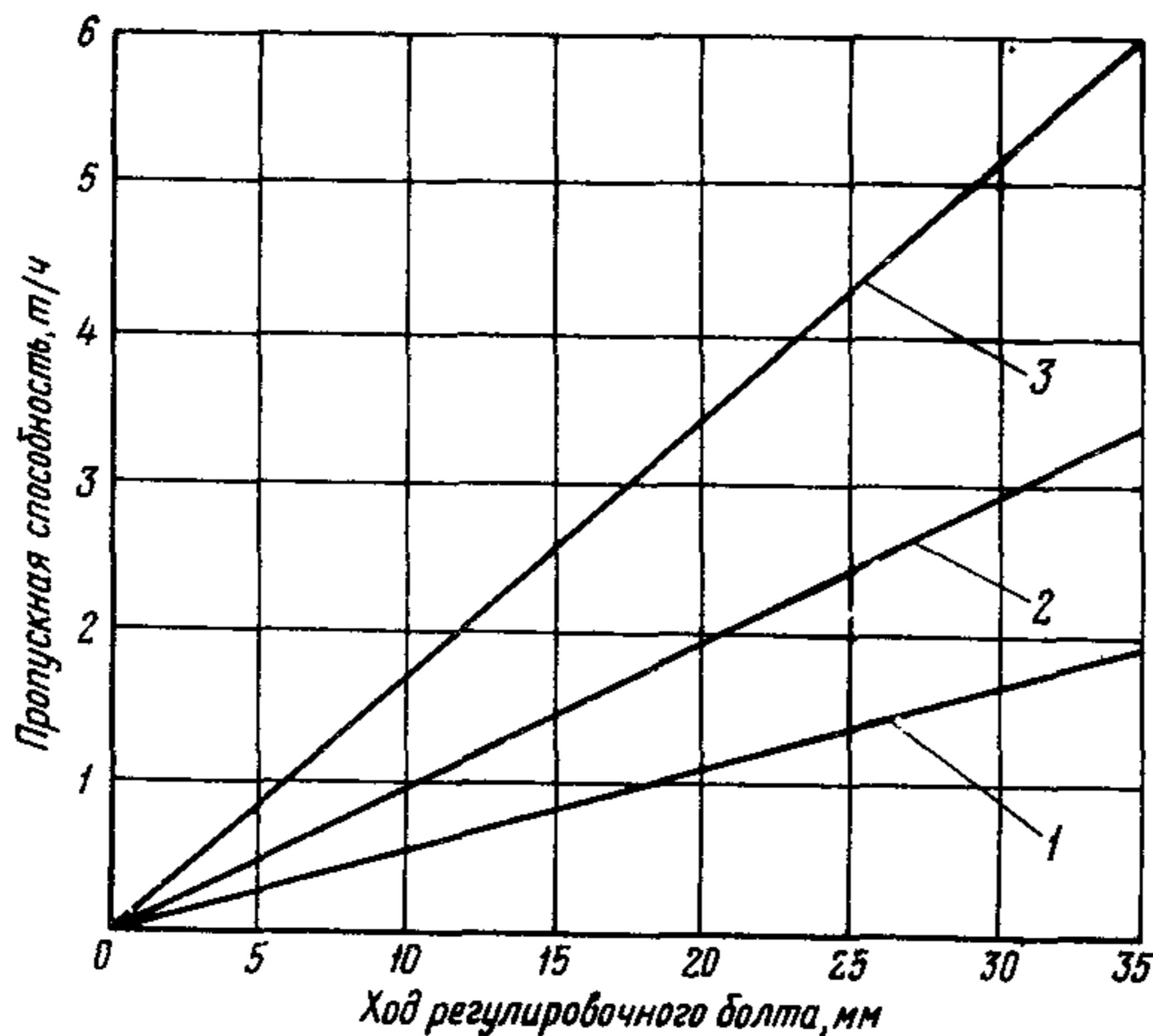
Рис.П4.1. Зависимость при уровне золы в бункере от 0,57 до 2,48 м:
