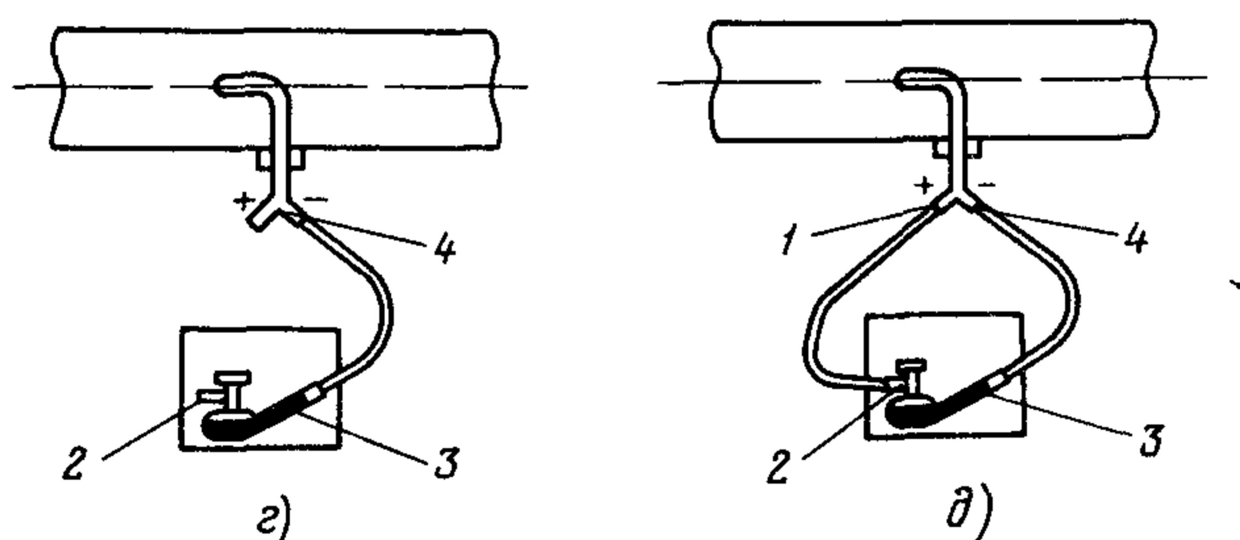
Рис.3.II. Порядок присоединения микроманометра к пневмометрической трубке при измерении различных давлений;
