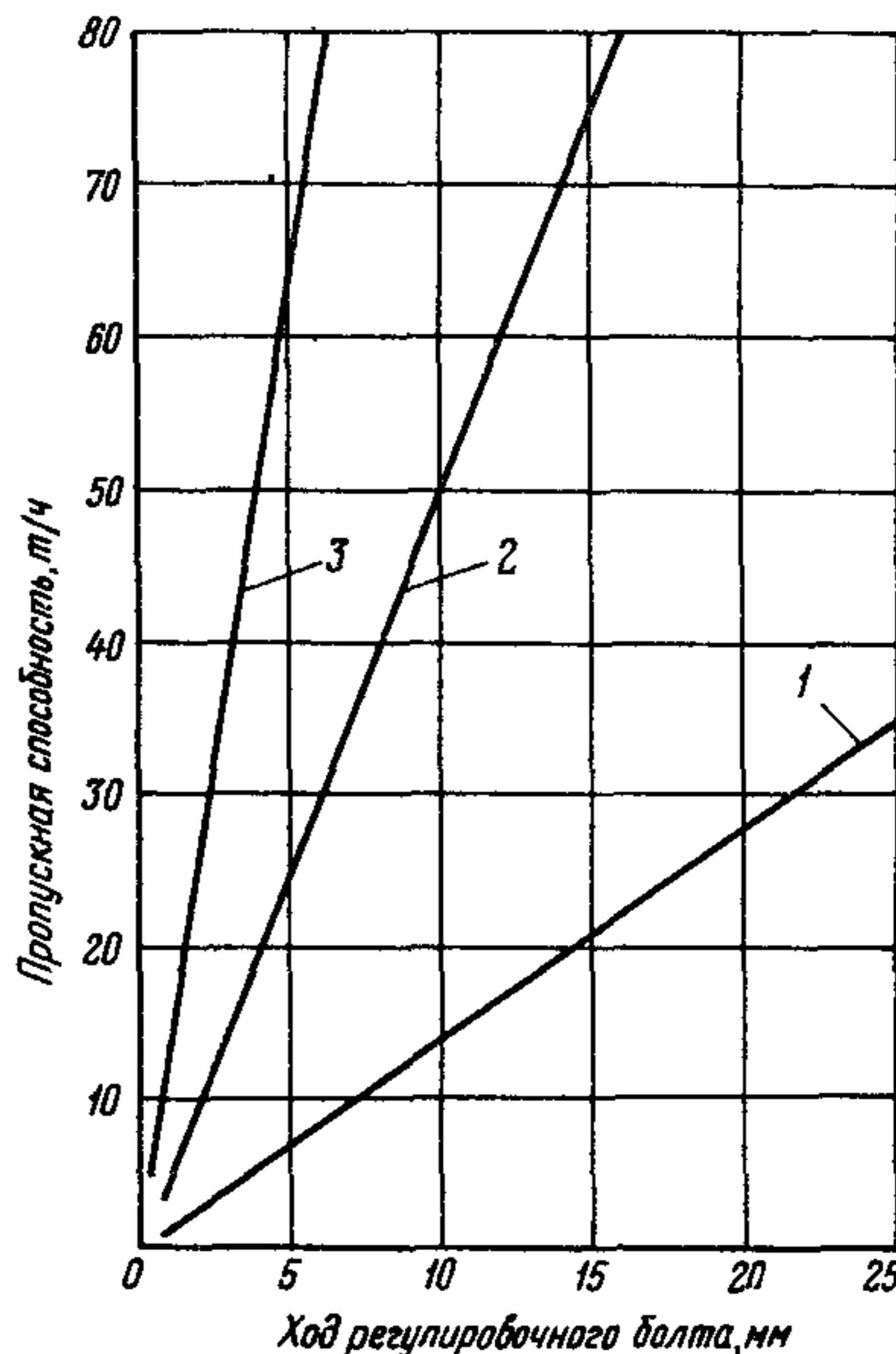
Рис.П4.2. Зависимость при расходе сжатого воздуха через аэрационный штуцер в течке золы  $20 \text{ м}^3/\text{ч}$  при нормальных условиях:
