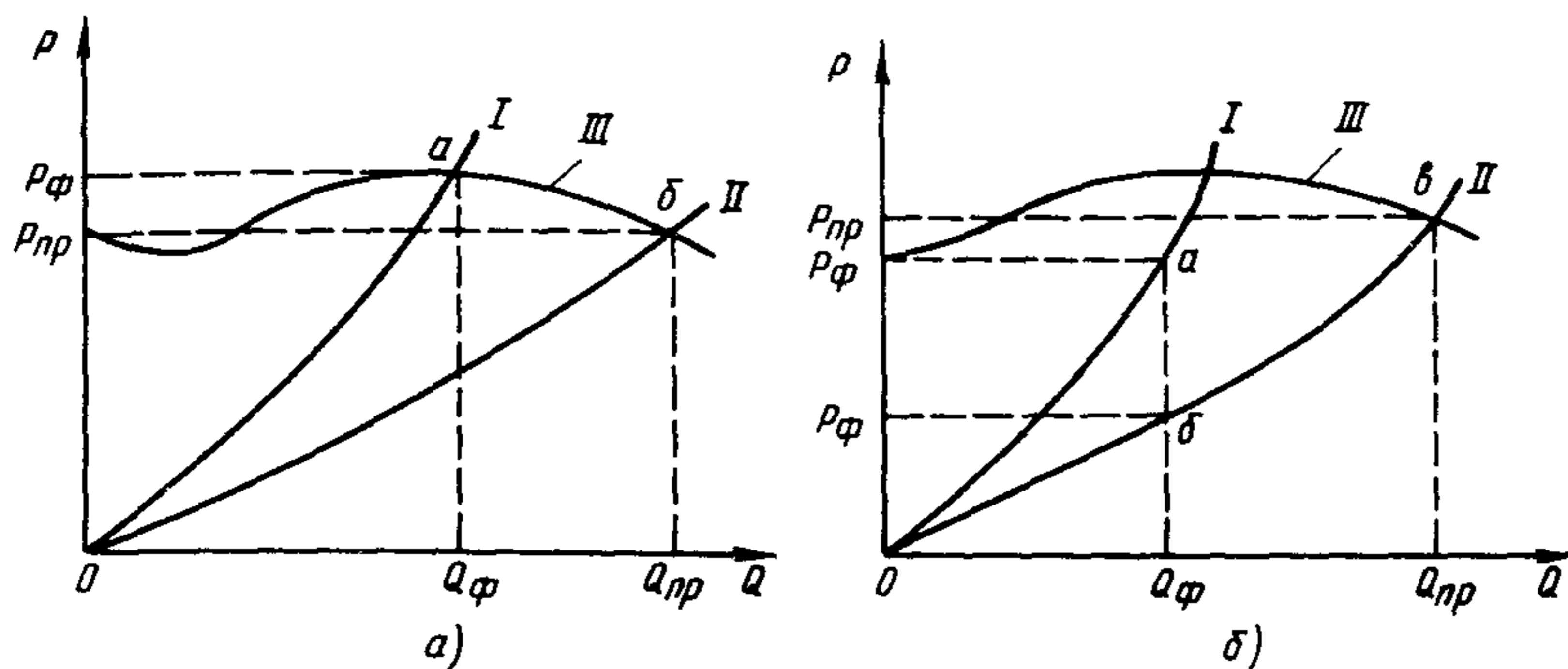
Рис.3.2. Аэродинамическая характеристика вентилятора и воздухоподводящей сети:
