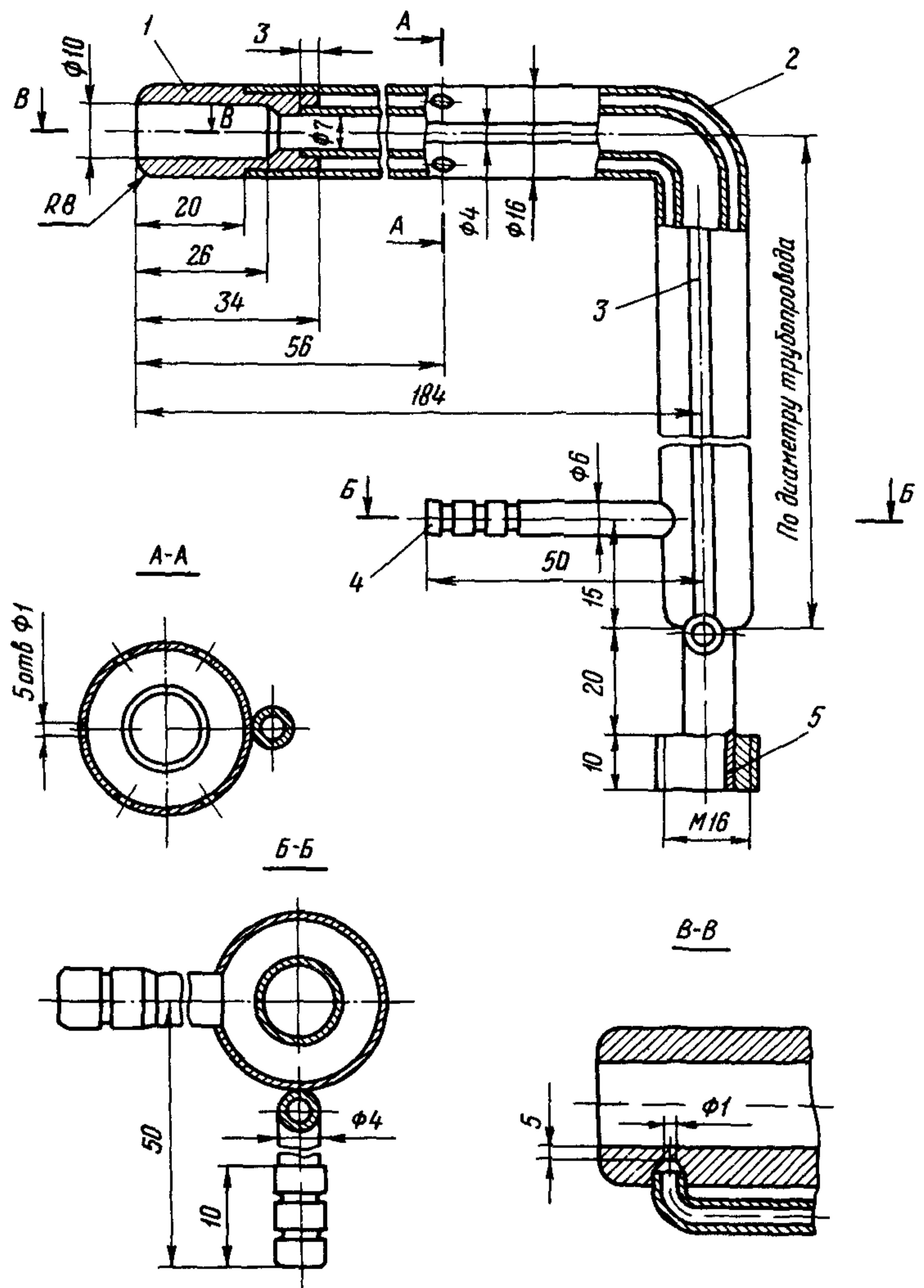
Рис.3.15. Заборная трубка нулевого типа конструкции ВТИ:
