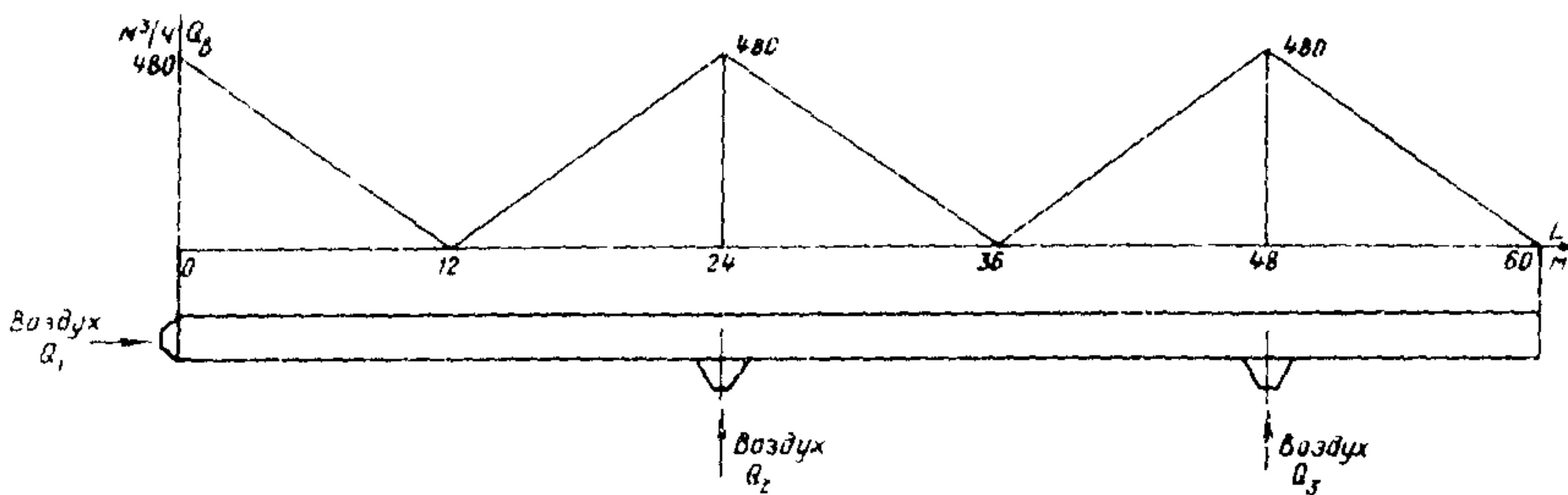
Рис. I8. Эпюра распределения воздуха по длине аэрохода
