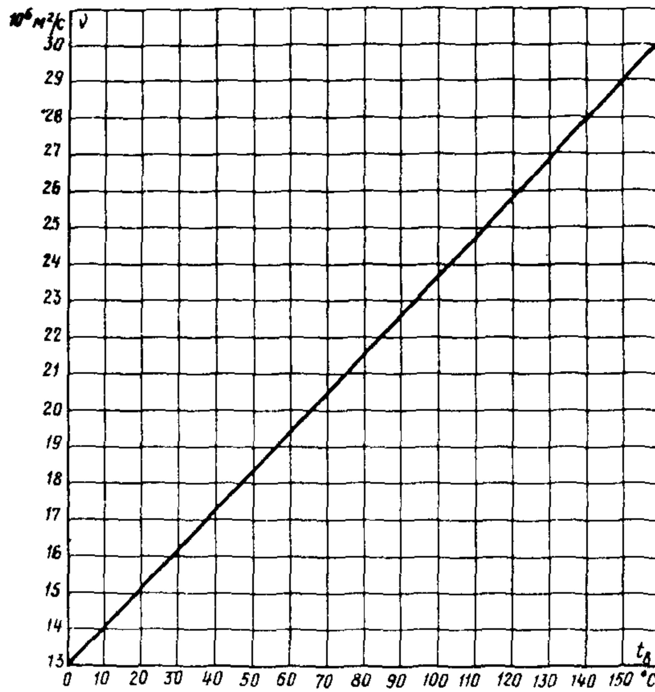
Рис. I7. Зависимость кинематической вязкости воздуха от температуры
