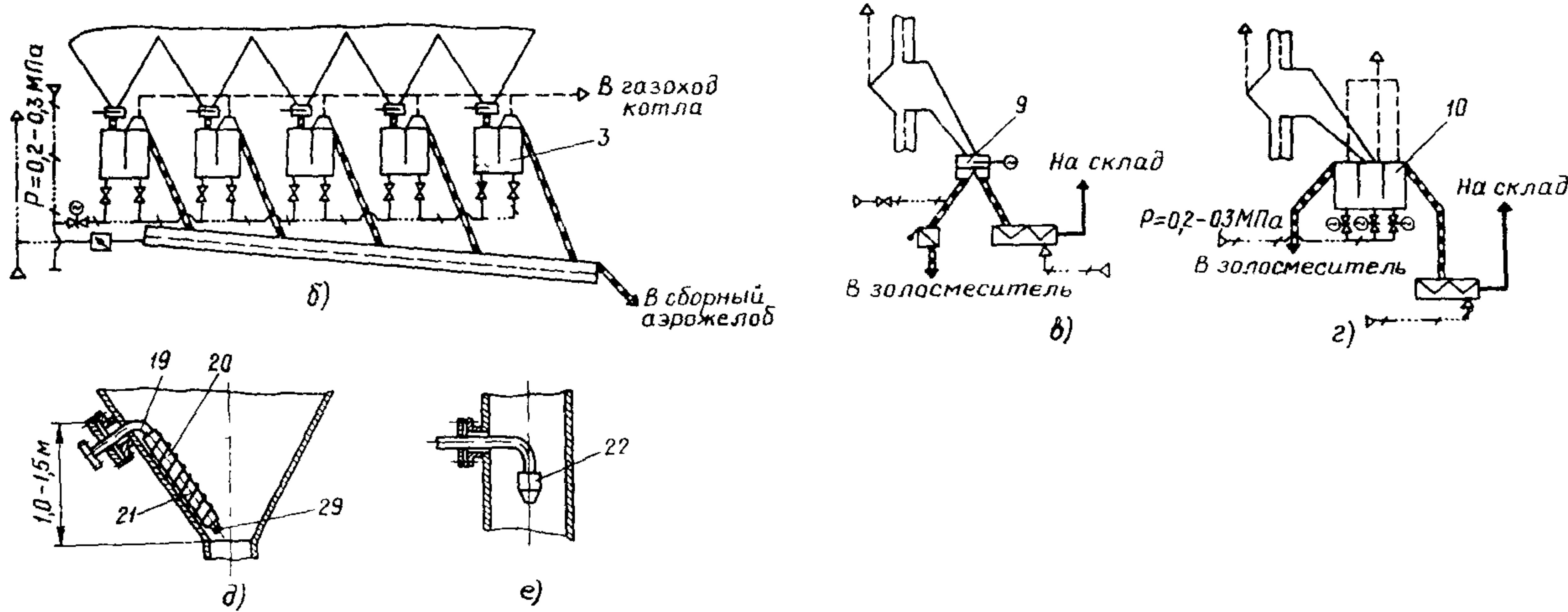
Рис.8. Внутренний пневмотранспорт золы с аэрожелобами:
