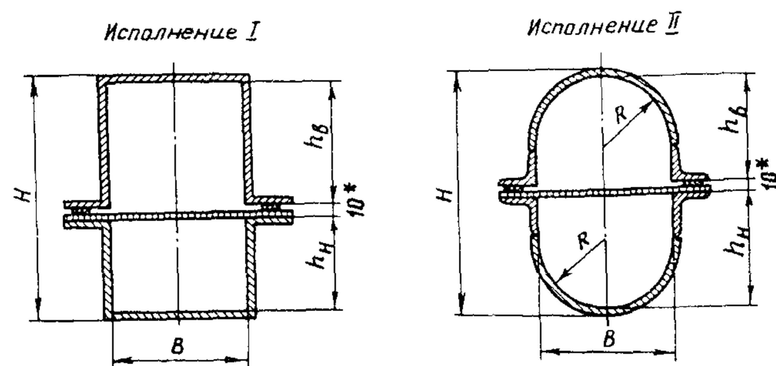
Рис.7. Оптимальные типоразмеры аэрожелобов
