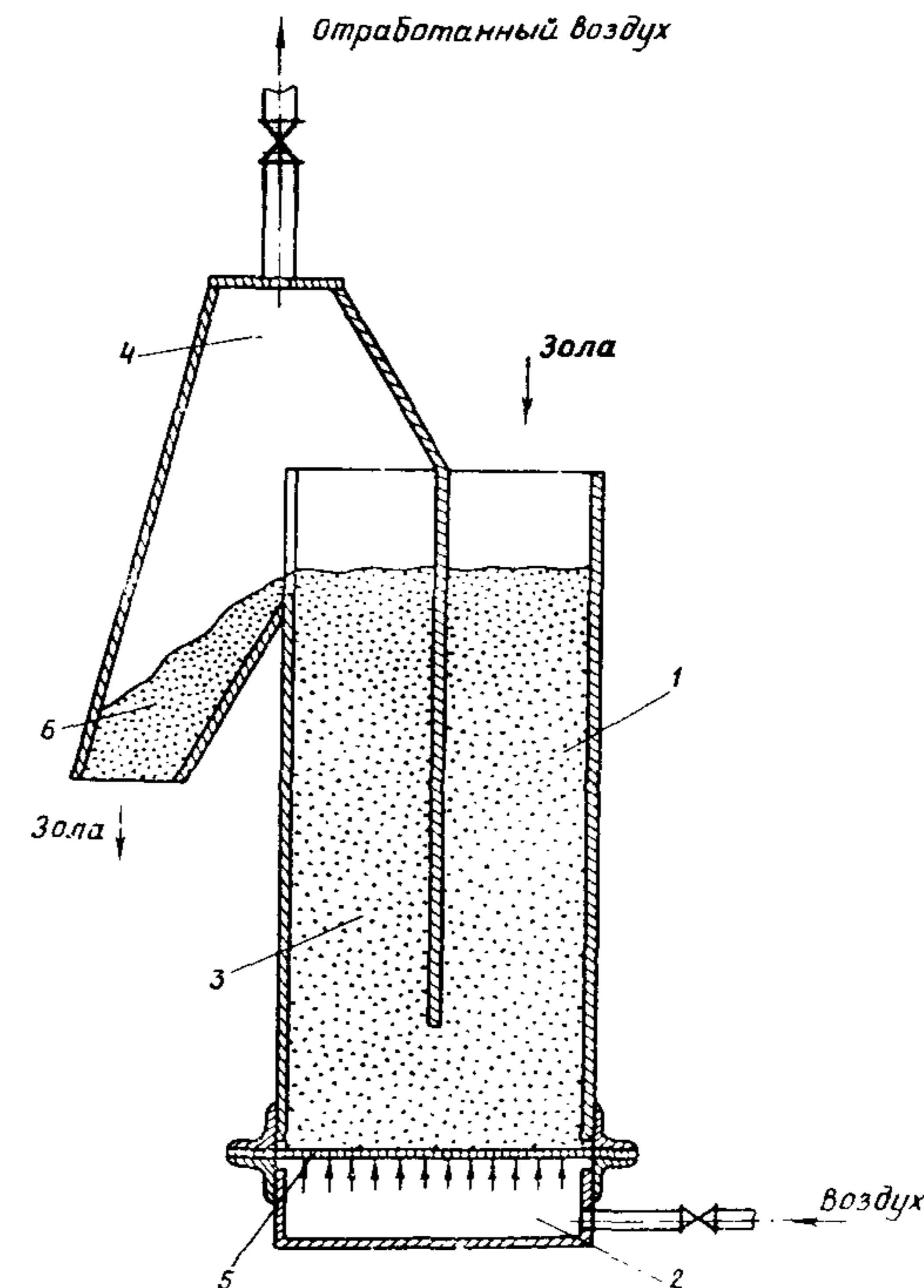
Рис.11. Пневмослоевой затвор:
