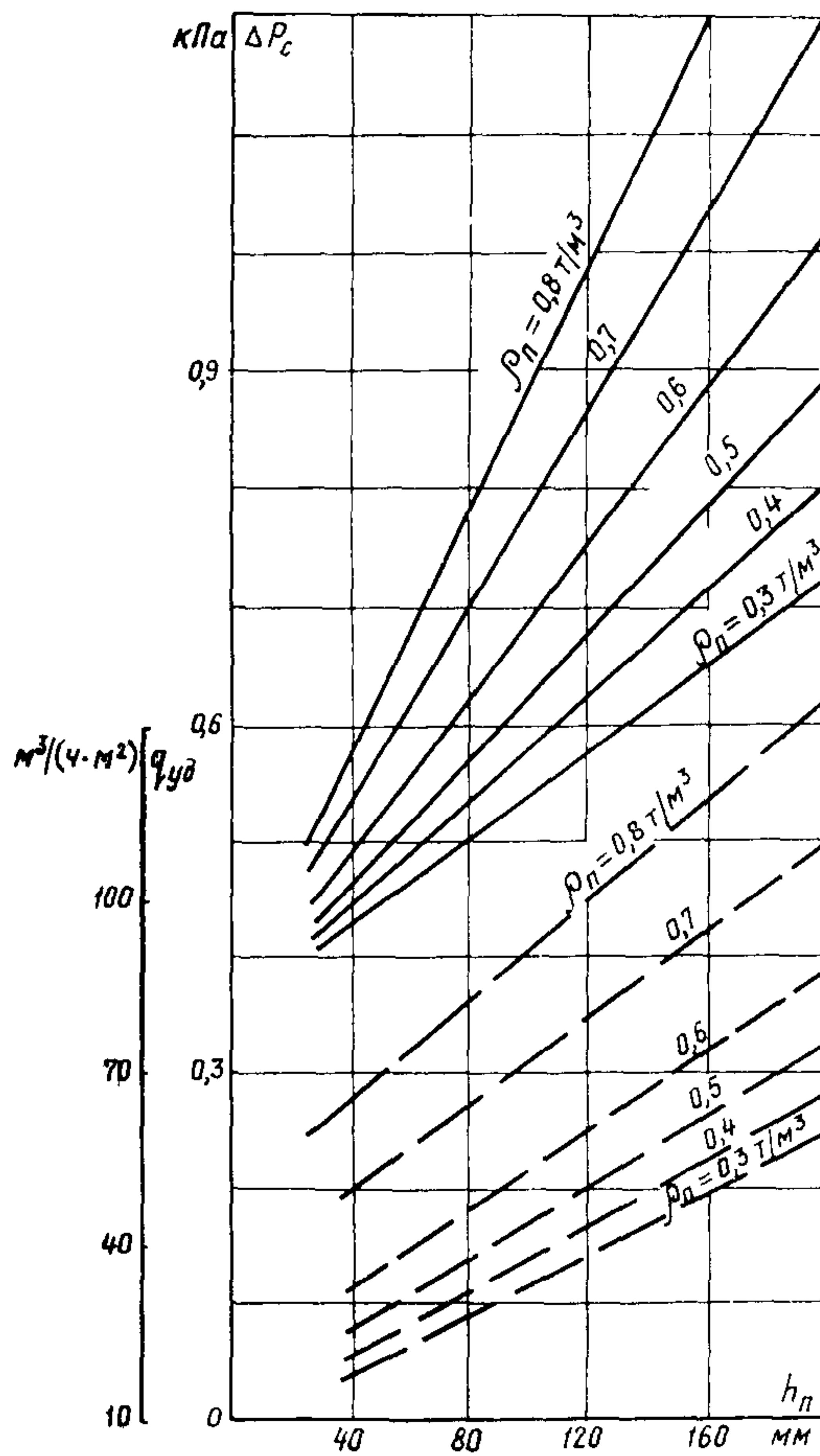
Рис. I.6. Номограмма для определения сопротивления слоя аэропульпы и удельного расхода воздуха
