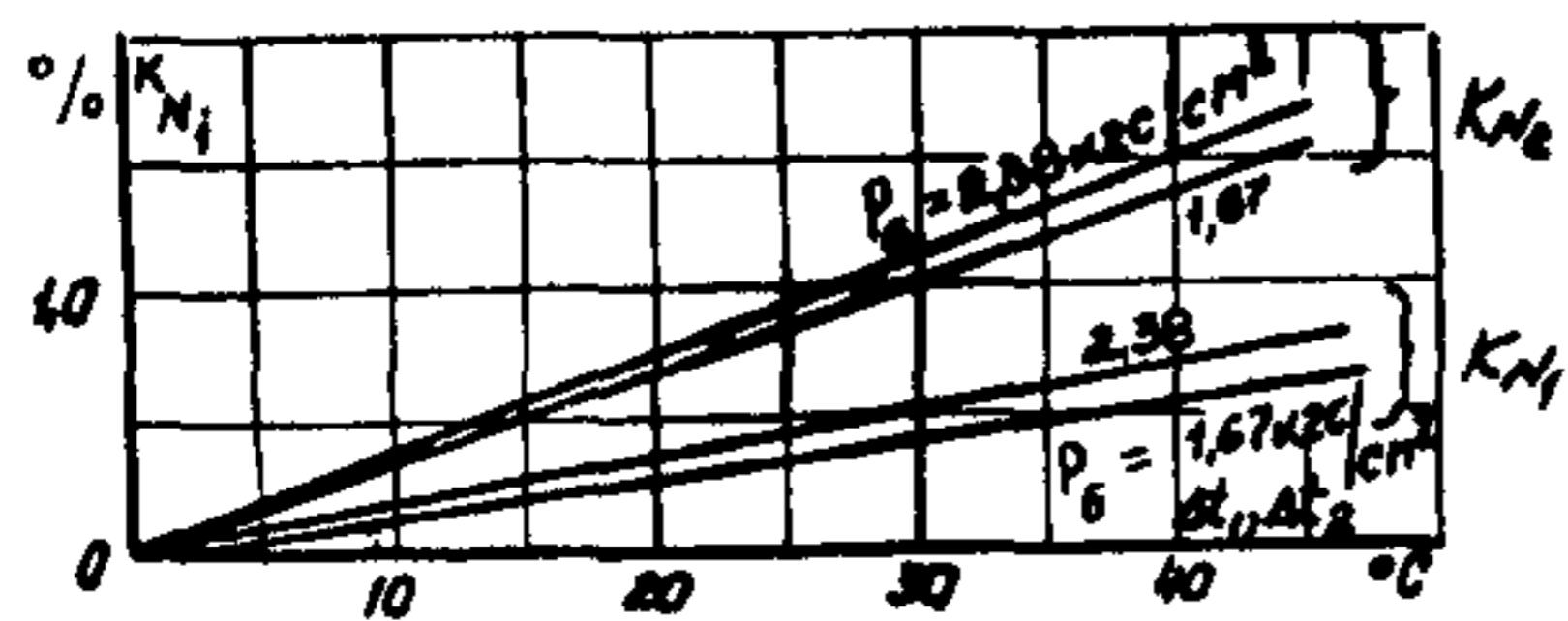
Рис. 19. Дополнительный поправочный коэффициент  $K_{N_i} = f(\Delta t, P_6)$
