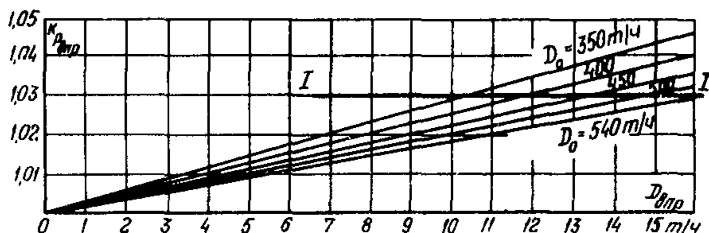
Рис. 21. Дополнительный поправочный коэффициент ( $K'_{P_{bp}}$ ) к давлениям пара в отборах в зависимости от расхода на впрыск в линию горячего промперегрева;
