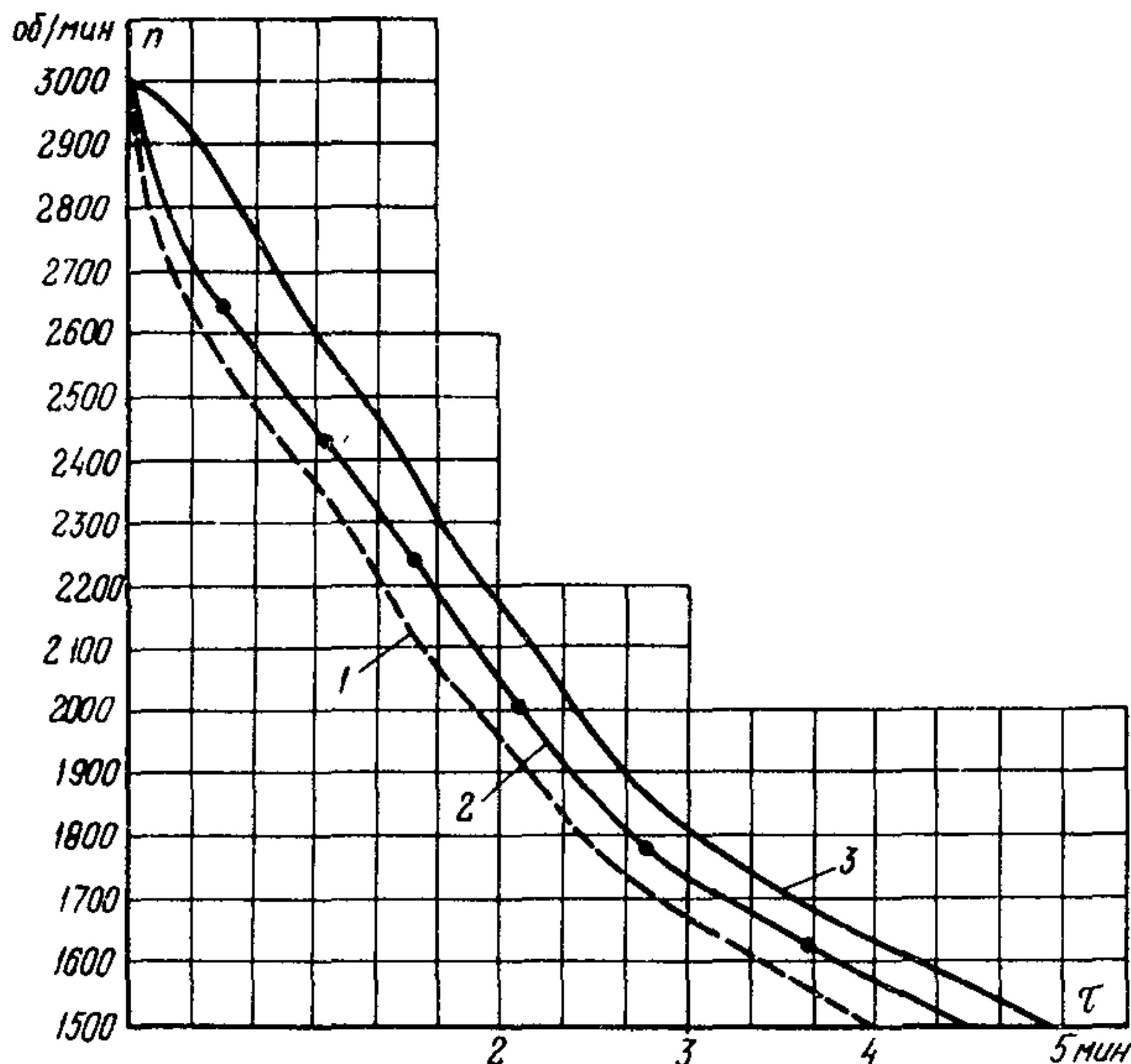
Рис. 27. Плотность органов парораспределения турбины
