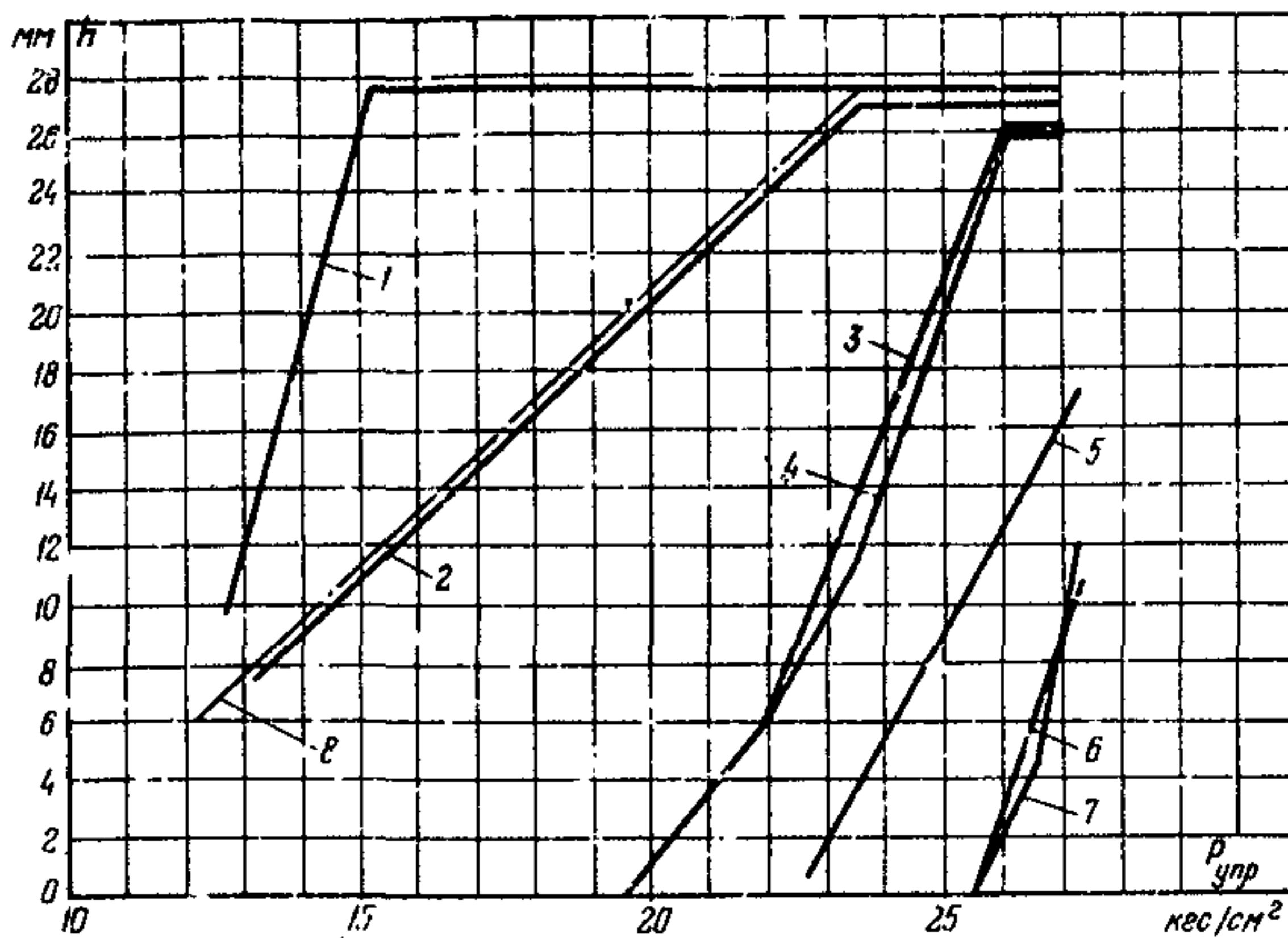
Рис.3. Зависимость хода сервомоторов регулирующих клапанов  $h$  от давления управляющей жидкости  $P_{упр}$  (на примере Лукомльской ГРЭС):
