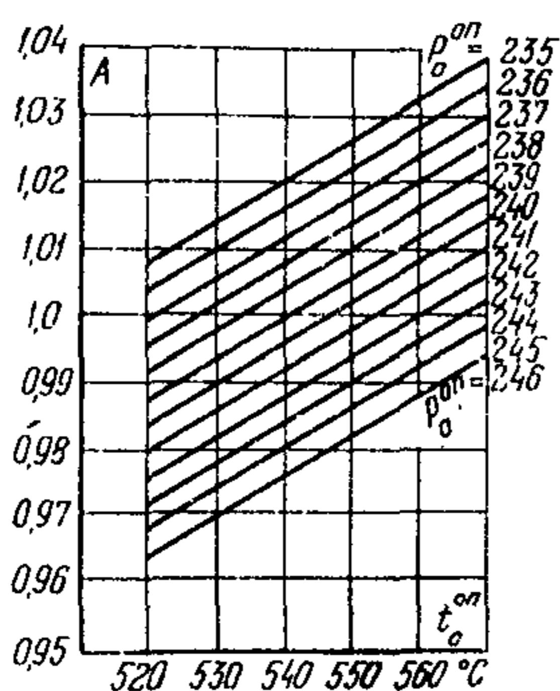
Рис. II. Поправочный коэффициент ( $A$ ) на изменение начального давления и температуры пара:
