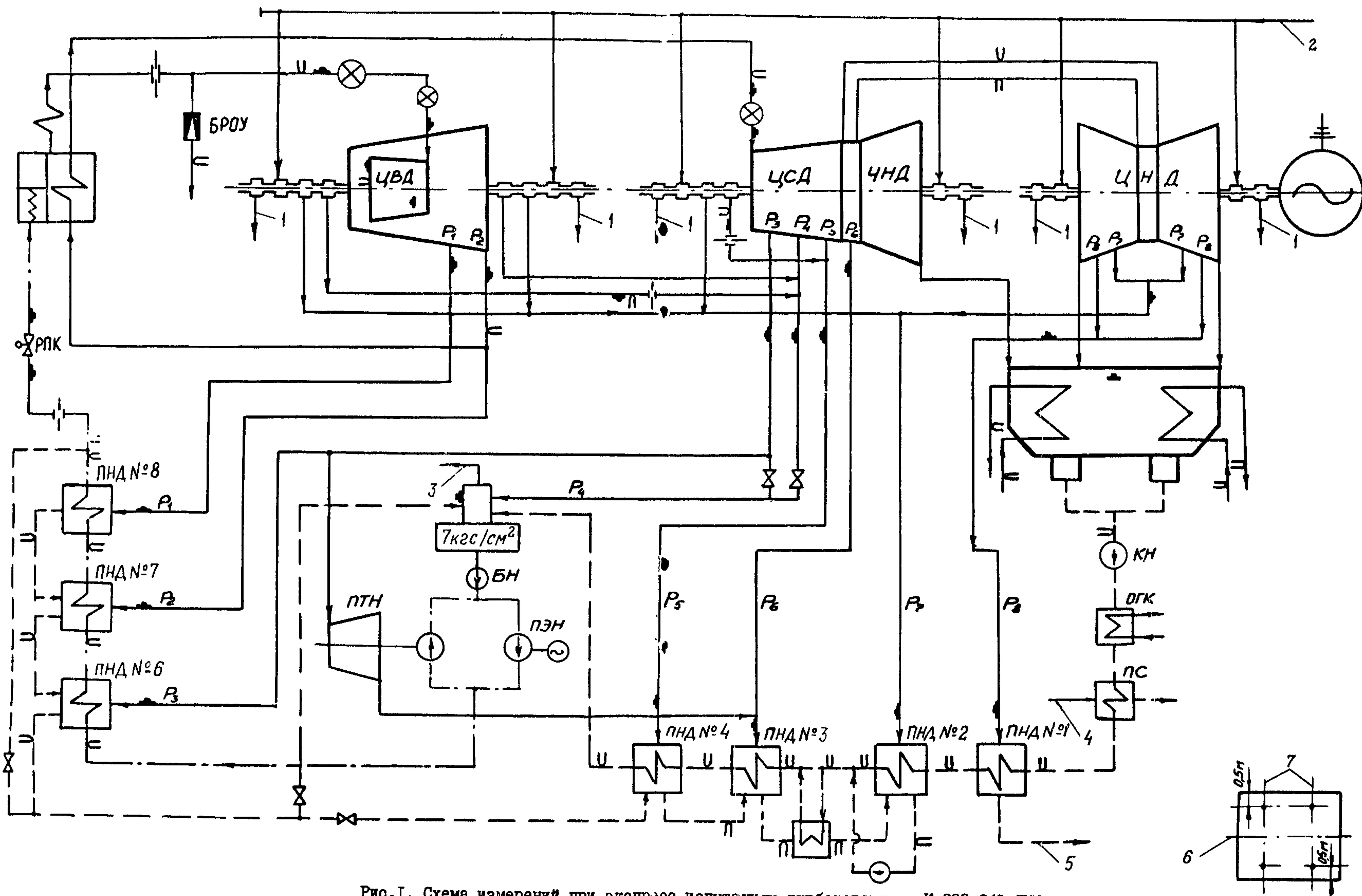
Рис. I. Схема измерений при экспресс-испытаниях турбоустановки К-300-240 ЛМЗ:
