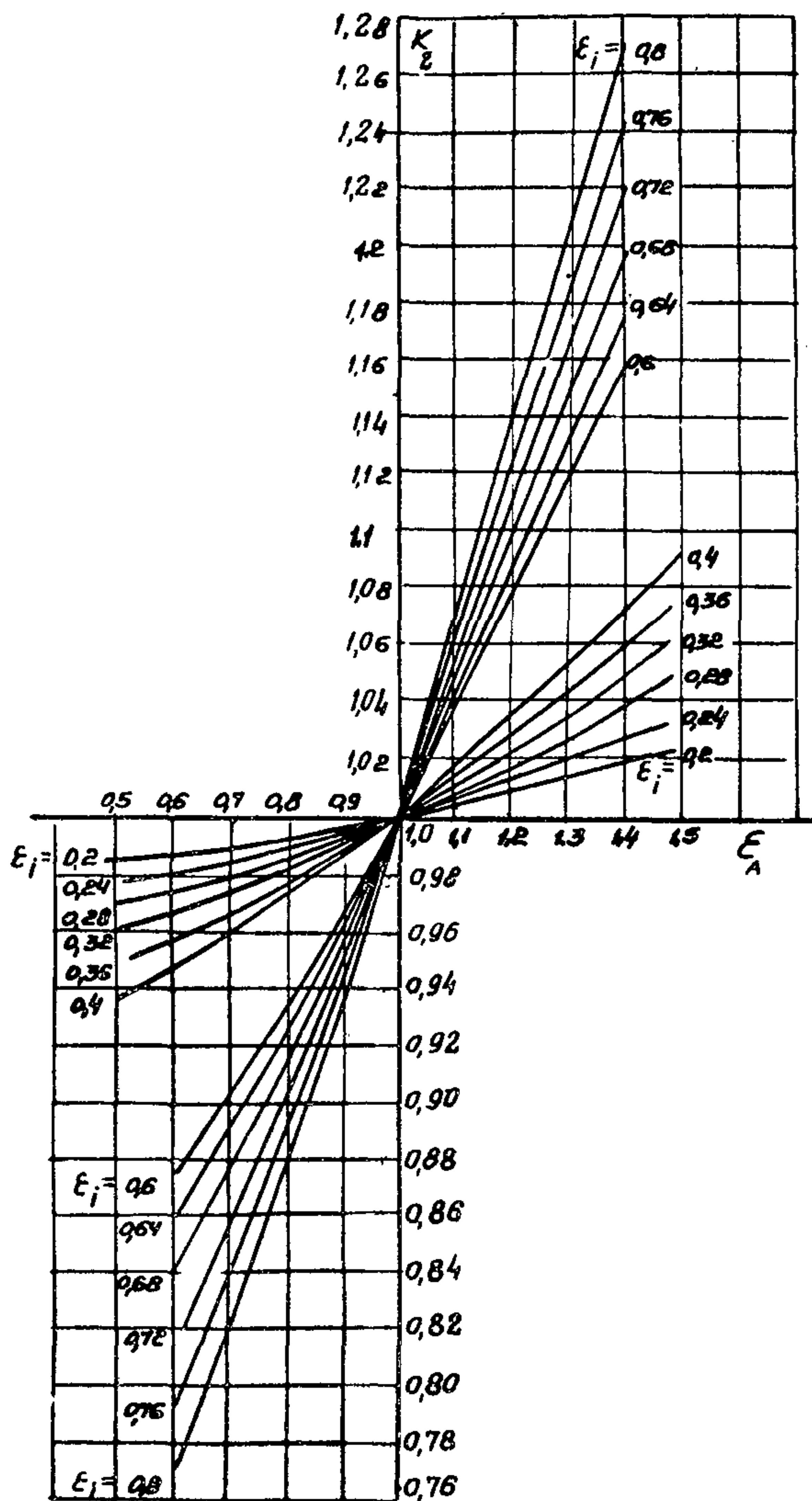
Рис. I4. Поправочный коэффициент для пересчета давлений по формуле Флюгеля:
