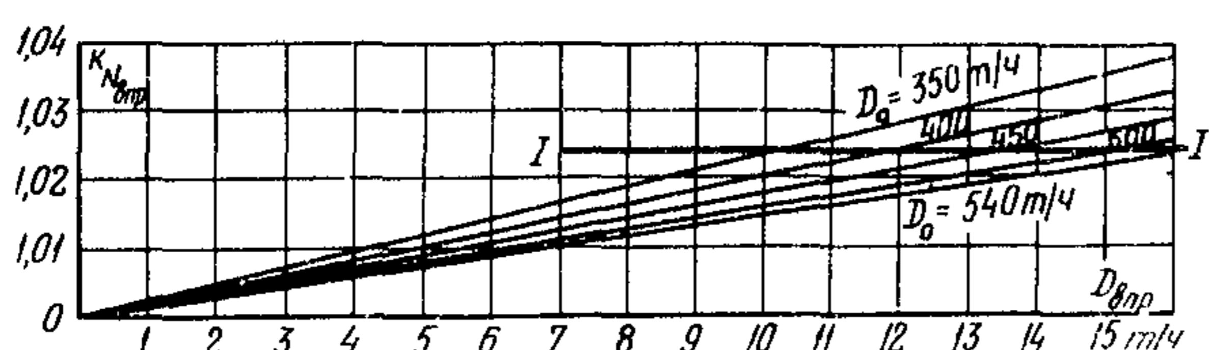
Рис. 22. Дополнительный поправочный коэффициент ( $K'_{N_{bp}}$ ) к мощности турбины в зависимости от расхода на впрыск в линию горячего промперегрева;
