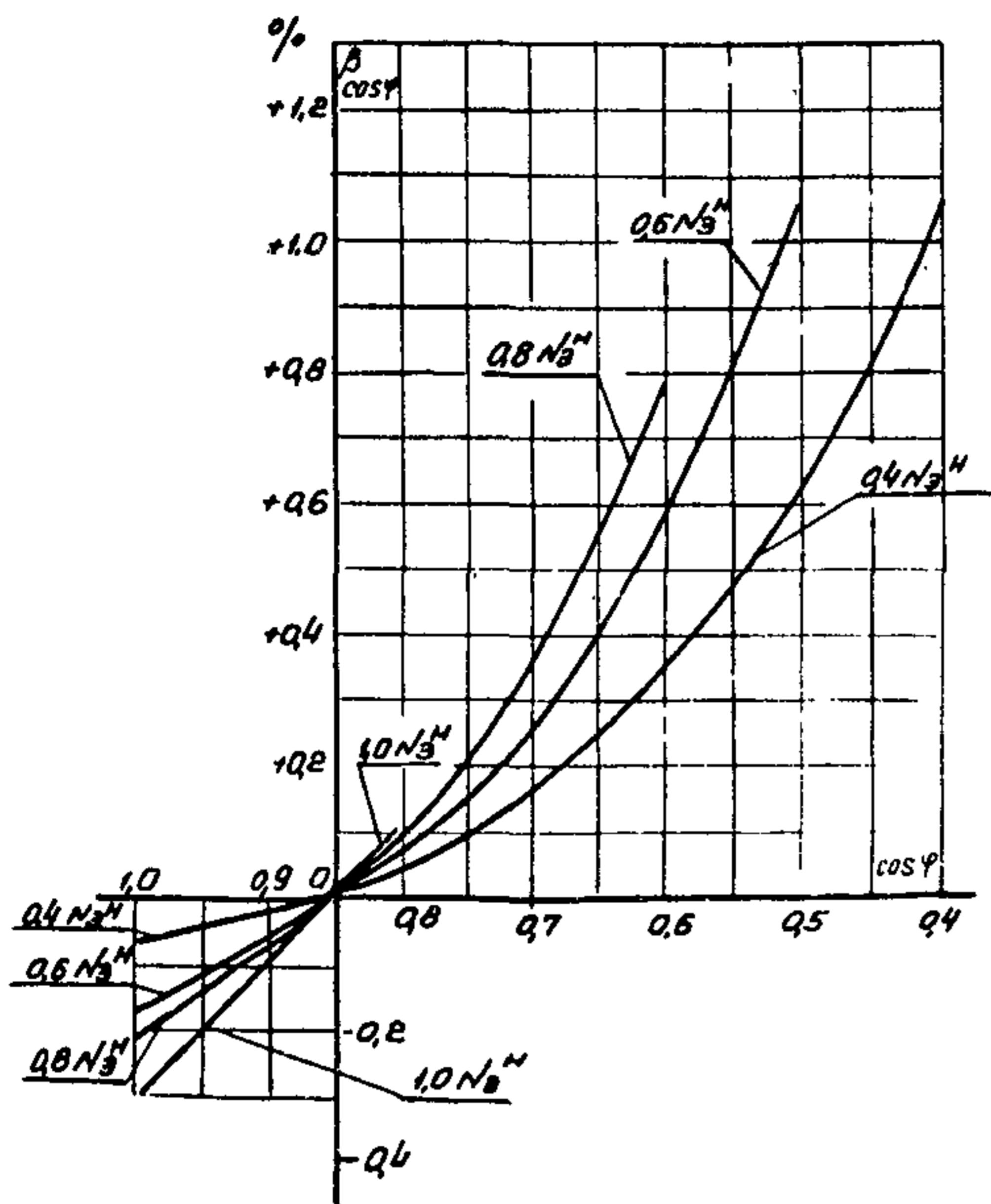
Рис. I7. Поправка к мощности на отклонение  $\cos \varphi$  от номинального
