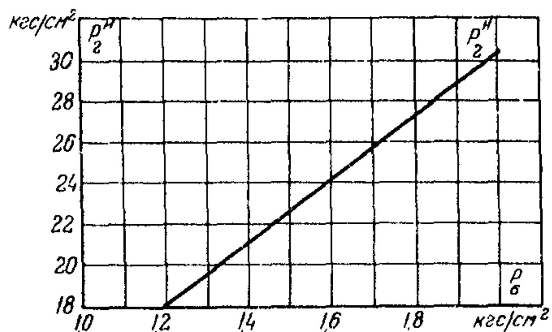
Рис. I3. Зависимость приведенного давления за ЦВД от давления в контрольной ступени
