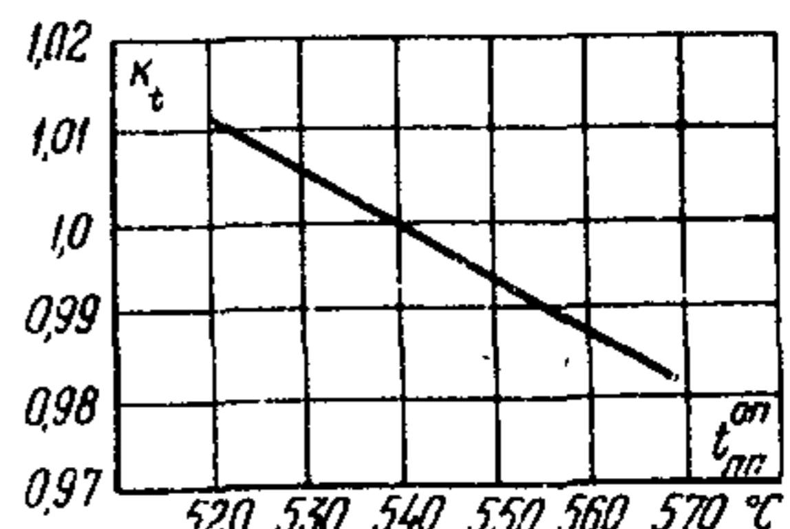
Рис. I2. Поправочный коэффициент ( $k_t$ ) на изменение температуры пара промперегрева:
