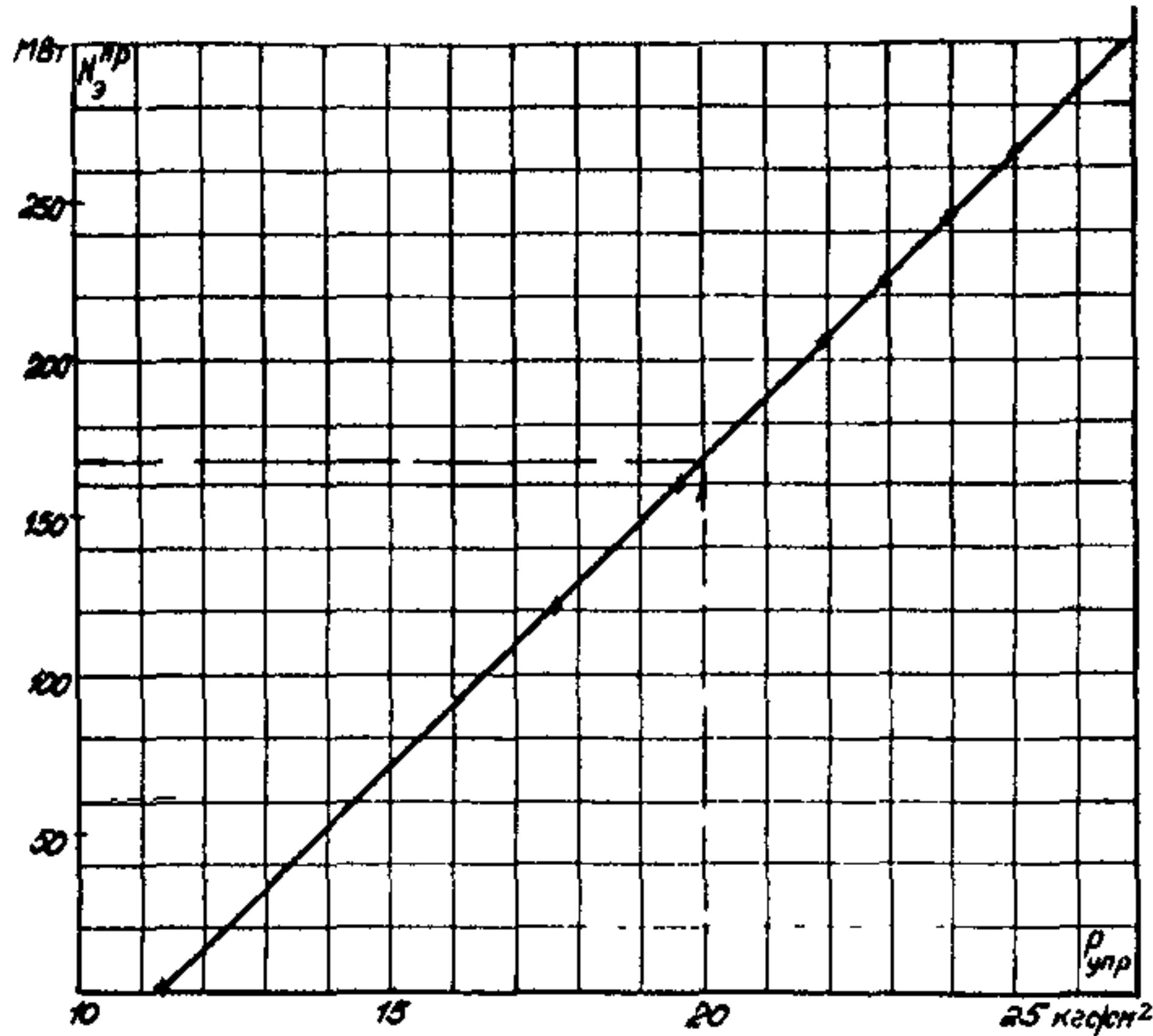
Рис. 25. Характеристика нагружения турбины (на примере Лукомльской ГРЭС):
