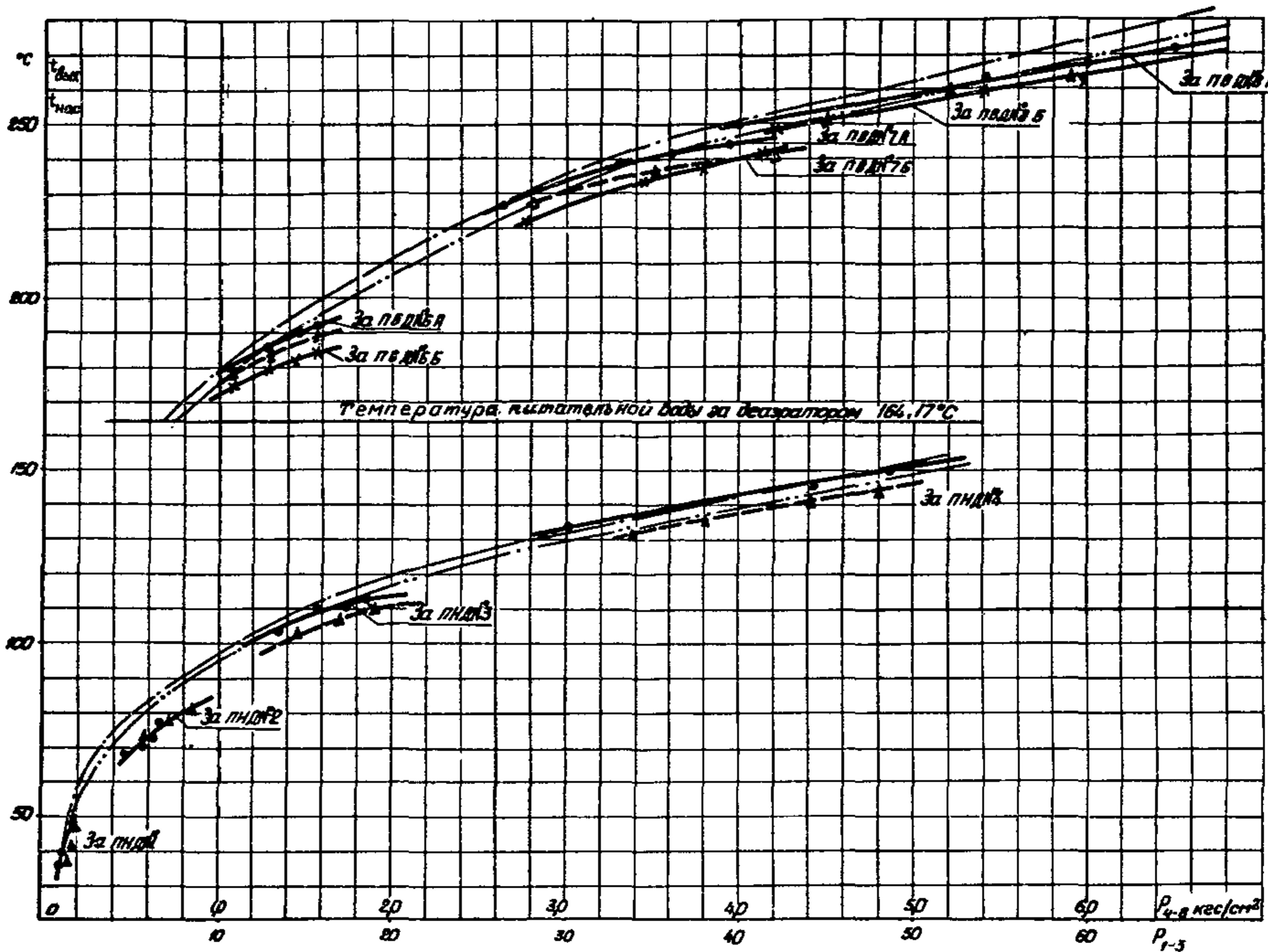
Рис. 23. Зависимость температуры воды за подогревателями от давления пара в камерах отборов
