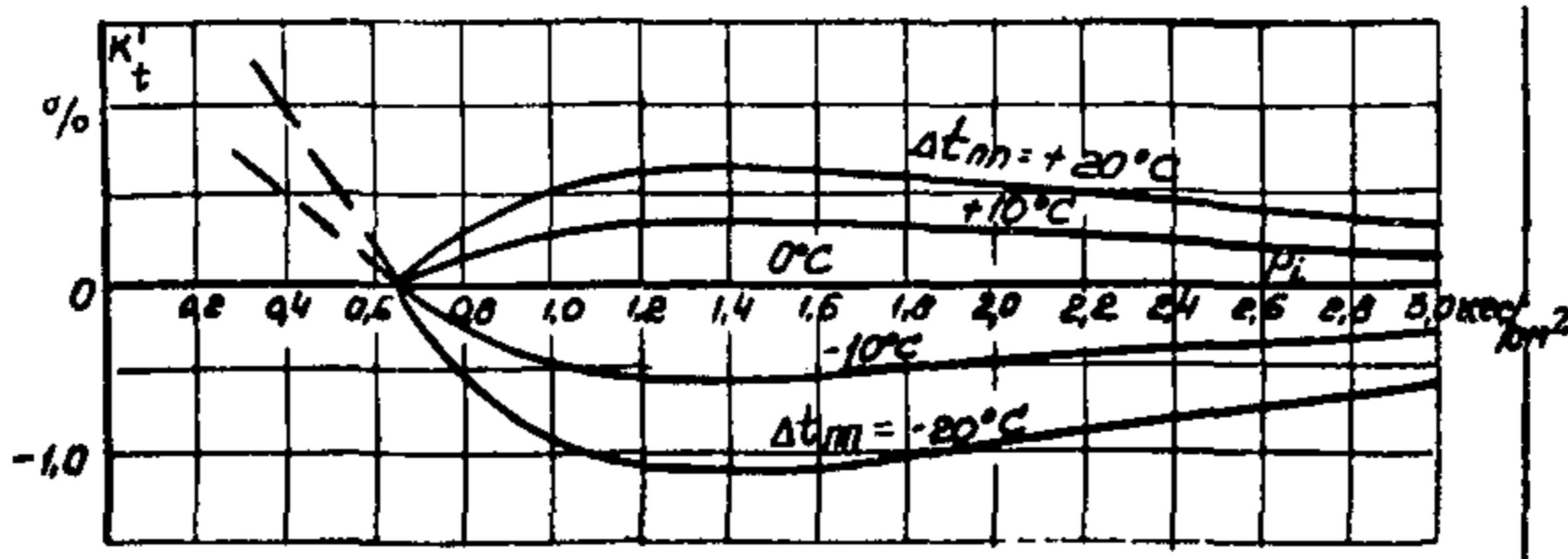
Рис. 20. Дополнительный поправочный коэффициент  $K'_t$  к давлениям пара в отборах  $P_i$  от температуры в линии горячего промперегрева  $\Delta t_{pp}$ ;
