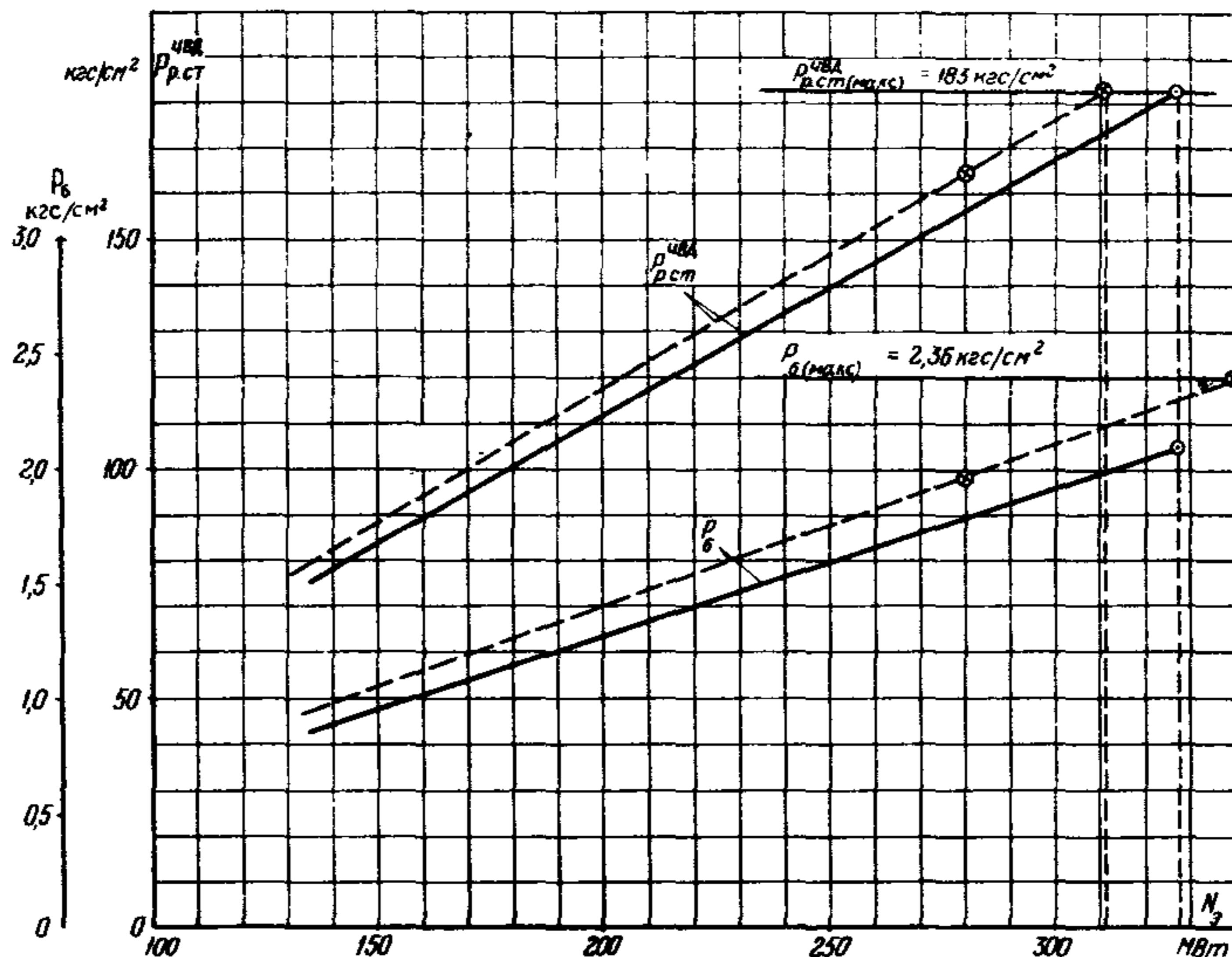
Рис. 4. Графическое определение максимальной электрической нагрузки при максимальном давлении в контрольной ступени (на примере Лукомльской ГРЭС):
