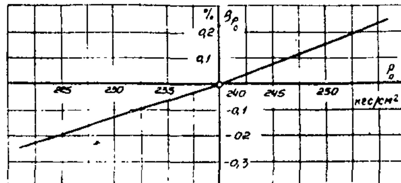
Рис. 8. Поправка к мощности на отклонение давления свежего пара от номинального
