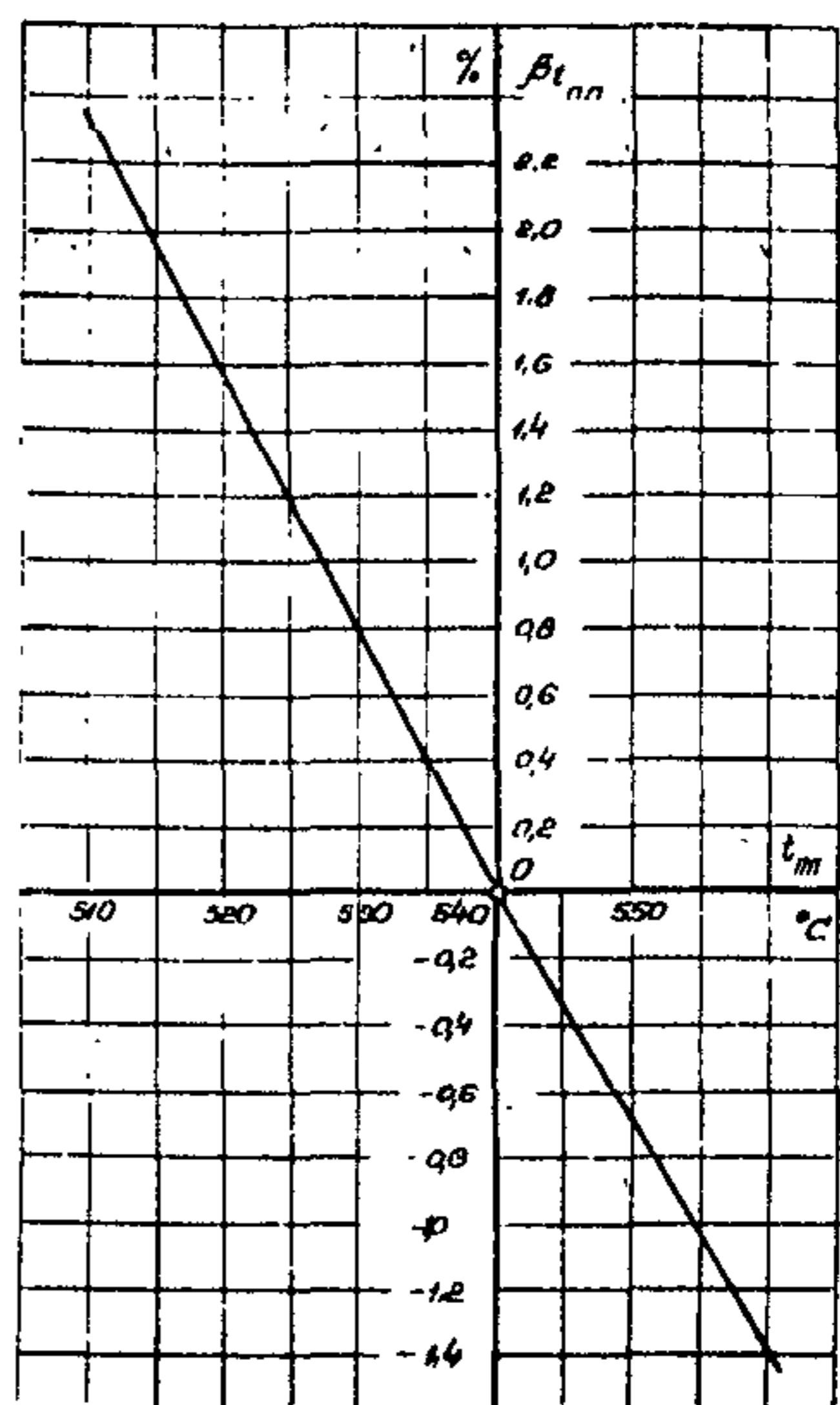
Рис. 10. Поправка к мощности на отклонение температуры пара промперегрева от номинальной
