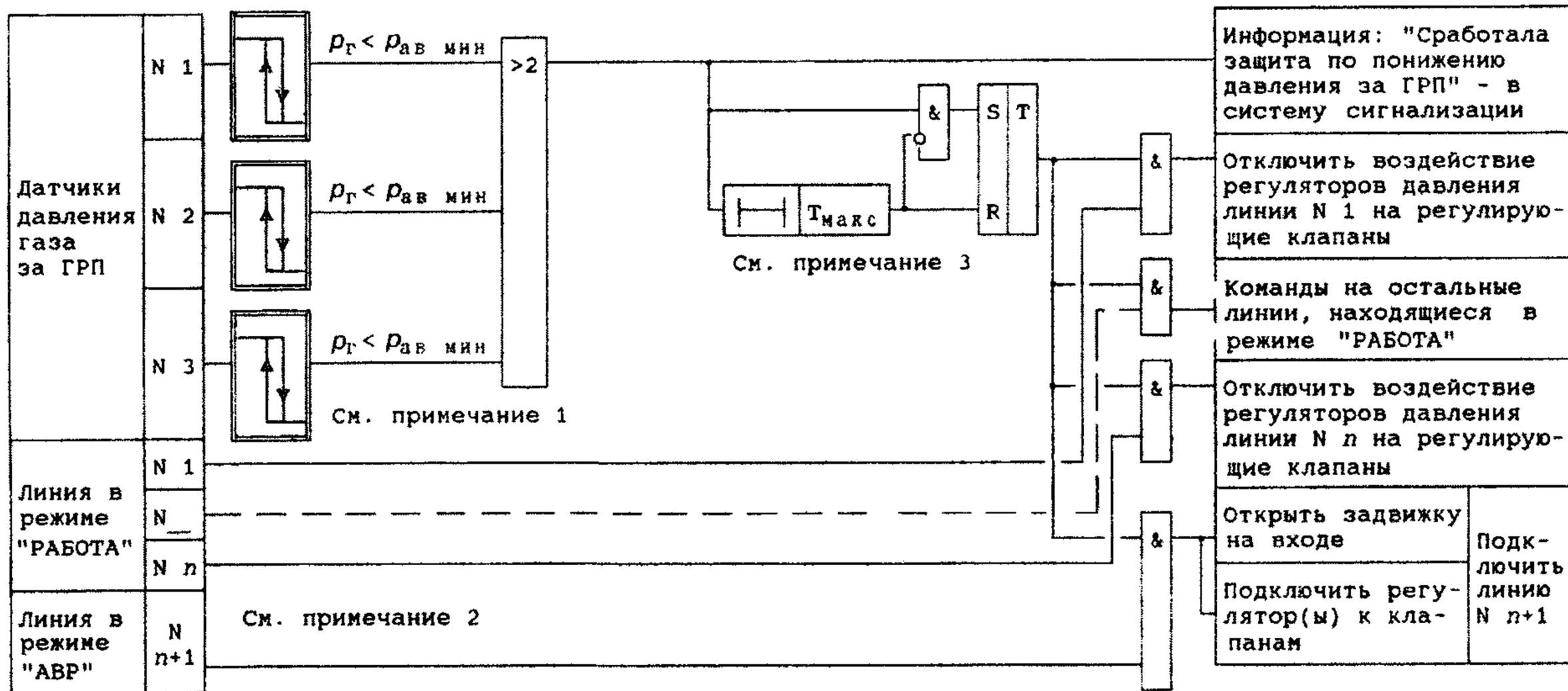
**Рис. 4. Структурная схема защиты по понижению давления газа за ГРП.**
