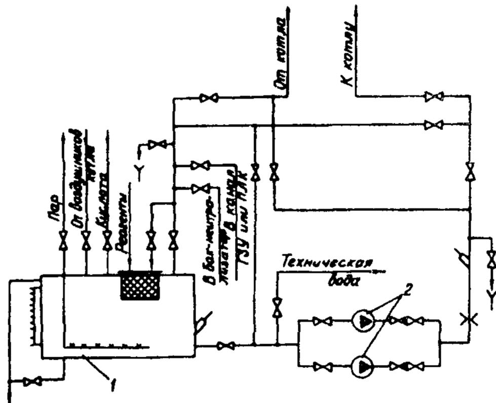
**Рис. 1. Схема установки для химической очистки котла:**
