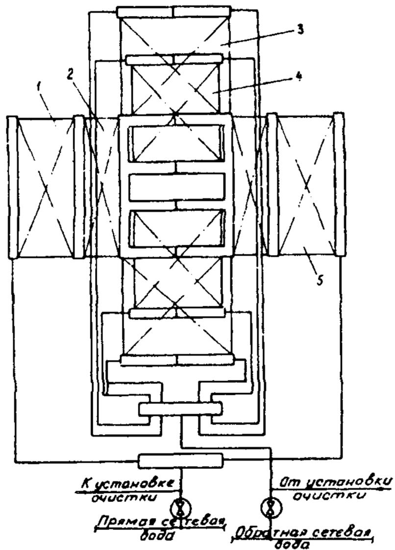
**Рис. 6. Схема химической очистки котла ПТВМ-180 (двухходовая схема):**
