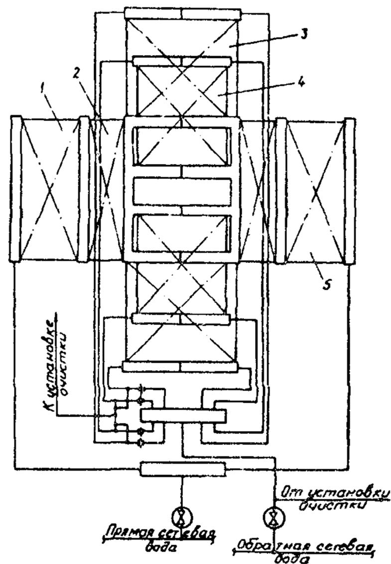
**Рис. 7. Схема химической очистки котла ПТВМ-180 (четырёхходовая схема):**
