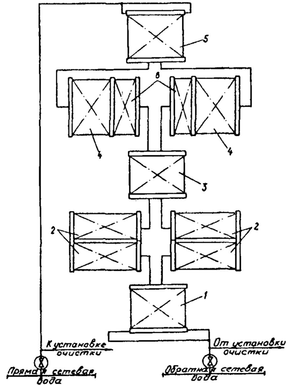
Рис. 4. Схема химической очистки котла KBGM-100 (основной режим):
