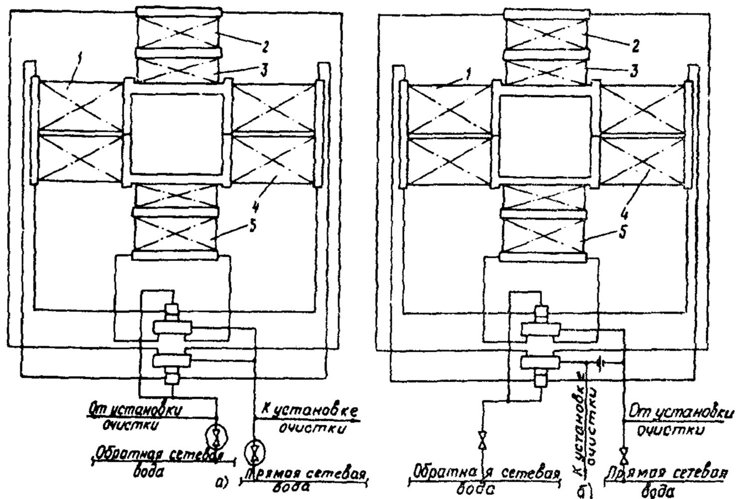
**Рис. 5. Схема химической очистки котла ПТВМ-100:**
