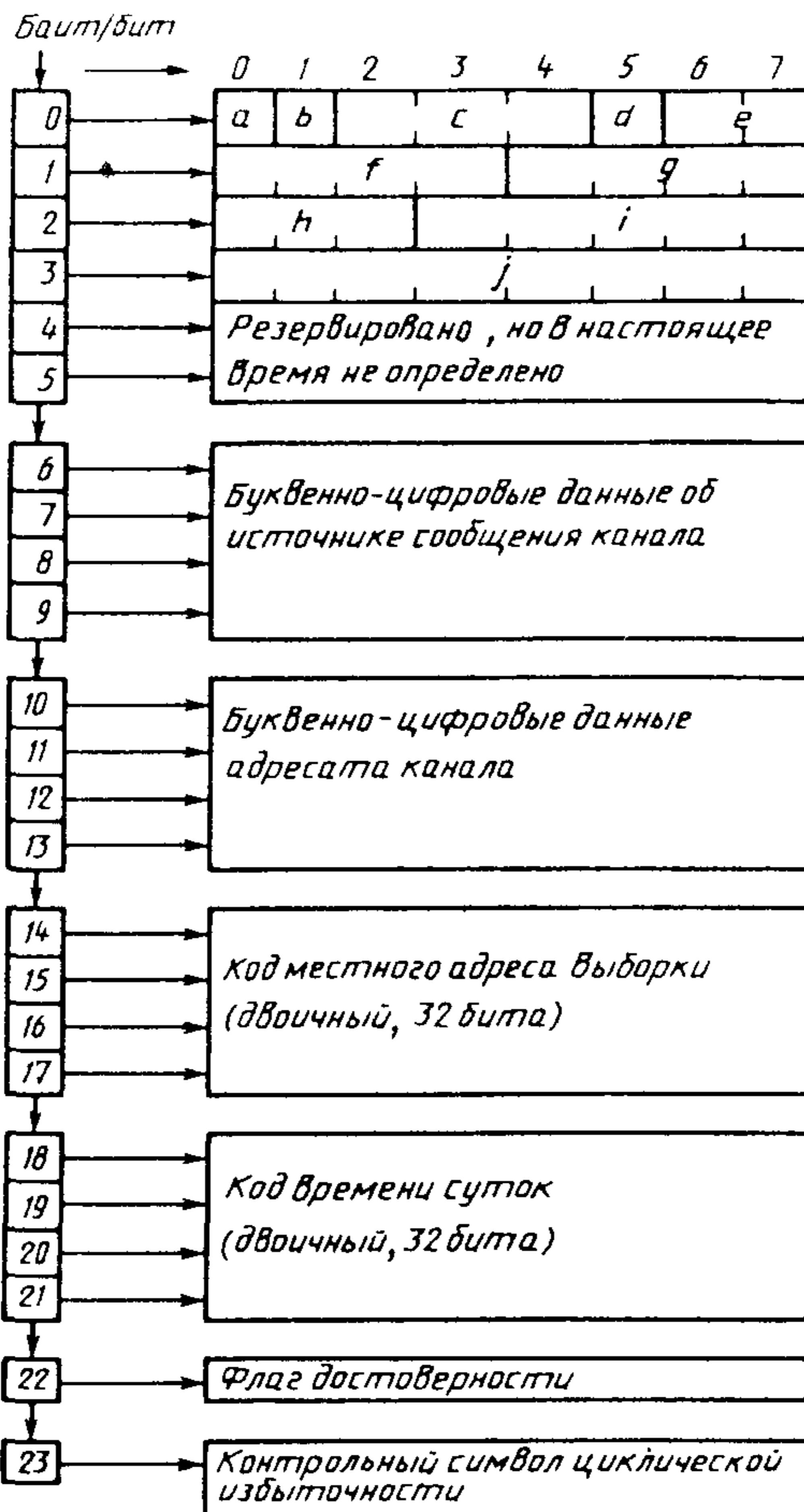
*a* – применение блока канала статуса; *b* – режим звуковой/незвуковой; *c* – предыскажения звукового сигнала; *d* – синхронизация дискретизации источника сообщения; *e* – частота дискретизации; *f* – режим канала; *g* – управление битами пользователя; *h* – использование вспомогательных битов выборки; *i* – длина слова источника сообщения и предыстория кодирования в источнике сообщения; *j* – описание будущих многоканальных функций
