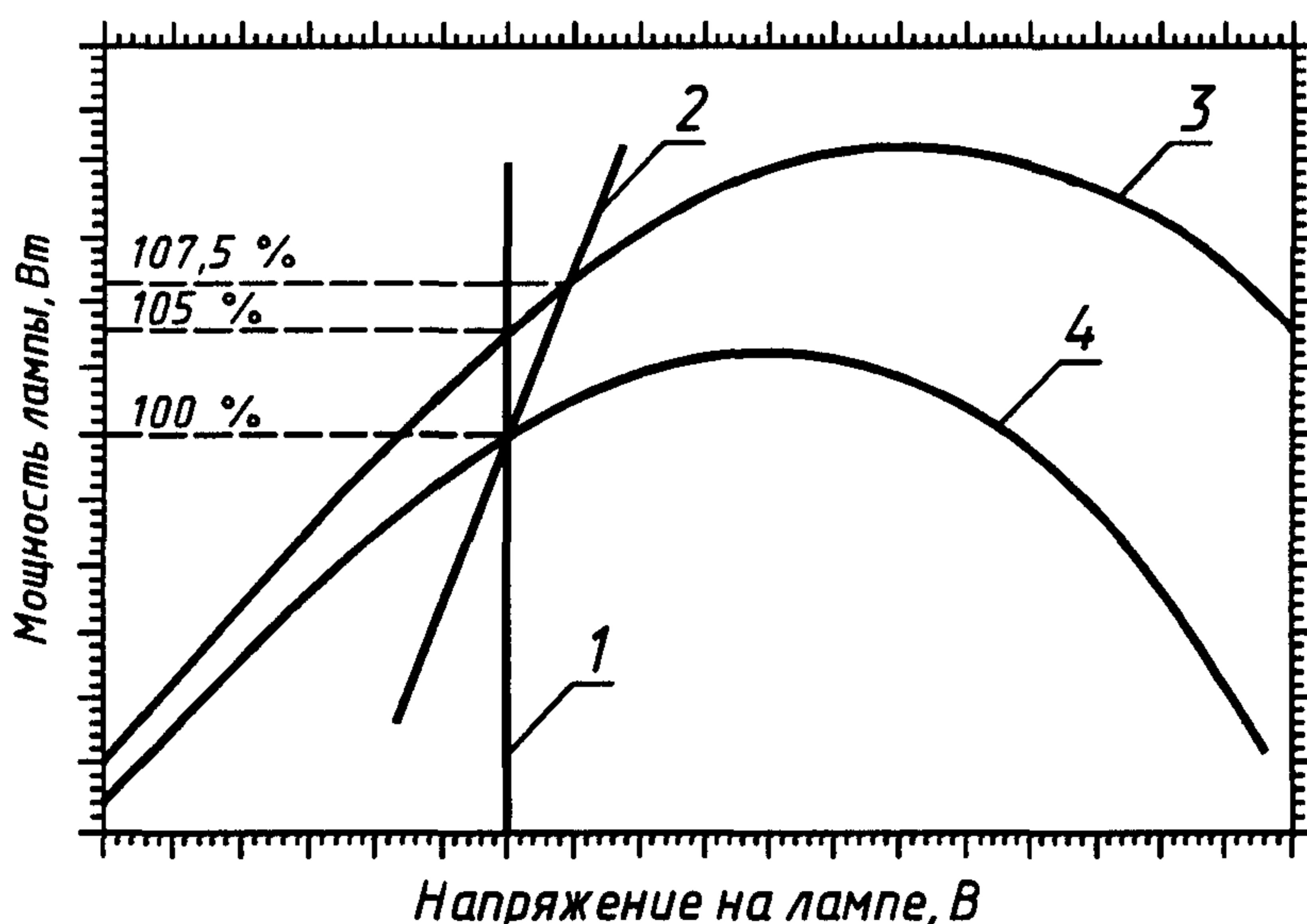
1 — рабочее напряжение на клеммах ламп; 2 — типичная наклонная характеристика лампы; 3 — характеристика испытуемого ПРА, имеющего предельное значение полного сопротивления при номинальном напряжении; 4 — характеристика ДОИ при номинальном напряжении
