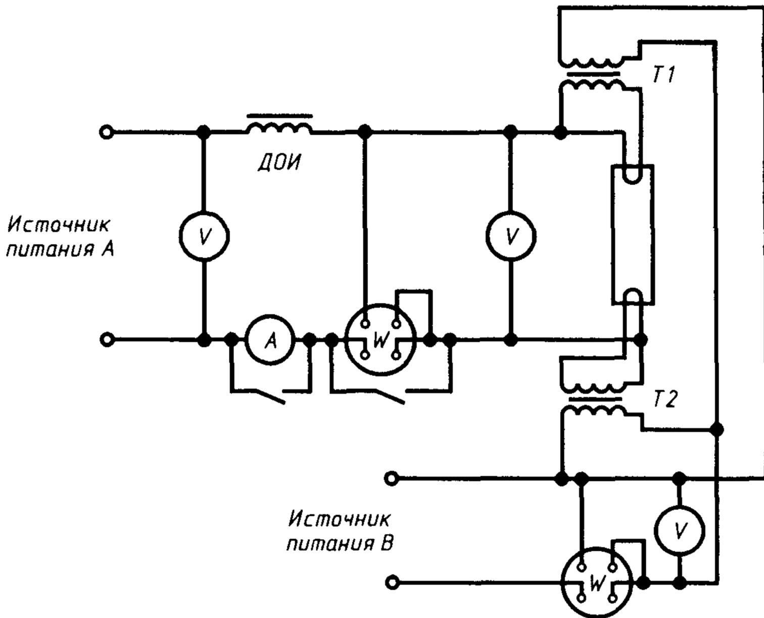
Примечание — Трансформаторы  $T1$  и  $T2$  могут иметь разные источники питания при условии, что напряжения будут иметь одну фазу.
