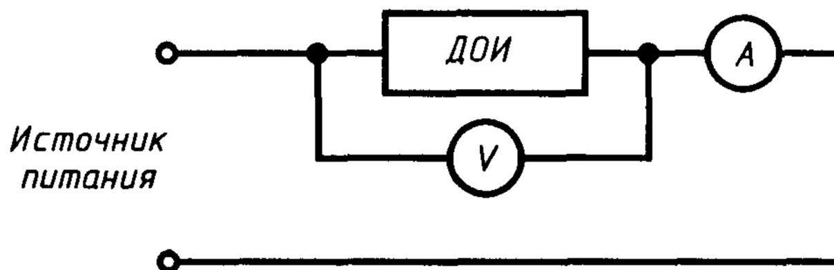
Рисунок 1 — Схема измерения отношения напряжение/ток
