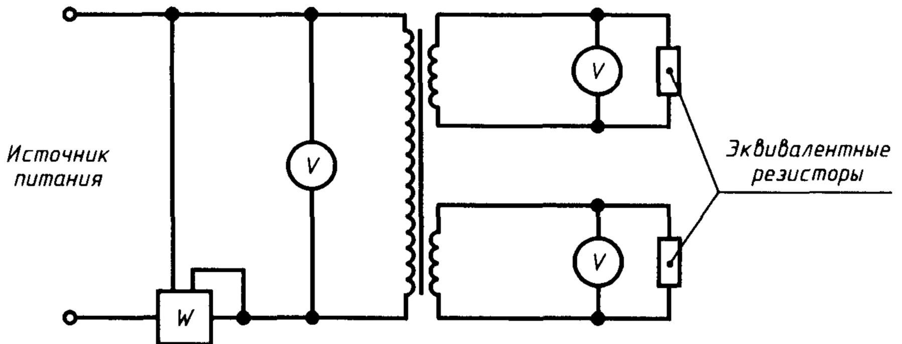
Рисунок 5 — Схема калибровки трансформаторов предварительного подогрева
