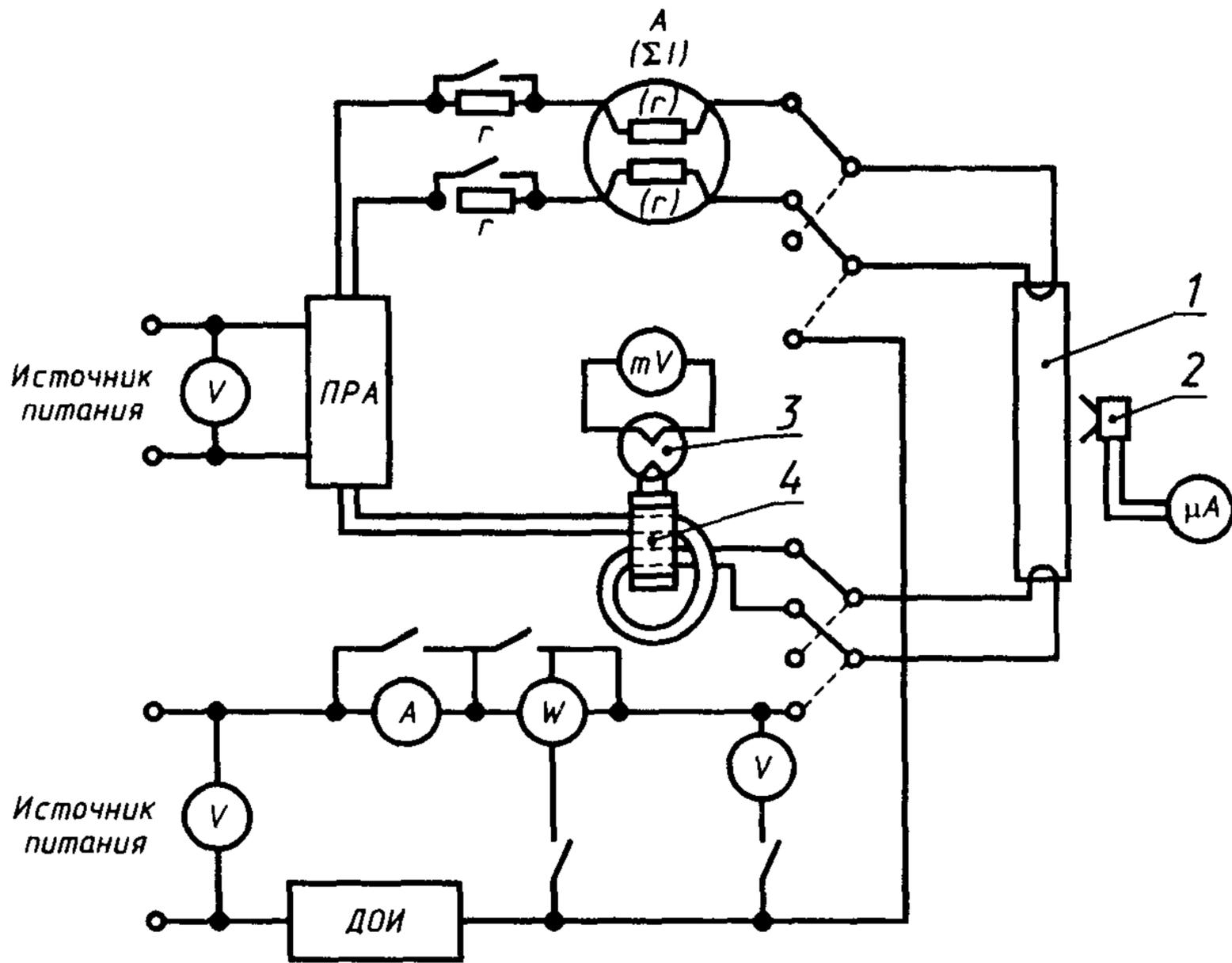
1 — номинальная лампа, 2 — фотозаэлемент, 3 — термопреобразователь,
