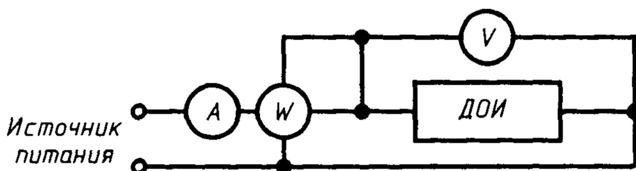
Рисунок 2 — Схема измерения коэффициента мощности
