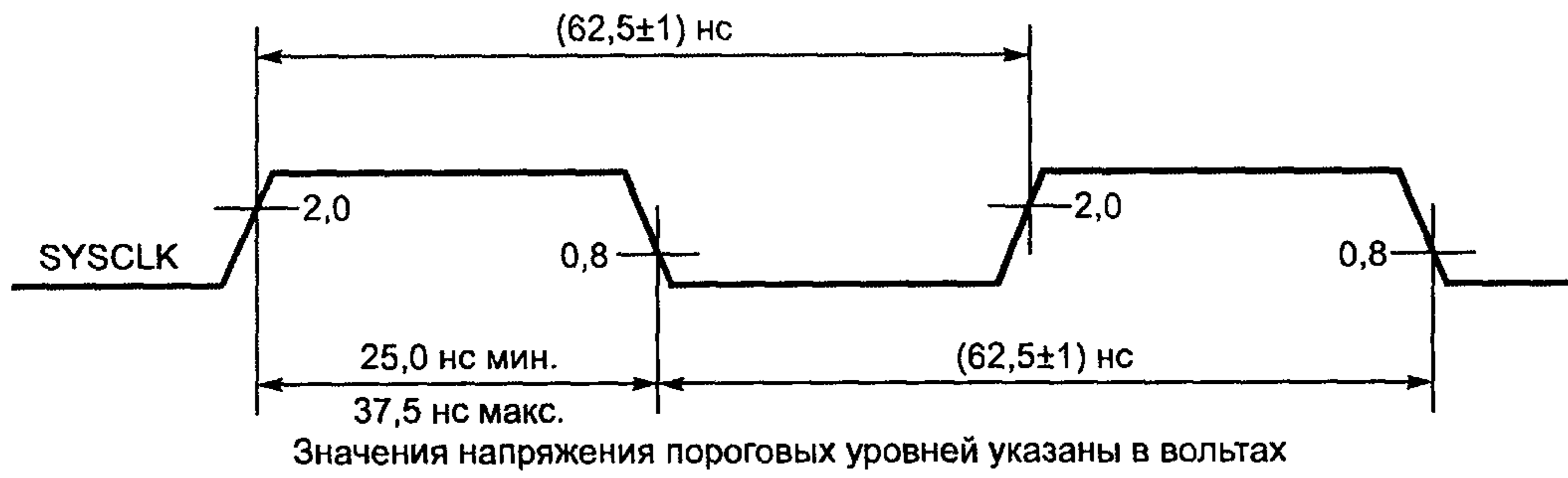
Рисунок 5.2 — Временная диаграмма работы формирователя системного тактового сигнала
