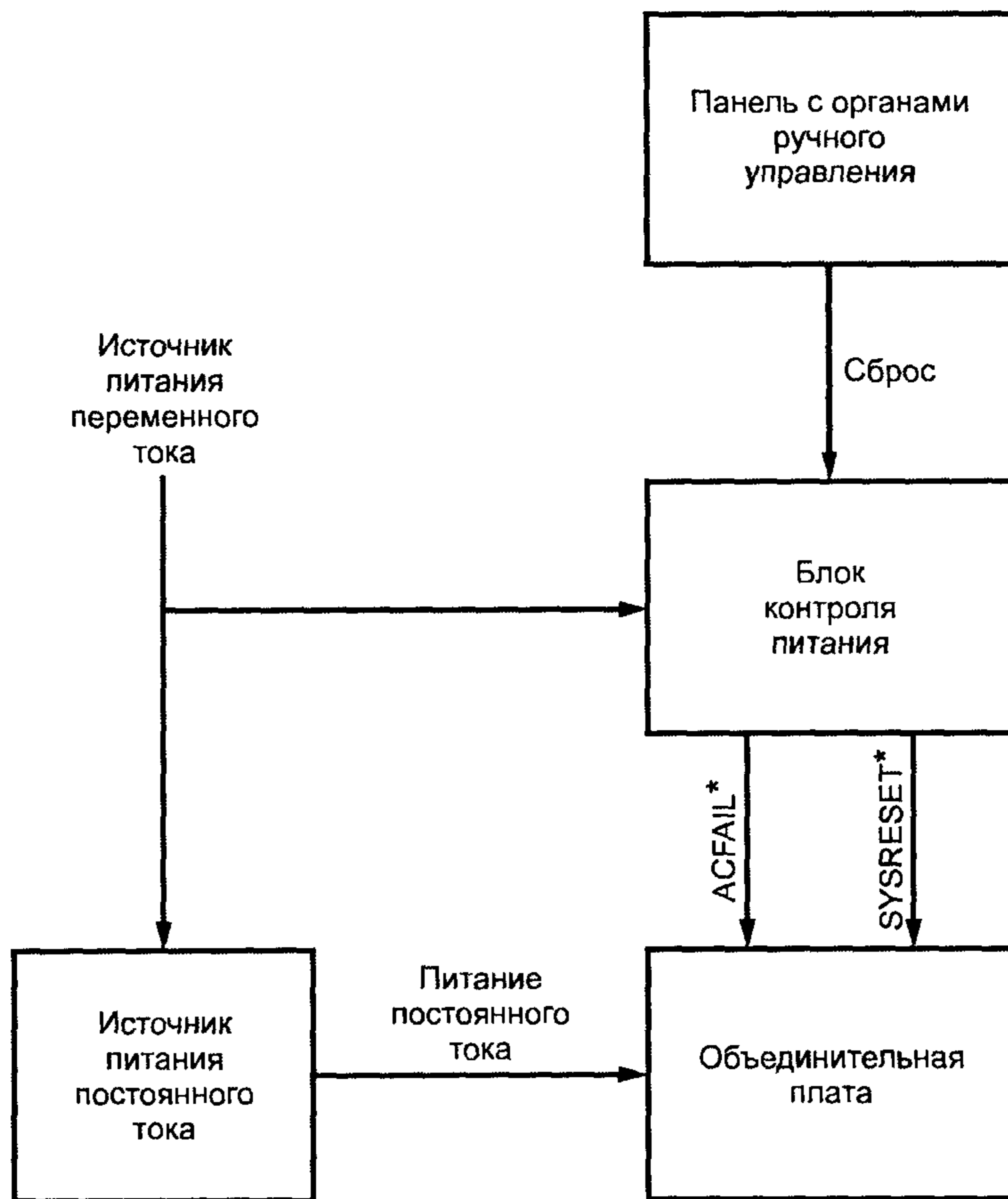
Рисунок 5.3 — Схема взаимодействия блока контроля питания с устройствами магистрали VME
