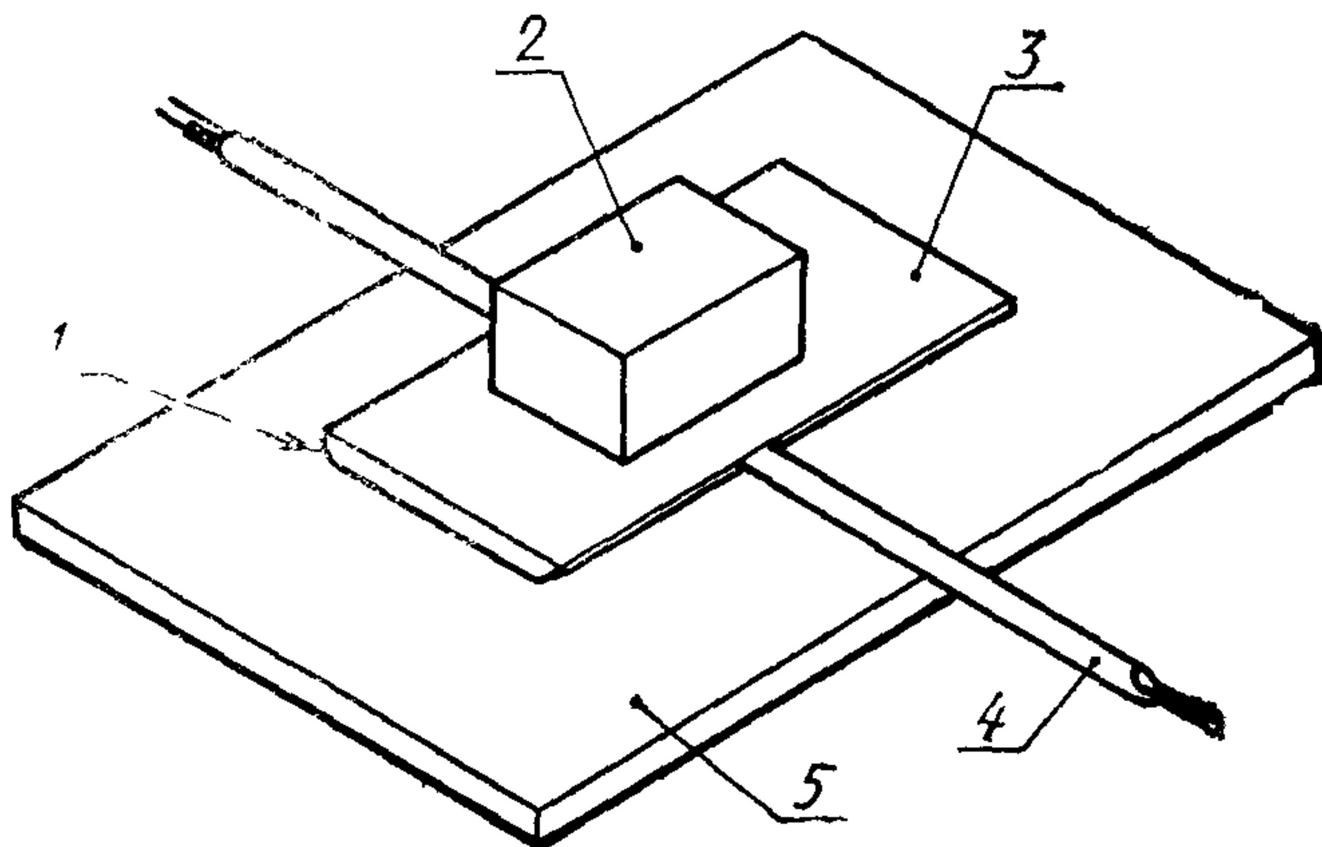
1 — радиус закругления 2 — груз 3 — подвижная пластина
