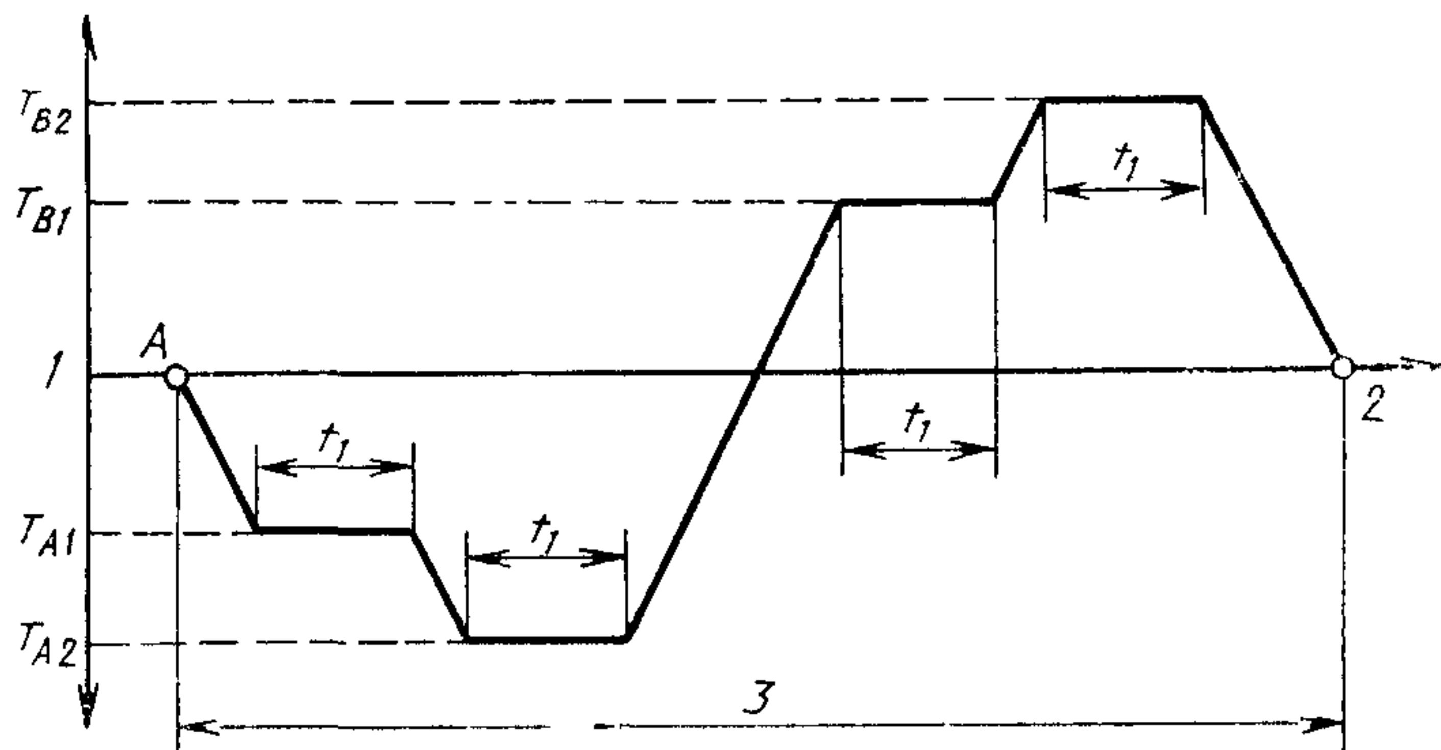
1 — температура в камере 2 — время, 3 — 1 цикл
