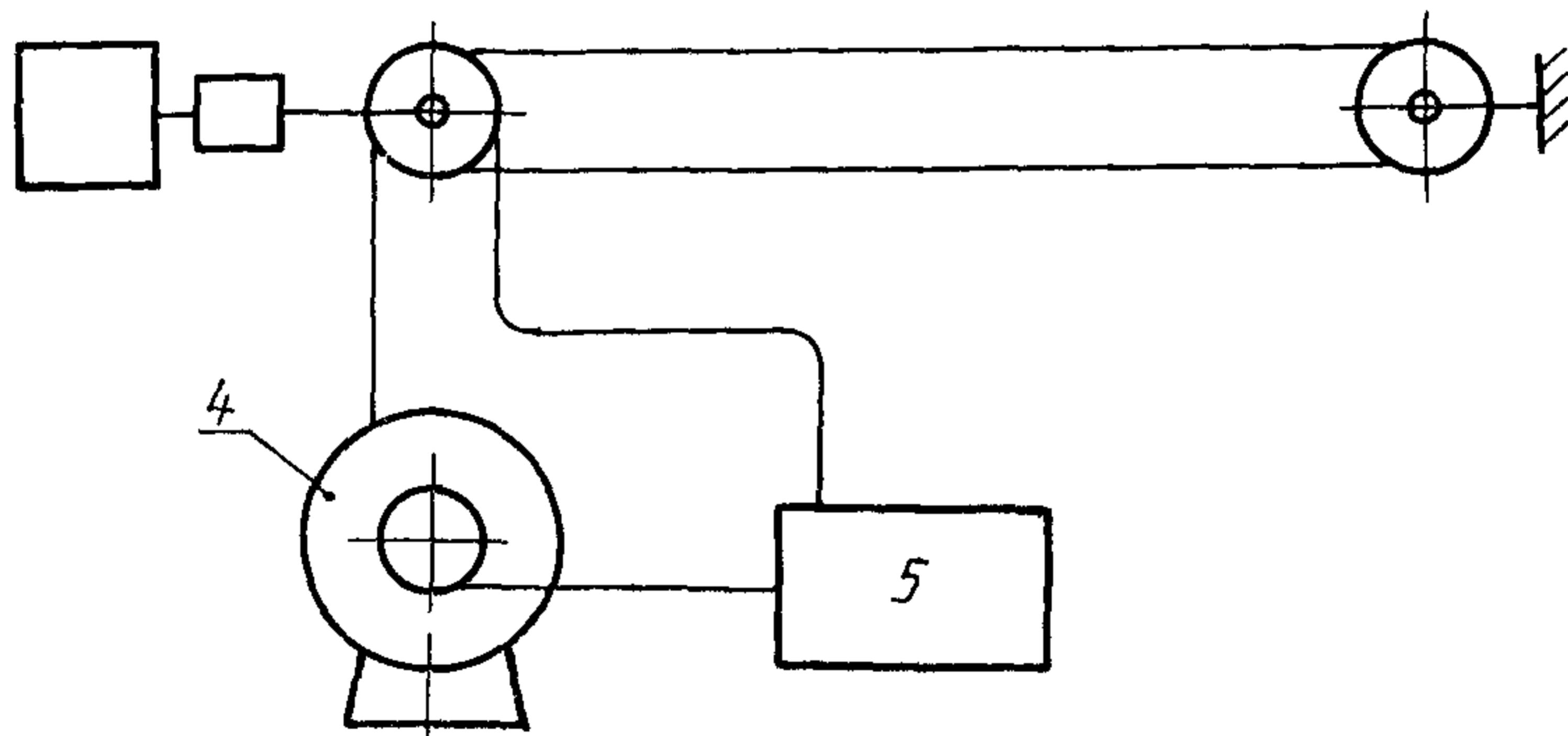
1 — привод, 2 — растягивающие ролики, 3 — барабан (для крепления кабеля), 4 — барабан с кабелем, 5 — прибор для измерения затухания
