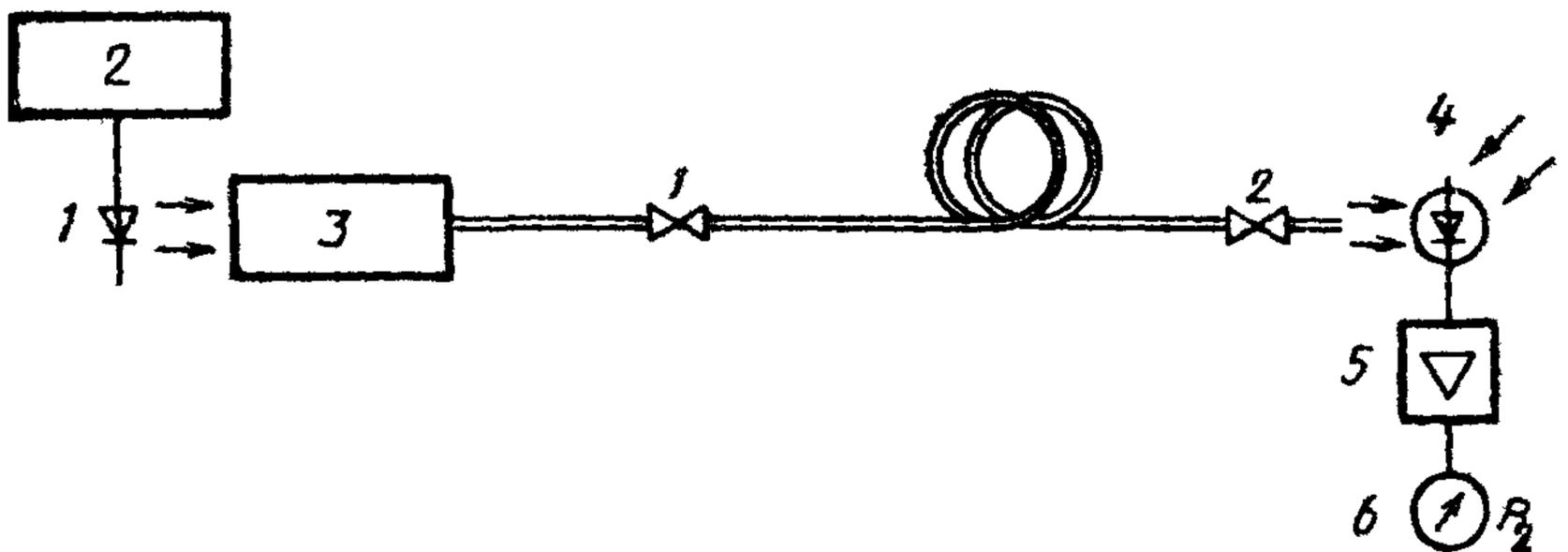
1 — светящийся источник; 2 — цепь питания; 3 — система ввода; 4 — детектор с дополнительным подводимым волокном; 5 — усилитель; 6 — измеритель уровня
