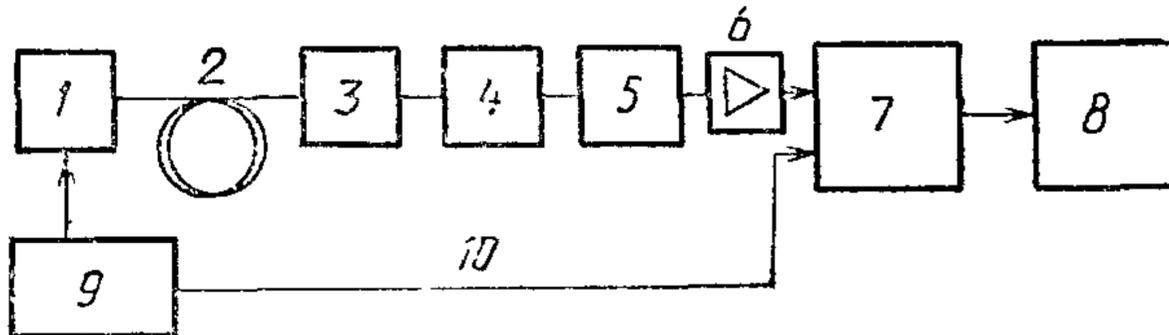
1 — светодиоды; 2 — испытуемое волокно; 3 — селектор длины волны; 4 — аттенюатор; 5 — оптический детектор; 6 — усилитель; 7 — векторный вольтметр; 8 — ЭВМ; 9 — генератор импульсов; 10 — контрольный сигнал
