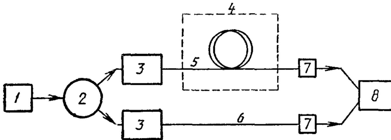
1 — оптический источник, 2 — оптический делитель, 3 — система возбуждения, 4 — среда, в которой проводятся испытания, 5 — испытываемый образец, 6 — опорный образец, 7 — детекторы, 8 — приемное и записывающее устройство
