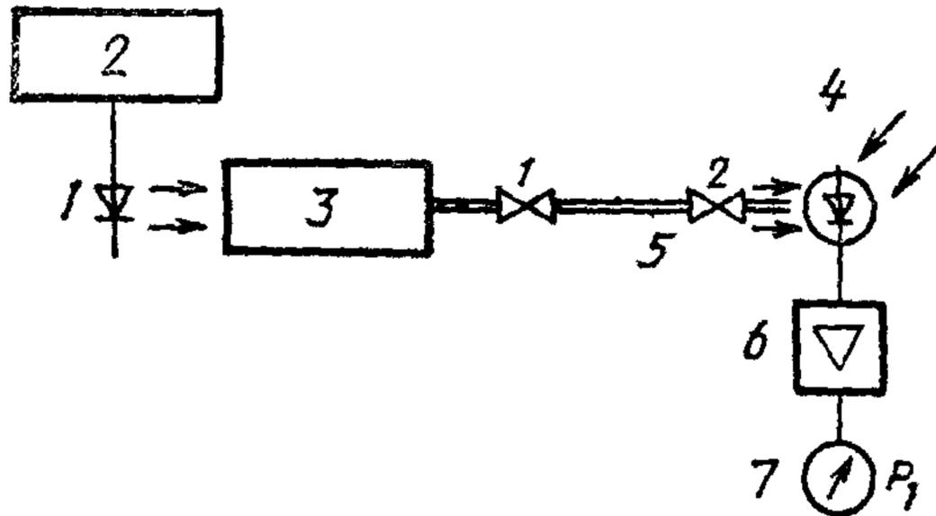
1 — светящийся источник; 2 — цепь питания; 3 — система ввода; 4 — детектор с дополнительным подводимым волокном; 5 — эталонное волокно; 6 — усилитель; 7 — измеритель уровня
