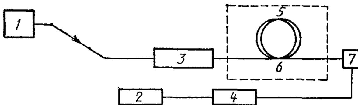
1 — стабилизированный оптический источник; 2 — записывающее устройство, 3 — система возбуждения, 4 — усилитель; 5 — среда, в которой проводятся испытания, 6 — испытываемый образец, 7 — детектор
