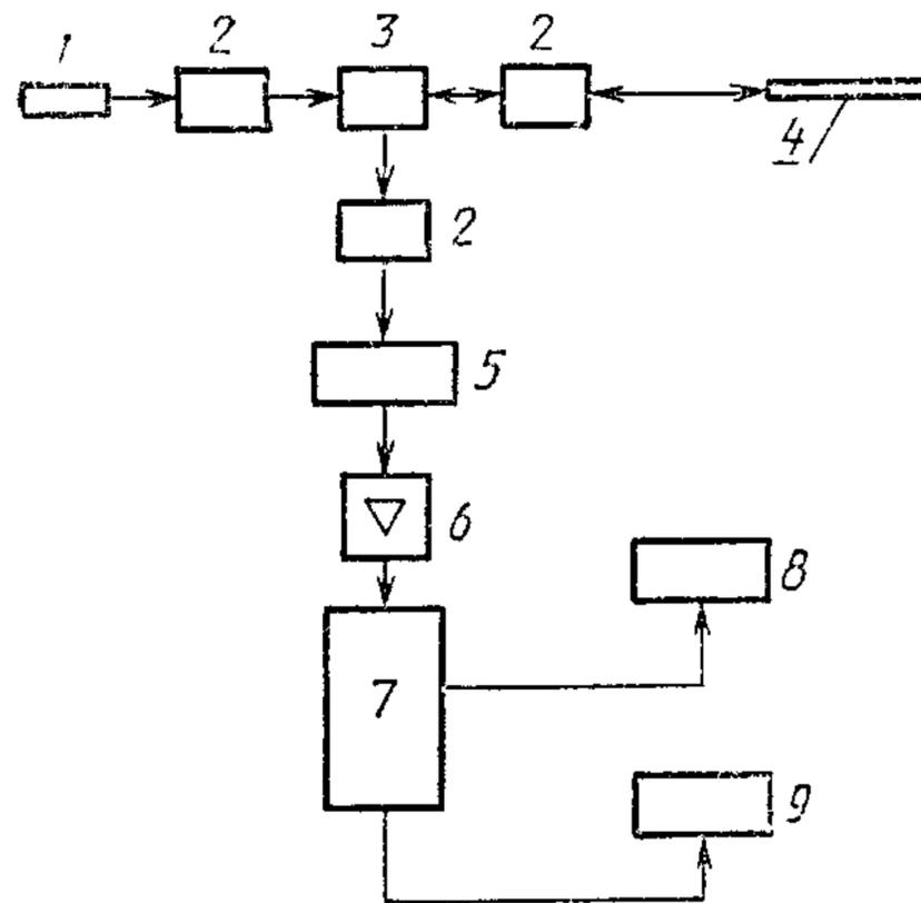
1 — источник света, 2 — оптическая система, 3 — устройство соединения, 4 — испытываемое волокно, 5 — оптический детектор, 6 — усилитель, 7 — устройство обработки сигналов, 8 — осциллограф, 9 — система сбора данных
