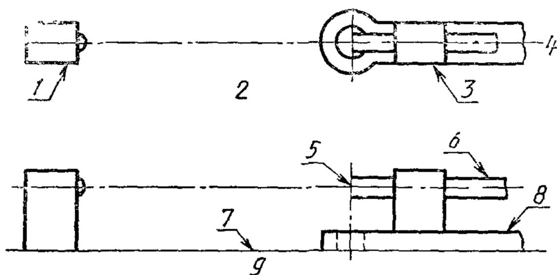
1 — детектор, 2 — вид сверху; 3 — зажим; 4 — ноль; 5 — выходной конец, 6 — образец, 7 — основание, 8 — подвижный кронштейн, 9 — вид сбоку
