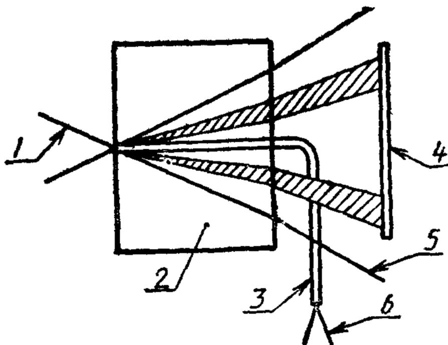
1 — падающий свет, переполняющий числовую апертуру волокна; 2 — ячейка с жидкостью; 3 — волокно; 4 — диск; 5 — только преломленные моды; 6 — излучение удержанных мод
