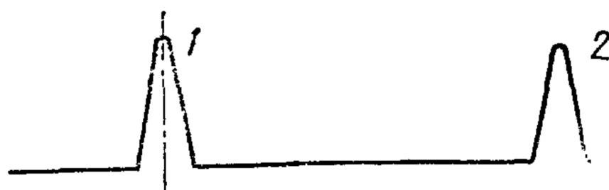
1 — первый импульс; 2 — второй импульс с настраиваемой частотой повторения
