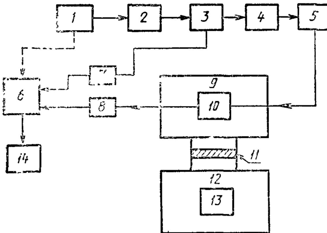
1 — модулированный источник света; 2 — оптические фильтры/монохроматор; 3 — оптический светоделитель; 4 — имитатор ввода на входе; 5 — устройство выделения мод оболочки; 6 — синхронный детектор; 7 — опорный детектор; 8 — оптический детектор; 9 — камера с регулируемой температурой; 10 — испытываемый образец; 11 — регистрирующее устройство; 12 — затвор; 13 — экранированная камера; 14 — источник гамма-излучения
