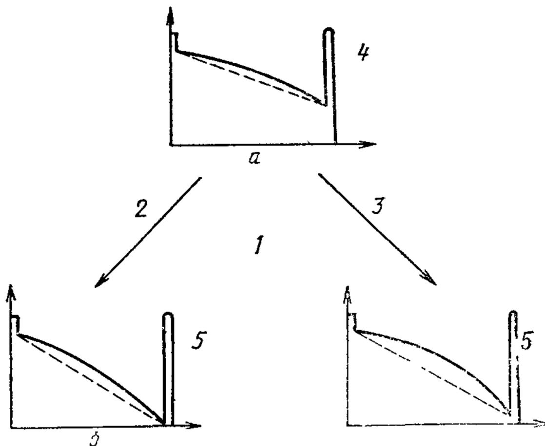
1 — причина образования изгиба; 2 — внутренняя; 3 — внешняя; 4 — до воздействия, 5 — после воздействия
