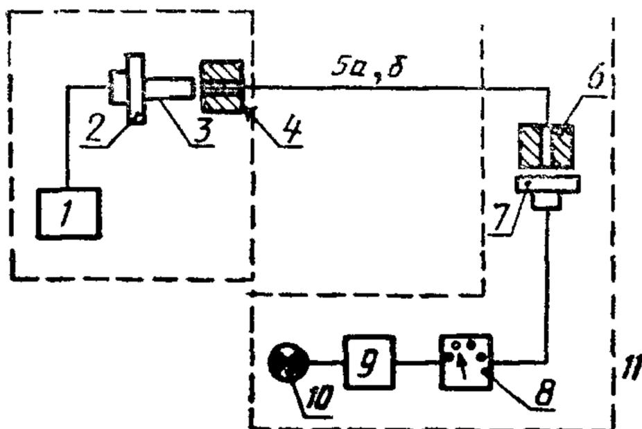
1 — стабилизированный источник постоянного тока; 2 — лампа или светодиод; 3 — возбуждающее волокно; 4 — приспособление для установки волокна; 5 а) контрольное волокно, б) испытываемое волокно; 6 — приспособление для установки волокна (при необходимости), 7 — PIN — фотодиодный детектор; 8 — прибор для регулирования чувствительности; 9 — пороговый детектор; 10 — индикатор; 11 — измеритель мощности
