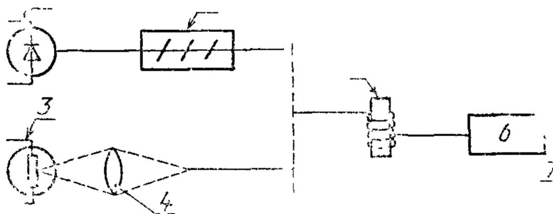
1 — светоизлучающий диод или лазер; 2 — смеситель мод;
