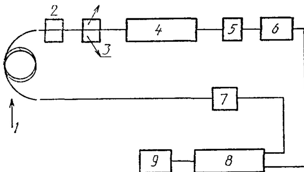
1 — испытываемое волокно; 2 — дополнительный фильтр мод; 3 — устройство выделения мод; 4 — смеситель мод; 5 — светозлучающий источник; 6 — импульсный генератор; 7 — детектор; 8 — осциллограф; 9 — блок обработки данных
