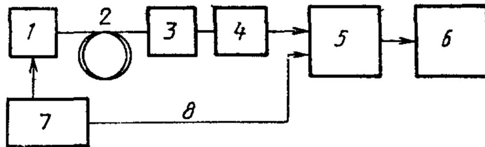
1 — лазерные диоды; 2 — испытуемое волокно; 3 — аттенюатор; 4 — оптический детектор; 5 — векторный вольтметр; 6 — ЭВМ; 7 — генератор импульсов; 8 — контрольный сигнал
