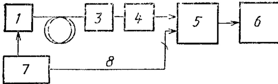
1 — лазерные диоды; 2 — испытуемое волокно; 3 — аттенюатор; 4 — оптический детектор; 5 — осциллограф; 6 — ЭВМ; 7 — синхронизирующая цепь; 8 — триггер.
