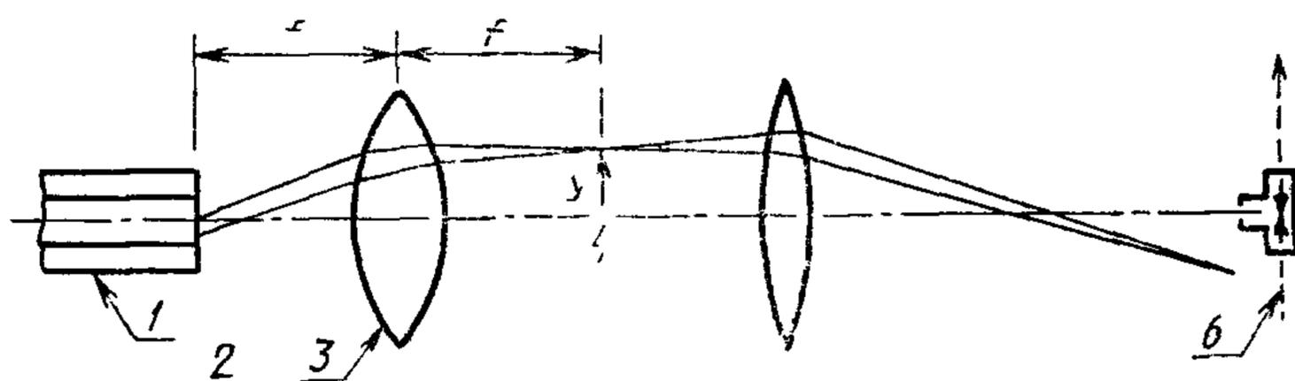
1 — образец; 2 — поле ближней зоны, 3 — объектив  $L_1$  (преобразователь);
