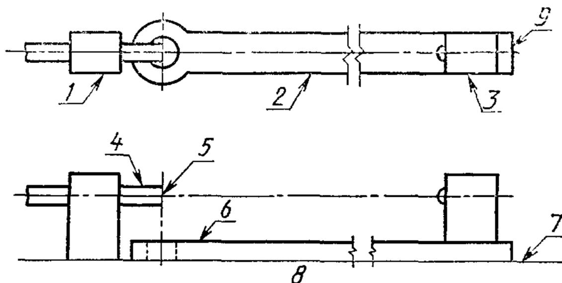
1 — зажим; 2 — вид сверху; 3 — детектор; 4 — образец; 5 — выходной конец; 6 — подвижный кронштейн; 7 — основание; 8 — вид сбоку 9 — ноль
