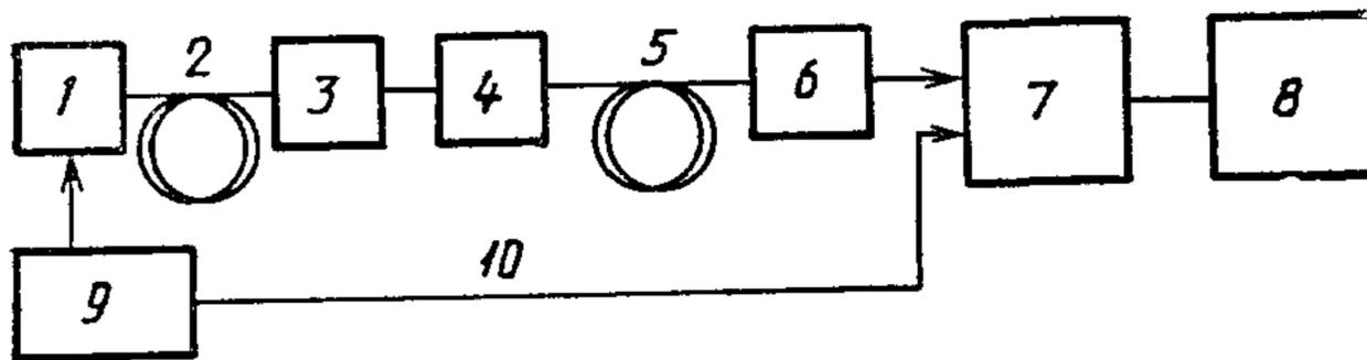
1 — лазер на алюмоиттриевом гранате; 2 — рамановское волокно; 3 — аттенюатор; 4 — монохроматор; 5 — испытуемое волокно; 6 — оптический детектор; 7 — осциллограф; 8 — ЭВМ; 9 — синхронизирующая цепь; 10 — триггер
