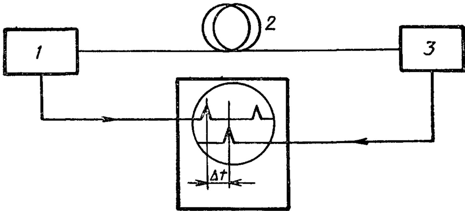
1 — генератор оптических импульсов, 2 — волокно (N.L.); 3 — оптический приемник
