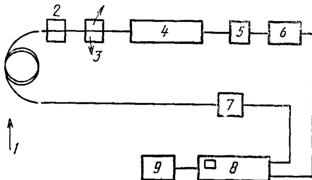
1 — испытываемое волокно; 2 — факультативный фильтр мод; 3 — устройство выделения мод; 4 — передатчик помех моды; 5 — светоизлучающий источник; 6 — генератор качающейся частоты; 7 — детектор; 8 — спектральный анализатор или анализатор с решеткой; 9 — блок обработки данных
