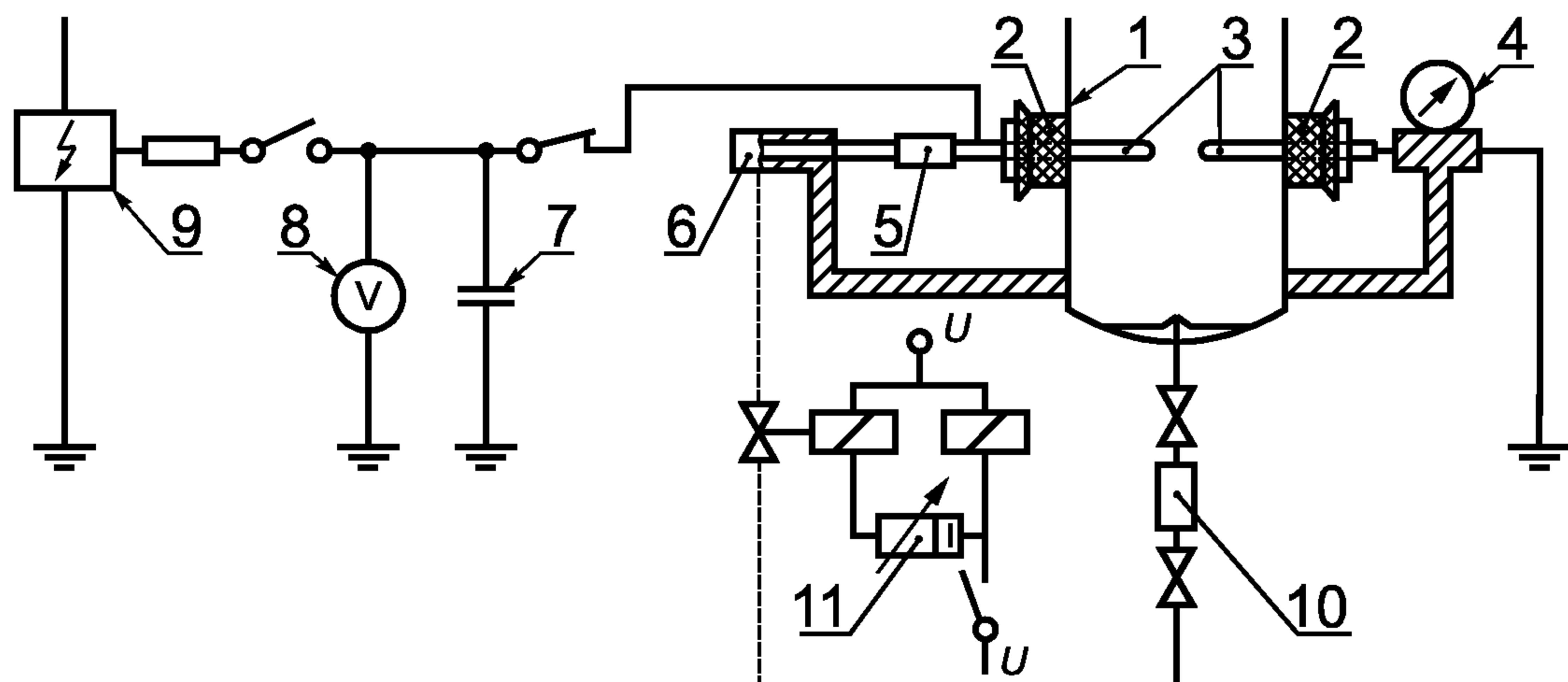
*1* — камера для воспламенения, трубка Хартмана с открытой верхней частью; *2* — пробки из ПТФЭ; *3* — электроды; *4* — микрометрический винт; *5* — изолационный отрезок трубы из ПТФЭ; *6* — пневматический поршень двойного действия; *7* — конденсатор; *8* — электростатический вольтметр; *9* — генератор высокого напряжения (5–10 кВ); *10* — камера высокого давления; *11* — таймер
