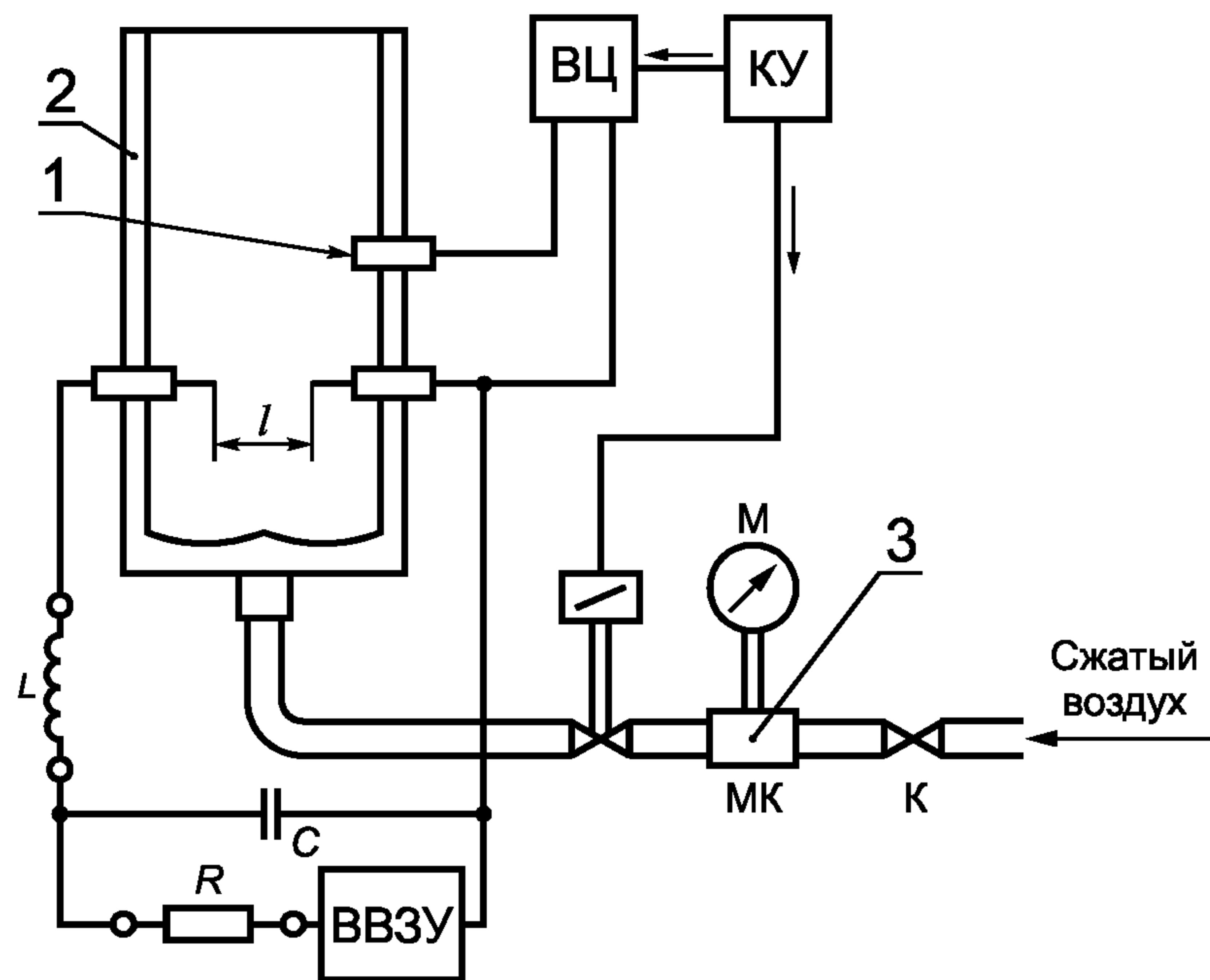
*ВЦ* — вспомогательная цепь; *С* — испытательный конденсатор; *КУ* — контрольное устройство; *ВВЗУ* — зарядное устройство; *М* — манометр; *L* — индуктивность; *MK* — магнитный клапан; *R* — зарядное сопротивление; *K* — запорный клапан; *l* — основной межэлектродный промежуток; *1* — вспомогательный электрод; *2* — трубка Хартмана; *3* — резервуар сжатого воздуха
