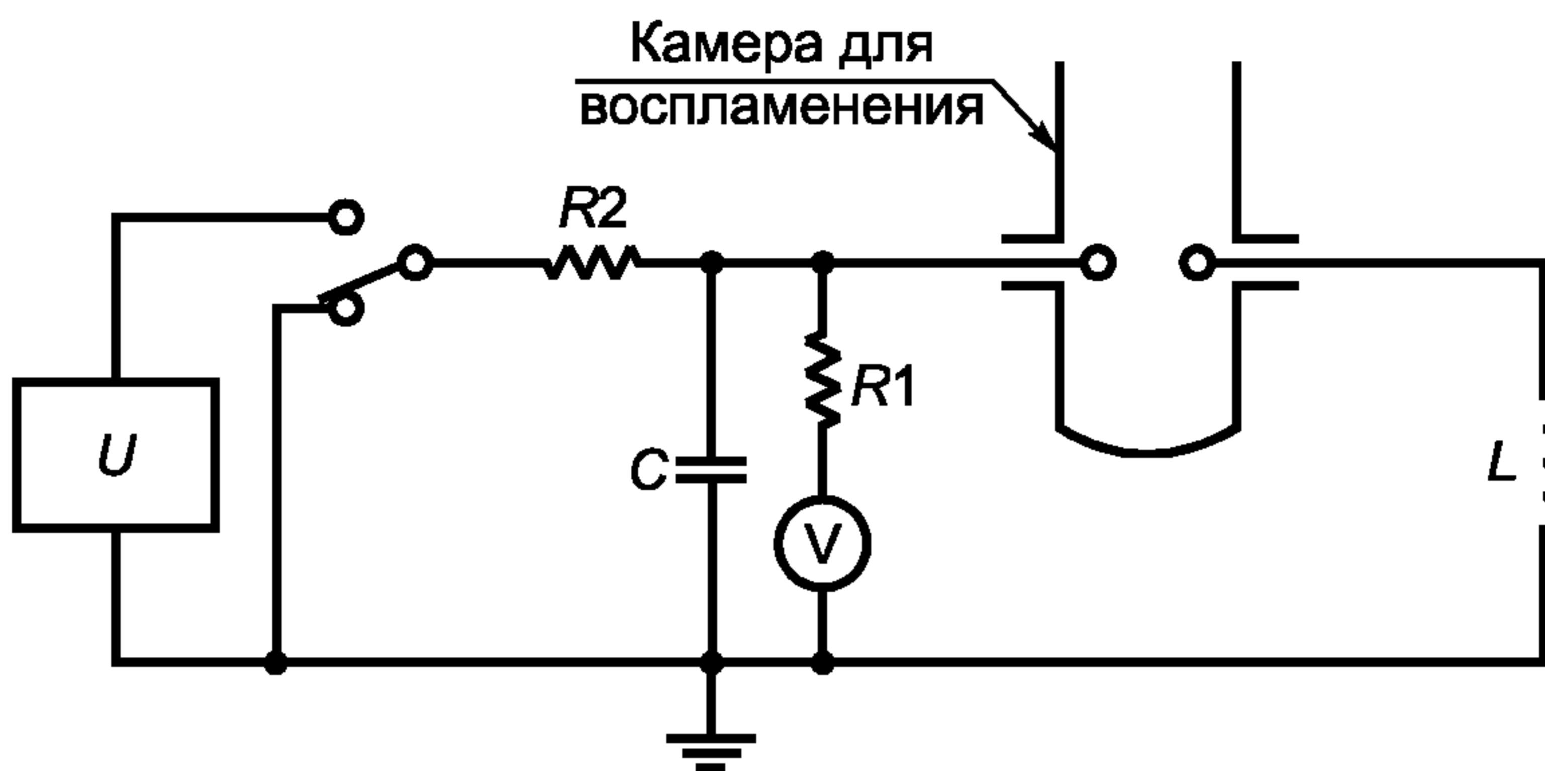
$U$  — источник напряжения постоянного тока;  $C$  — конденсатор;  $R_1$  — резистор (развязывающее сопротивление);
