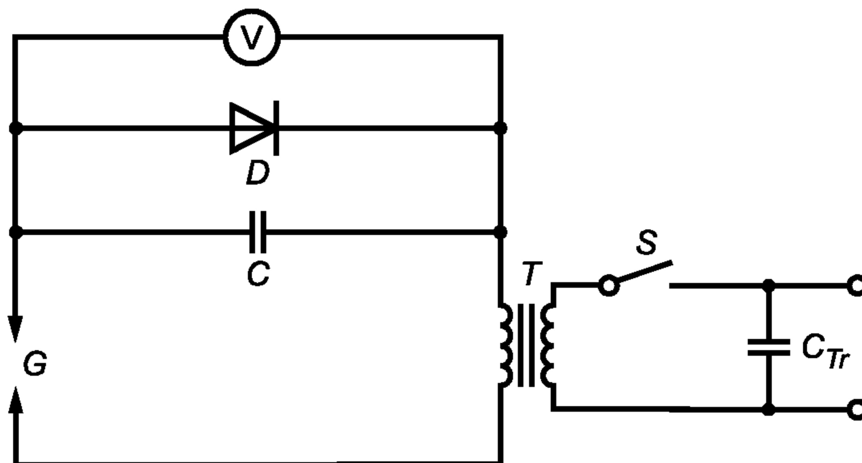
$C$  — основной конденсатор;  $C_{Tr}$  — конденсатор в цепи триггера;  $D$  — диод;  $S$  — выключатель;  $T$  — трансформатор;
