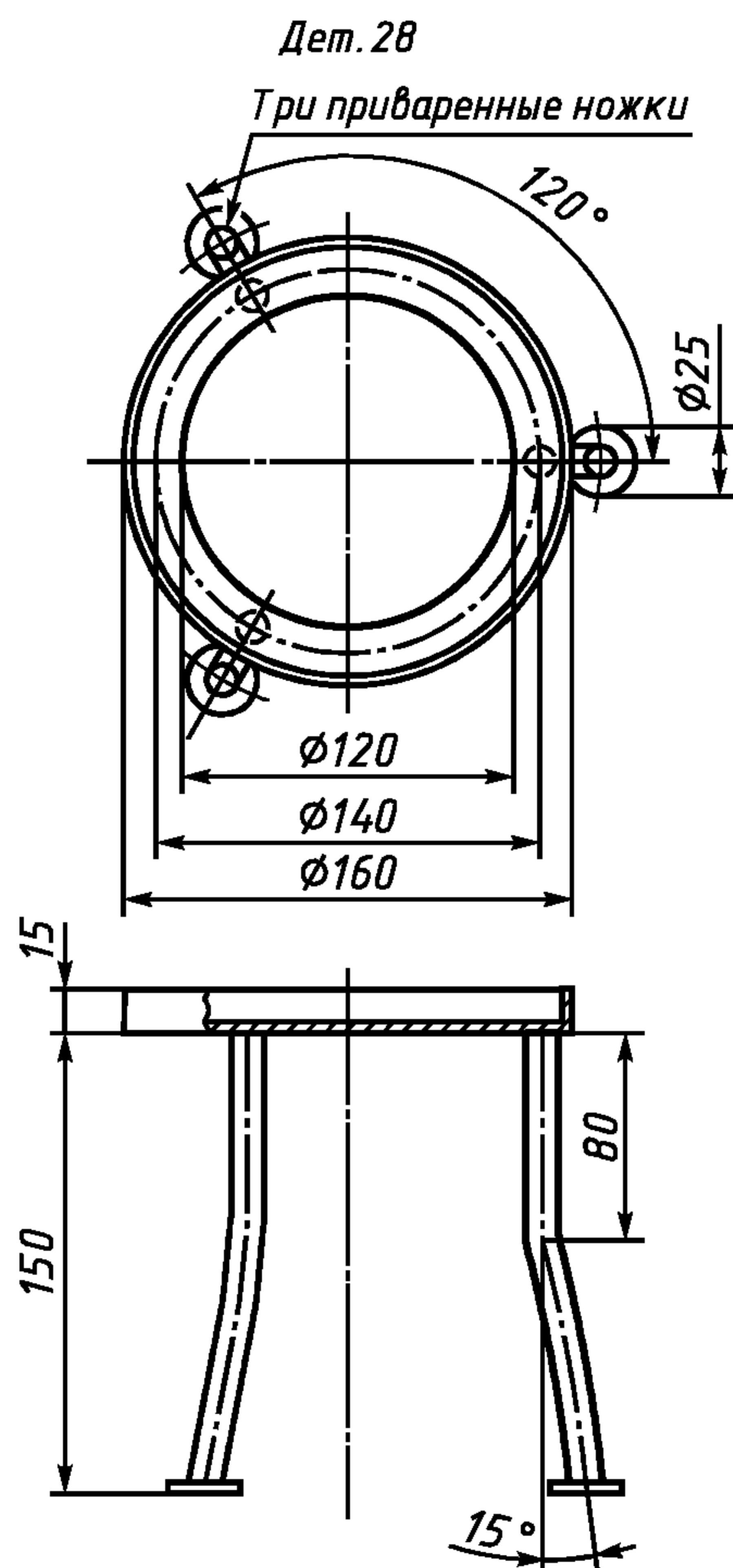
Верхняя круговая секция из нержавеющей стали, ножки из трубы из нержавеющей стали наружным диаметром 10 мм, приваренные наконечники ножек диаметром 25 мм из нержавеющей стали.
