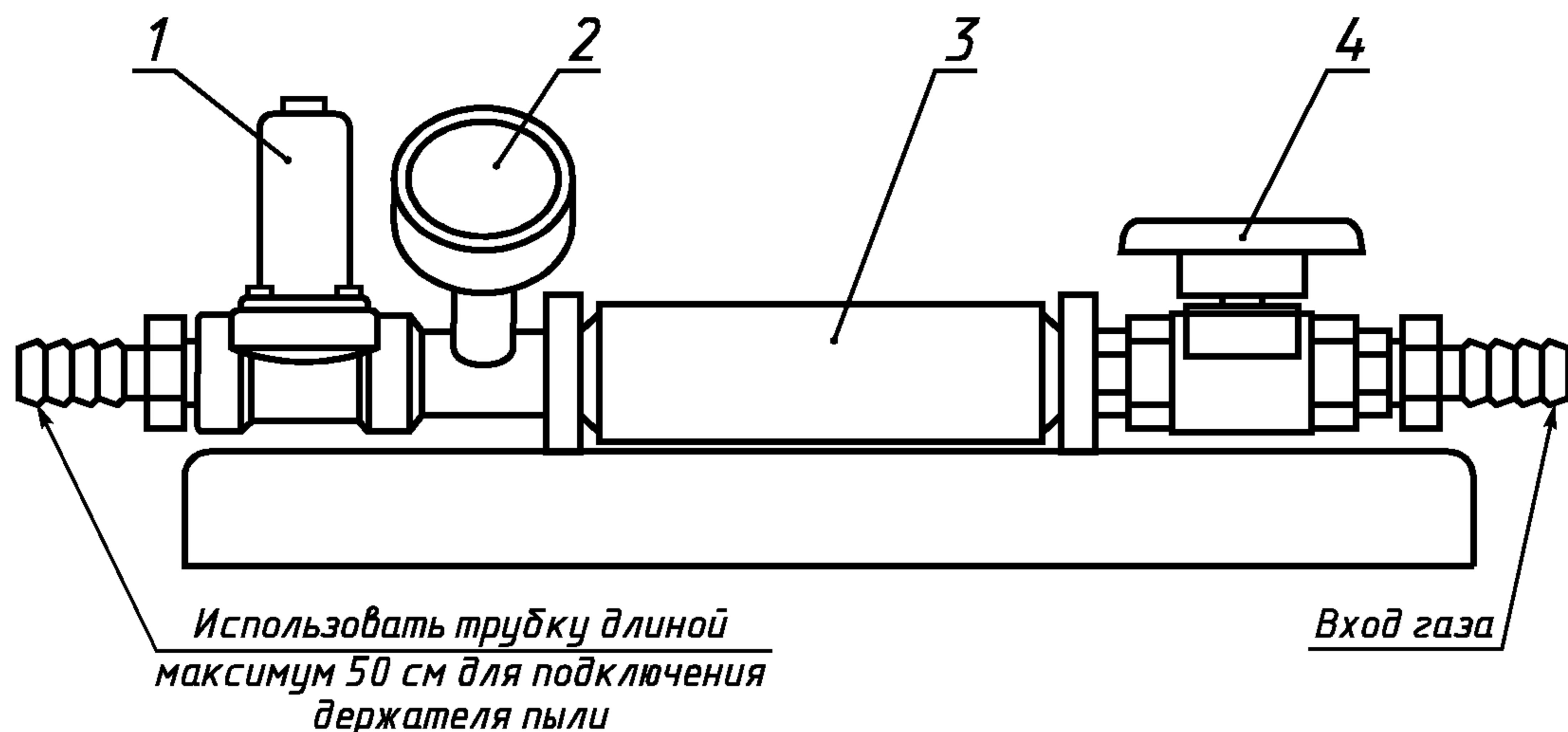
1 — электромагнитный клапан диаметром 10 мм; 2 — манометр с ценой деления до 0,02 бар;
