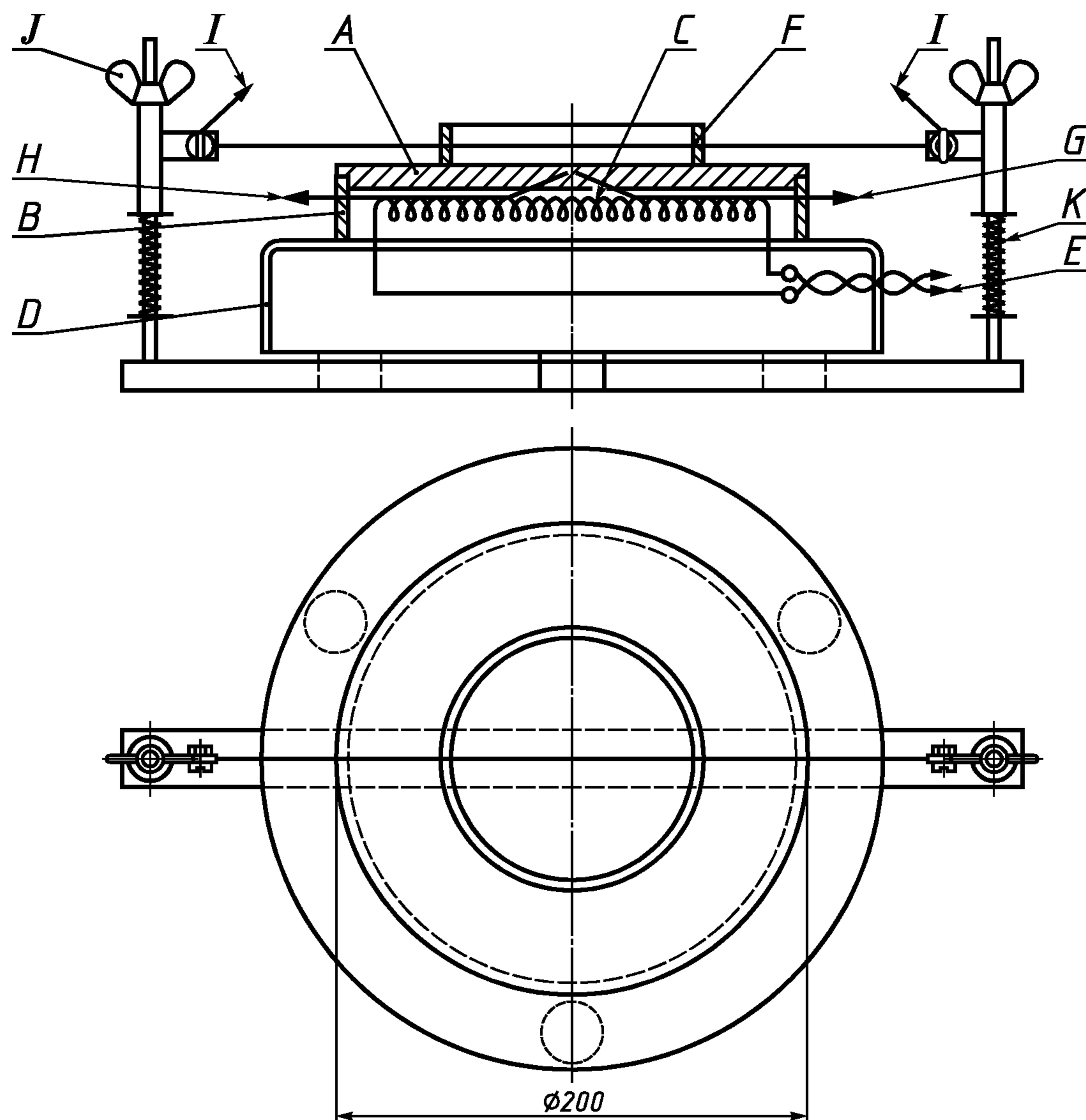
*A* — нагреваемая пластина; *B* — «юбка»; *C* — нагреватель; *D* — основание нагревателя; *E* — соединение нагревателя с источником питания и контроллером; *F* — кольцо для слоя пыли; *G* — соединение контрольной термопары пластины с контроллером; *H* — соединение регистрирующей термопары пластины с прибором; *I* — соединение термопары, регистрирующей температуру в слое пыли, с прибором; *J* — винт регулировки высоты термопары; *K* — спиральная пружина
