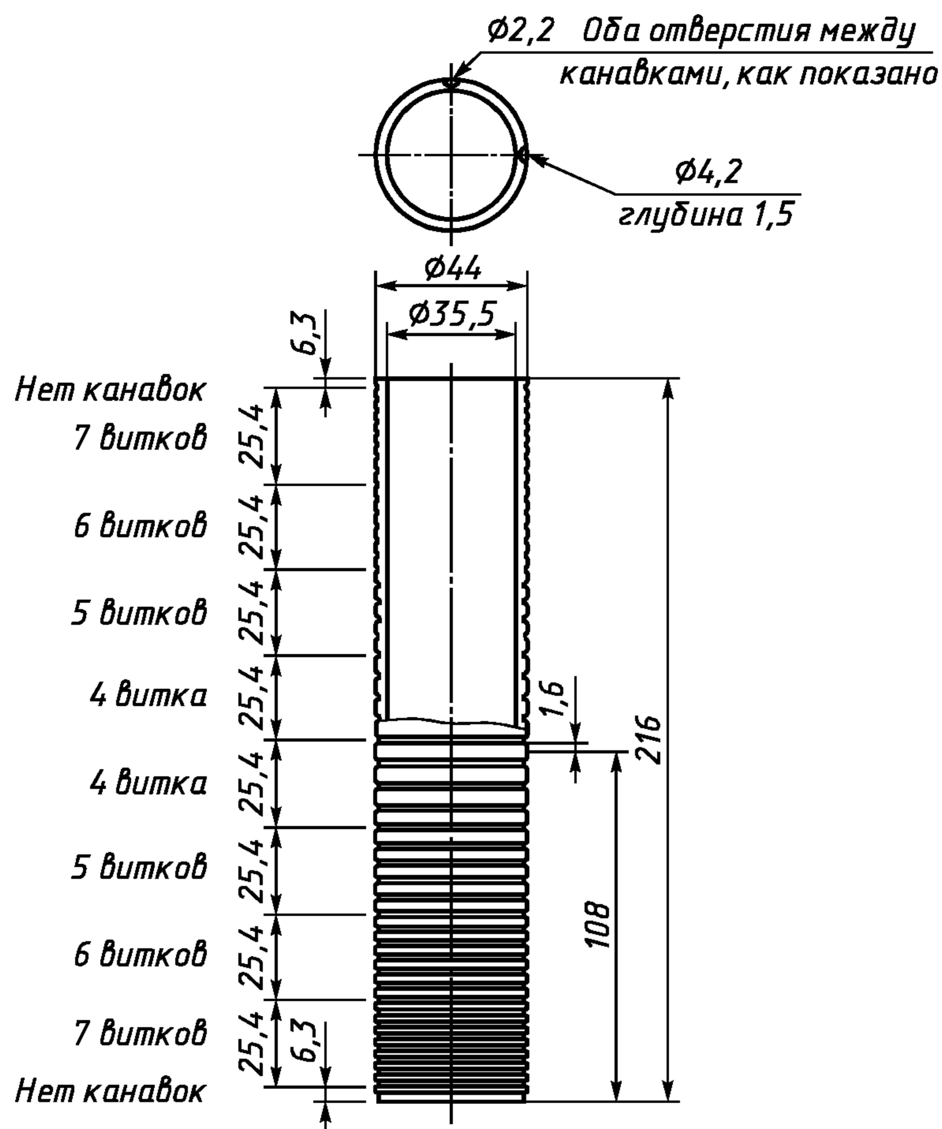
Кварцевая трубка со спиральной канавкой на внешней поверхности. В канавке размещается нагревательный элемент из проволоки Кантал А с общим сопротивлением 13 Ом.
