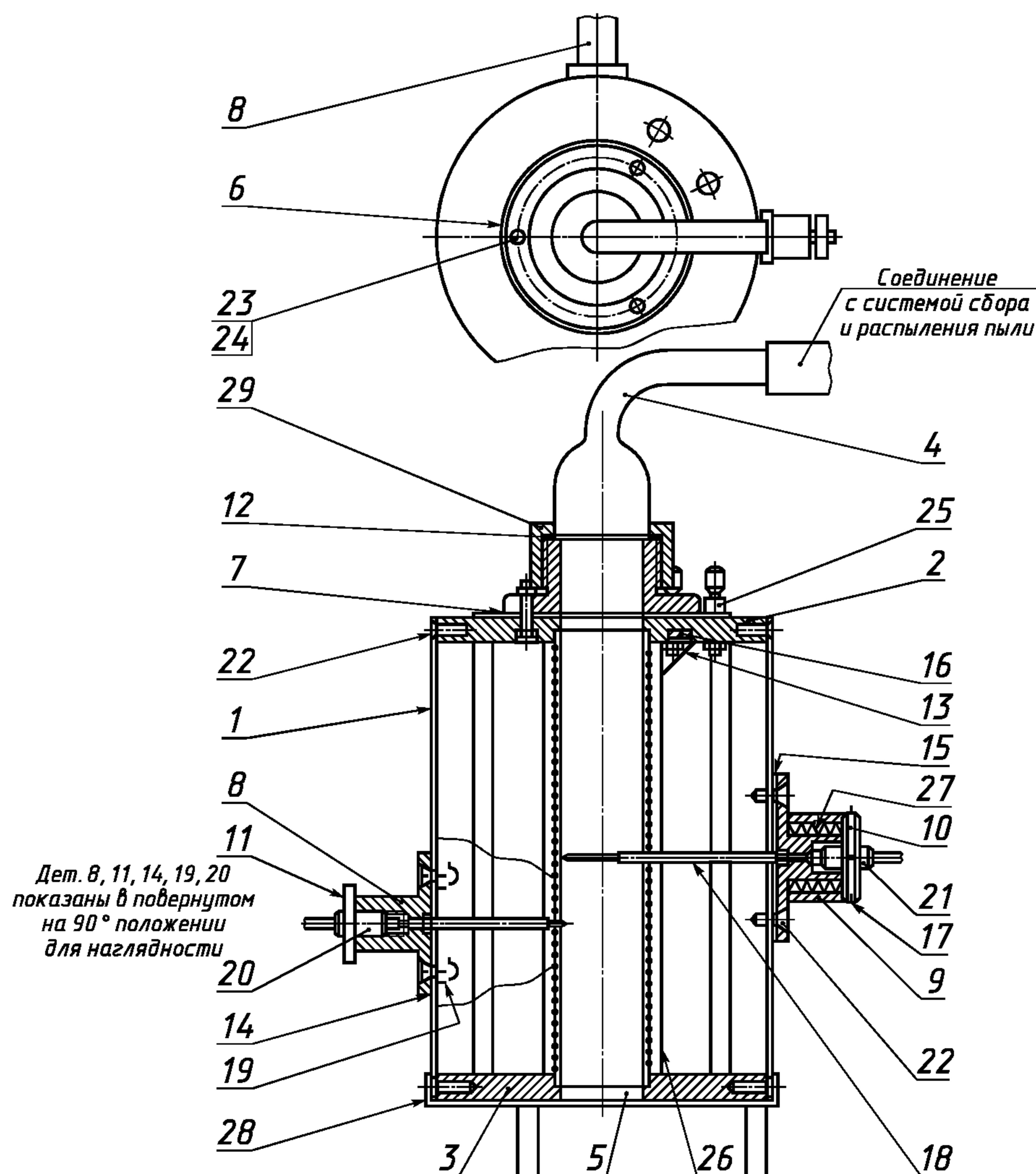
Изоляция для дет. 5: слой глиноземного наполнителя толщиной 5 мм, слой минерального волокна толщиной 25 мм, слой глиноземного наполнителя толщиной 10 мм, остальное — кизельгур.
