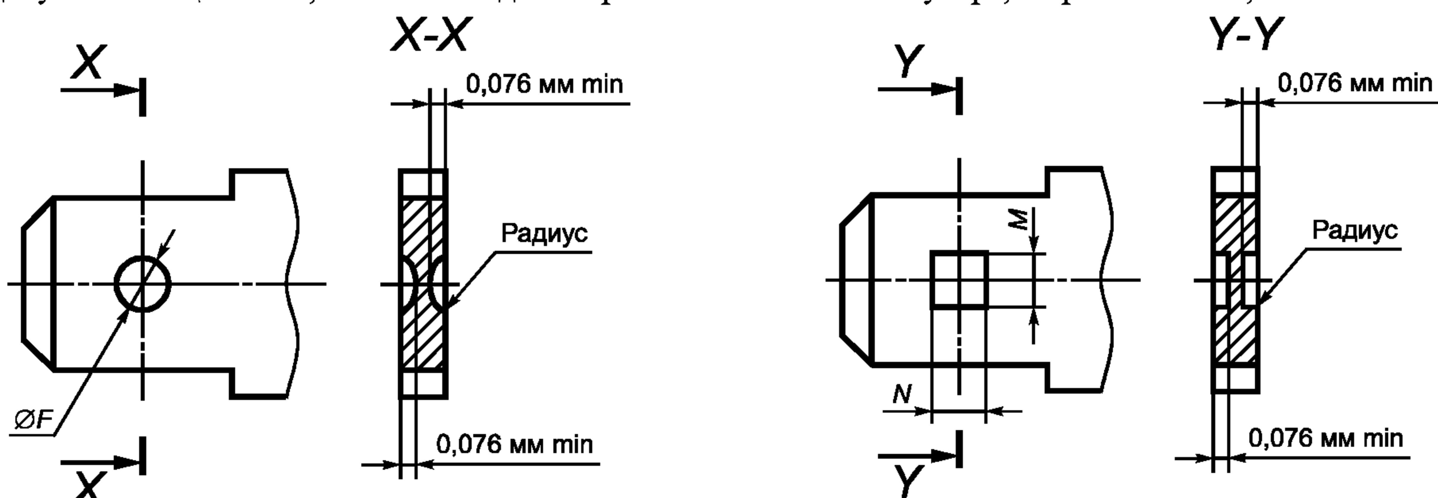
Рисунок 2 — Размеры круглых углублений фиксации (см. рисунок 1)
