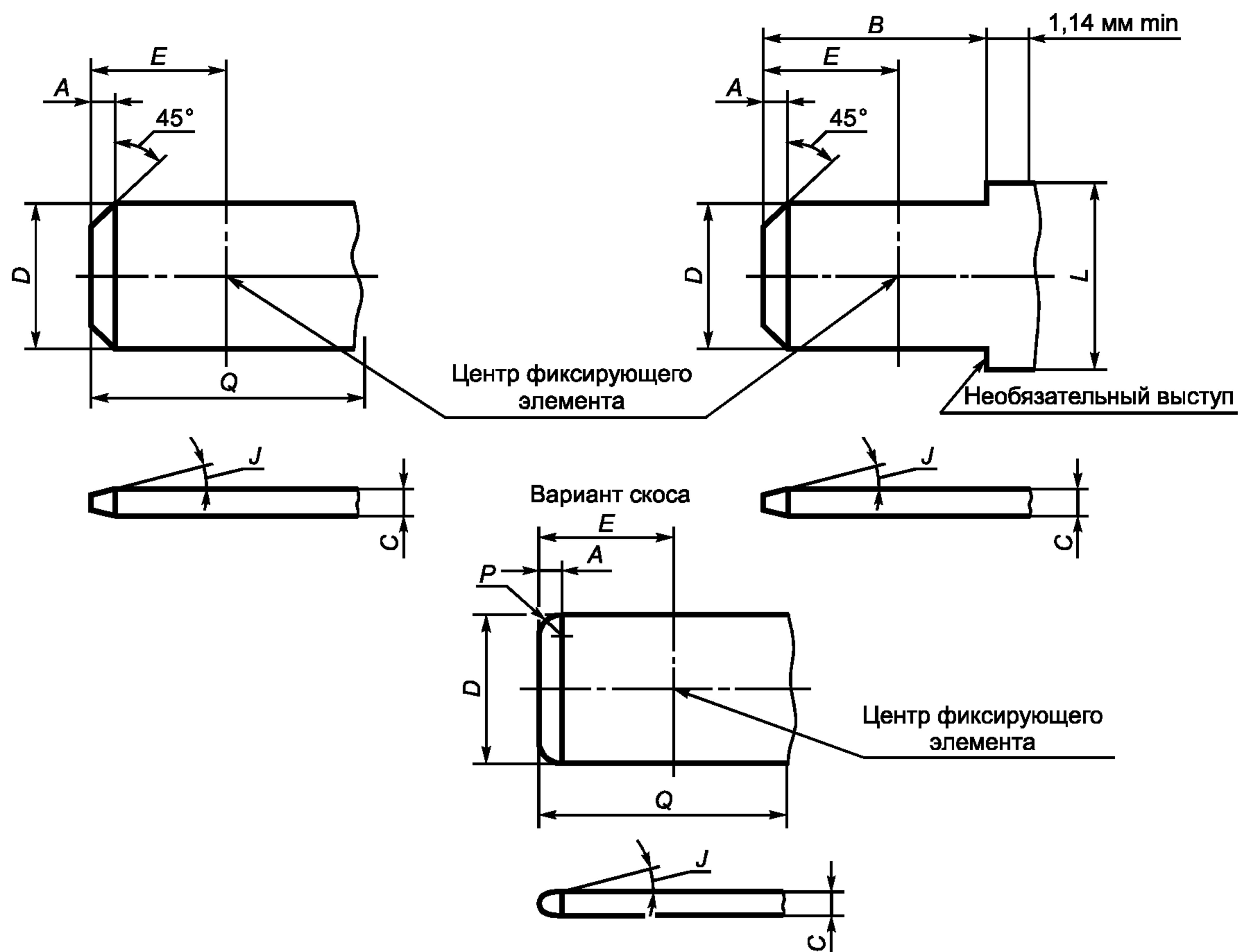
Рисунок 1 — Размеры штыревых контактов (штекеров)
