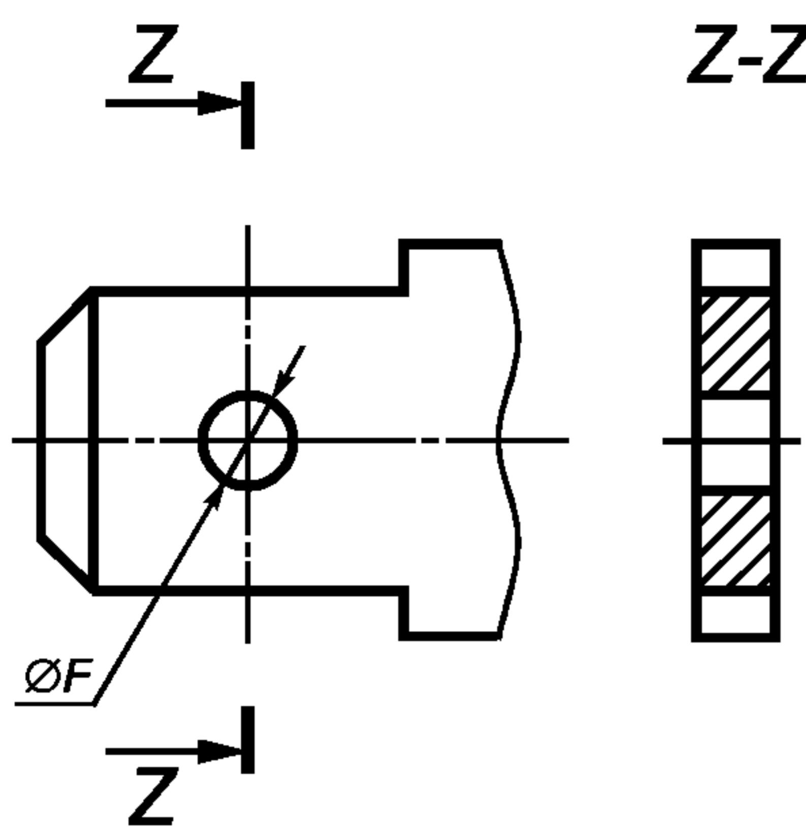
Рисунок 4 — Размеры отверстий для фиксации
