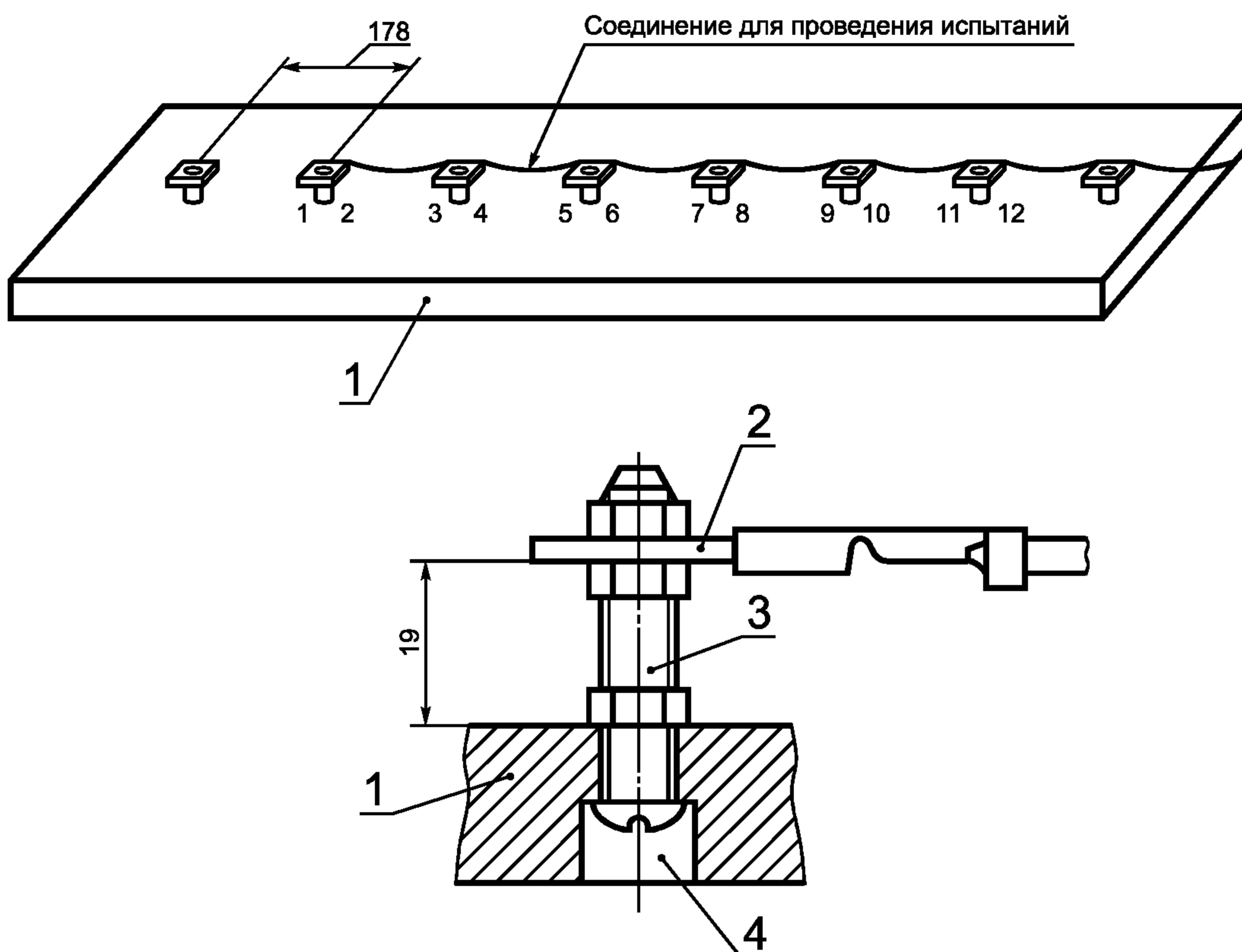
1 — плита из текстолита толщиной 19 мм; 2 — двухсторонний штыревой наконечник; 3 — винт и гайка из стали;
