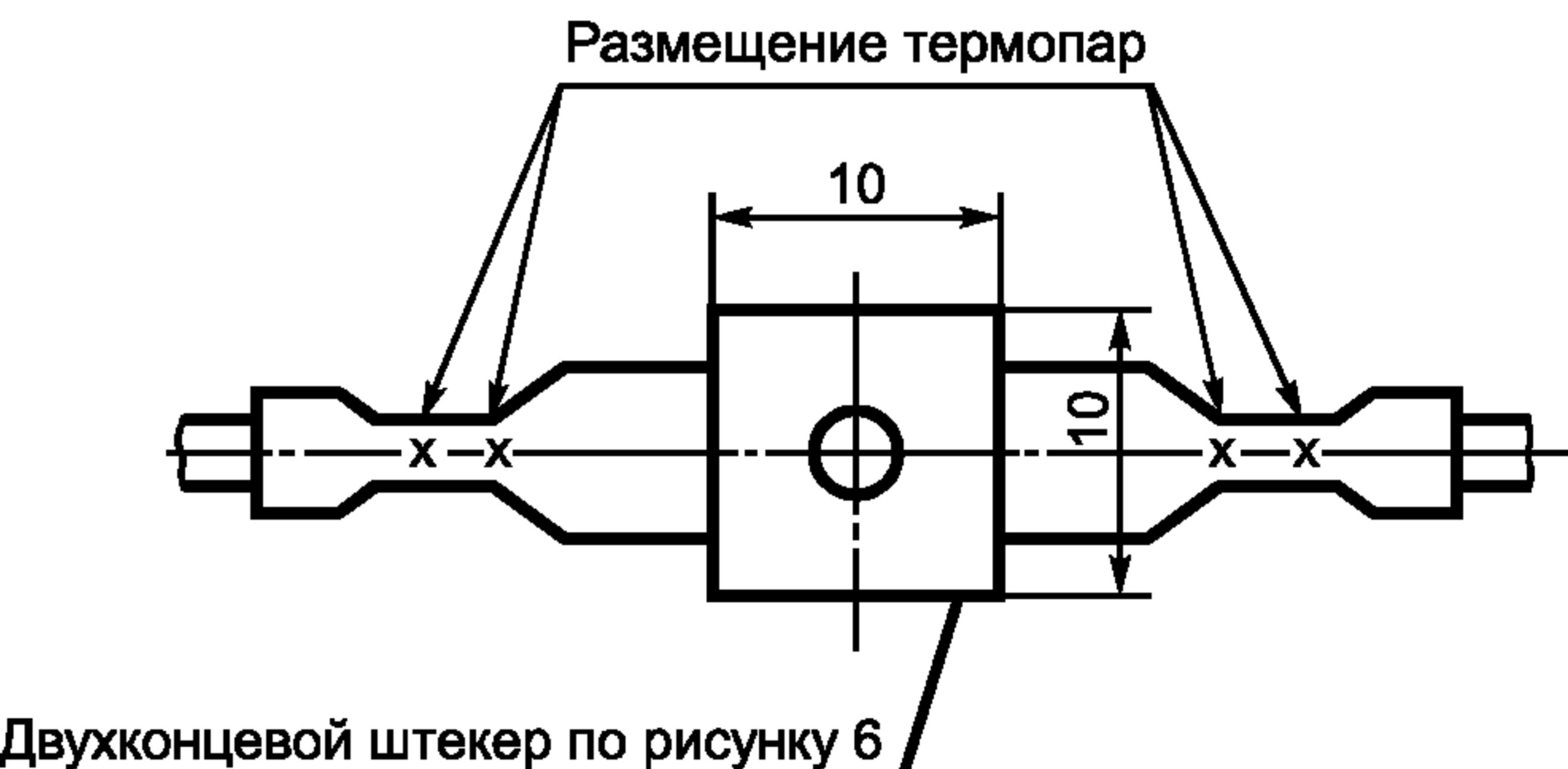
Рисунок 7 — Размещение термопар при испытаниях
