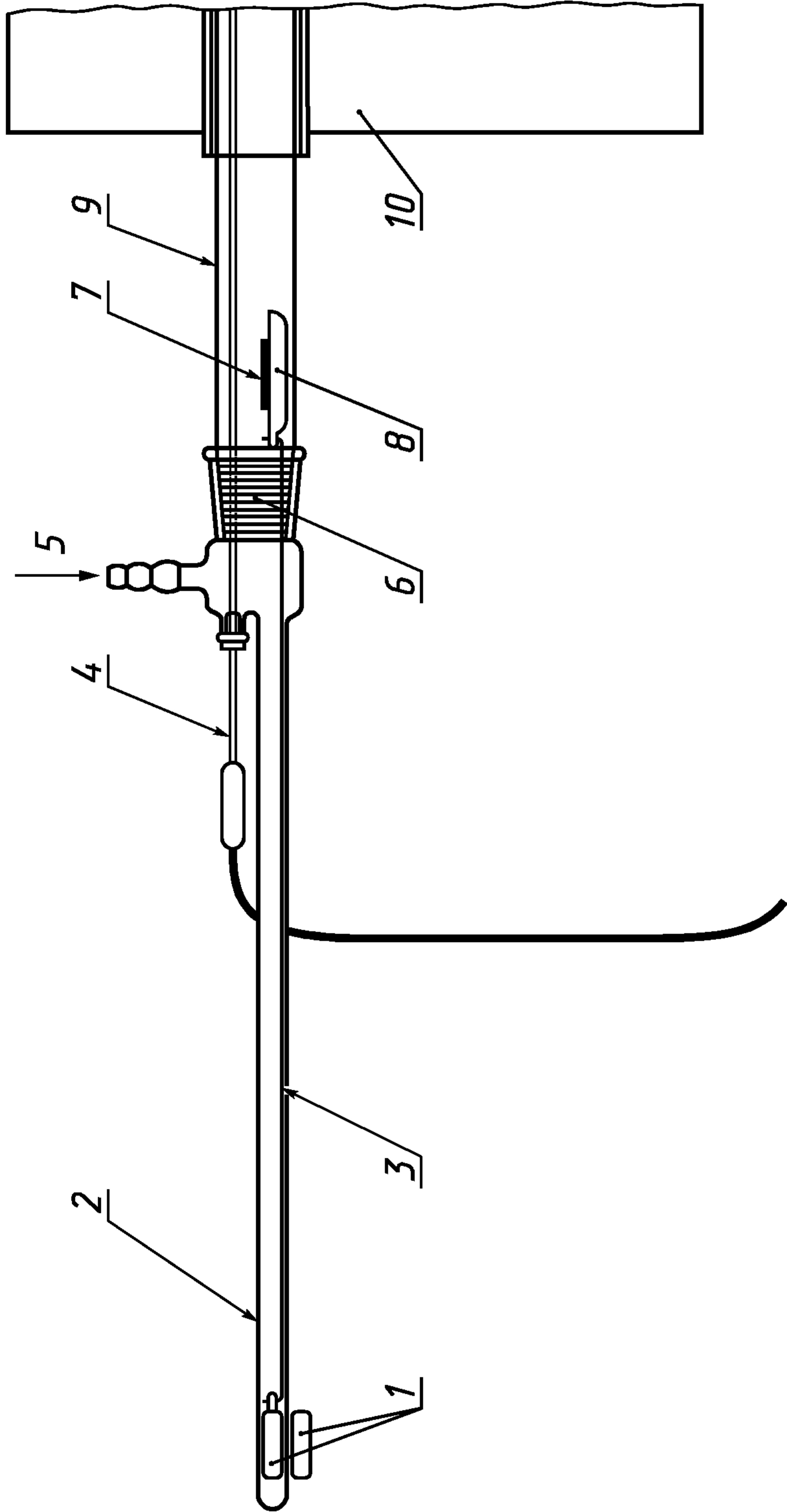
1 — стержневые магниты; 2 — стеклянная трубка; 3 — стеклянная трубка; 4 — платиновая проволока; 5 — термопары; 6 — стандартное притертное соединение, размер которого соответствует диаметру трубы из кварцевого стекла; 7 — образец; 8 — лодочка; 9 — трубка из кварцевого стекла; 10 — печь
