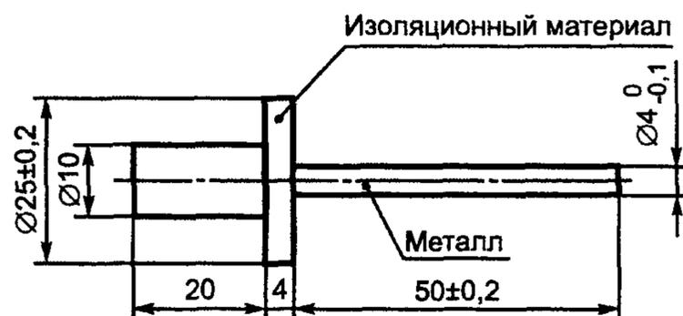
Рисунок 104 — Длинный испытательный щуп
