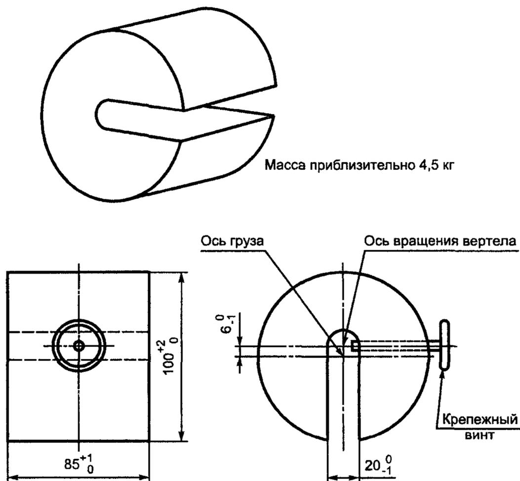
**Примечание** — Груз располагают на вращающемся вертеле так, чтобы винт крепления касался образующей вертела
