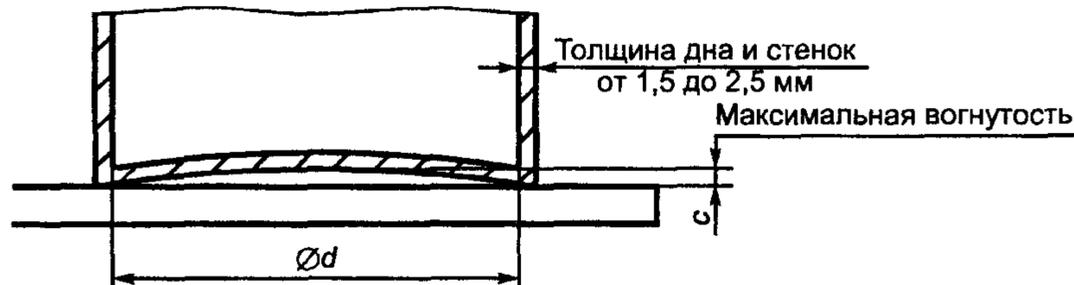
**Примечание** — Сосуд сделан из низкоуглеродистой стали с максимальным содержанием углерода 0,08 %. Он имеет форму цилиндра без металлических ручек или выступов. Диаметр плоской части дна сосуда должен быть не менее диаметра рабочей зоны. Максимальная вогнутость  $C$  дна сосуда  $0,006 d$ , где  $d$  — диаметр плоской части дна сосуда. Дно сосуда не должно быть выпуклым.
