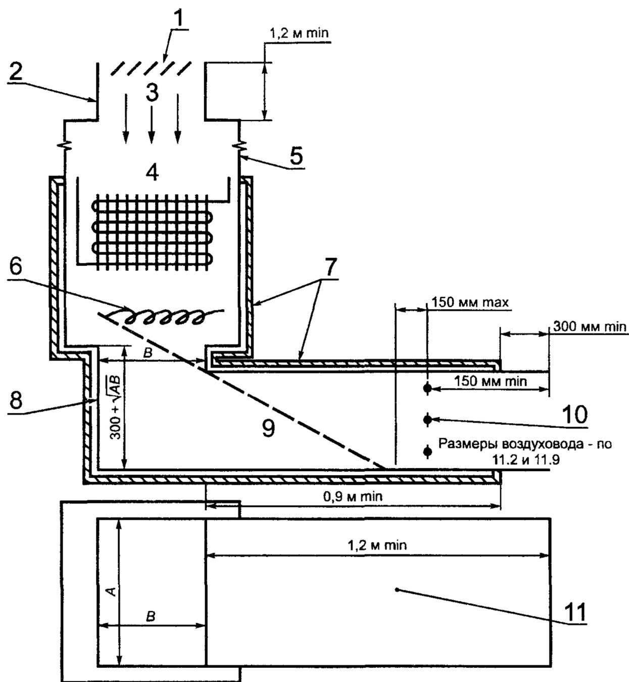
1 — регулируемый дроссель; 2 — входной трубопровод; 3 — воздушный поток; 4 — внутренний блок спиралей; 5 — внутренняя часть камеры; 6 — электрический нагреватель; 7 — испытательная камера; 8 — метка зазора или нулевая отметка; 9 — выходной воздуховод; 10 — термопарная сетка; 11 — выходной воздуховод.
