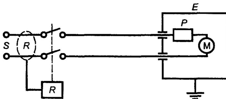
**П р и м е ч а н и е** — Необходимо выполнить заземление системы для обеспечения правильной работы устройства защитного отключения с / без встроенной защитой от сверхтока.
