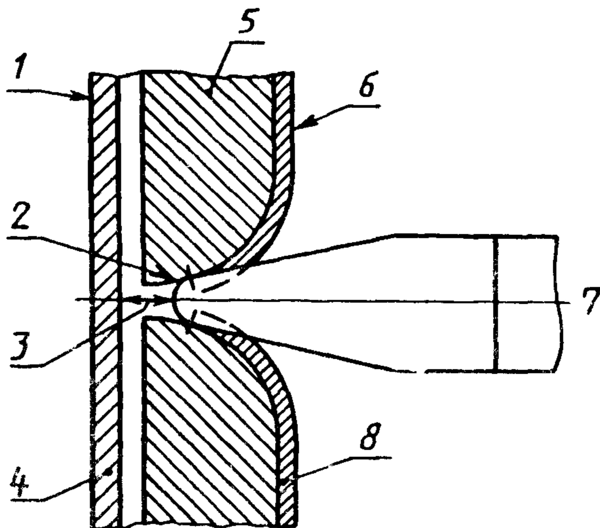
1 — внутренняя сторона; 2 — точка, от которой измеряют токи утечки; 3 — воздушный зазор; 4 — зона, прикасание к которой представляет опасность; 5 — покрытие, 6 — наружная часть, 7 — испытательный палец; 8 — фиктивный проводящий слой
