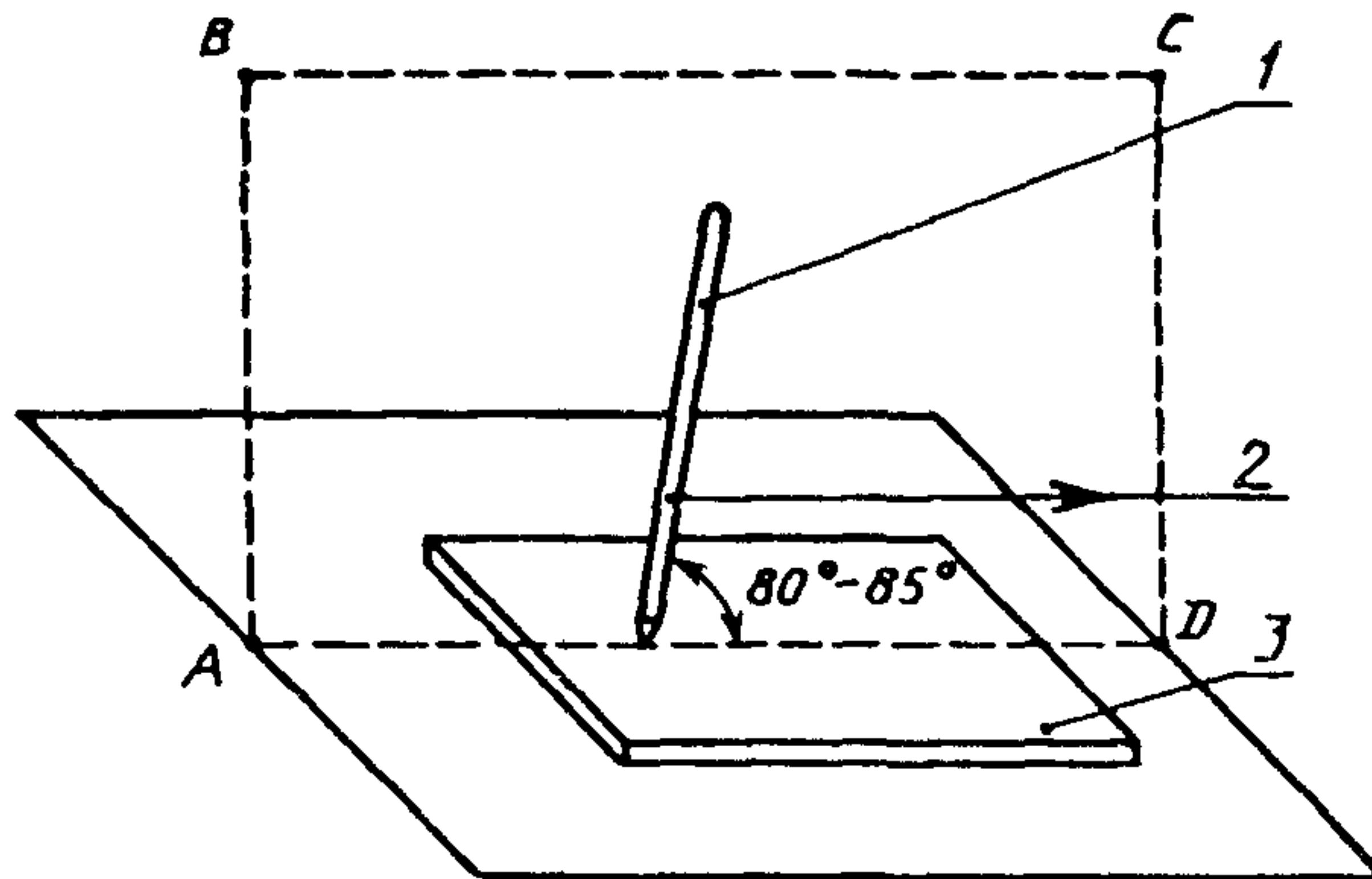
1 — штырь; 2 — направление перемещения штыря; 3 — испытываемый образец
