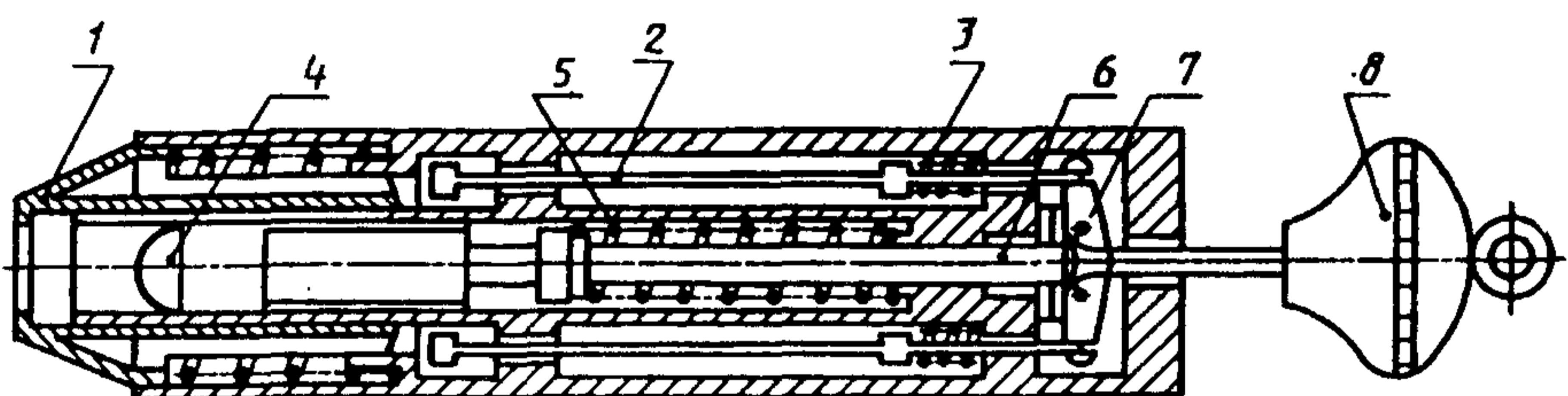
1 — конус давления; 2 — направляющая; 3, 5 — пружины; 4 — боек; 6 — стержень; 7 — цапфа; 8 — ударная часть
