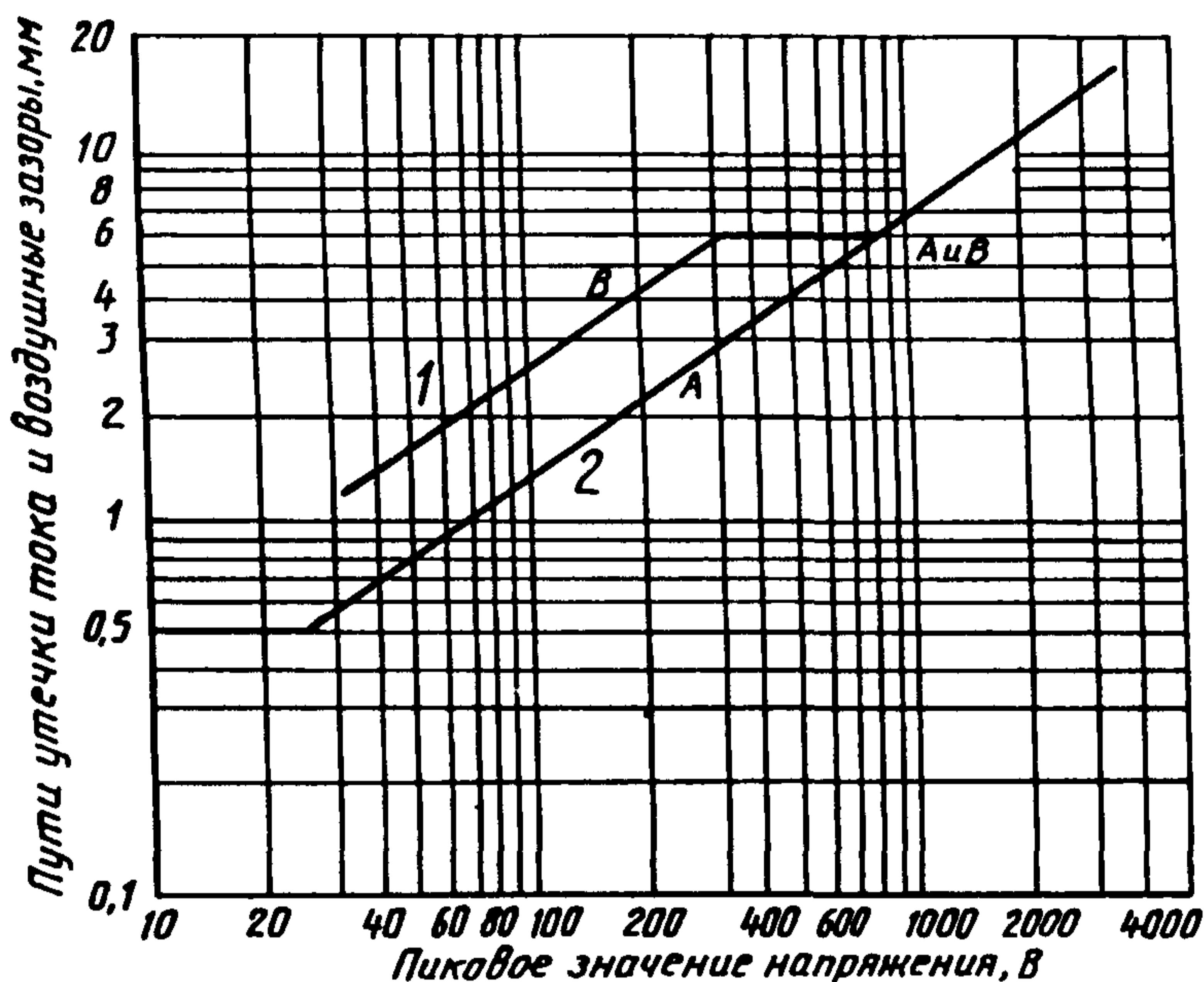
1 — только для усиленной изоляции; 2 — для основной и дополнительной изоляции, а также для испытаний в ненадлежащих условиях работы
