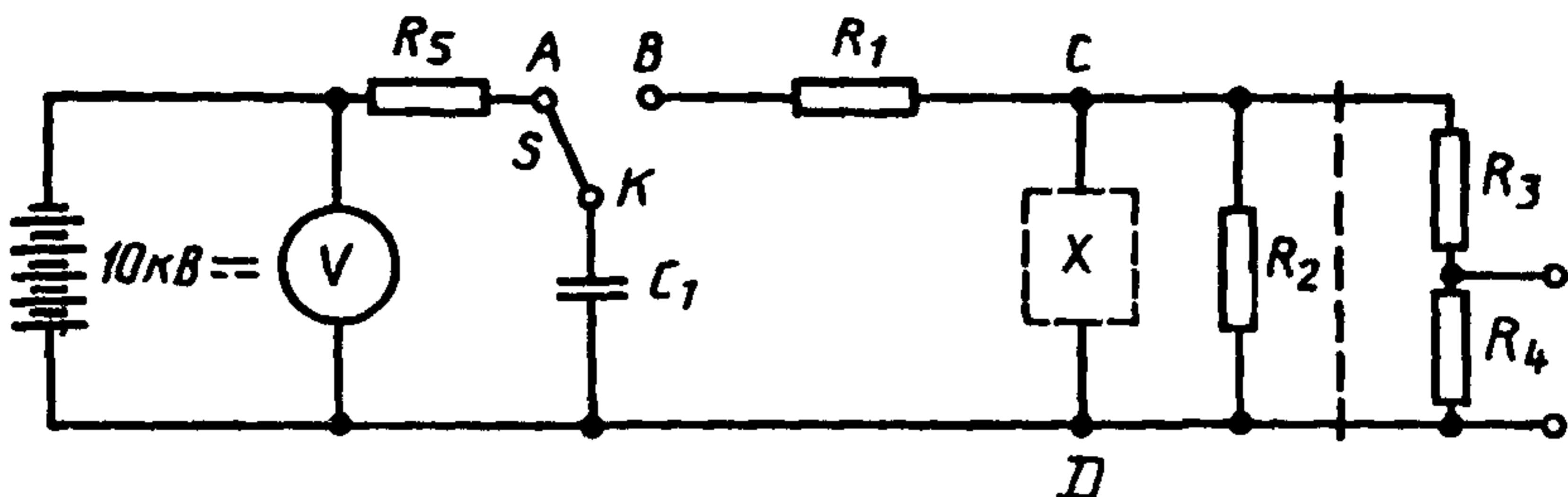
$C_1 = 1 \text{ нФ}$ ;  $R_1 = 1 \text{ кОм}$ ;  $R_2 = 4 \text{ МОм}$ ;  $R_3 = 100 \text{ МОм}$ ;  $R_4 = 0,1 \text{ МОм}$ ;  $R_5 = 15 \text{ МОм}$
