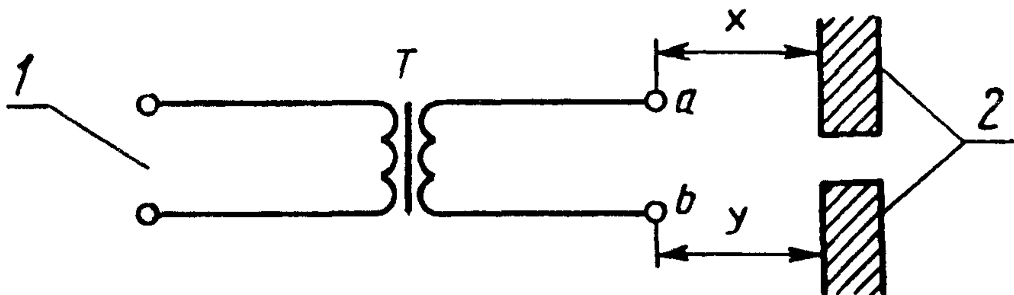
1 — сеть питания; 2 — электрически разделенные доступные части; Т — развязывающий трансформатор
