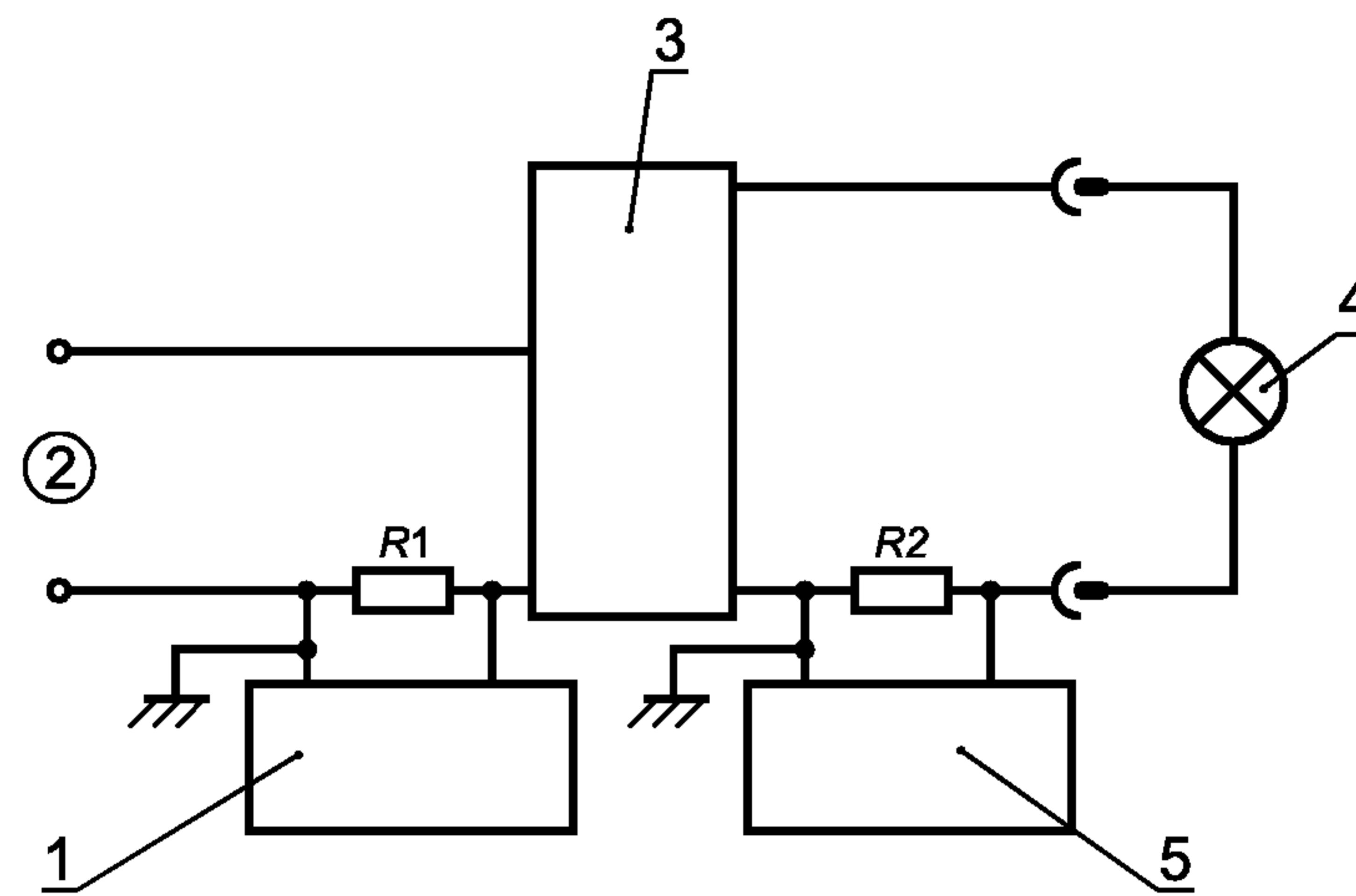
1 — селективный вольтметр или анализатор гармоник; 2 — источник питания; 3 — понижающий преобразователь;
