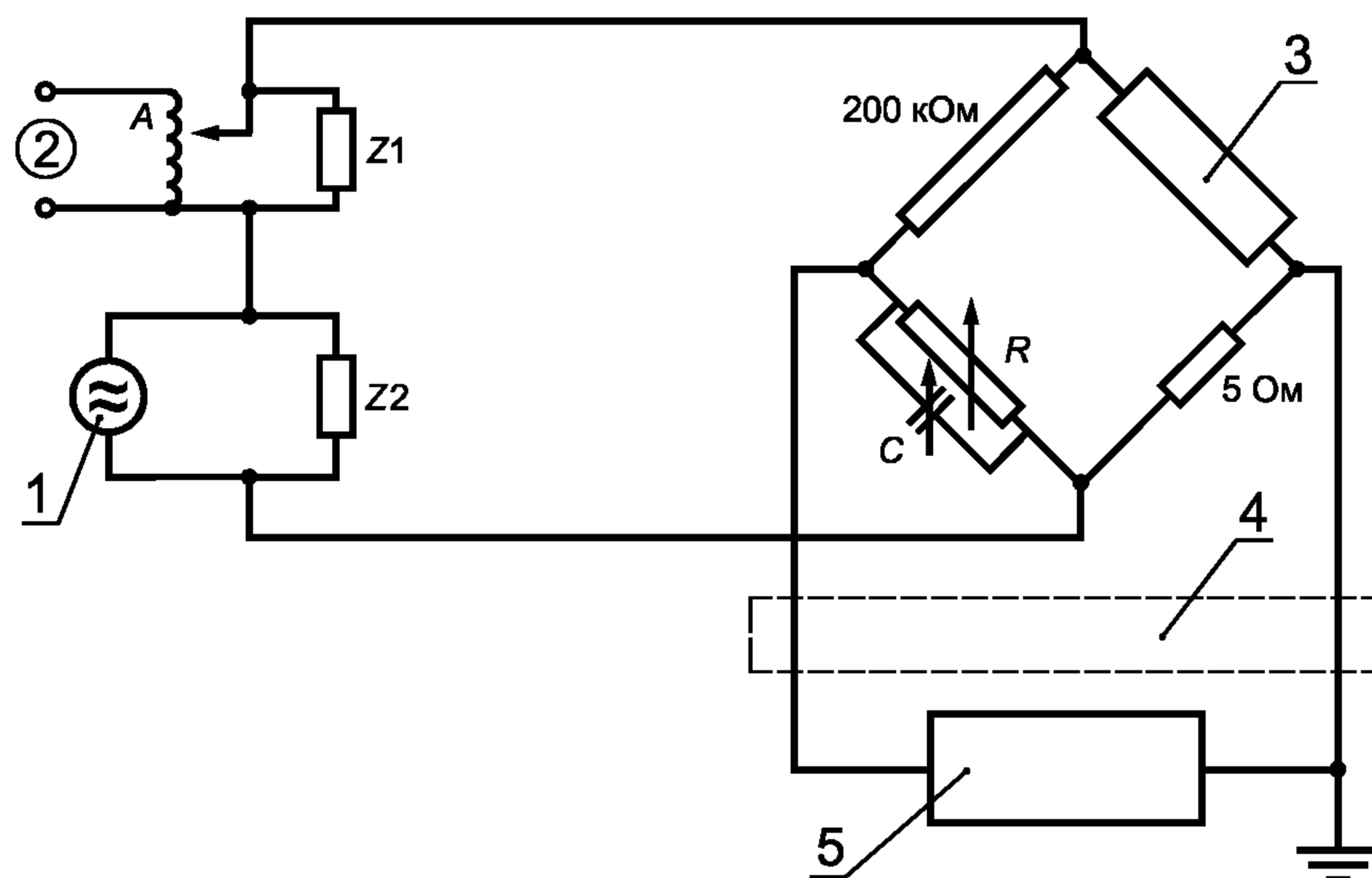
1 — генератор 250—2000 Гц; 2 — сеть 50 или 60 Гц; 3 — комплект лампа + преобразователь; 4 — фильтр 50 или 60 Гц;
