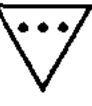
) — преобразователь, содержащий устройство тепловой защиты, предназначенное для предотвращения его перегрева в любых условиях эксплуатации, при температуре на корпусе преобразователя, превышающей объявленное значение.
