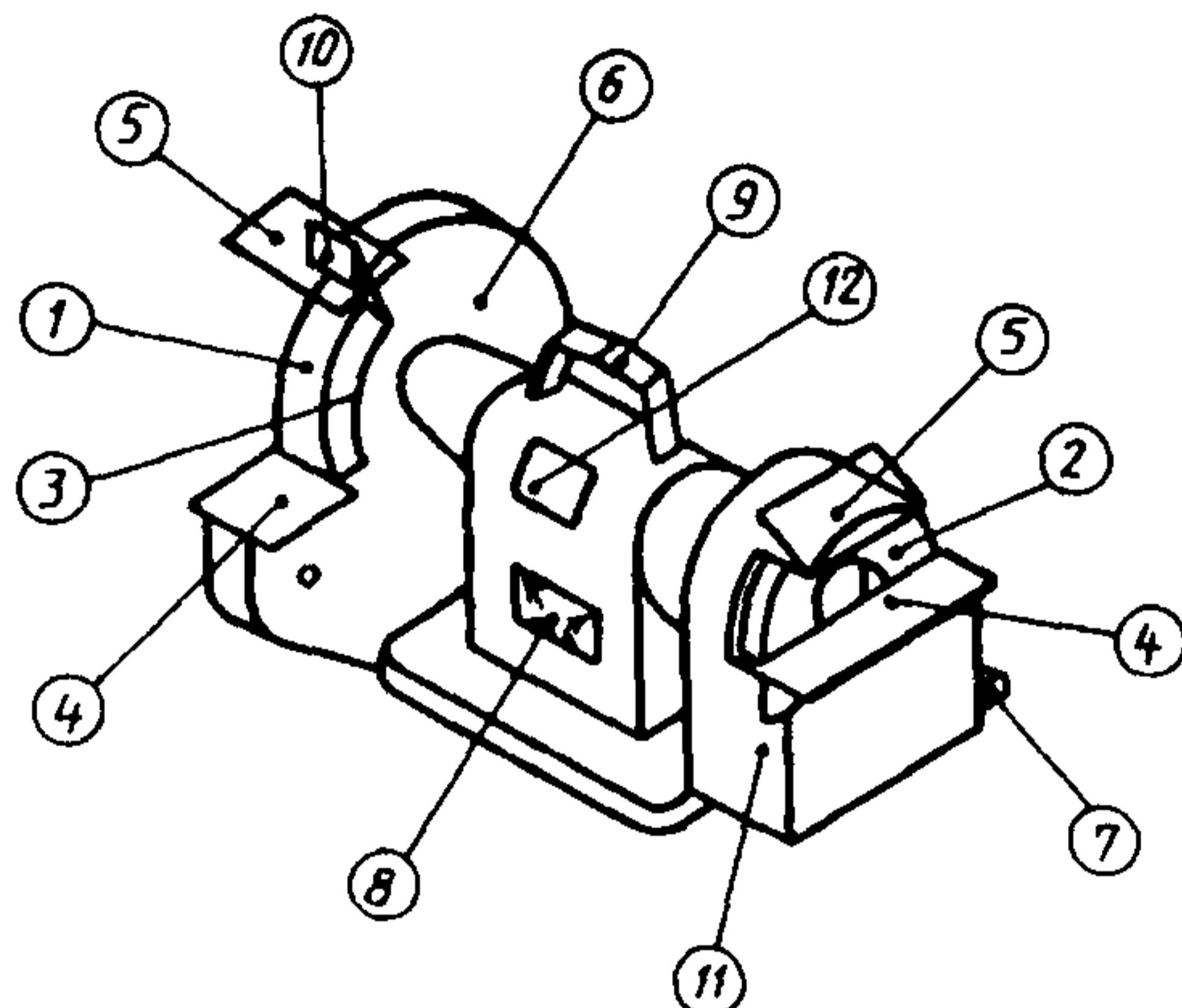
1 — плоский шлифовальный круг, 2 — чашечный цилиндрический шлифовальный круг, 3 — фланец, 4 — рабочий упор, 5 — прозрачный экран, 6 — защитный кожух плоского шлифовального круга, 7 — мундштук для удаления пыли, 8 — устройство включения/отключения, 9 — ручка, 10 — искрогаситель, 11 — защитный кожух чашечного шлифовального круга, 12 — маркировочная табличка
