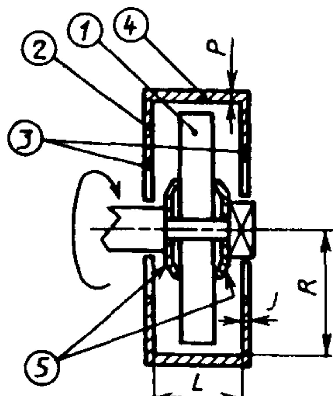
1 — шлифовальный круг, 2 — защитный кожух, 3 — боковые стенки кожуха, 4 — периферическая часть кожуха, 5 — фланцы,  $R$  — толщина периферической части кожуха,  $J$  — толщина боковых стенок кожуха,  $L$  — ширина кожуха,  $R$  — внутренний радиус кожуха
