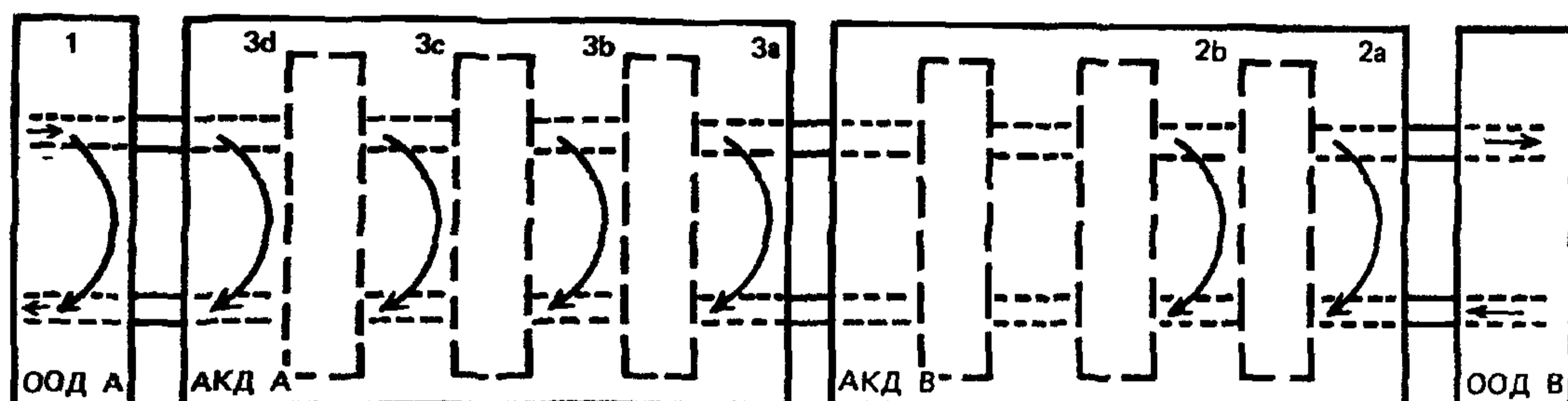
**П р и м е ч а н и е** — Каждая АКД должна реализовывать, по меньшей мере, один из двух шлейфов типа 2 (шлейф 2а или 2б) для проверки со стороны линии и, по меньшей мере, четыре шлейфа типа 3 (шлейфы 3а, 2б, 3с или 3д) для проверки со стороны локального окончания.
